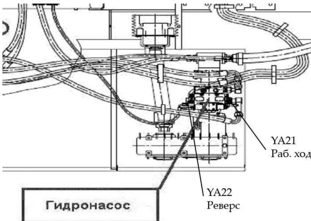
Рисунок М.2 - Расположение магнитов гидронасоса
