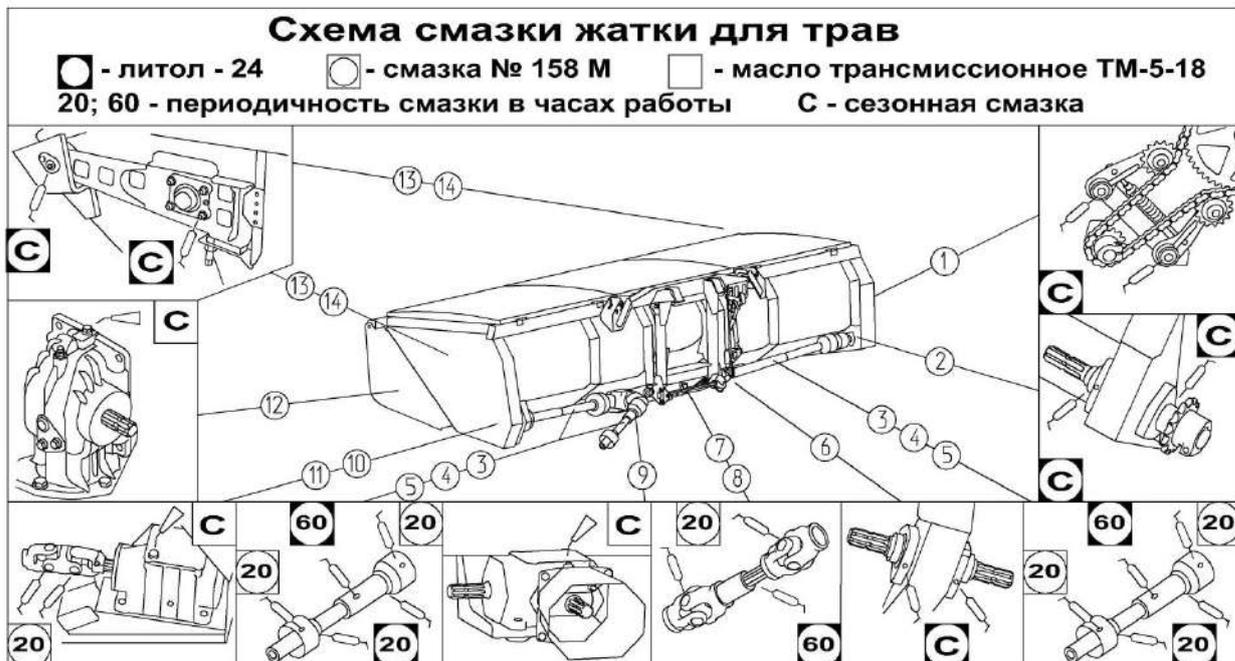
Рисунок 3.1 – Схема смазки жатки
