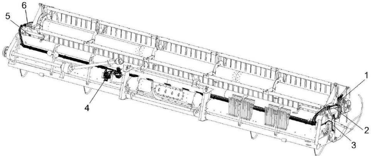
1 – гидромотор привода мотовила;
