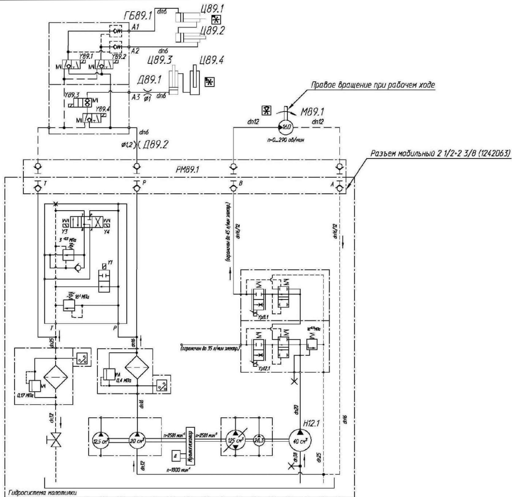
Ц89.1, Ц89.2 - гидроцилиндры горизонтального перемещения мотовила;
