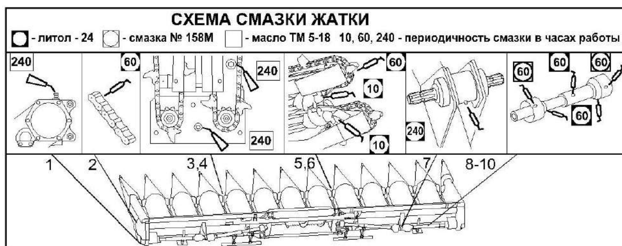
Рисунок 3.1 – Схема смазки жатки
