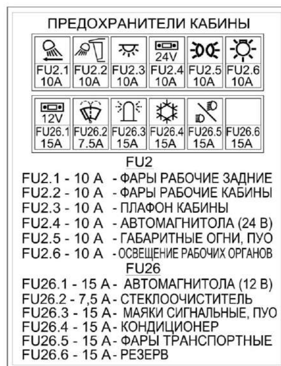
Рисунок 1.37 – Схема расположения предохранителей
