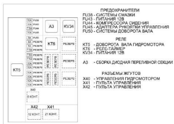
Рисунок 1.33 – Реле и предохранители пульта управления
