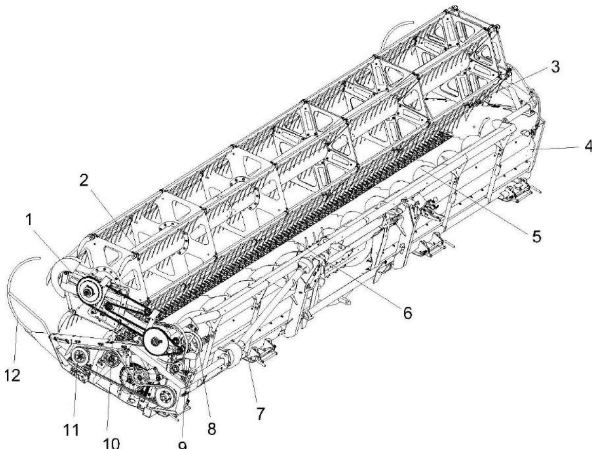
1 – гидроцилиндр выноса мотовила; 2 – мотовило; 3, 10 – гидроцилиндры подъема мотовила по высоте; 4 – рама жатки; 5 – шнек; 6 – режущий аппарат; 7 - копирующий башмак; 8 – вариатор; 9 – исполнительный электромеханизм; 11 – редуктор/угловая передача; 12 – прутковый делитель
