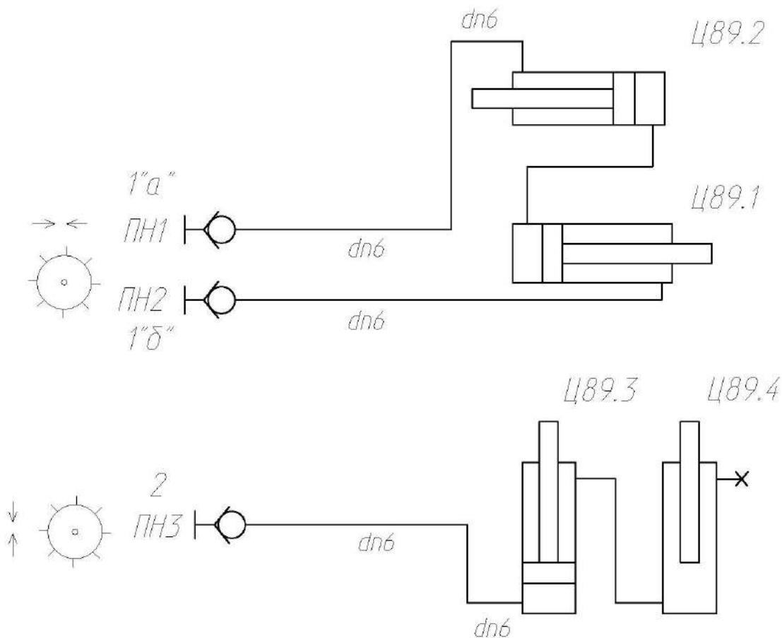
Ц89.1, Ц89.2 - гидроцилиндры горизонтального перемещения мотовила;
