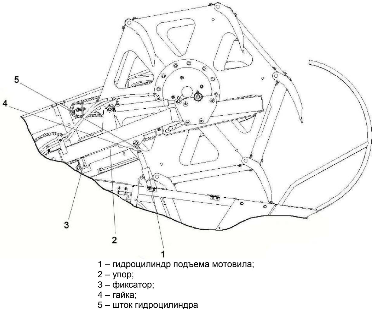
Рисунок 2.13 – Расположение упоров на жатке
