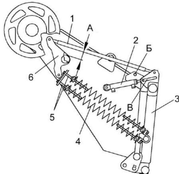
Наклонная камера комбайна
