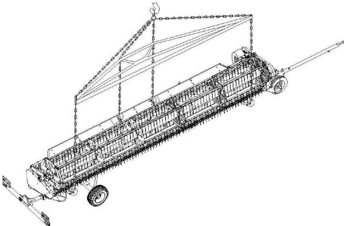
Рисунок 6.1 – Схема строповки жатки с транспортной тележкой
