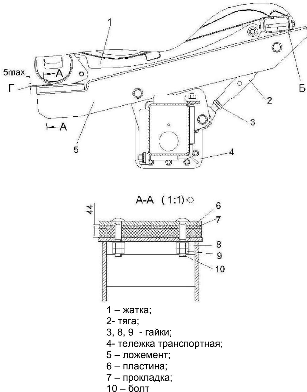
Рисунок 2.21 – Регулировка зазора между жаткой и ложементами тележки
