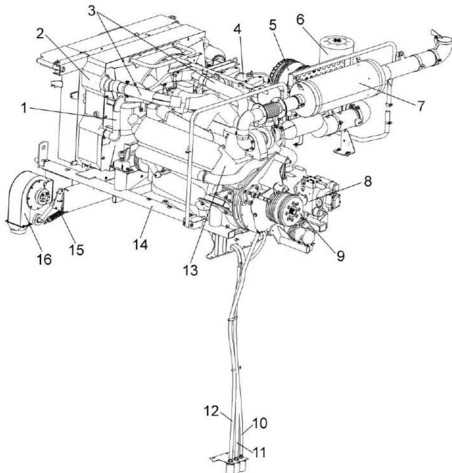
1 – труба водяная верхняя; 2 – радиатор; 3 – трубы воздушные; 4 – бачок расширительный; 5 – воздушный фильтр; 6 - воздухозаборник вращающийся; 7 – глушитель; 8 – установка гидронасосов; 9 – главный привод; 10 – сливной рукав охлаждающей жидкости; 11 – сливной рукав масла из редуктора; 12 – сливной рукав масла из картера двигателя; 13 – двигатель; 14 – рама подмоторная; 15 – устройство натяжное; 16 – вентилятор
