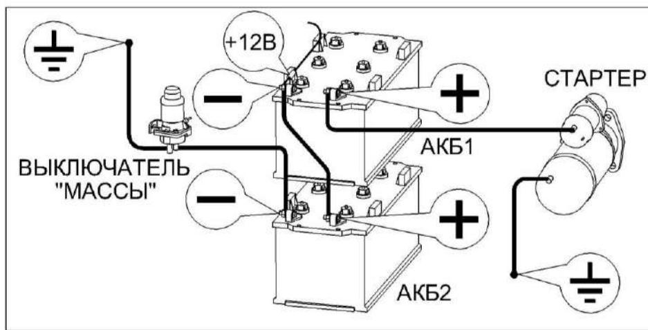
Рисунок 2.3 - Подключение аккумуляторных батарей
