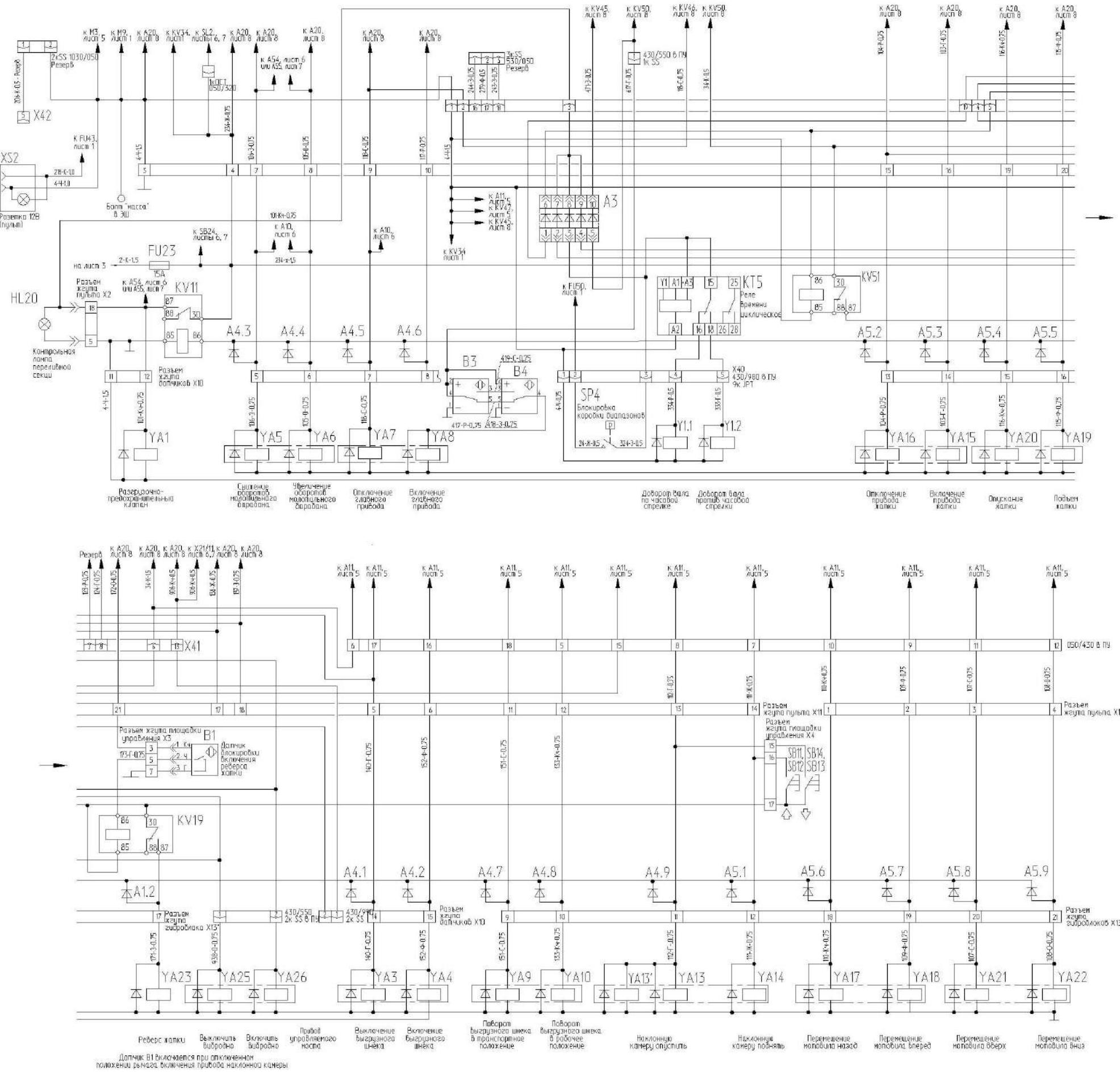
Рисунок Б.4 – Схема электрическая принципиальная комбайна (лист 4)
