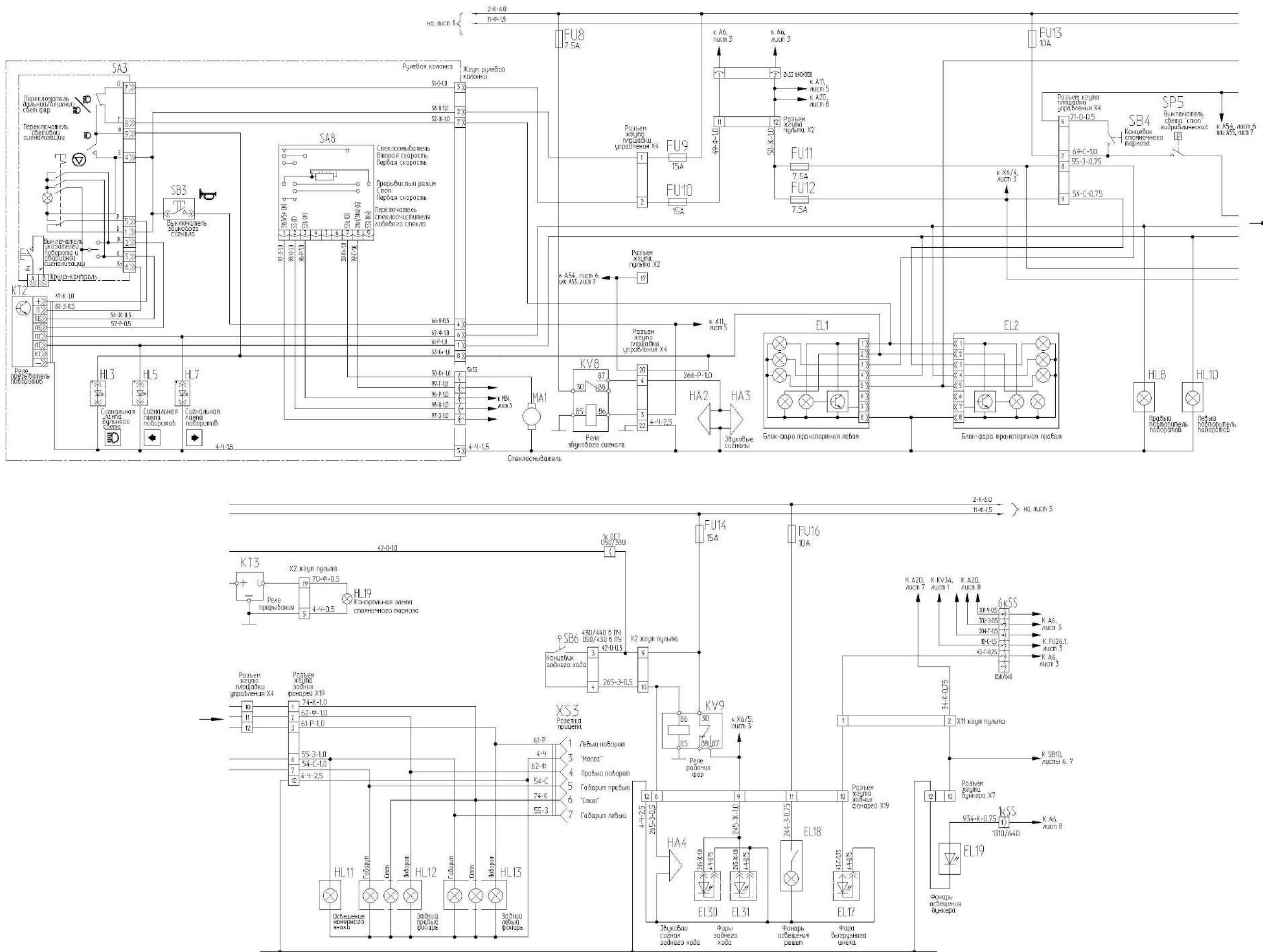
Рисунок Б.2 – Схема электрическая принципиальная комбайна (лист 2)
