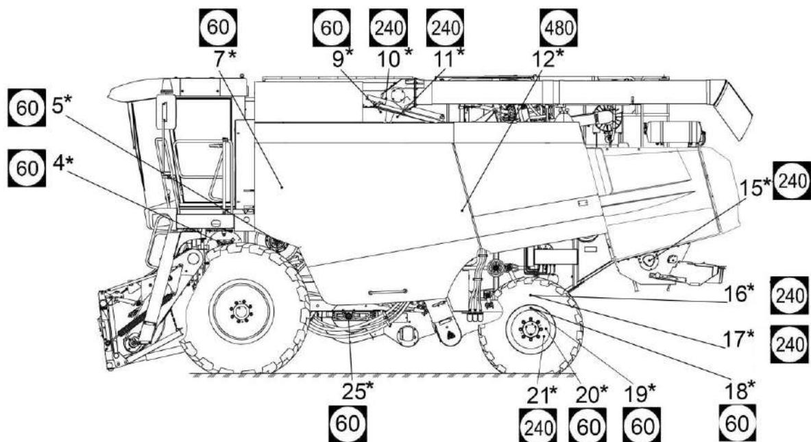
Рисунок 3.3 – Смазка молотилки АЦСС (вид слева)
