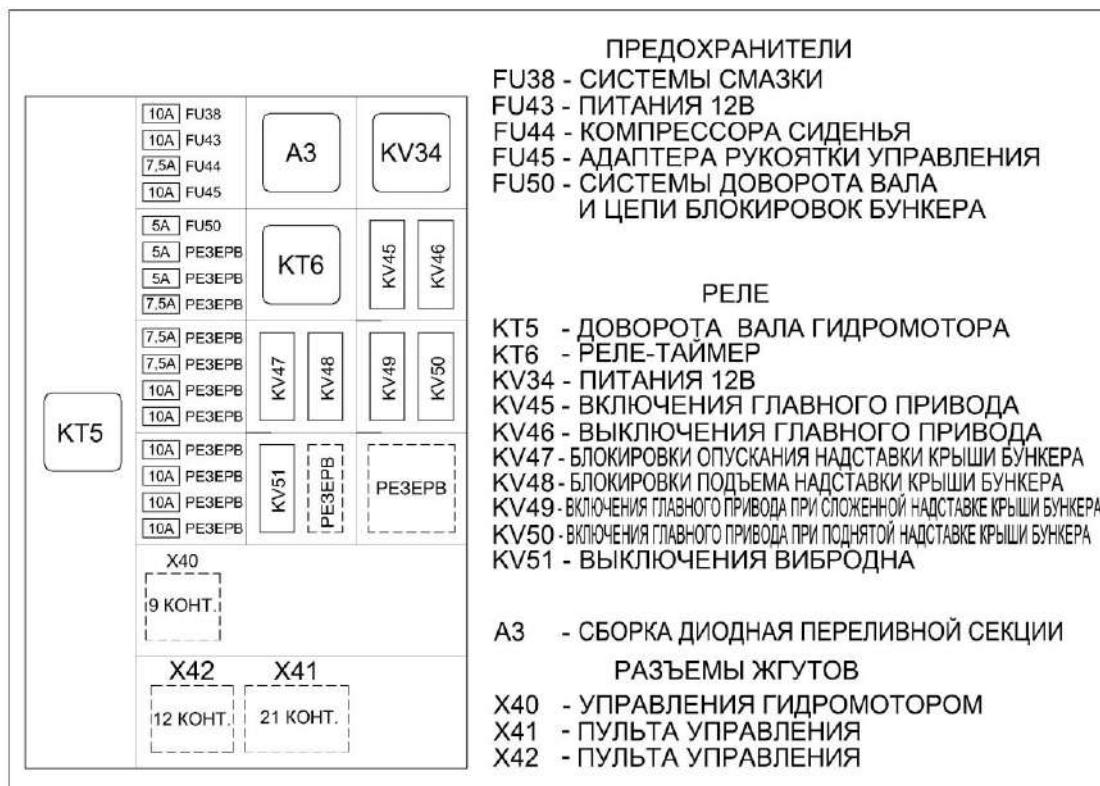
Рисунок 1.31 – Реле и предохранители пульта управления
