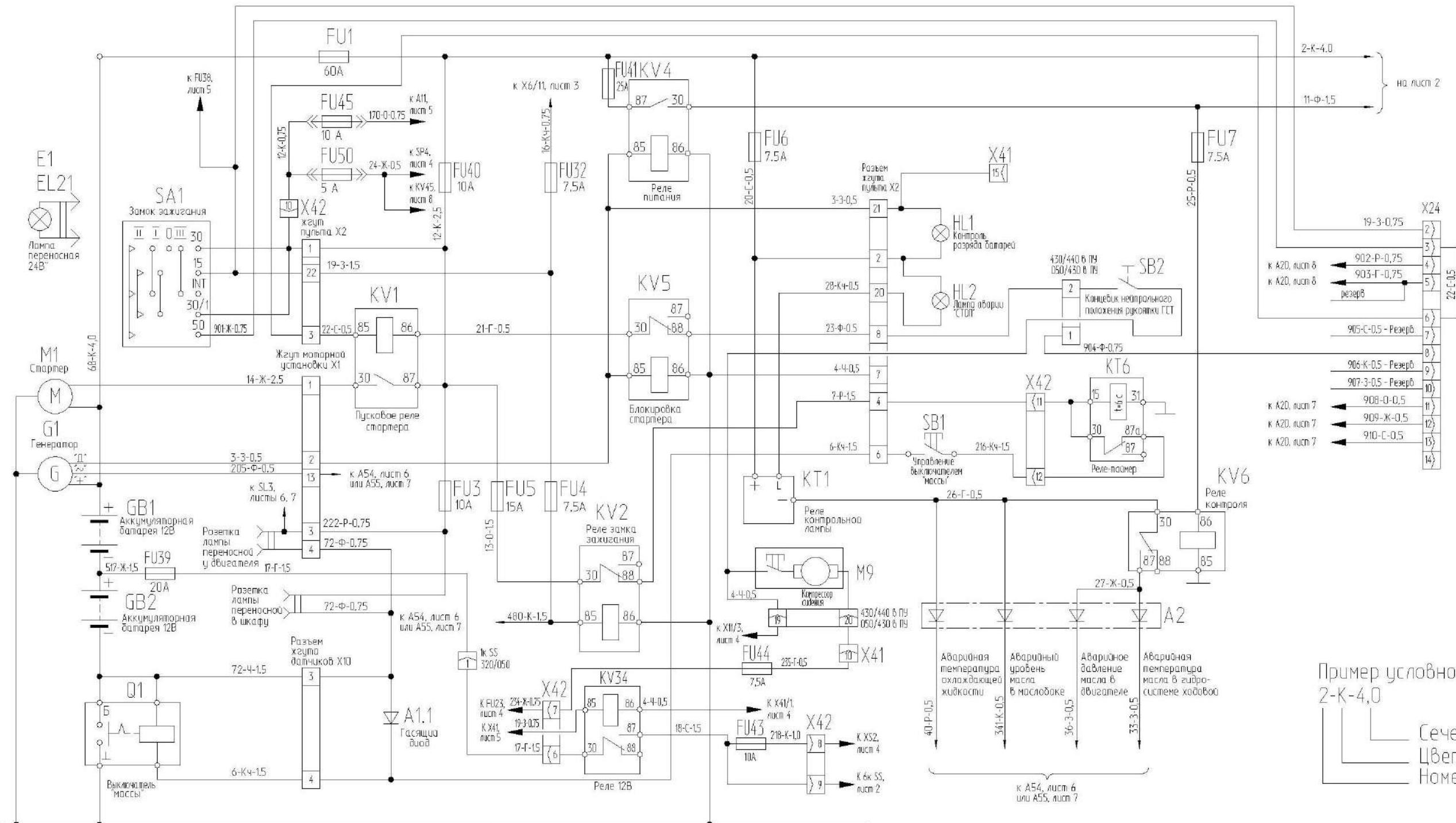
Рисунок Б.1 – Схема электрическая принципиальная комбайна (лист 1)
