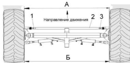
1, 3 – гайки; 2 – тяга рулевая
