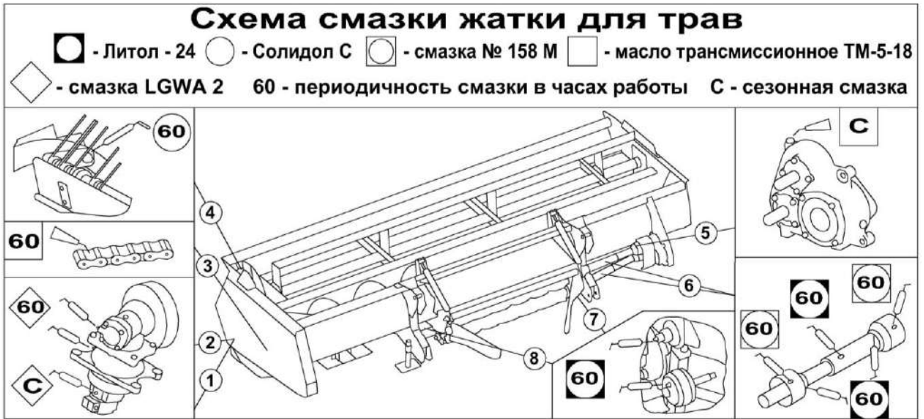
Рисунок 3.2 – Схема смазки жатки
