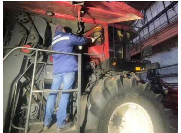
Рисунок 3.4 – Заправка насоса АЦСС
