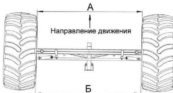
Рисунок 2.25 - Регулировка сходимости колес
