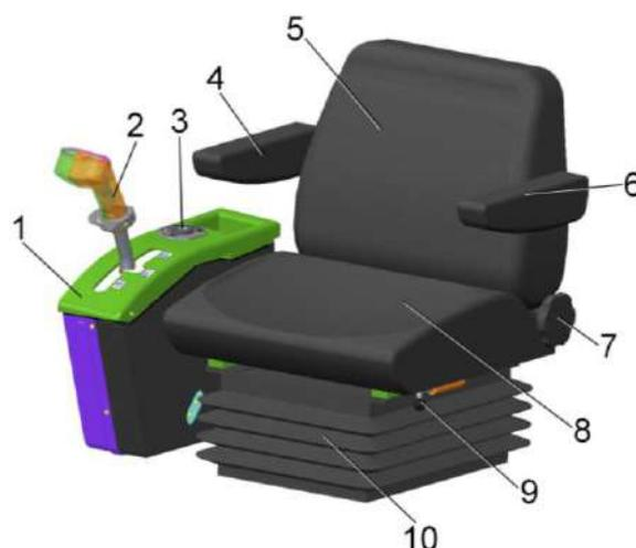
1 – блок управления; 2 - рукоятка управления скоростью движения; 3 - выключатель зажигания; 4, 6 – подлокотники; 5 – спинка; 7 – рычаг фиксации наклона спинки; 8 – подушка; 9 - рычаг фиксации продольного перемещения; 10 – чехол
