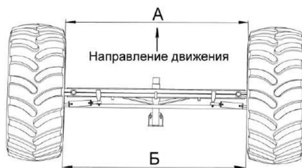
Рисунок 2.26 - Регулировка сходимости колес
