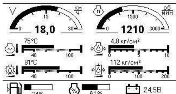
Рисунок К.4 – Экран транспортного режима
