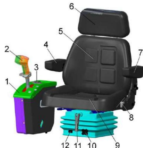
1 – блок управление; 2 – рукоятка управления скоростью движения; 3 - выключатель зажигания; 4, 7 – подлокотники; 5 – спинка; 6 – подголовник; 8 – рычаг фиксации наклона спинки; 9 – подушка; 10 – кнопка регулировки системы подпрессоривания сиденья; 11 – рычаг фиксации продольного перемещения сиденья; 12 – указатель веса
