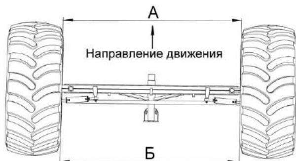
Рисунок 2.26 - Регулировка сходимости колес
