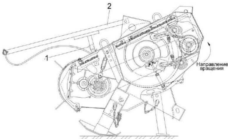
1 – упор прижимного устройства; 2 – прижимное устройство
