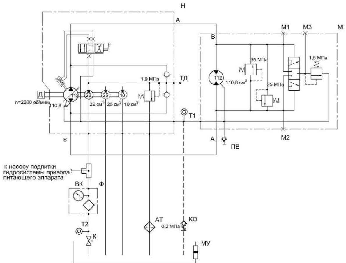
АТ – масляный радиатор; ВК – вакуумметр; КО – обратный гидроклапан; К – шаровой кран; М – гидромотор аксиально-поршневой нерегулируемый; МУ – указатель уровня масла; Н – тандем насосов; ПВ – полумуфта внутренняя; ТД - резьбовое соединение с колпачком; Т1 – датчик указателя температуры жидкости; Т2 – датчик аварийной температуры жидкости; Ф – всасывающий фильтр
