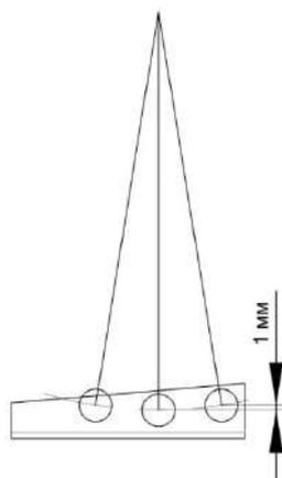
Рисунок 2.54 – Схема установки подвески
