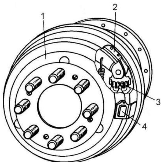
1 - тормозной барабан; 2 - тормозная накладка;
