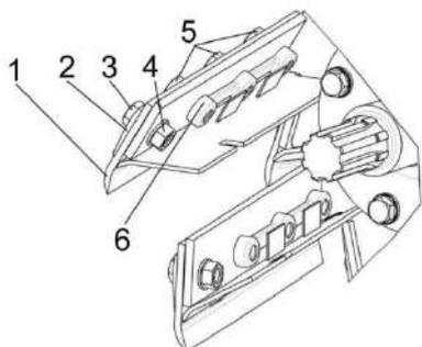
1 – нож; 2 – прижим ножа; 3, 5 – болты; 4 - гайка; 6 -планка
