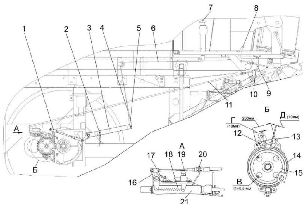
1, 3 – тяги; 2, 18 – пружины; 4, 12 – наконечники; 5, 10, 13 – вилки; 6, 11, 19 – тросы; 7 – рукоятка стояночного тормоза; 8 – педаль управления блокировкой коробки передач; 9, 16 – рычаги; 14 – тормозная лента; 15 – стояночный тормоз; 17 – болт; 20 – кронштейн; 21 – коробка перемены передач
