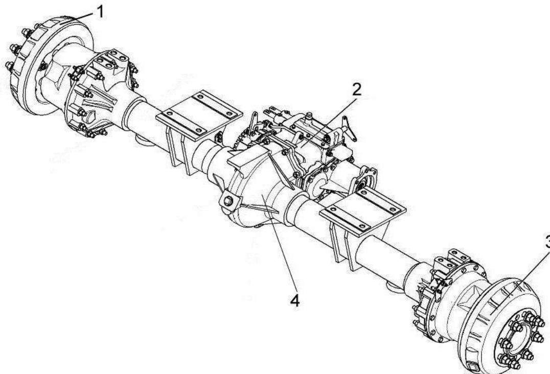
1, 3 – бортовые редуктора; 2 – коробка перемены передач; 4 – дифференциал
