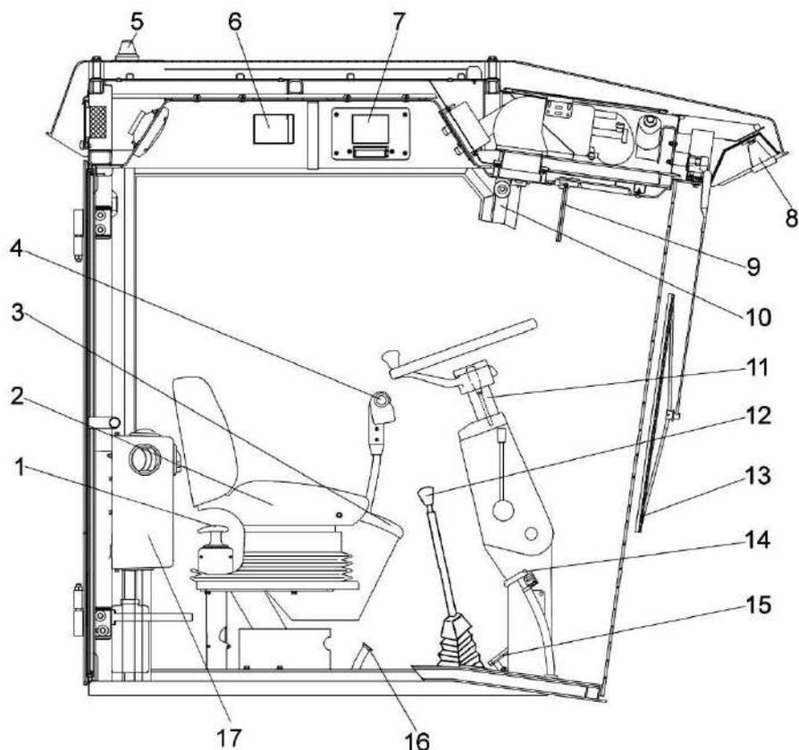
1 – рукоятка стояночного тормоза; 2 – сиденье водителя; 3 – пульт управления; 4 – рукоятка управления скоростью движения; 5 – маяк проблесковый; 6 – плафон освещения салона; 7 – блок предохранителей; 8 – рабочая фара (4 шт.); 9 – козырек; 10 – пульт контроля; 11 – рулевая колонка; 12 – рычаг переключения передач; 13 – стеклоочистители; 14 – педали управления тормозами; 15 – педаль останова двигателя; 16 – педаль управления блокировкой коробки передач; 17 – отопитель
