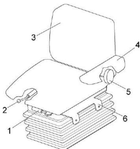
1 - рукоятка регулировки сиденья по массе; 2 - рычаг фиксации продольного перемещения сиденья; 3 – спинка; 4 – подлокотник; 5 - рукоятка фиксации наклона спинки; 6 - кронштейн
