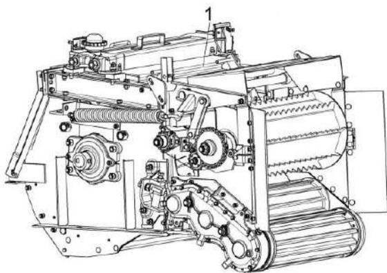
1 – крышка измельчающего барабана
