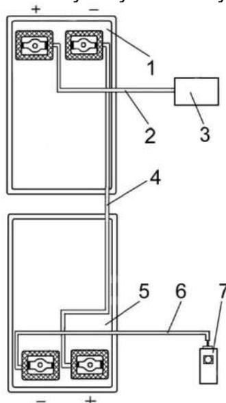
1, 5 – аккумуляторные батареи; 2 – жгут стартера, 3 – стартер; 4 – промежуточный жгут аккумуляторов, 6 – жгут выключателя МАССЫ; 7 – выключатель МАССЫ
