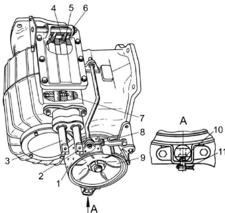
1 - стояночный тормоз; 2 - шток переключения 2-й передачи; 3 - шток переключения 1-й и 3-й передач; 4 - пружина механизма блокировки; 5 – фиксатор механизма блокировки; 6 - валик; 7 - блокирующее устройство; 8 - винт регулировки стояночного тормоза; 9 - шкив; 10 - пружина; 11 – болт
