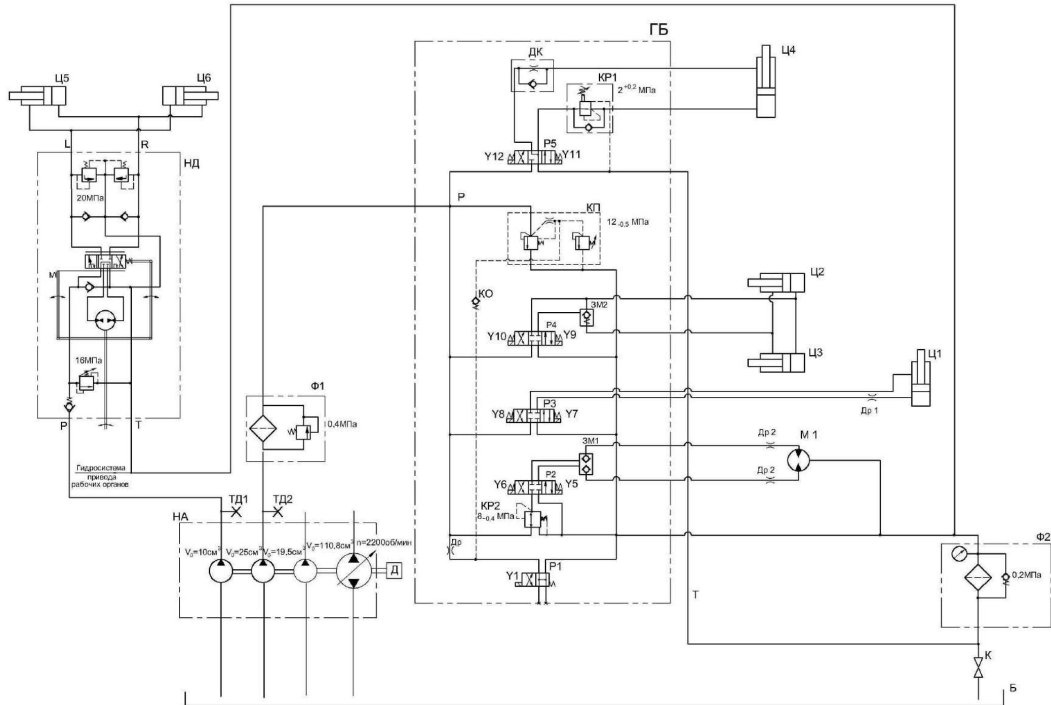
Б – масляный бак; ГБ – гидроблок; P1 - P5 – гидрораспределители; 3М1, 3М2 – гидрозамки; Др – демпфер; ДК – гидродроссель с обратным клапаном; КП – предохранительный клапан; КР1, КР2 – редукционные клапана; КО – обратный клапан; К – кран; Др1, Др2 – гидродроссели; М1 – гидромотор поворота силосопровода; НА – тандем насосов; НД – насос-дозатор; ТД1, ТД2 – резьбовые соединения с колпачком; Ф1, Ф2 - фильтры
