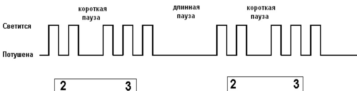
Рисунок Ж.1 – Пример отображения ошибки с кодом 23
