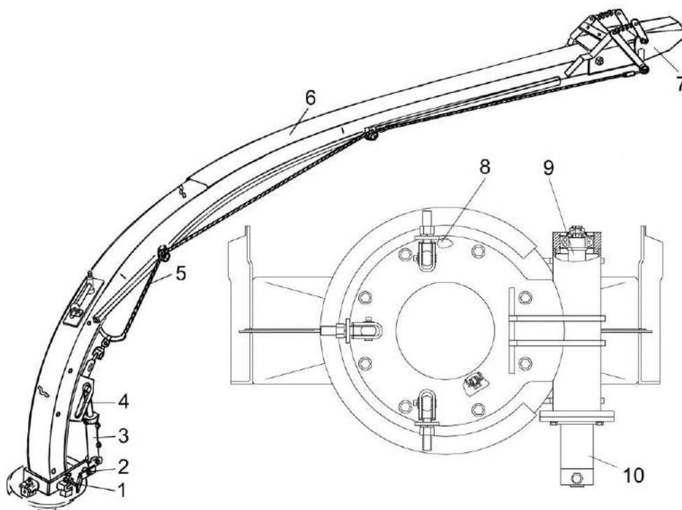
1 - откидной болт; 2 - ось; 3 - гидроцилиндр; 4 - кронштейн; 5 - трос; 6 - силосопровод; 7 - козырек; 8 - опора; 9 - червяк; 10 - гидромотор
