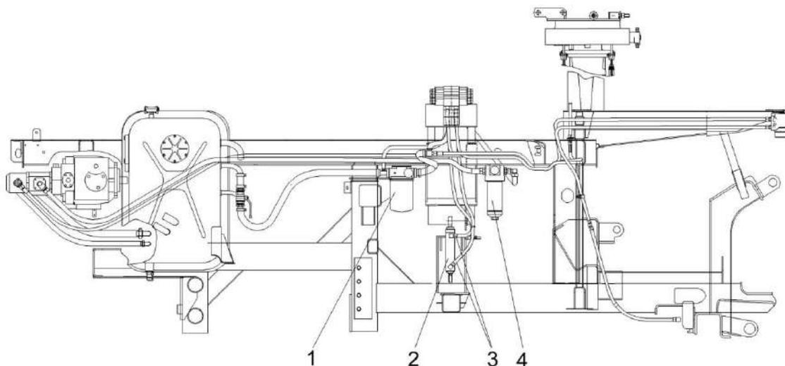
1 – сливной фильтр; 2 – гидроцилиндр управления ВОМ; 3 – рукава высокого давления; 4 – напорный фильтр
