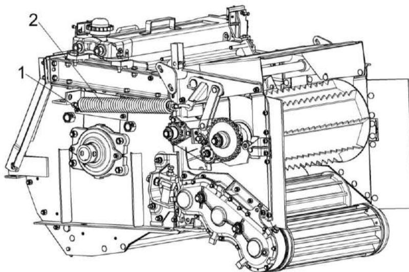
1 – регулировочный болт; 2 – пружина механизм подпрессовки массы
