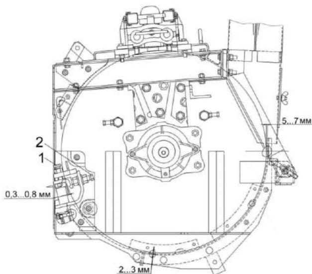
1 – прижимной болт, 2 – регулировочный болт
