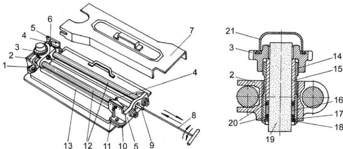
1 - болт крепления ограждения; 2 - каретка; 3 – храповое колесо; 4 - защелка; 5 - кронштейн; 6 - гайка стопорения тяги; 7 - ограждение; 8 - тяга; 9 - винт крепления тяги; 10 - регулировочная шайба; 11 - регулировочный болт; 12 - направляющие; 13 - задвижка; 14 - резьбовая втулка; 15 - нажимная втулка; 16 - зажимная втулка; 17 - специальная шайба; 18 - стопорное кольцо; 19 - абразивный брусок; 20 - резиновые кольца; 21 – колпак
