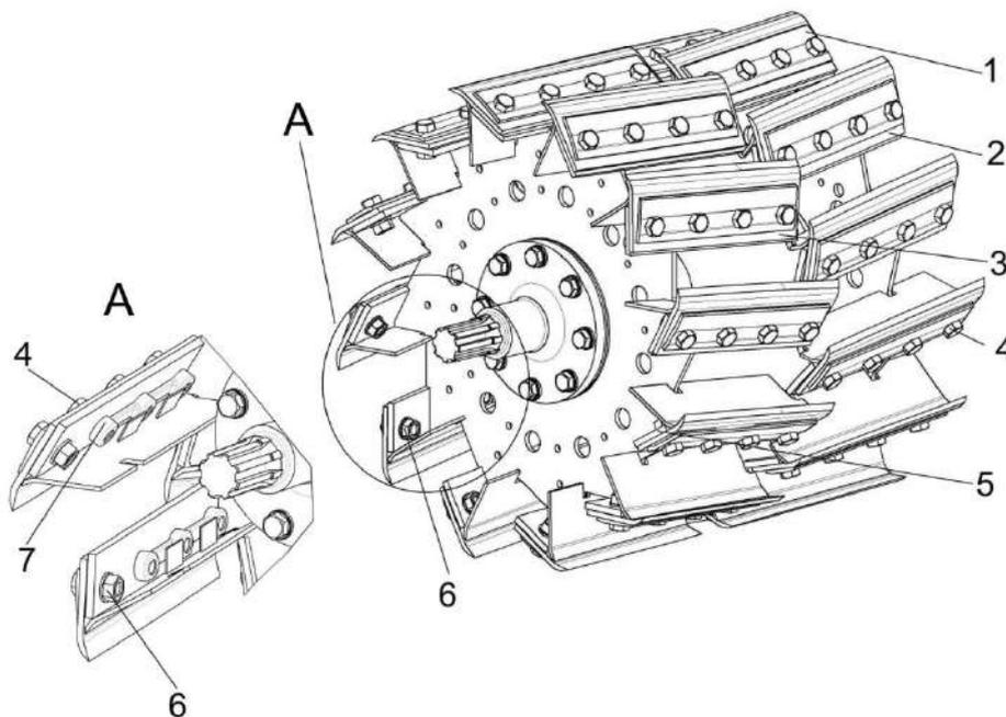
1 - прижим ножа; 2, 3 - ножи; 4 – болт; 5 – опора; 6 – гайка; 7 - планка
