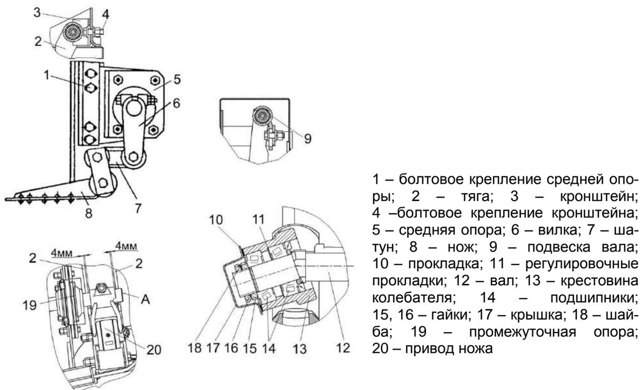
1 – болтовое крепление средней опоры; 2 – тяга; 3 – кронштейн; 4 – болтовое крепление кронштейна; 5 – средняя опора; 6 – вилка; 7 – шатун; 8 – нож; 9 – подвеска вала; 10 – прокладка; 11 – регулировочные прокладки; 12 – вал; 13 – крестовина колебателя; 14 – подшипники; 15, 16 – гайки; 17 – крышка; 18 – шайба; 19 – промежуточная опора; 20 – привод ножа
