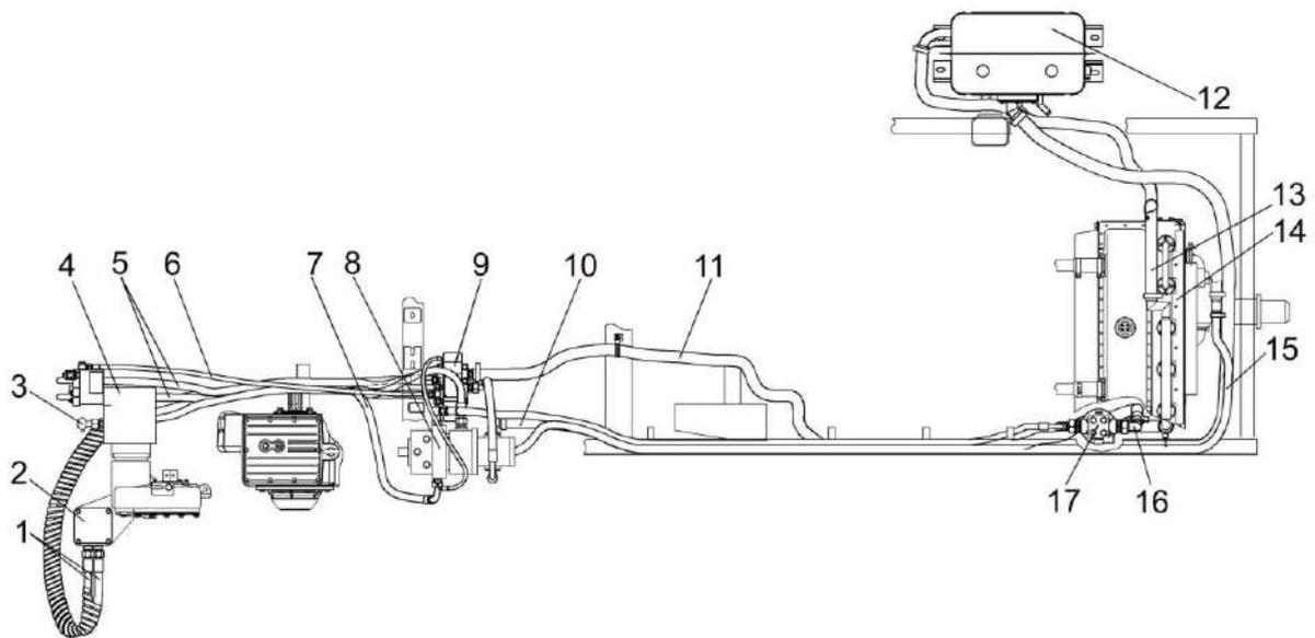
1, 5, 6 – рукава высокого давления; 2 – гидромотор привода адаптеров; 3 – заправочная муфта; 4 - гидромотор привода питающего аппарата; 7, 11, 13 – рукава; 8 – двухсекционный гидронасос; 9 – гидроблок адаптеров; 10, 15 - всасывающие рукава; 12 – масляный бак; 14 - масляный радиатор; 16 – кран; 17 - сливной фильтр
