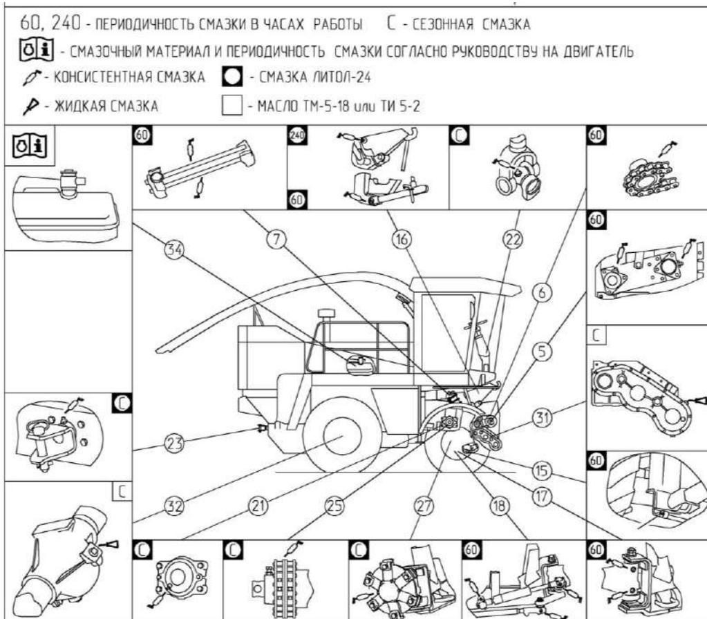
Рисунок 3.2 – Схема смазки самоходного измельчителя (вид справа)
