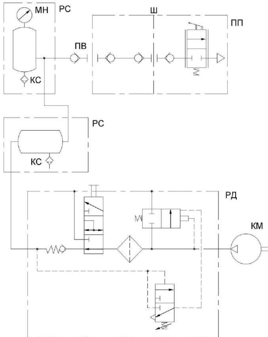
КМ – компрессор; КС – клапан слива конденсата; МН – манометр; ПВ – пневмовывод; ПП – обдувочный пневмопистолет; РС – ресивер; РД – регулятор давления; Ш - шланг
