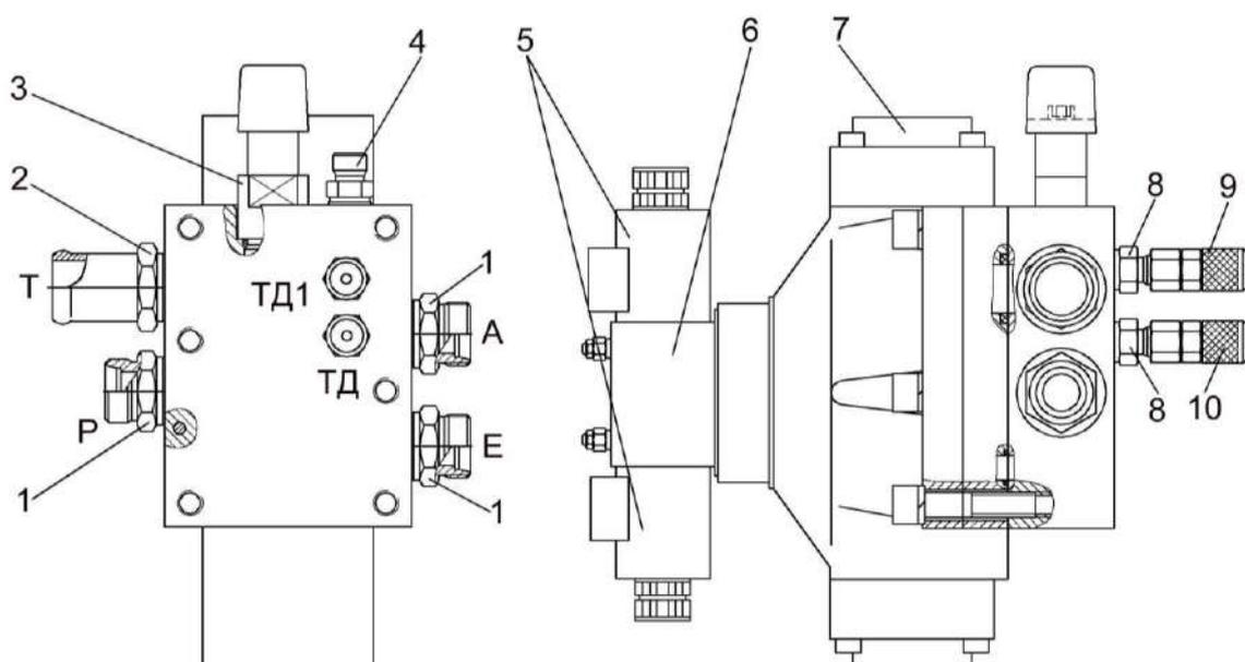
1, 2, 4, 8 – штуцера; 3 – предохранительный клапан; 5 – электромагниты управления; 6 – управляющий гидрораспределитель; 7 – основной гидрораспределитель; 9- диагностическая точка давления управления (подпитки аксиально-плунжерного насоса); 10 - диагностическая точка давления шестеренного насоса (давления гидромотора адаптеров). Р – напорная линия; Т – сливная линия; А, Е – линии подсоединения к гидромотору привода адаптеров
