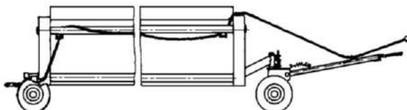
Схема прокладки жгута проводов по жатке
