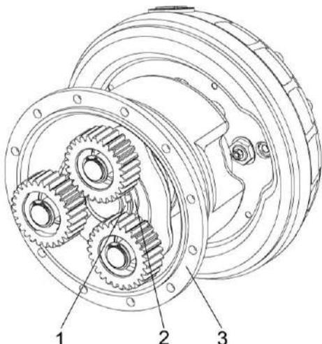
1 - гайка; 2 - шайба замочная; 3 - корпус бортового редуктора
