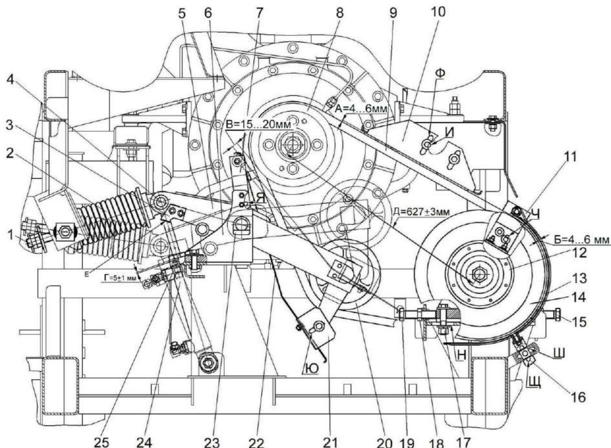
1, 17, 18 – гайки; 2 – пружина механизма натяжения; 3, 6, 7, 16, 21, 23 – кронштейны; 4 – палец; 5 - рычаг; 8 – шкив двигателя; 9 – ремень; 10 – пластина; 11 – планка; 12 – контрпривод; 13 – ограждение; 14 – шкив контрпривода; 15 – упорный болт; 19 – болт; 20 – натяжной шкив; 22 – щиток; 24 – гидроцилиндр; 25 – концевой выключатель
