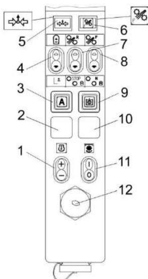
1 – переключатель регулировки оборотов двигателя; 2, 10 – заглушки; 3 – выключатель включения/выключения питания автоматики; 4, 7, 8 – переключатели управления питающим аппаратом; 5 – контрольная лампа переливной секции; 6 – лампа контроля режимов автоматики; 9 – выключатель включения/выключения питания электрогидравлики; 11 – переключатель включения/отключения главного привода; 12 – звуковой сигнализатор аварийных режимов
