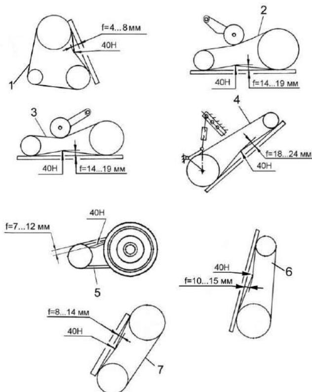
1 – привод компрессора; 2 – привод двигателя жатки для трав; 3 – привод режущего аппарата жатки для трав; 4 – привод подбирающего барабана подборщика; 5 – привод водяного насоса; 6 – привод генератора; 7 – привод компрессора кондиционера
