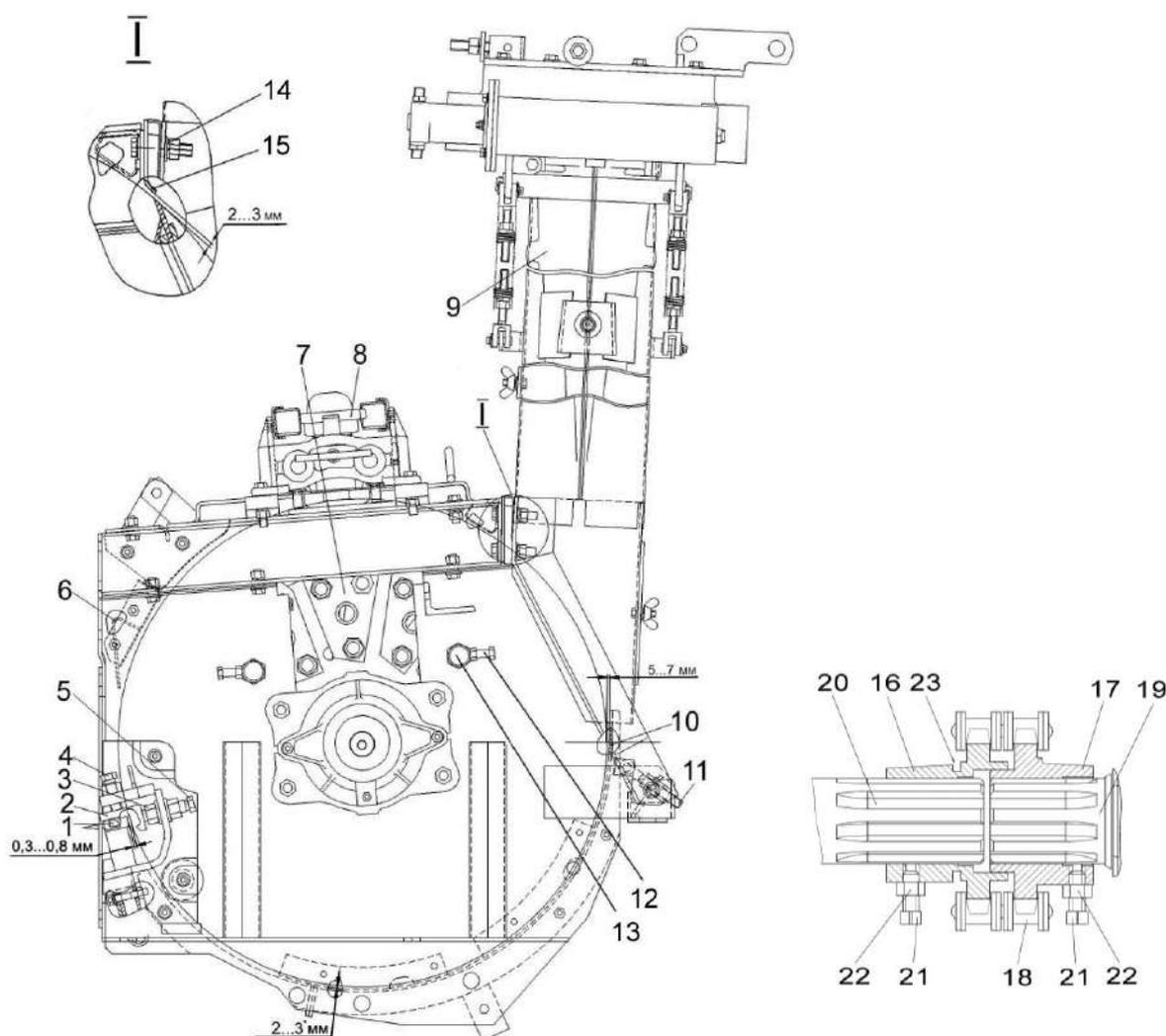
1 – противорежущий брус; 2 – прижим; 3 – гайка; 4, 5, 11, 14, 21 – болты; 6 – отражатель; 7 – барабан; 8 – заточное устройство; 9 – основание силосопровода; 10 – поддон; 12 – стопорный болт; 13 – бонка; 15 – отсекатель; 16, 17 – полумуфты; 18 – цепь; 19, 20 – валы; 22 – гайки; 23 – проточка
