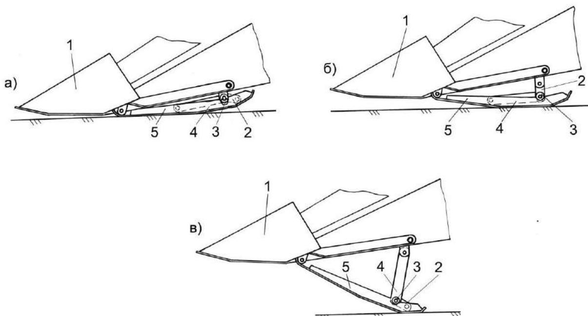
1 – носок делителя; 2, 4 – стойки; 3 – ось; 5 – башмак
