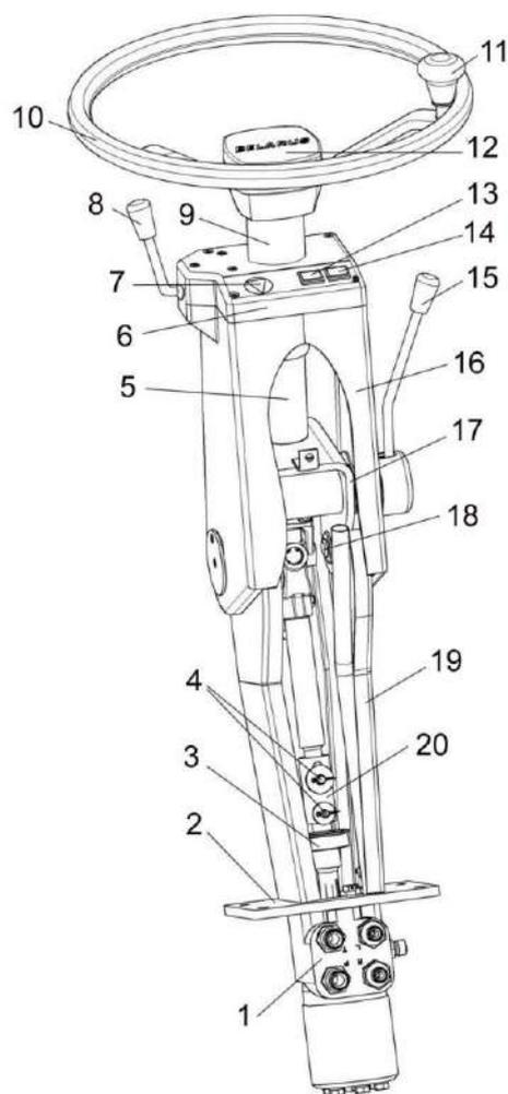
1 - насос дозатор; 2, 17 – кронштейны; 3 – опора; 4, 18 – оси; 5 – рулевой вал; 6 – крышка; 7 – выключение аварийной сигнализации; 8 – подрулевой переключатель; 9 – колпак; 10 – колесо рулевое; 11 – ручка; 12 – крышка; 13 - контрольная лампа указателей поворотов; 14 - контрольная лампа дальнего света; 15 - рукоятка фиксации угла наклона колонки; 16 - кожух; 19 – стойка; 20 – втулка
