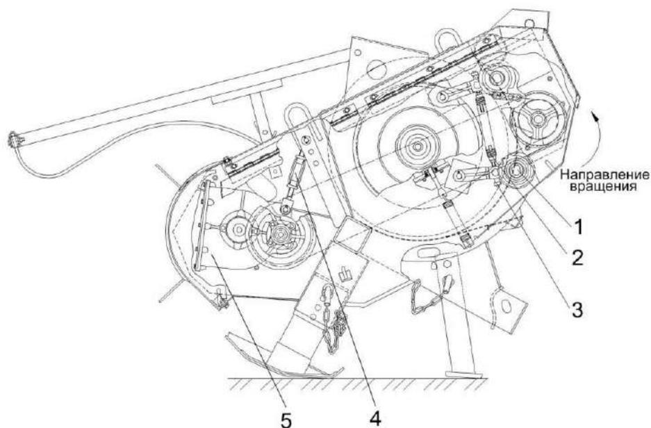
1 – натяжной ролик; 2 – пружина; 3 – тяга; 4 – стяжка; 5 – редуктор
