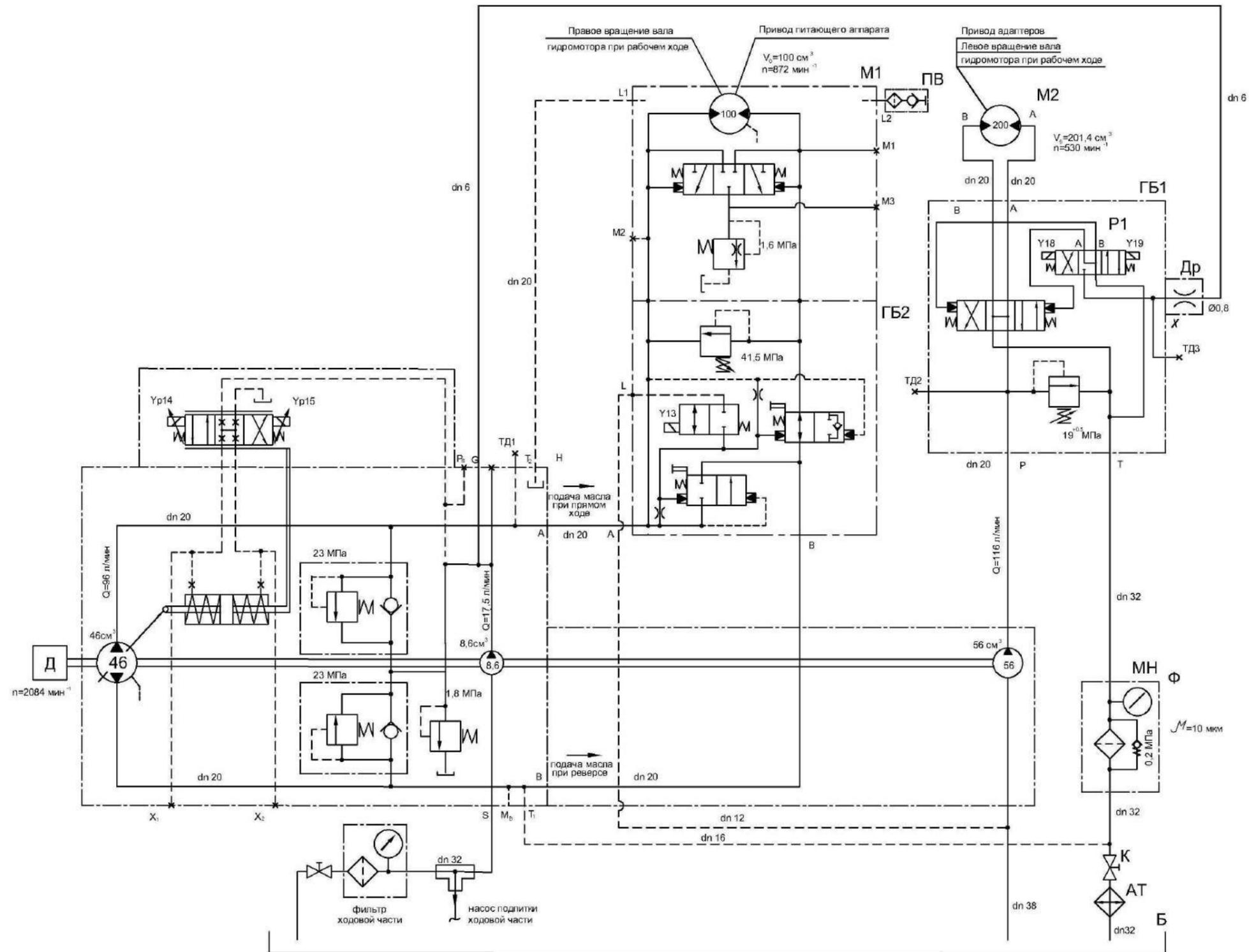
АТ – масляный радиатор; Б – масляный бак; ГБ1 – гидроблок адаптеров; ГБ2 – гидравлический блок; Р1 – гидрораспределитель; ТД1, ТД2, ТД3 – резьбовые соединения с колпачком; К – шаровый кран; М1, М2 – гидромоторы; Н – двухсекционный гидронасос; ПВ – внутренняя полумуфта; Ф – сливной фильтр
