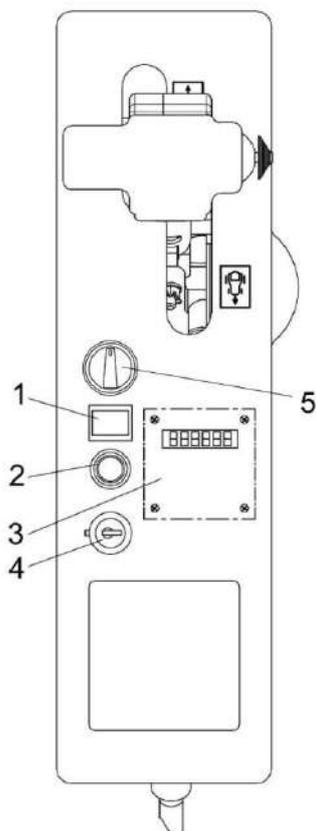
1 – контрольная лампа включения МАССЫ; 2 – кнопка дистанционного управления выключателем МАССЫ; 3 – счетчик времени наработки двигателя; 4 – замок зажигания; 5 – переключатель оборотов вентилятора отопителя
