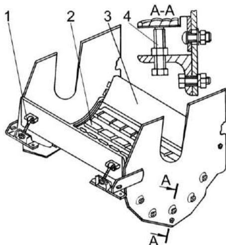
1 - болт регулировочный; 2 - устройство для дробления зерна (сменное); 3 - поддон гладкий; 4 - болт регулировочный
