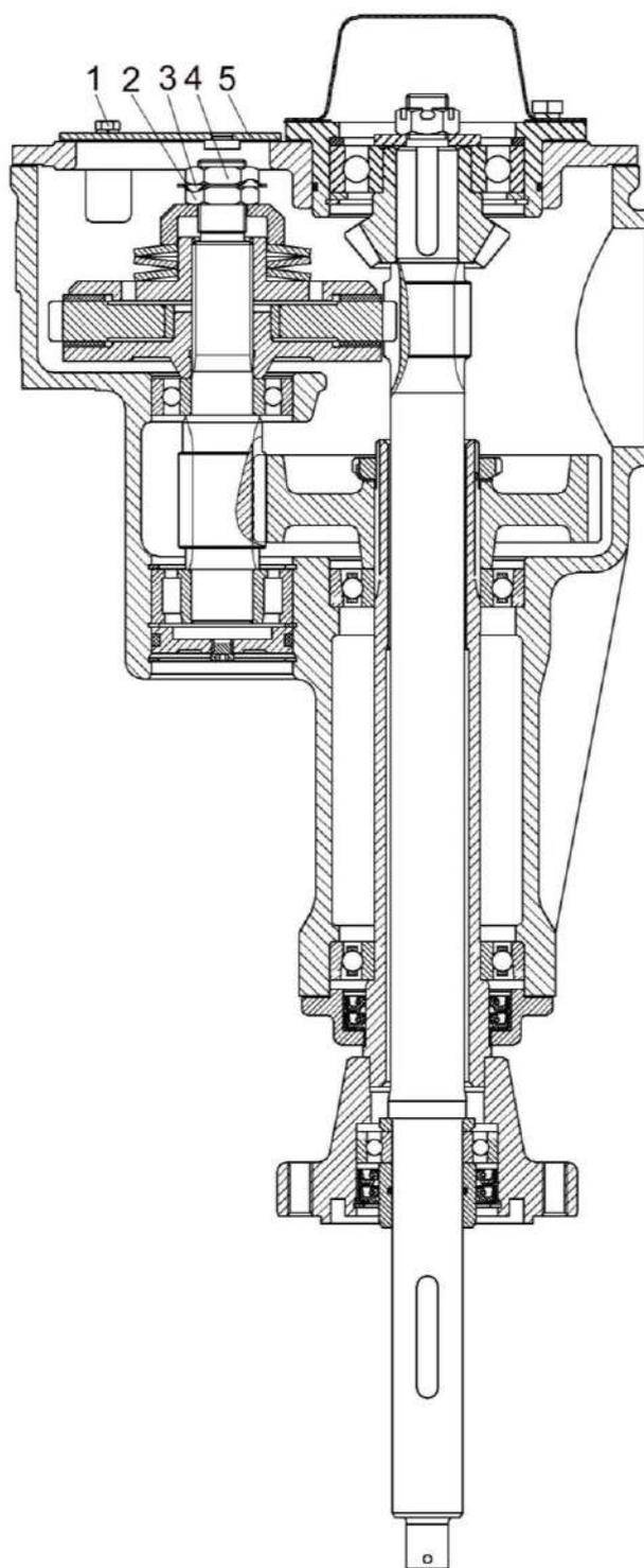
1 – болт; 2 – гайка; 3 – шайба стопорная; 4 – контргайка; 5 – крышка
