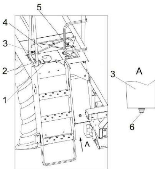
1 – заливная горловина; 2, 4 - крышки; 3 – топливный бак; 5 – фиксатор; 6 - пробка
