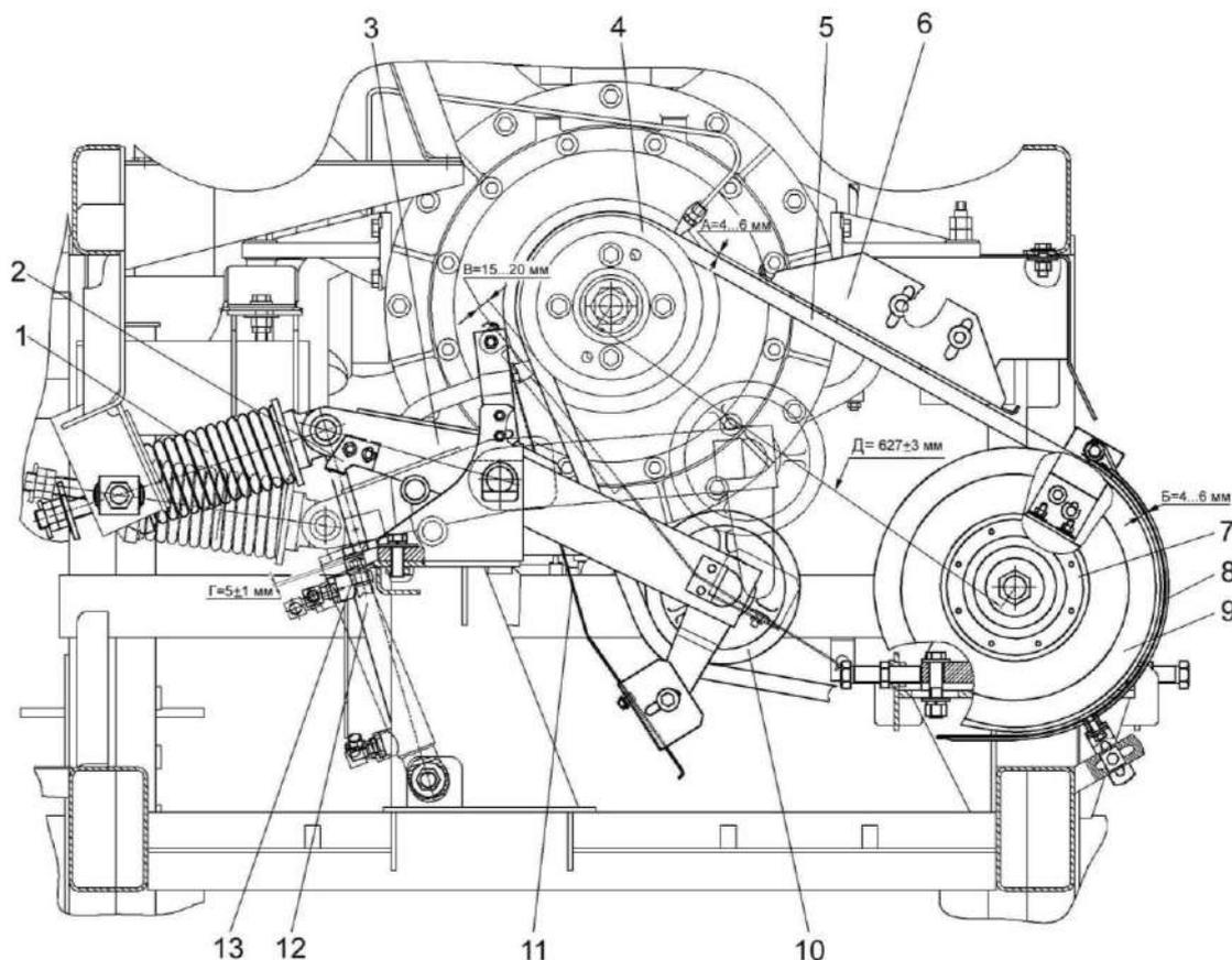
1 – пружина механизма натяжения; 2 – кронштейн; 3 - рычаг; 4 – шкив двигателя; 5 – ремень; 6 – пластина; 7 – контрпривод; 8 – ограждение; 9 – шкив контрпривода; 10 – натяжной шкив; 11 – щиток; 12 - гидроцилиндр; 13 – концевой выключатель
