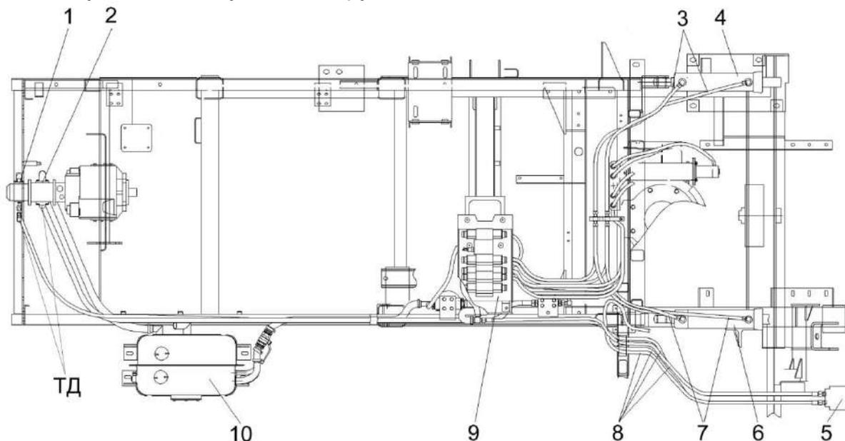
1 – насос шестеренный НШ 10-3Л; 2 – насос шестеренный НШ 25М-4; 3, 7, 8 – рукава высокого давления; 4, 6 – гидроцилиндры подъема (опускания) адаптеров; 5 – насос-дозатор; 9 – гидроблок; 10 – масляный бак; ТД – диагностические точки
