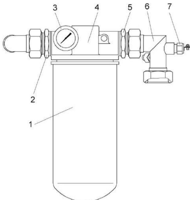
1 – фильтроэлемент; 2, 5 – штуцера; 3 – вакуумметр; 4 – головка фильтра; 6 – угольник; 7 - датчик сигнализатора температуры
