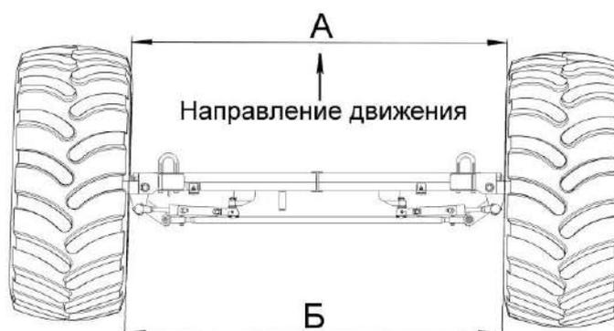
Рисунок 2.39 – Схема регулировки сходимости колес-
