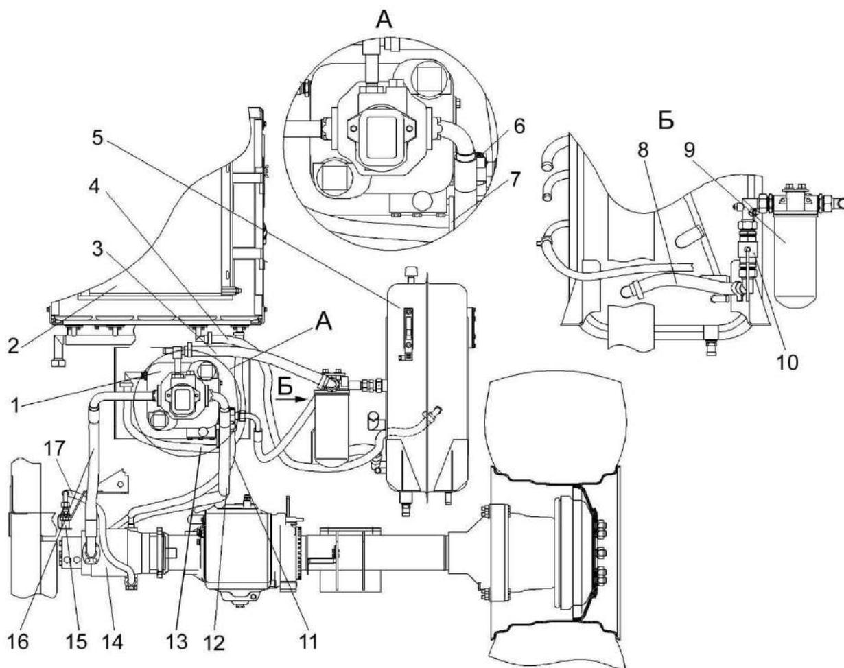
1 – гидронасос; 2 – масляный радиатор; 3, 8 – всасывающие рукава; 4, 11, 13 – сливные рукава; 5 – масляный бак; 6 – термодатчик; 7 – поворотный рычаг; 9 – фильтр всасывающий; 10 – запорный кран; 12, 16 – рукава высокого давления; 14 – гидромотор; 15 – заправочная муфта; 17 – заправочный рукав
