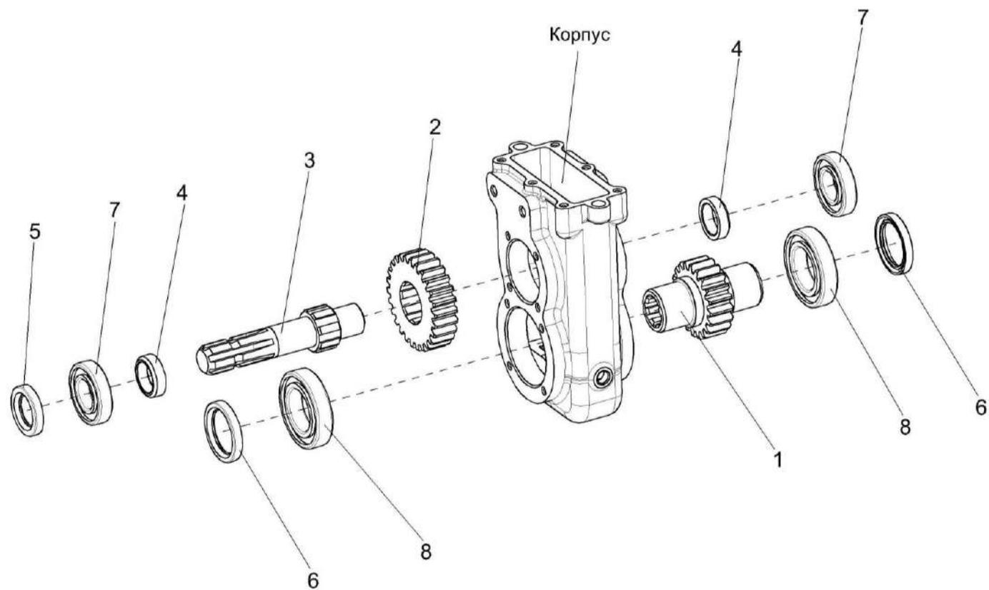
Рисунок 20 – Редуктор ПКК 0409000 (валы и шестерни)
