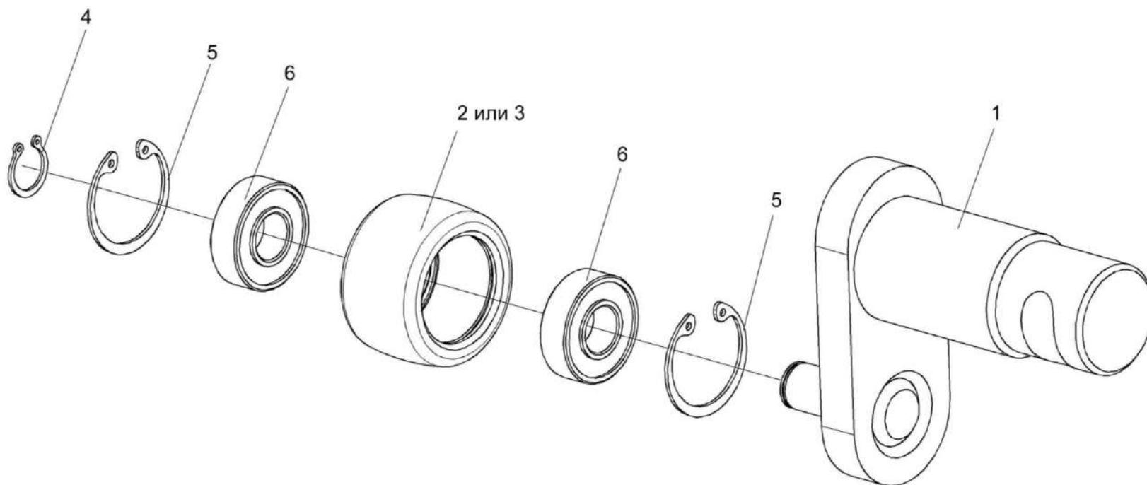
Рисунок 16 – Эксцентрик с роликом КВС-1-3903270-01
