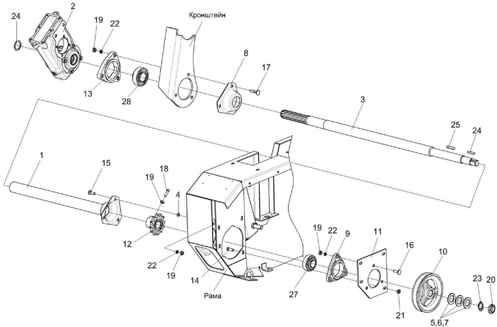
Рисунок 10 – Установка вала ПКК-1-0350601А
