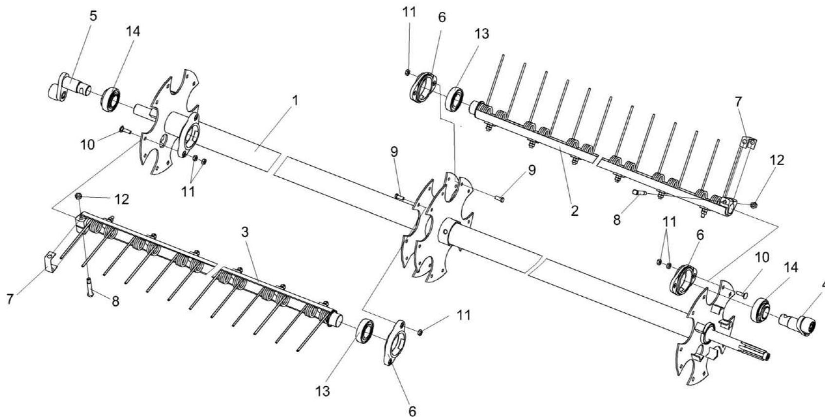
Рисунок 12 – Устройство подбирающее ПКК-1-0353100В
