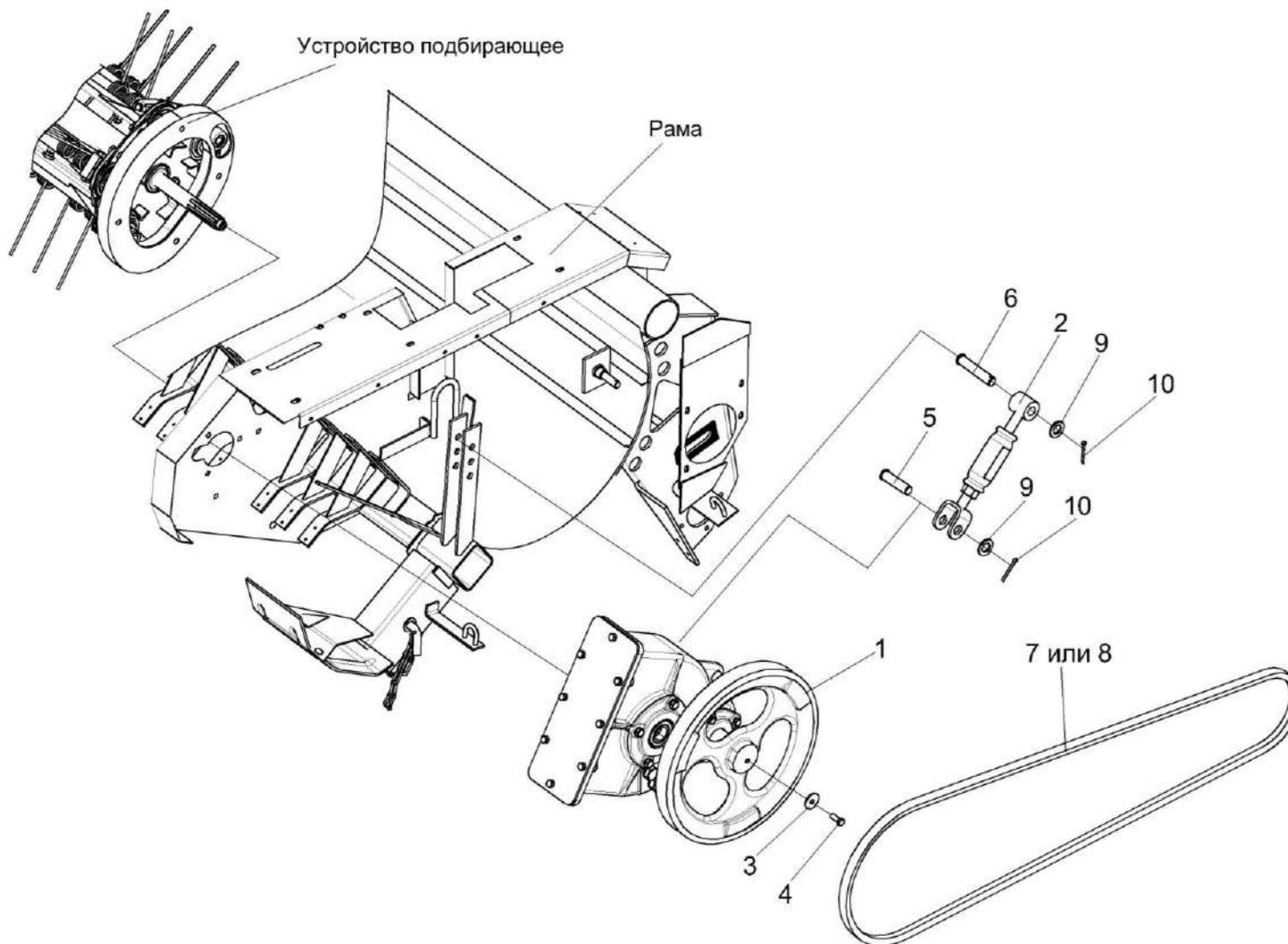
Рисунок 21 – Установка редуктора КИС 0904000Б
