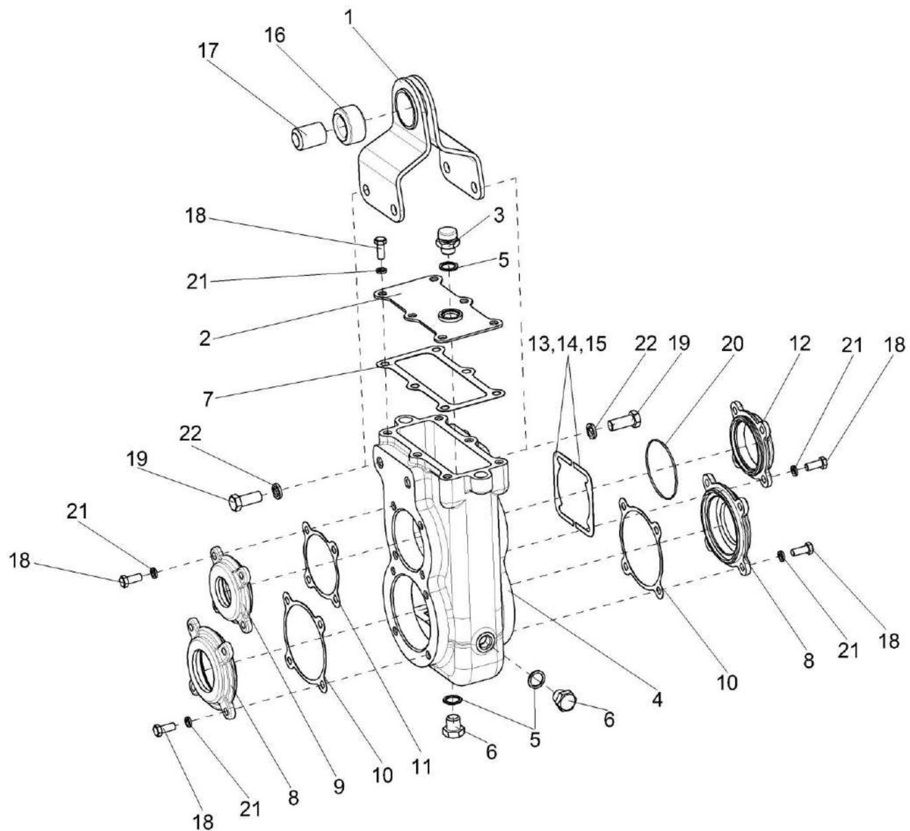
Рисунок 19 – Редуктор ПКК 0409000 (корпус и крышки)
