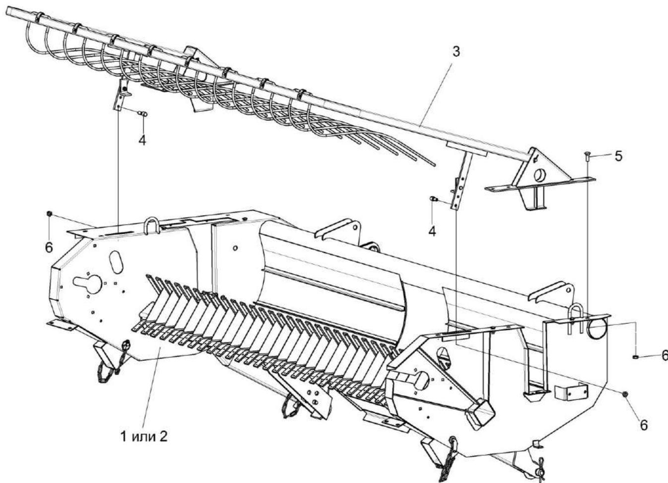
Рисунок 17 – Установка устройства прижимного ПКК-1-0354000Б
