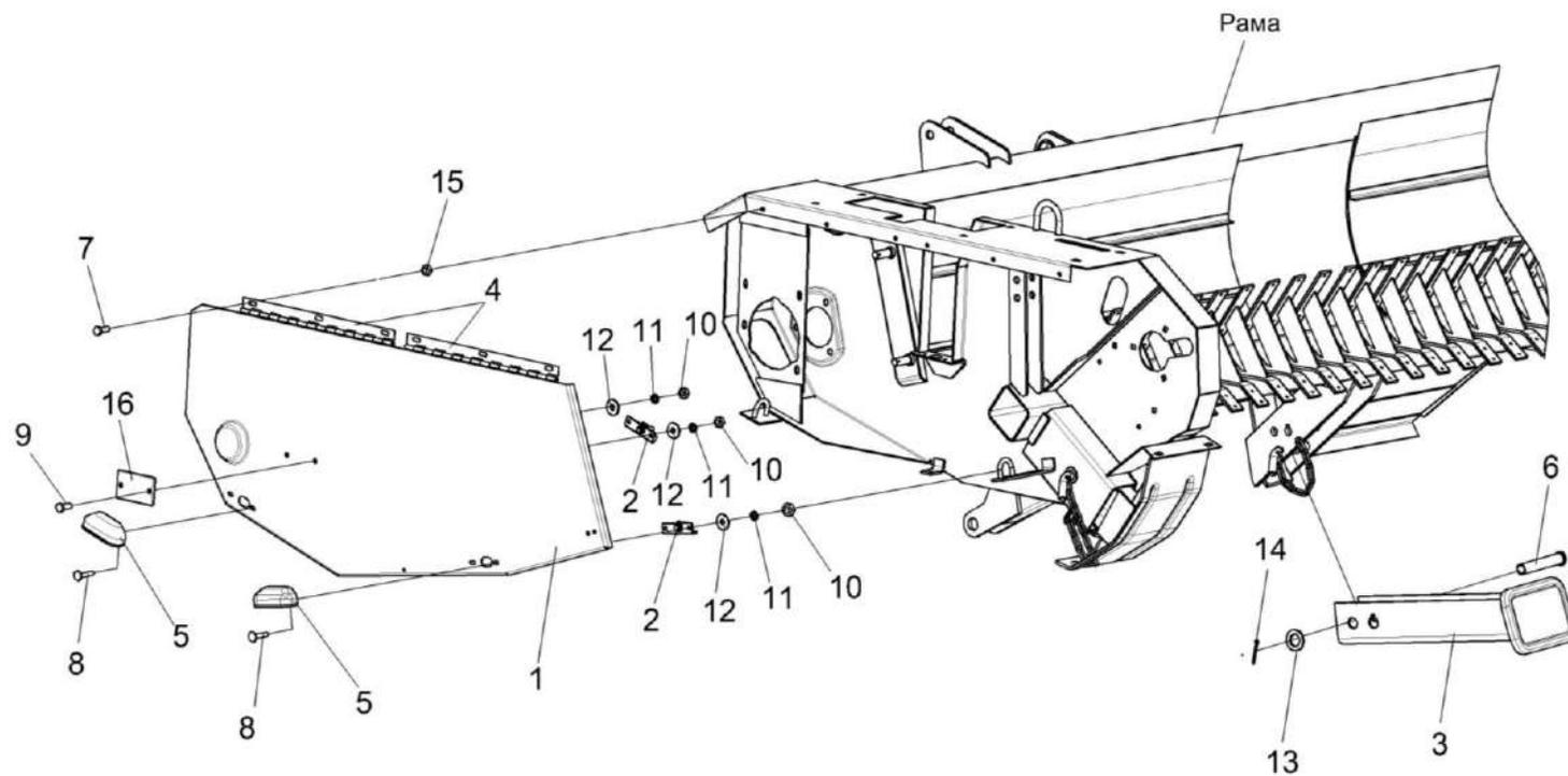
Рисунок 2 – Установка ограждения ПКК-1-0350220
