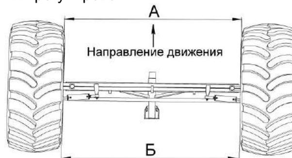
Рисунок 2.13 - Регулировка сходимости колес
