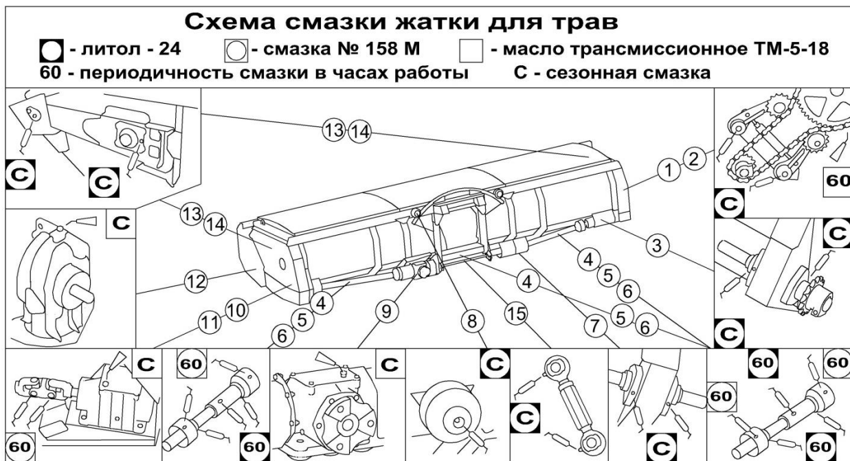
Рисунок 3.1 – Схема смазки жатки
