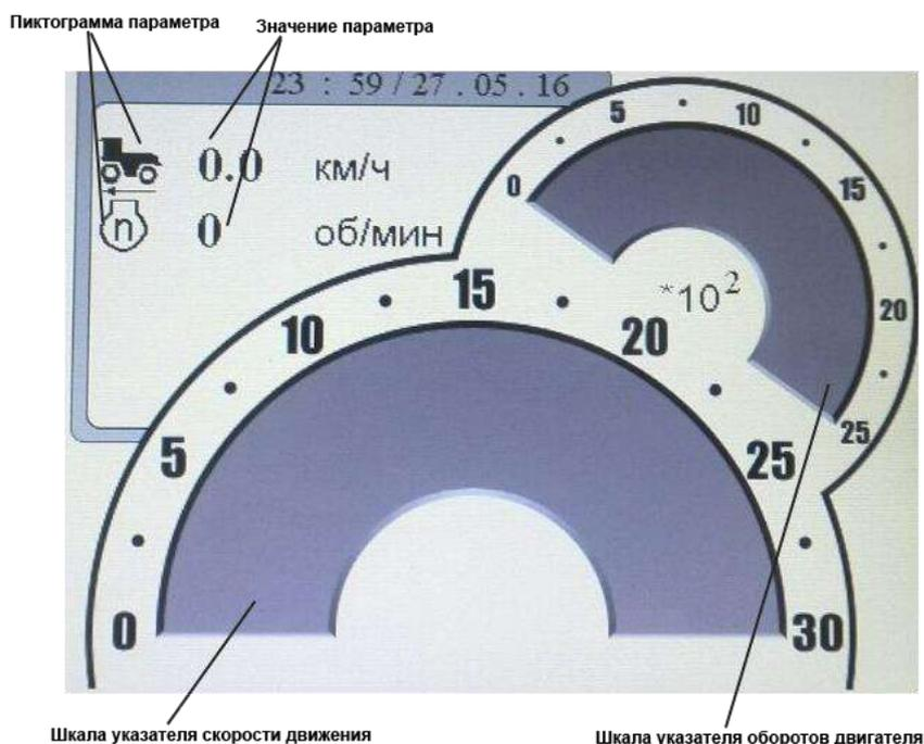
Рисунок Н.5 – Индикатор приборной панели
