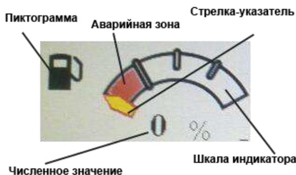
Рисунок Н.3 – Пример стрелочного индикатора
