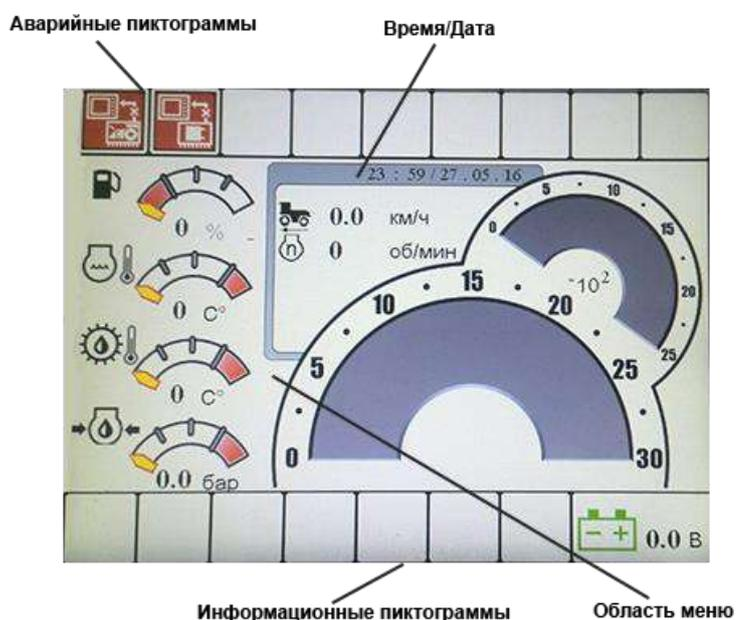
Рисунок Н.2 – Области на экране терминала
