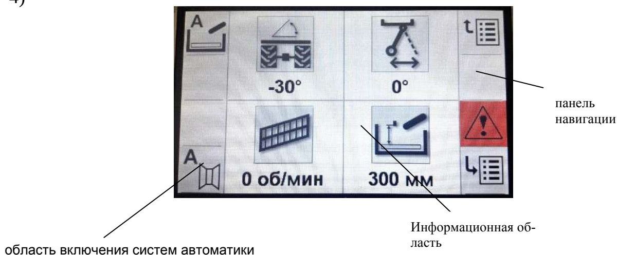
Рисунок Н.2 – Области на экране терминала
