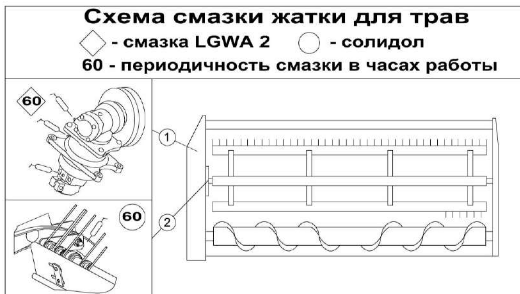
Рисунок 3.1 – Схема смазки жатки
