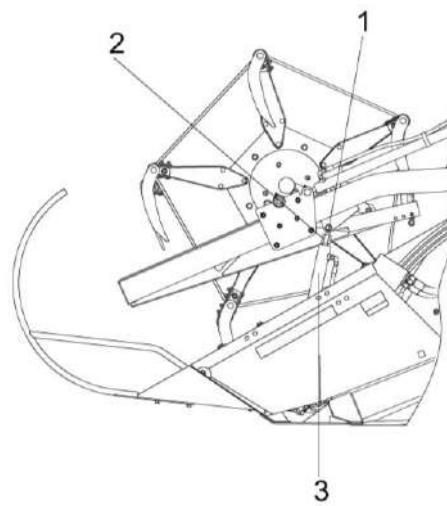
1 – проушина; 2 – гайка; 3 – гидроцилиндр
