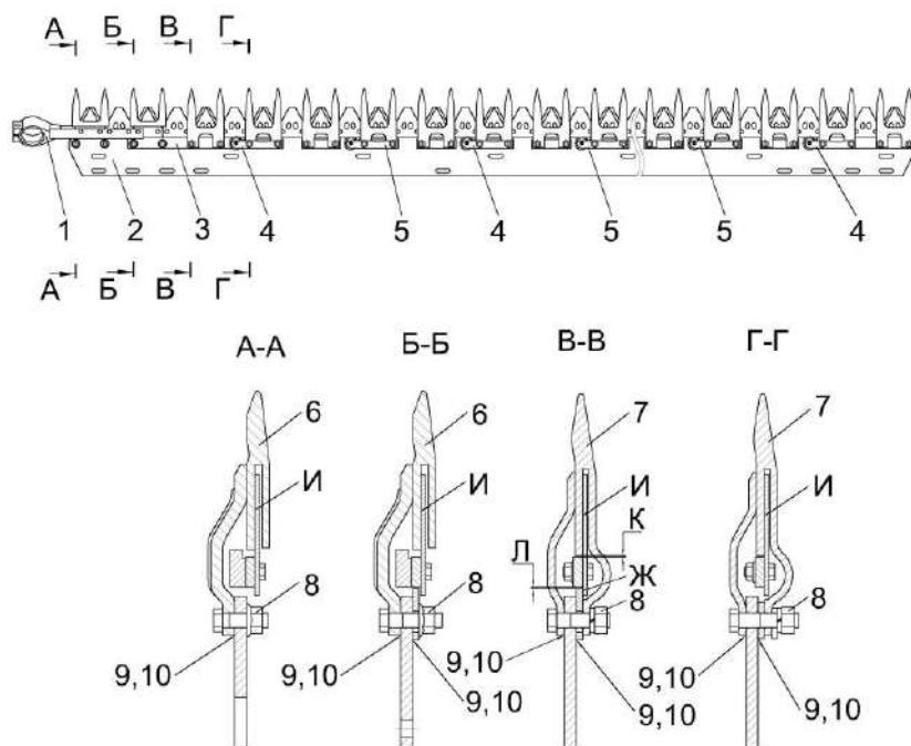
1 – нож; 2 – брус; 3 – пластины трения; 4 – ролик прижимной; 5 – ролик направляющий; 6 – пальцы направляющие сдвоенные; 7 – пальцы; 8 – гайки; 9 - регулировочные прокладки; 10 - прокладки
