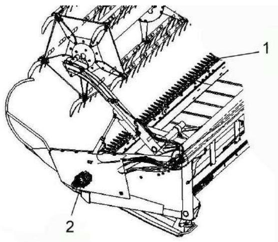
1 – режущий аппарат; 2 – привод режущего аппарата
