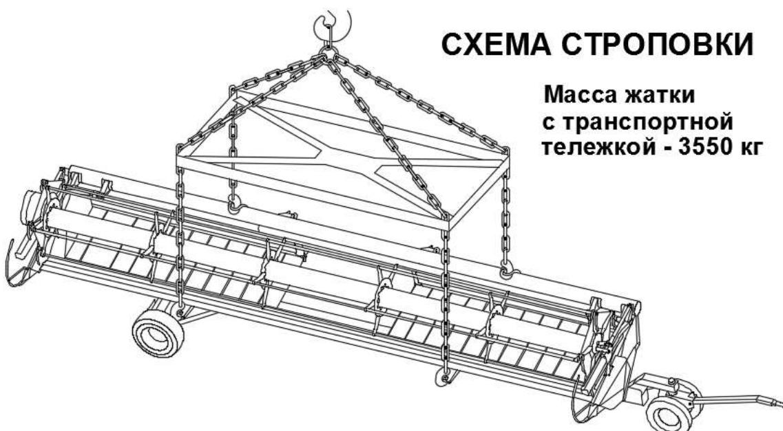
Рисунок 6.2 – Схема строповки жатки совместно с транспортной тележкой
