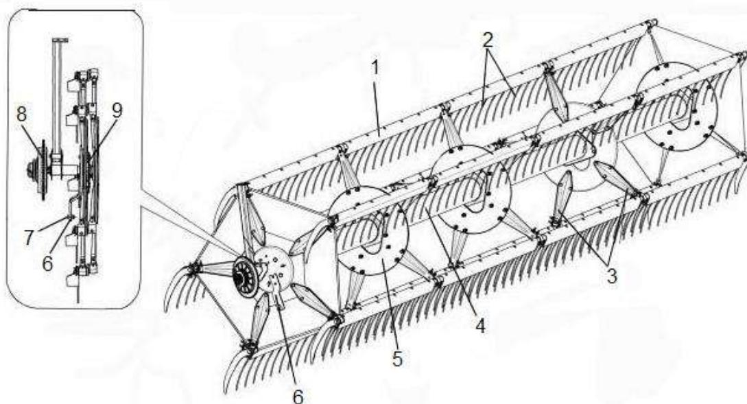
1 – граблина; 2 – зуб; 3 – луч; 4 – вал мотовила; 5 – диск; 6 – поводок; 7 – ролик; 8 – приводная звездочка с предохранительной муфтой; 9 – эксцентриковый механизм
