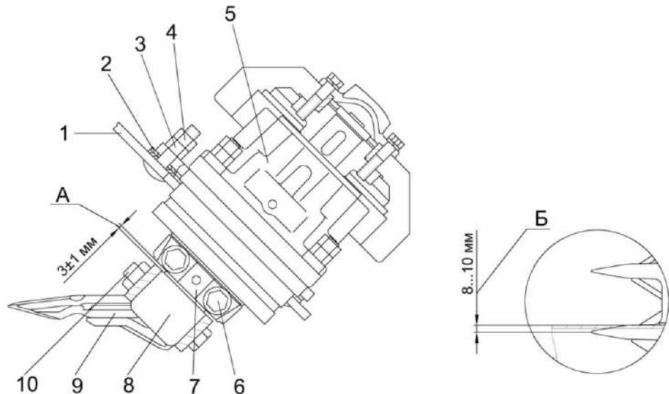
1 – плита рамы; 2 - набор прокладок; 3 - гайка; 4 - контргайка; 5 – привод ножа; 6 – винты; 7 - водило; 8 - головка ножа; 9 - режущий аппарат; 10 - болт
