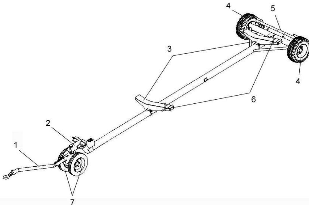
1 – дышло; 2 – ось передняя; 3 – лонжероны; 4, 7 – колеса; 5 – балка габаритная; 6 – фиксаторы
