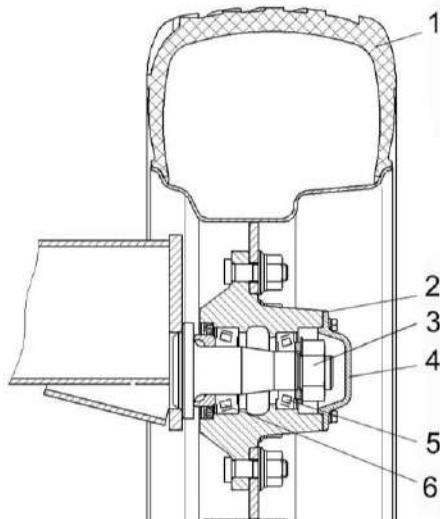
1 – колесо; 2 – прокладка; 3 – гайка; 4 – крышка ступицы; 5, 6 - подшипники
