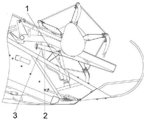
1 – гидроцилиндр подъема мотовила; 2 – упор; 3 – палец-фиксатор
