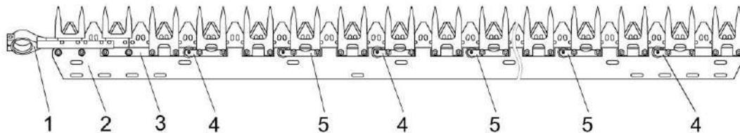
1 – нож; 2 – брус; 3 – пластина трения; 4 – ролик прижимной; 5 – ролик направляющий
