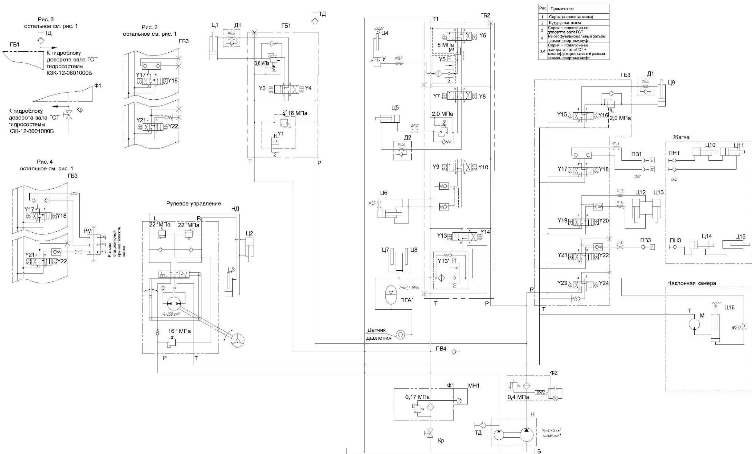
Б – бак масляный; ГБ1, ГБ2, ГБ3 – гидроблоки; Д1, Д2 – дроссели с обратным клапаном; Кр – кран шаровой ММ рычажный У 32; У – устройство для подвода масла; МН1 – манометр; М - гидромотор; НД – насос-дозатор; Н – насос шестеренный; ПВ1...ПВ3 – штекер; ПВ4 - полумуфта внутренняя; ПГА1 – пневмогидроаккумулятор; ПН1...ПН3 – муфта; ТД – точки диагностики; Ф1 – фильтр; Ф2 – фильтр напорный
