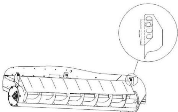
Рисунок 2.12 – Регулировка ограждения над горизонтальным шнеком бункера
