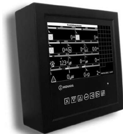
Рисунок Ж.1 – Бортовой компьютер «ВулКан-04»
