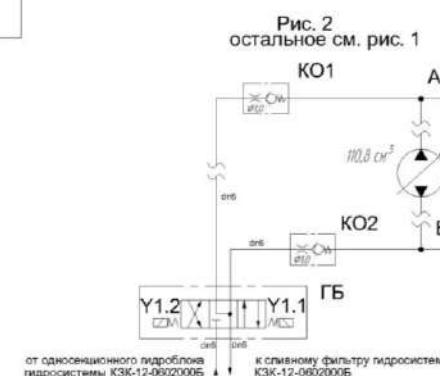
АТ – масляная секция радиатора; Б – бак масляный; ГБ – гидроблок; КО1, КО2 – дроссель с обратным клапаном; КП – гидроклапан обратный; МА – гидромотор аксиально-поршневой нерегулируемый; НА – насос аксиально-поршневой регулируемый; ПВ – полумуфта внутренняя; Т1 – датчик ДУТЖ-01; Т2 - датчик аварийной температуры жидкости ДАТЖ-04; МУ – указатель уровня масла; Ф – фильтр
