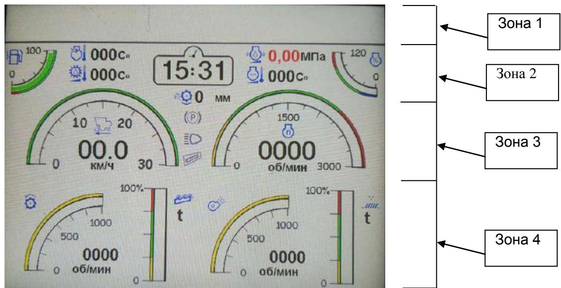
Рисунок И.3 – Экран технологического режима уборки (комбайнирования)
