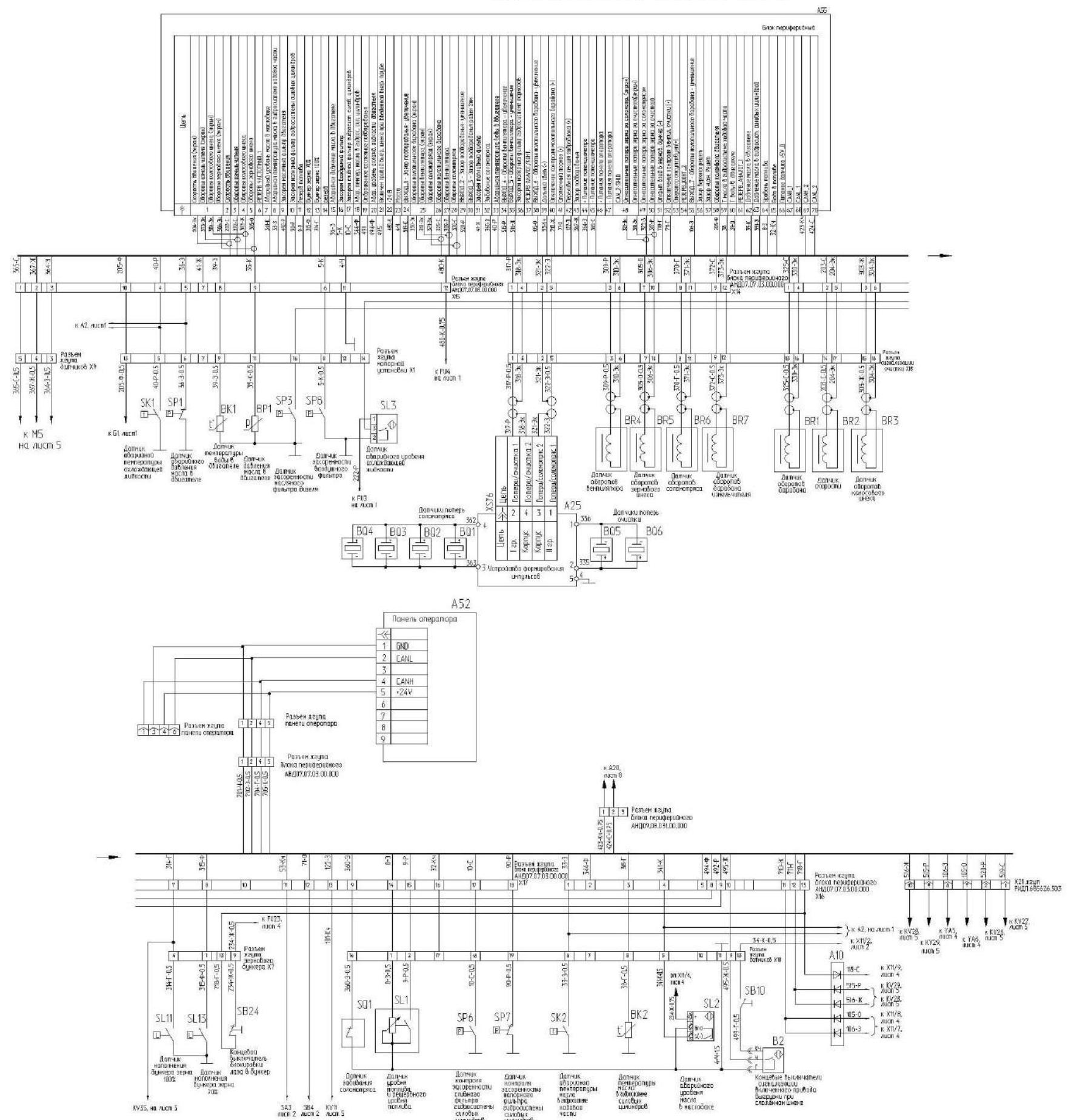
Рисунок Б.7 – Схема электрическая принципиальная комбайна (лист 7)
