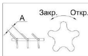
Жалюзи решет в закрытом положении должны свободно, без напряжения прилегать друг к другу. Не допускается прилагать усилия на маховике для закрытия жалюзи. Размеры зазоров внесены в таблицу 2.3.
