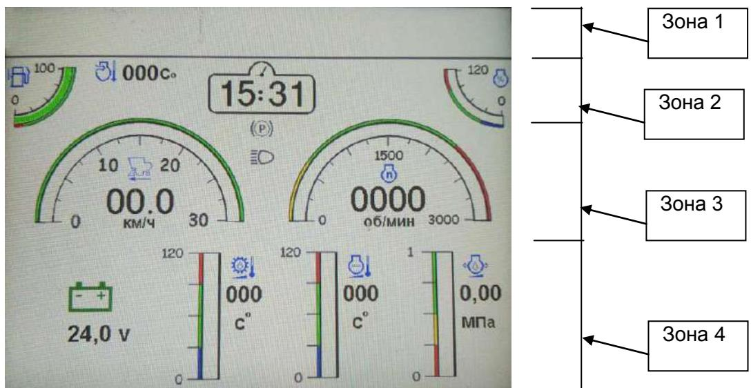
Рисунок И.4 – Экран транспортного режима
