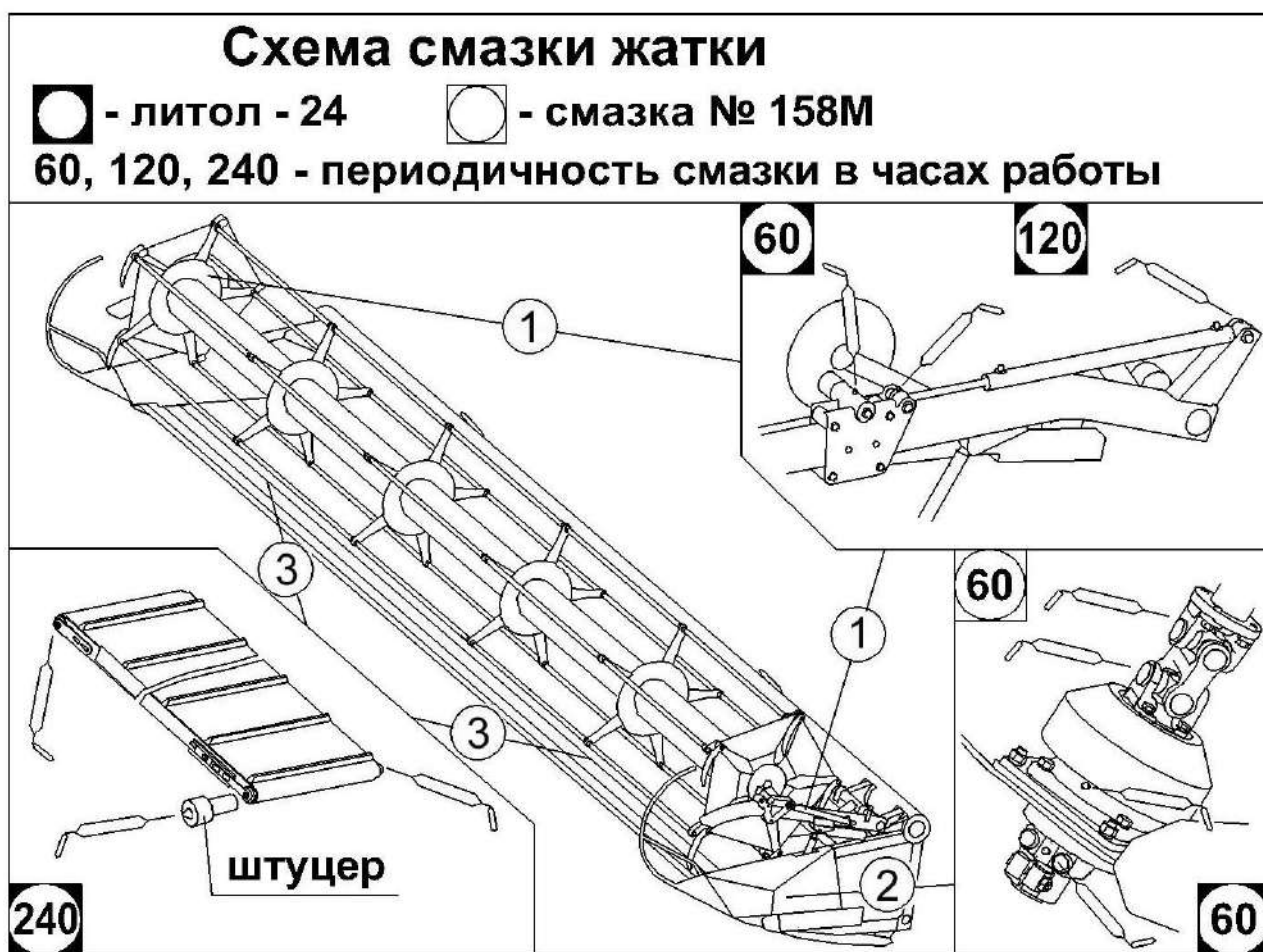
Рисунок 3.3 – Схема смазки жатки
