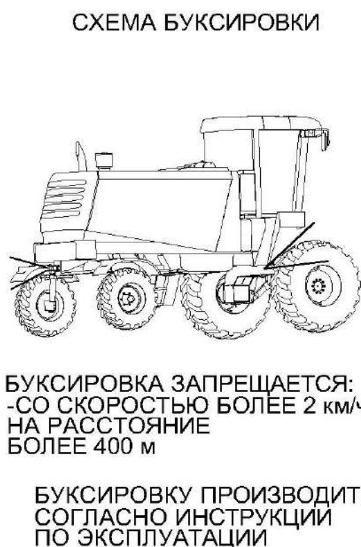
Рисунок 6.1 – Схемы строповки и буксировки самоходной части косилки
