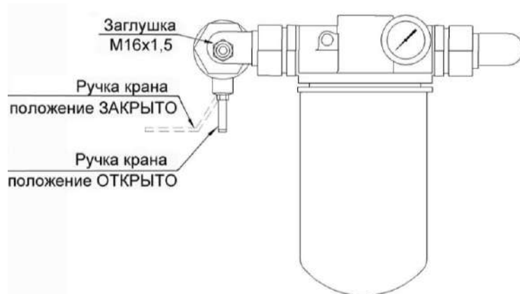
Рисунок 6.6 - Место подсоединения к заглушке на фильтре
