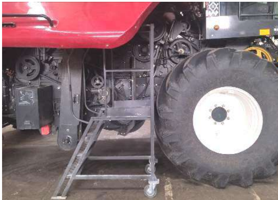
Рисунок 3.5 – Лестница с площадкой для заправки насоса АЦСС
