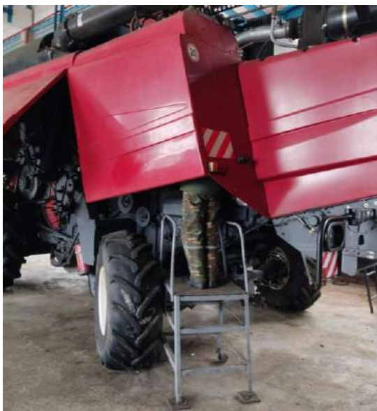
Рисунок 3.10 – Вид на лестничную площадку с механизатором при замене сливного и напорного фильтроэлементов
