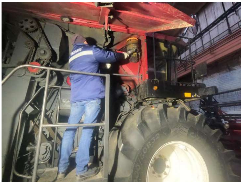
Рисунок 3.5 – Лестница с площадкой для заправки насоса АЦСС
