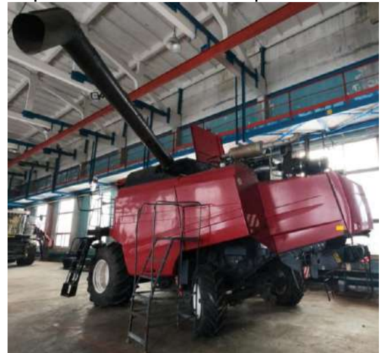
Рисунок 3.13 – Вид на трубу выгрузного шнека повернутую на угол не менее 50°
