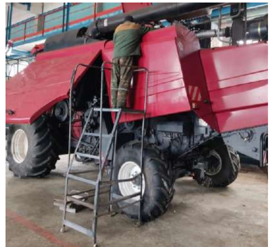
Рисунок 3.14 – Вид на лестничную площадку с механизатором при замене всасывающего фильтроэлемента
