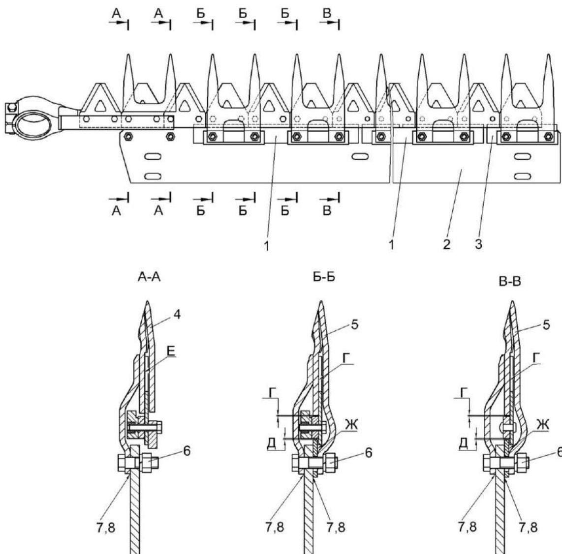
1, 3 – пластины трения; 2 – брус; 4 – палец направляющий сдвоенный; 5 – палец сдвоенный; 6 – гайка; 7 – регулировочная прокладка; 8 – прокладка
