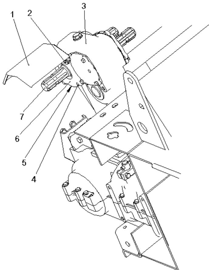
1 – щиток; 2 – болт М8х30 с увеличенной шайбой и гроверной шайбой; 3 – редуктор привода адаптеров; 4 – болт М8х25 с гроверной шайбой; 5 – прокладка; 6 – сквозная крышка; 7 – вал-шестерня с двумя хвостовиками
