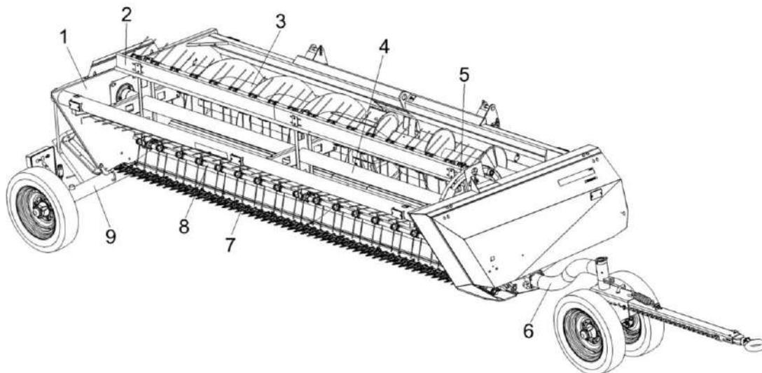
1 – рама; 2 – планка мотовила; 3 – шнек; 4 – мотовило; 5 – дорожка направляющая; 6 – тележка передняя; 7 – режущий аппарат; 8 – граблины; 9 – тележка транспортная задняя
