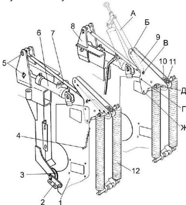
1 – ловитель рамы комбайна; 2 – накладка; 3 – ролик; 4 – фиксатор транспортного положения; 5 - пальцы; 6 – гидроцилиндр; 7 – тяга; 8 – кронштейн рамы навески; 9 – рычаг механизма вывешивания; 10 – серьга; 11 – регулировочный болт; 12 – пружина
