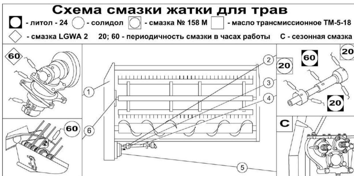
Рисунок 3.1 – Схема смазки жатки для трав
