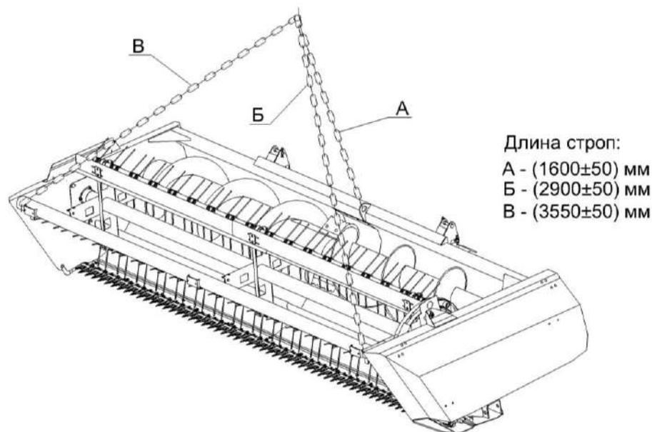
Рисунок 8.1 – Схема строповки
