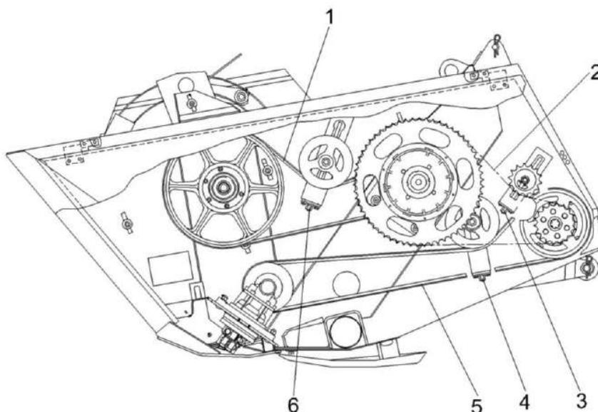
1 – ременная передача привода мотовила; 2 – цепная передача привода шнека; 3, 4, 6 – винты; 5 – ременная передача привода режущего аппарата
