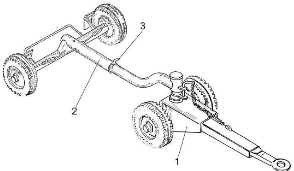
1 – передняя тележка; 2 – задняя тележка; 3 – фиксатор
