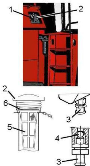
1 – заливная горловина; 2 – крышка; 3 – сливной штуцер; 4 – шарик; 5 – сетка; 6 – пружина
