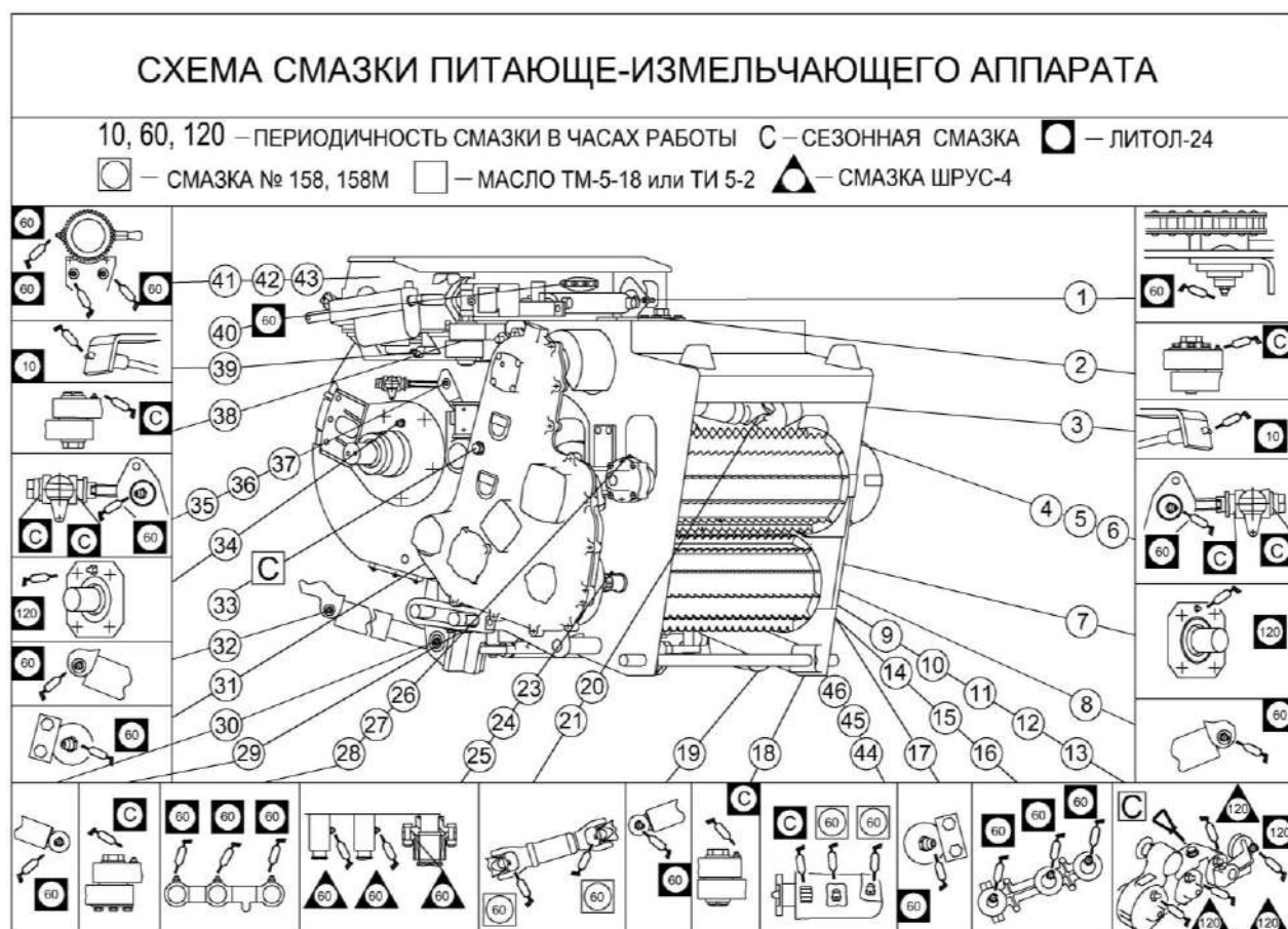
Рисунок 3.11 – Схема смазки питающе-измельчающего аппарата комбайна
