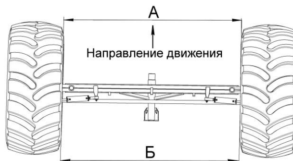
Рисунок 2.17 - Регулировка сходимости колес
