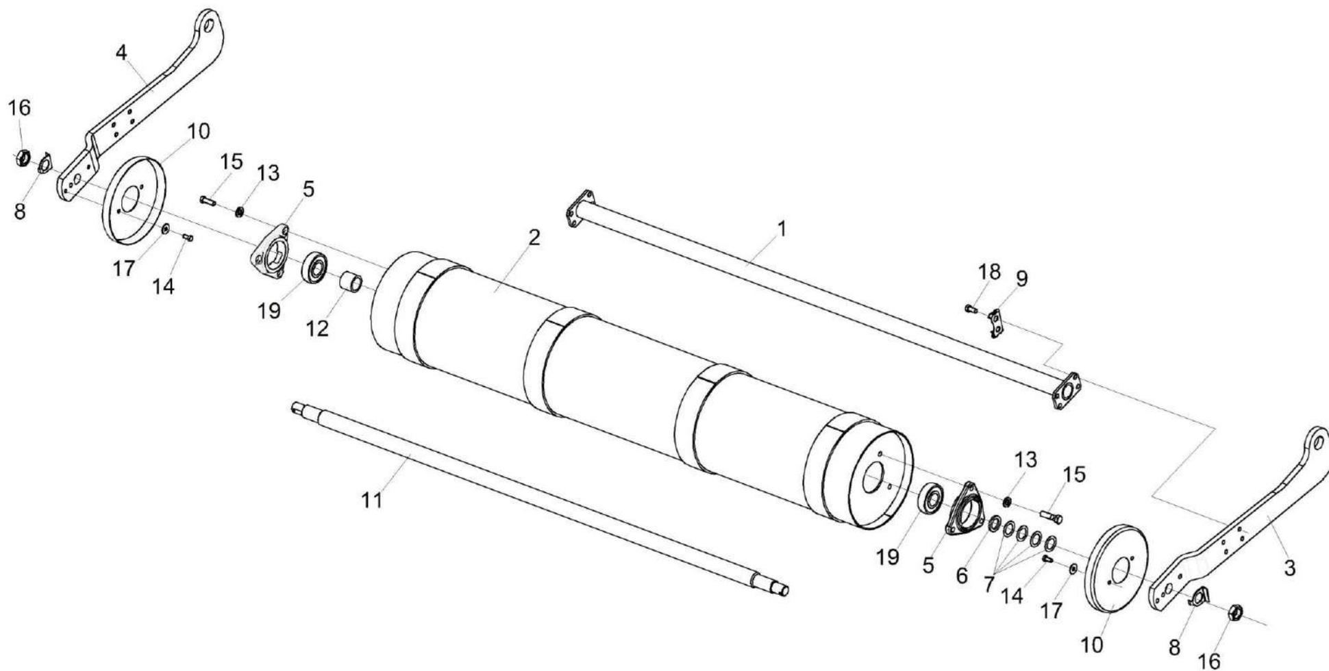
Рисунок 16 – Вал нижний КЗК-12-1836000Б
