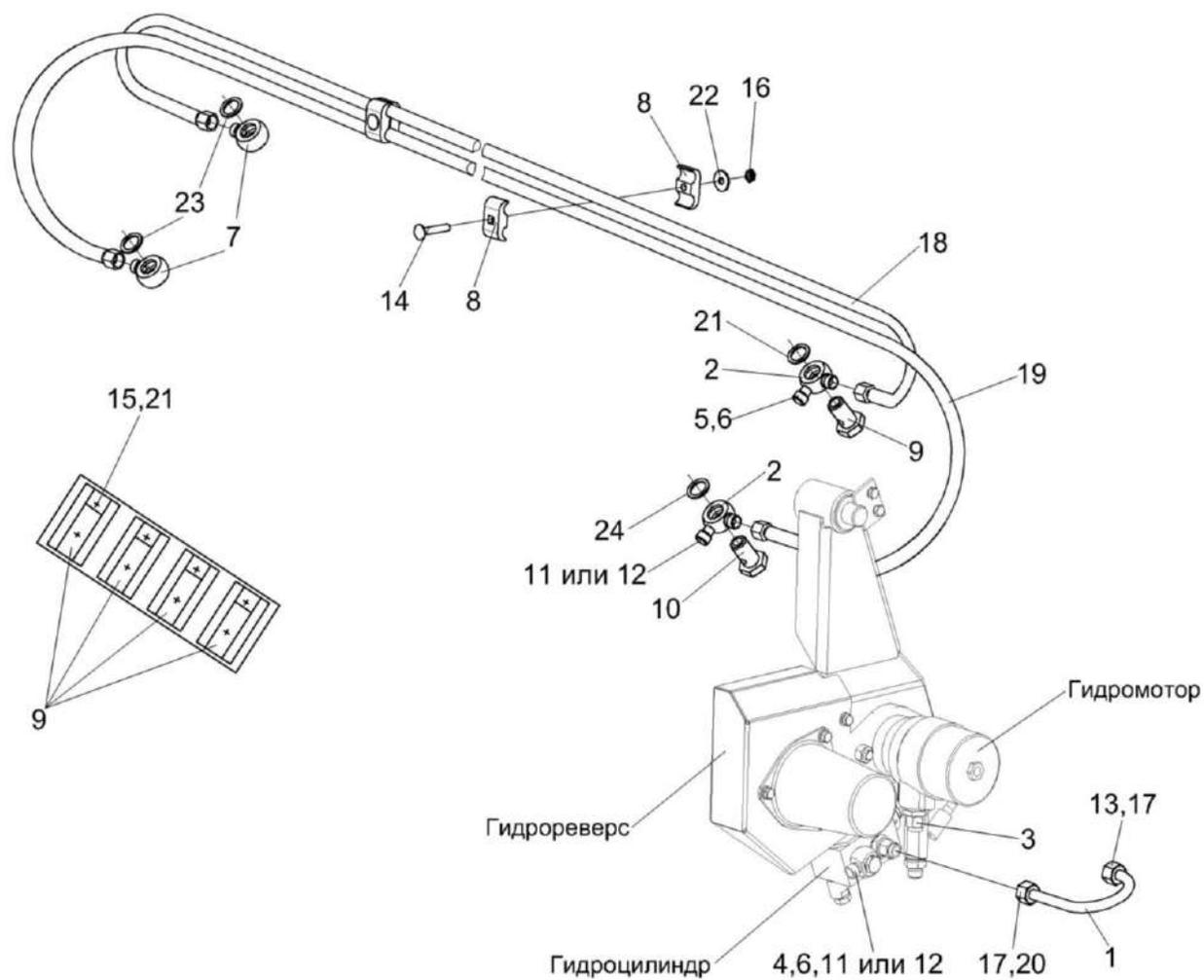
Рисунок 22 – Система гидравлическая камеры наклонной КЗК-12-1790000А-01
