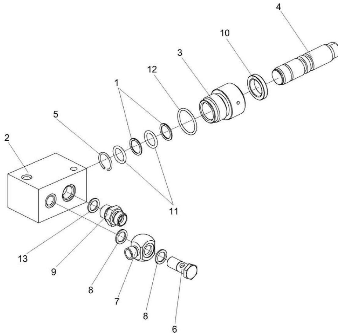
Рисунок 12 – Гидроцилиндр КЗК-12-1790200А
