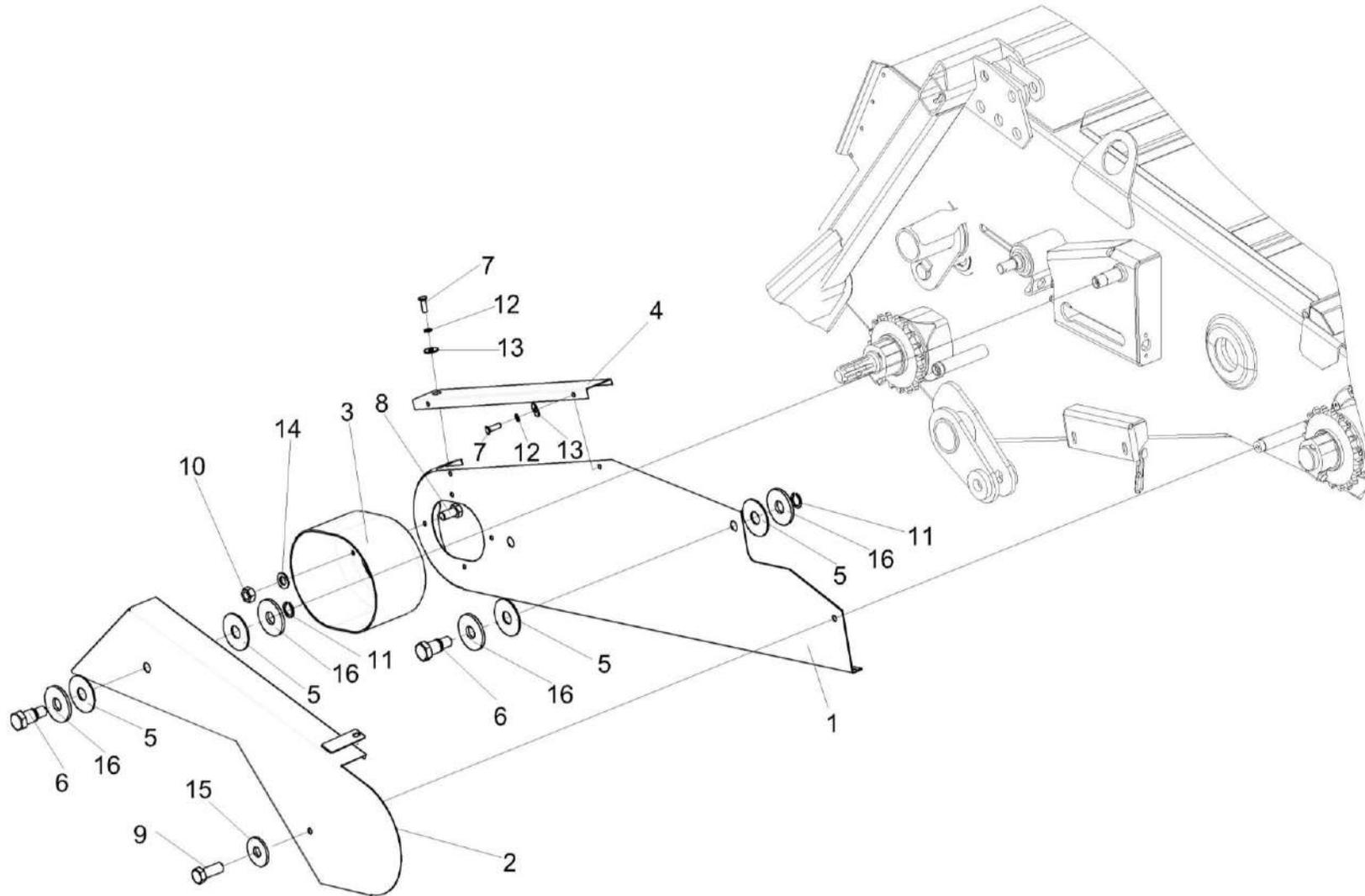
Рисунок 9 – Установка ограждений КЗК-12-1800140 и КЗК-12-1810160
