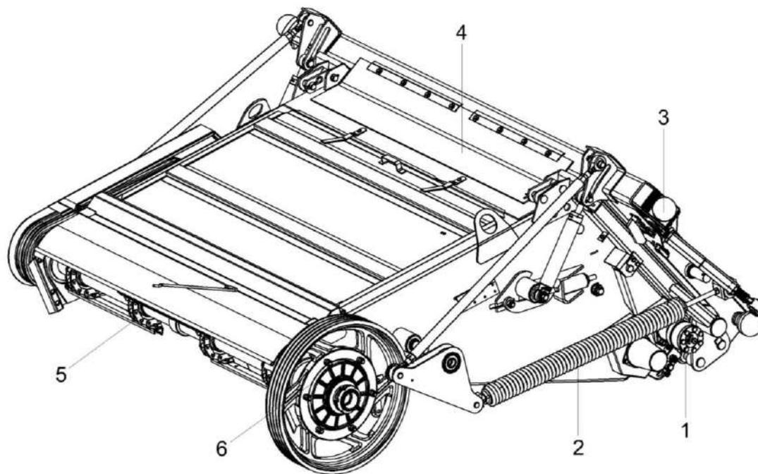
Рисунок 1 – Камера наклонная КЗК-12-1820000-03 (общий вид)
