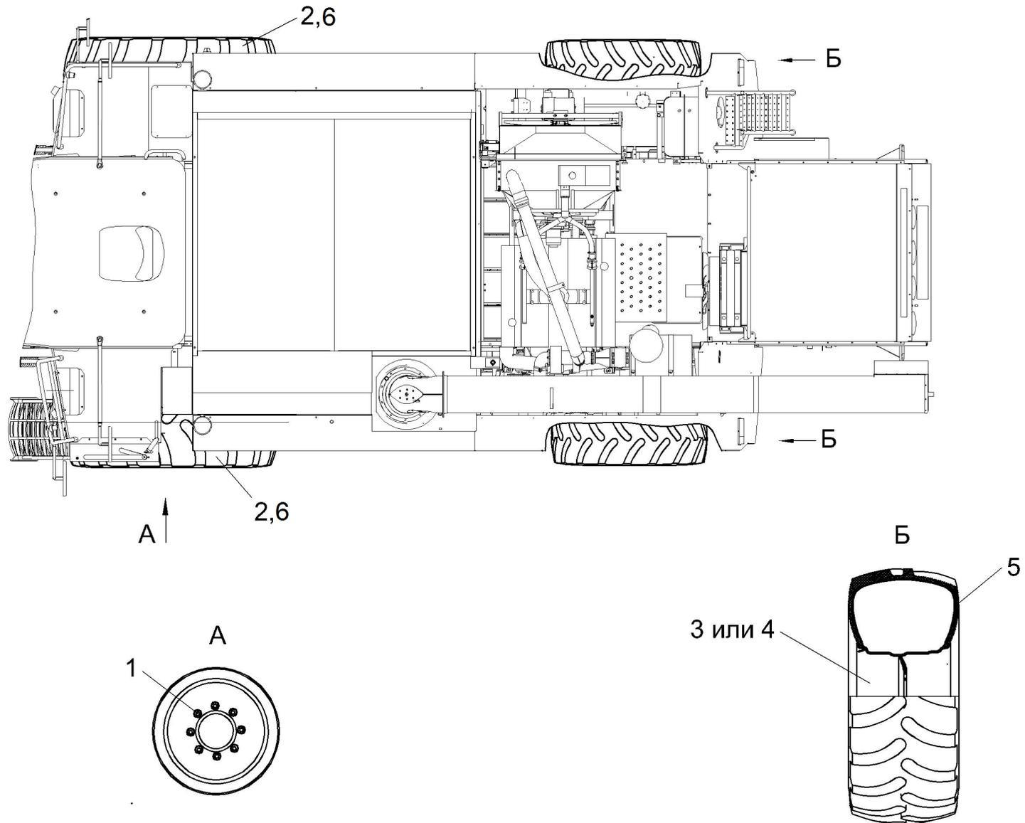
Рисунок 2 – Установка колес КЗК-10-0111100-02
