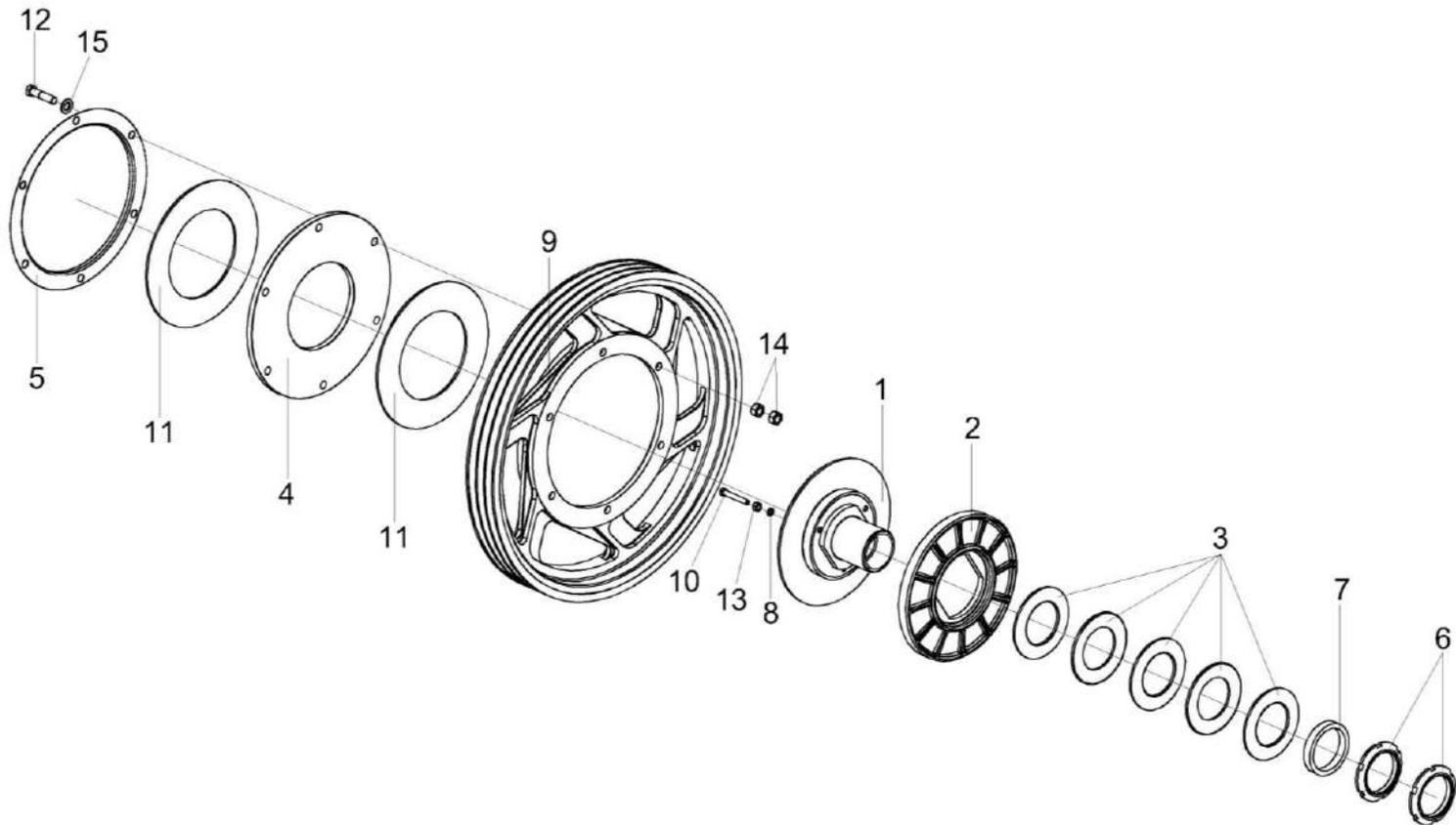
Рисунок 8 – Муфта предохранительная КЗК-12А-1-1803090-01
