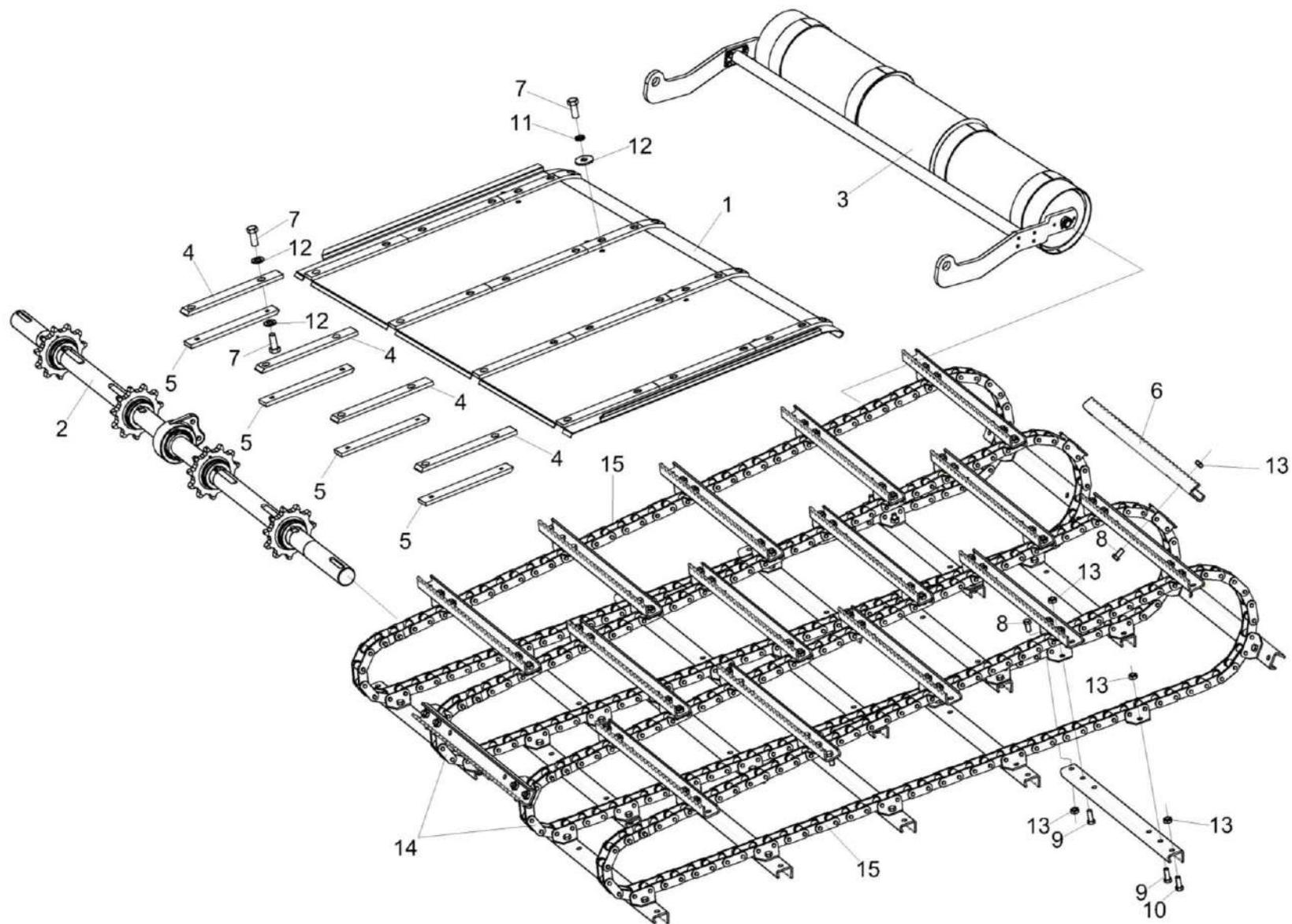
Рисунок 4 – Установка транспортера КЗК-12-1807200
