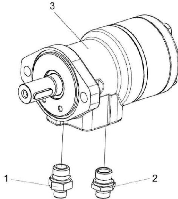
Рисунок 13 – Гидромотор КЗК-12-1790990А
