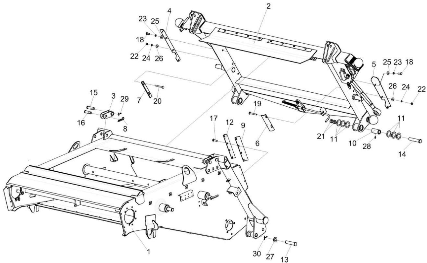
Рисунок 18 – Установка рамки переходной КЗК-12-1828000
