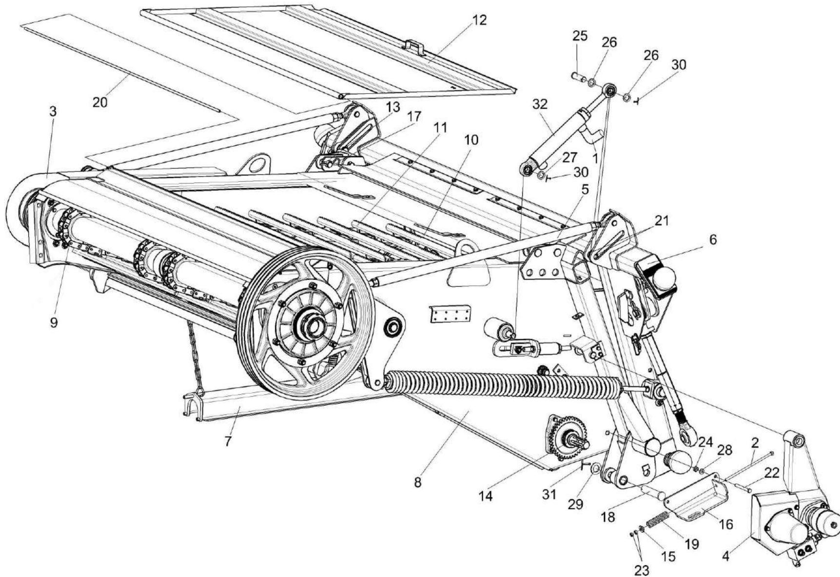
Рисунок 2 – Камера наклонная КЗК-12-1820000-03
