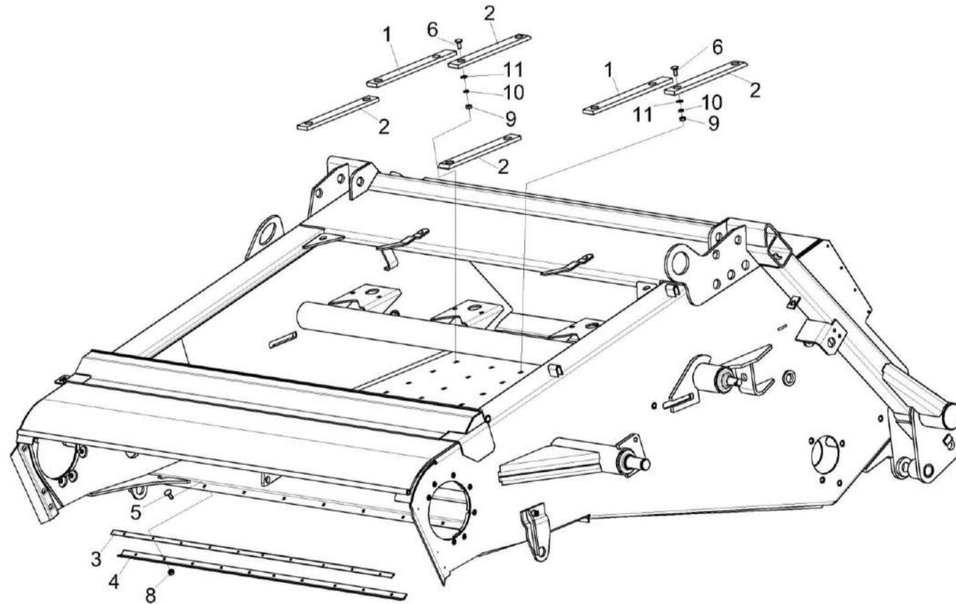
Рисунок 3 – Установка накладок и уплотнения
