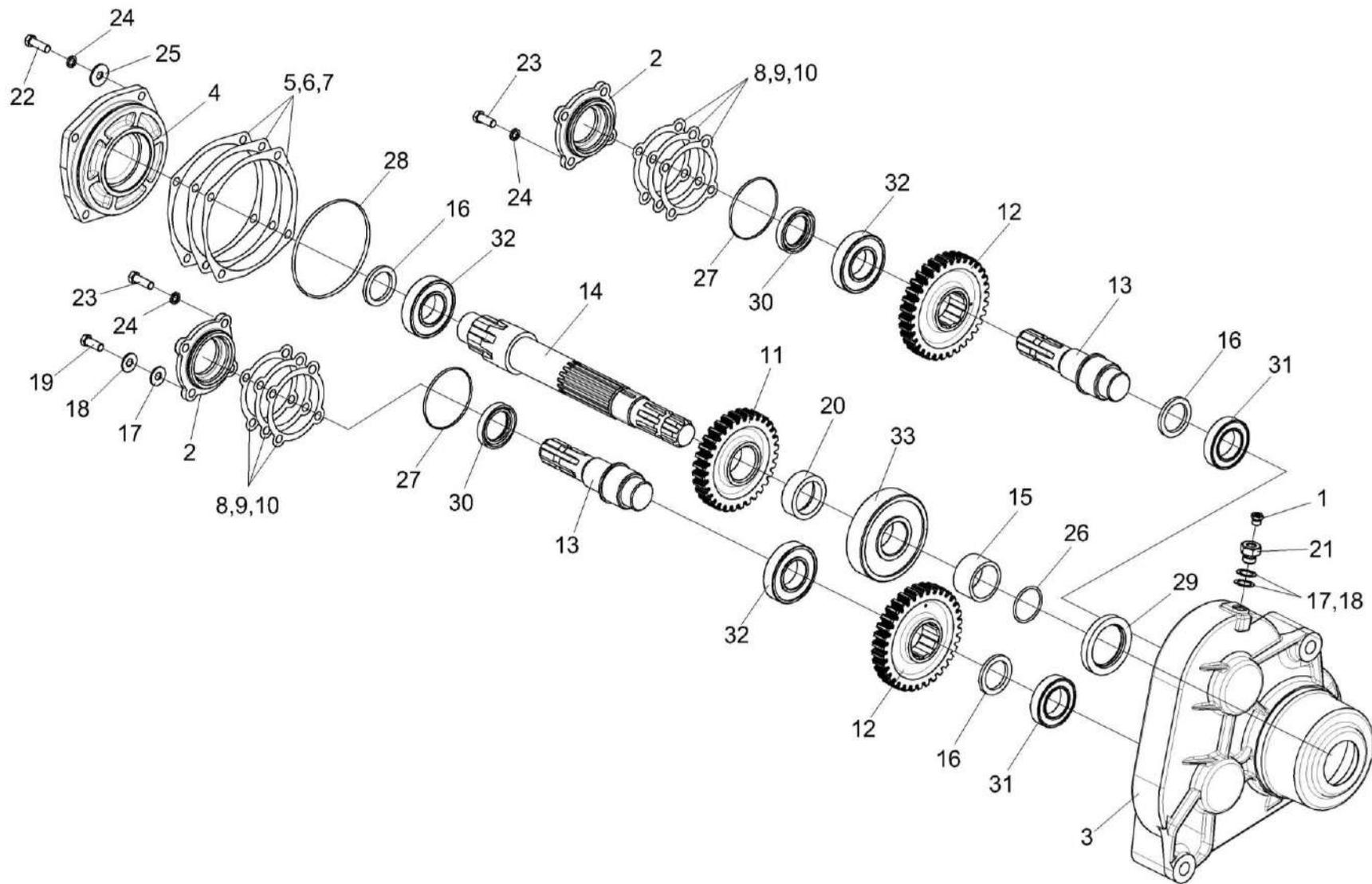
Рисунок 30 – Редуктор КПП 0508000
