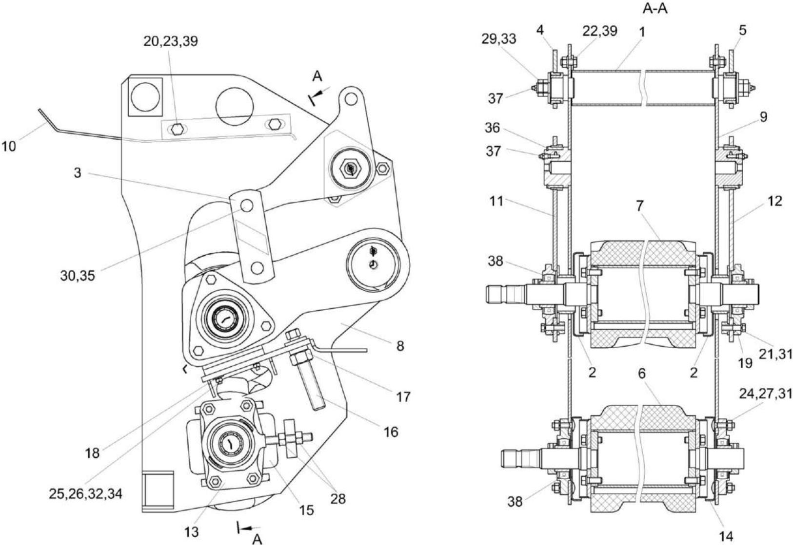
Рисунок 12 – Аппарат плющильный КПП 0107300А
