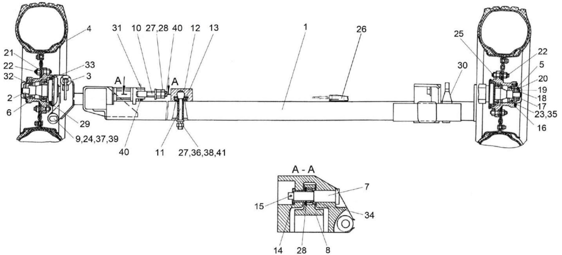
Рисунок 8 – Колесный ход КПП 0108000
