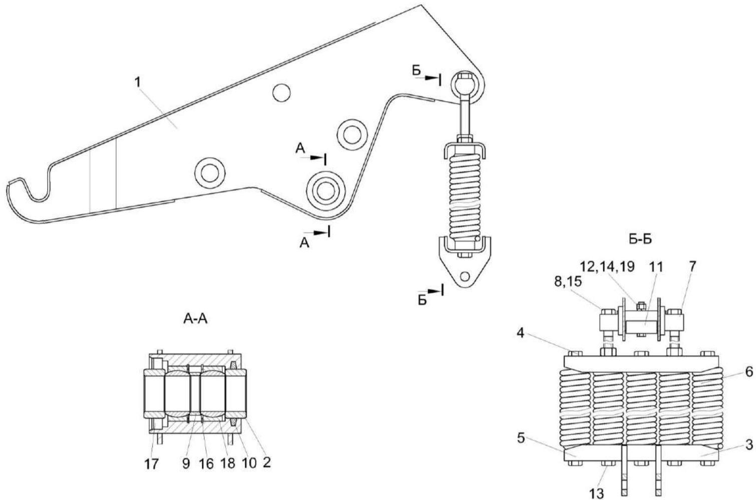
Рисунок 10 – Механизм навески КПП 0105000Б
