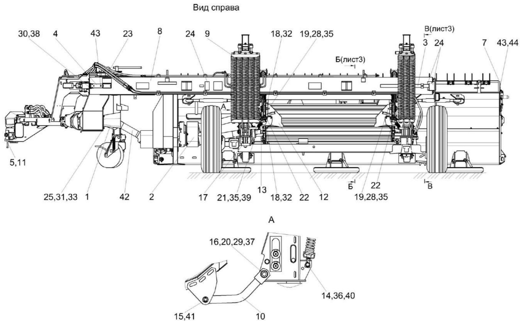
Рисунок 2 – Косилка-плющилка прицепная КПП-4,2 КПП 0000000 (лист 2)
