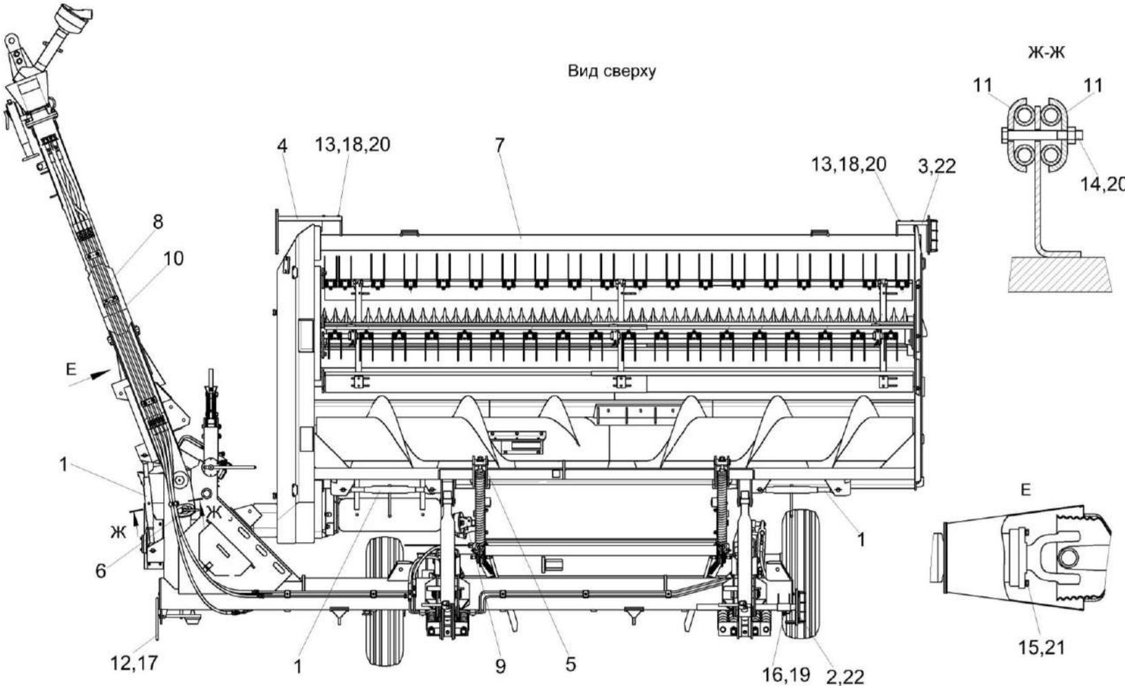
Рисунок 4 – Косилка-плющилка прицепная КПП-4,2 КПП 0000000 (лист 4)
