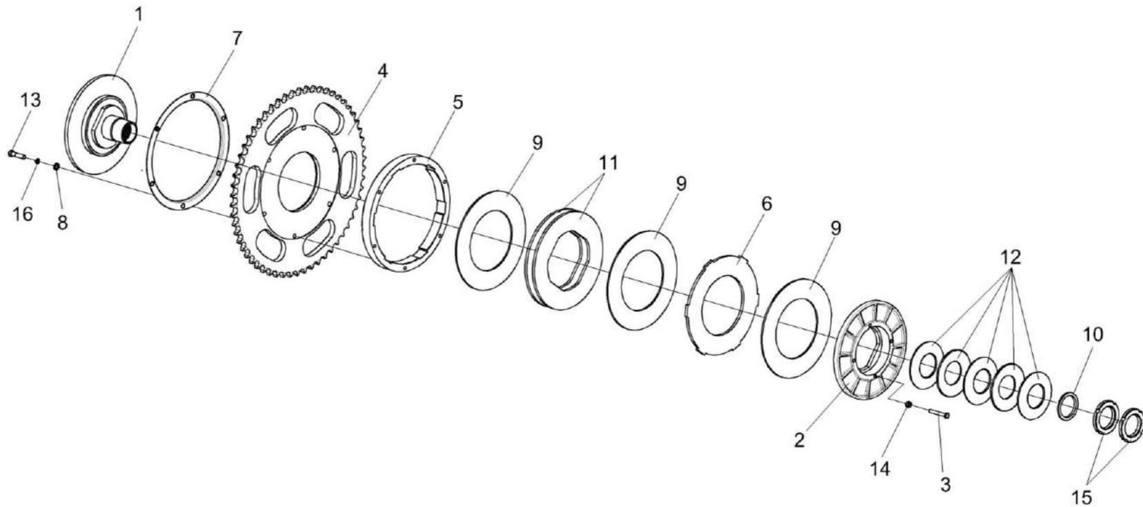
Рисунок 39 – Муфта предохранительная КГК 1202100-02
