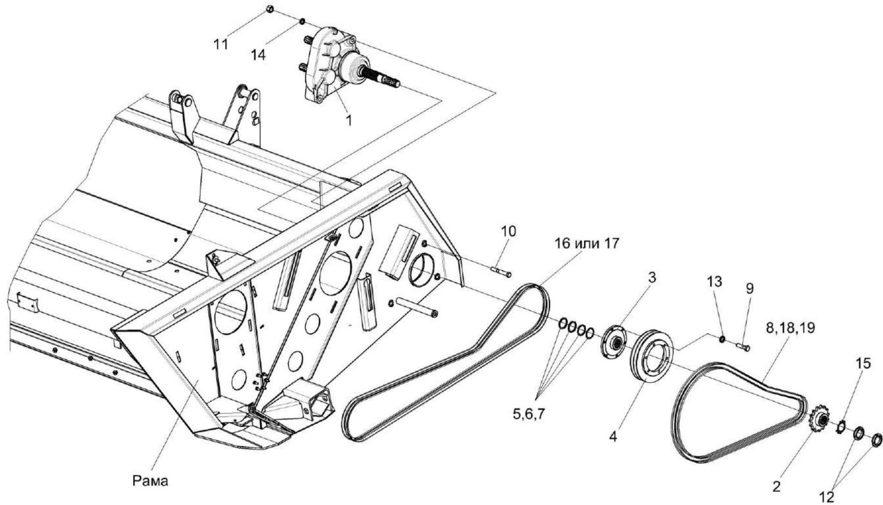
Рисунок 29 – Установка редуктора
