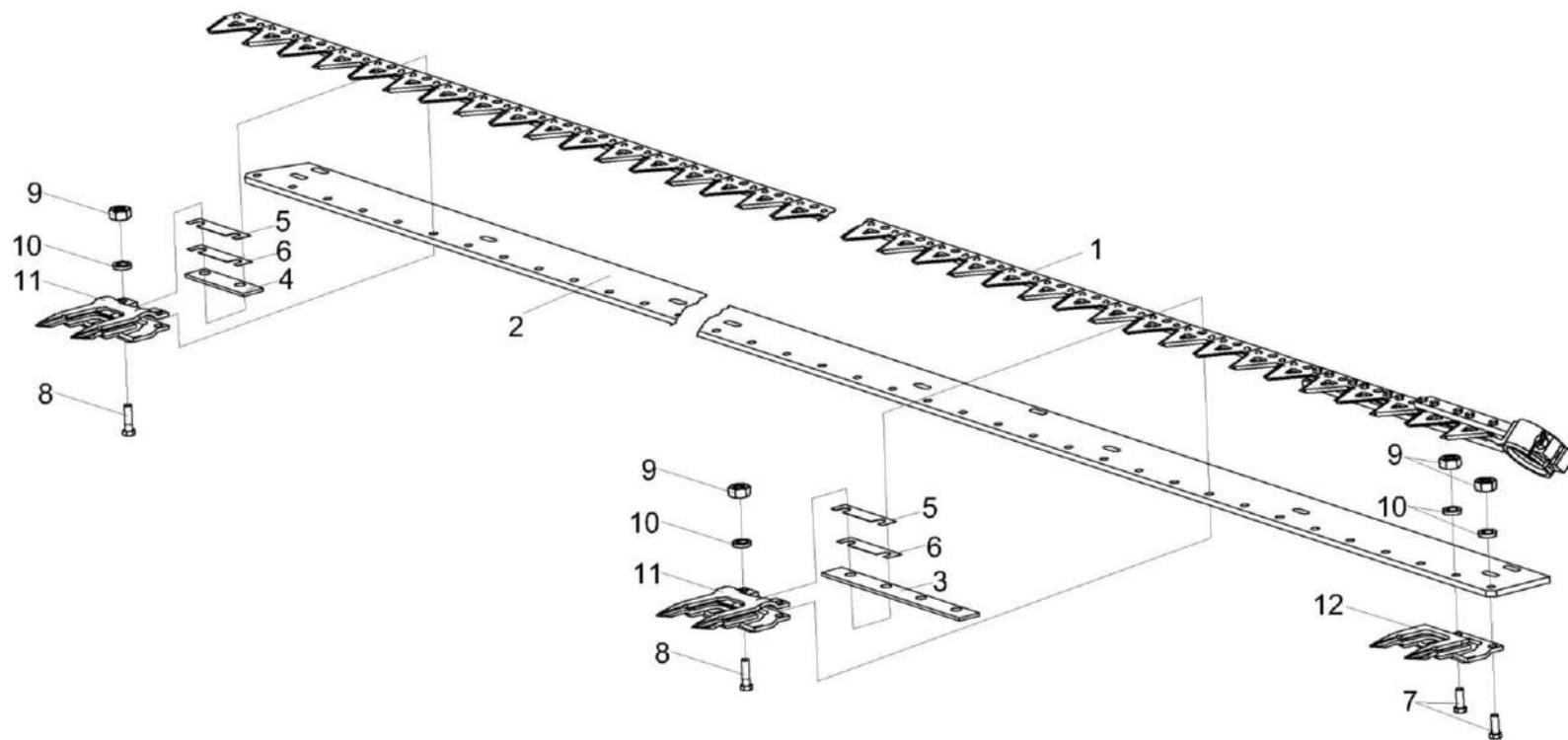
Рисунок 36 – Аппарат режущий КПП 1207000А
