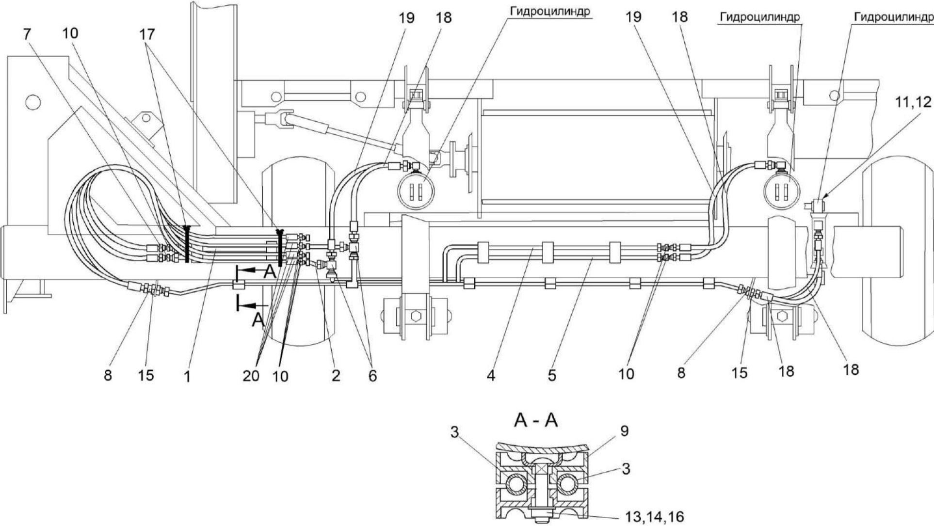
Рисунок 42 – Гидросистема рамы навесной КПП 0800000
