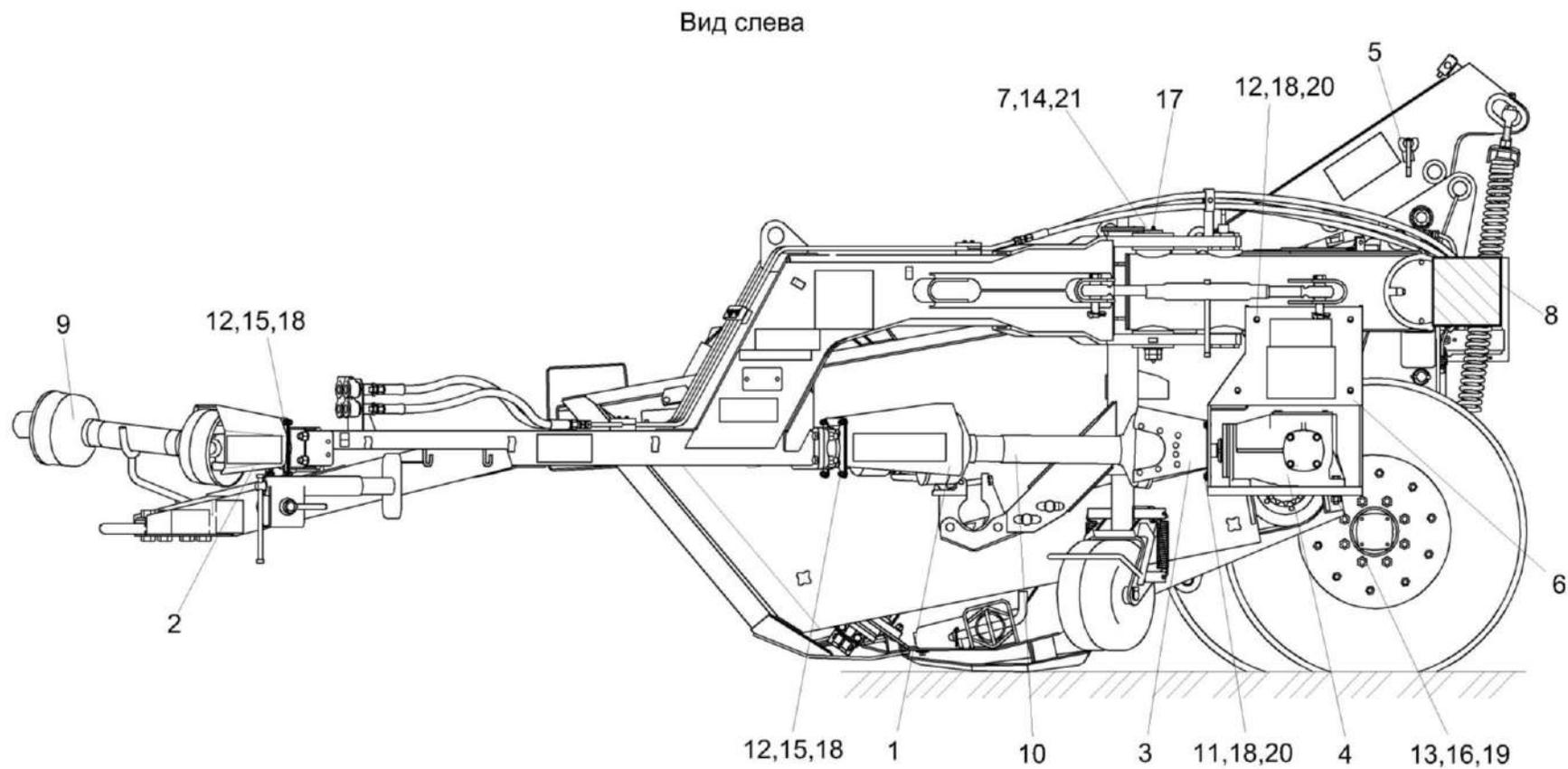
Рисунок 1 – Косилка-плющилка прицепная КПП-4,2 КПП 0000000 (лист 1)
