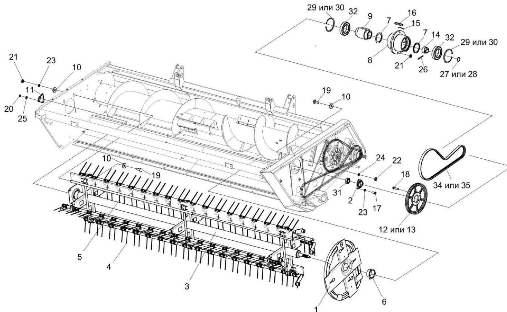
Рисунок 26 – Установка мотовила и муфты обгонной
