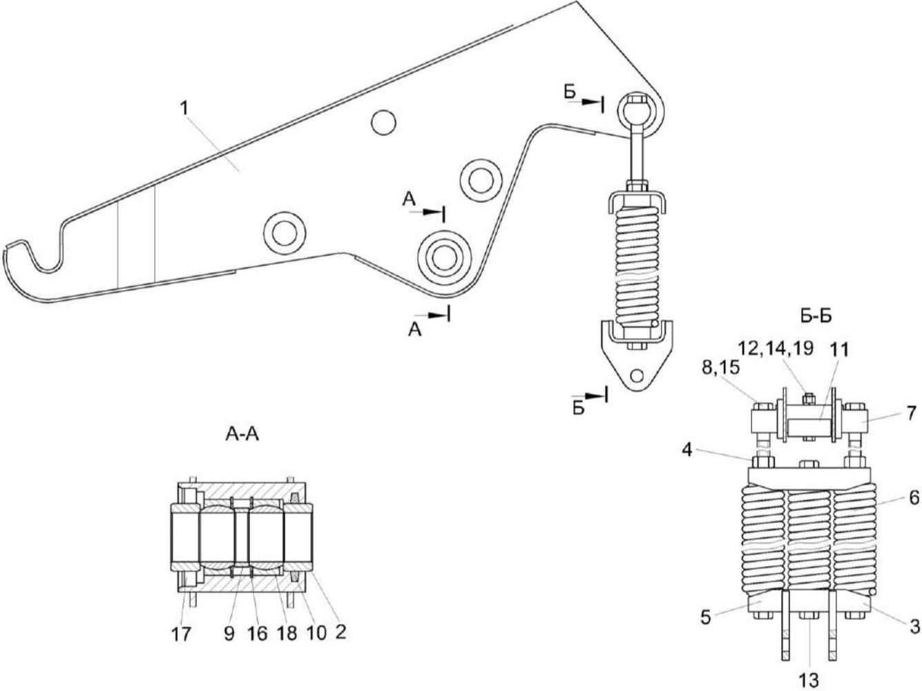
Рисунок 11 – Механизм навески КПП 0105000Б-01
