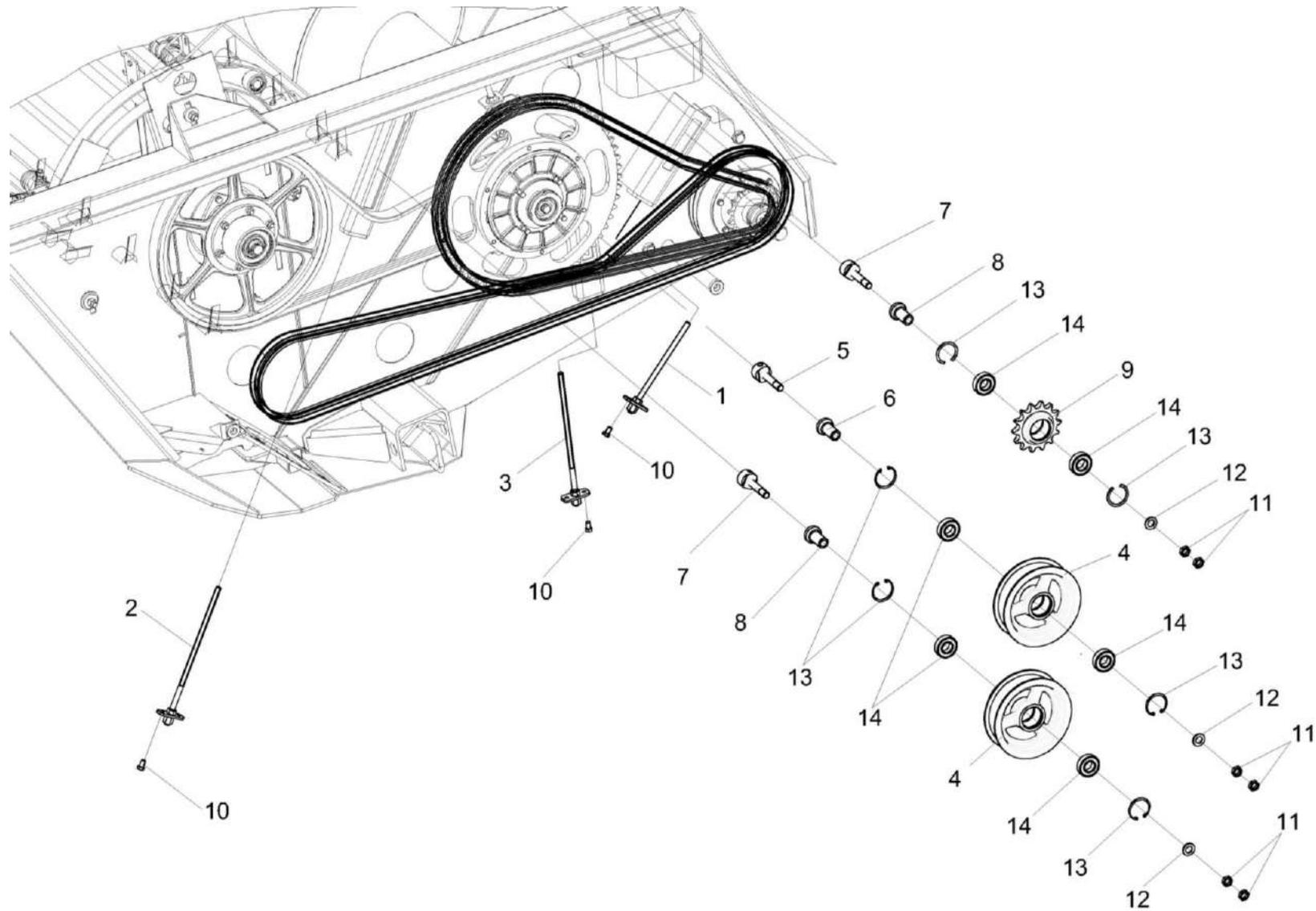
Рисунок 25 – Механизмы натяжения передач
