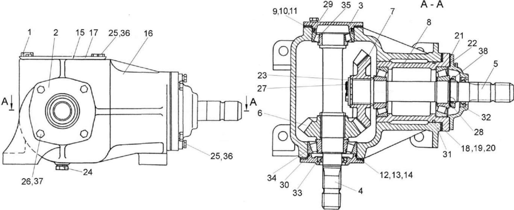
Рисунок 9 – Редуктор КПП 0104000
