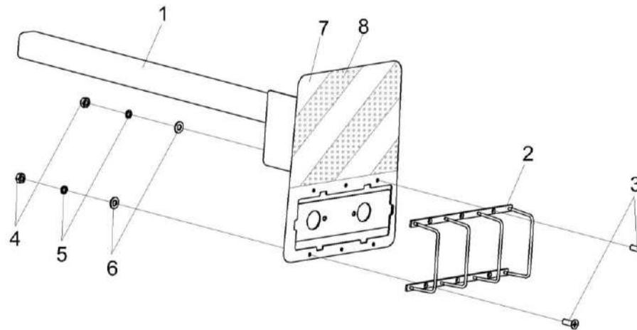
Рисунок 5 – Балка габаритная КПП 0000140Б
