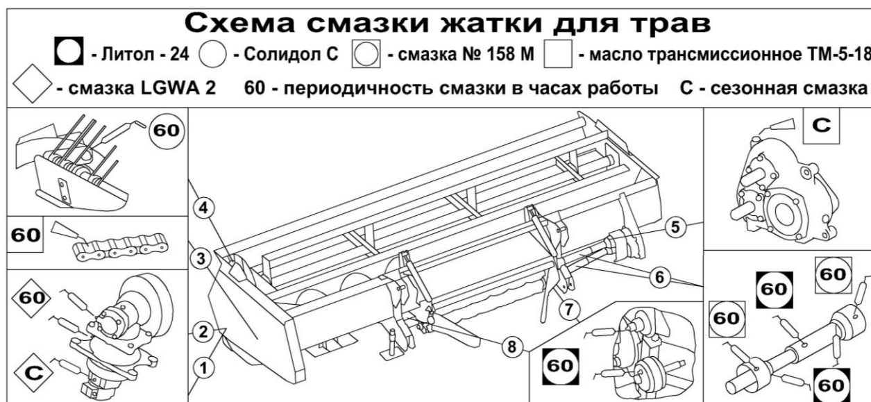
Рисунок 3.2 – Схема смазки жатки
