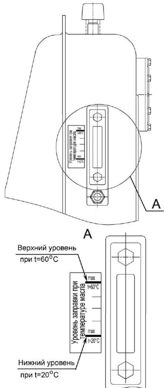
Рисунок 2.6 – Заправка гидросистем
