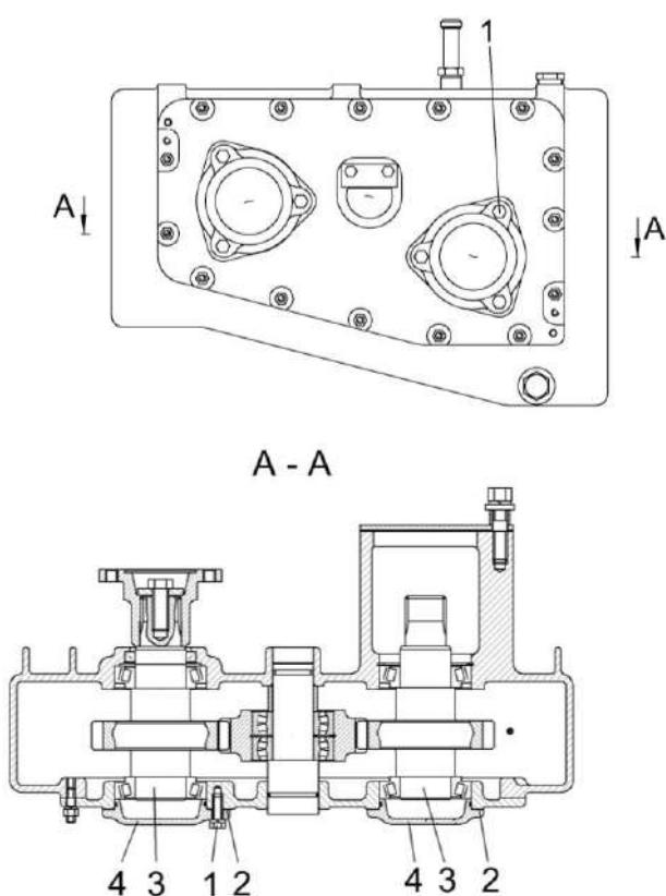
1 – болты; 2 - прокладки; 3 – вал-шестерня; 4 – крышка
