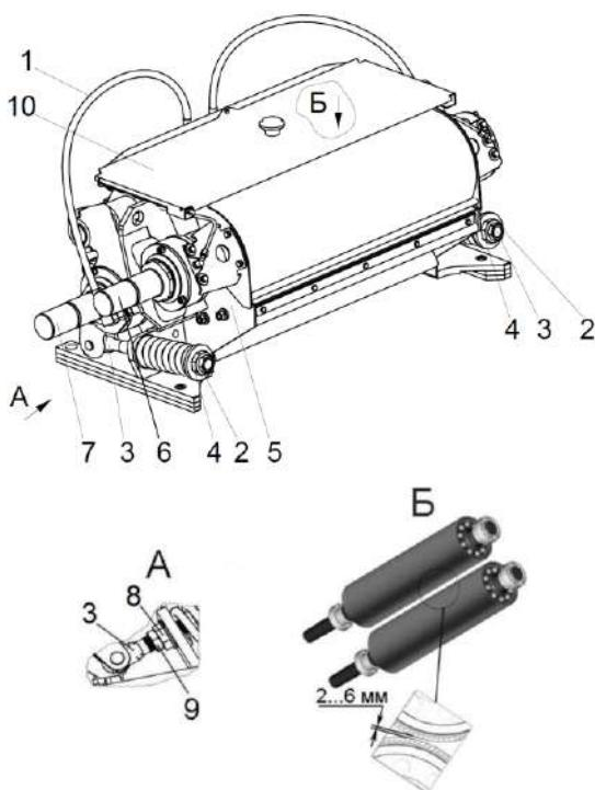
1 – гидросистема регулировки зазора; 2, 9 – гайки; 3 – тяга; 4 – гильза; 5 – корпус; 6 – валец верхний; 7 – валец нижний; 8 – упор; 10 – крышка
