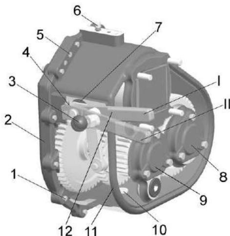
1 – болт; 2, 11 – корпуса; 3 – ручка шаровая; 4 - клеммовое соединение; 5 - штифт; 6 – сапун; 7 - пробка; 8- крышка вала привода нижних вальцов; 9 - крышка промежуточного вала; 10 – пробка слива; 12 - рычаг переключения передач
