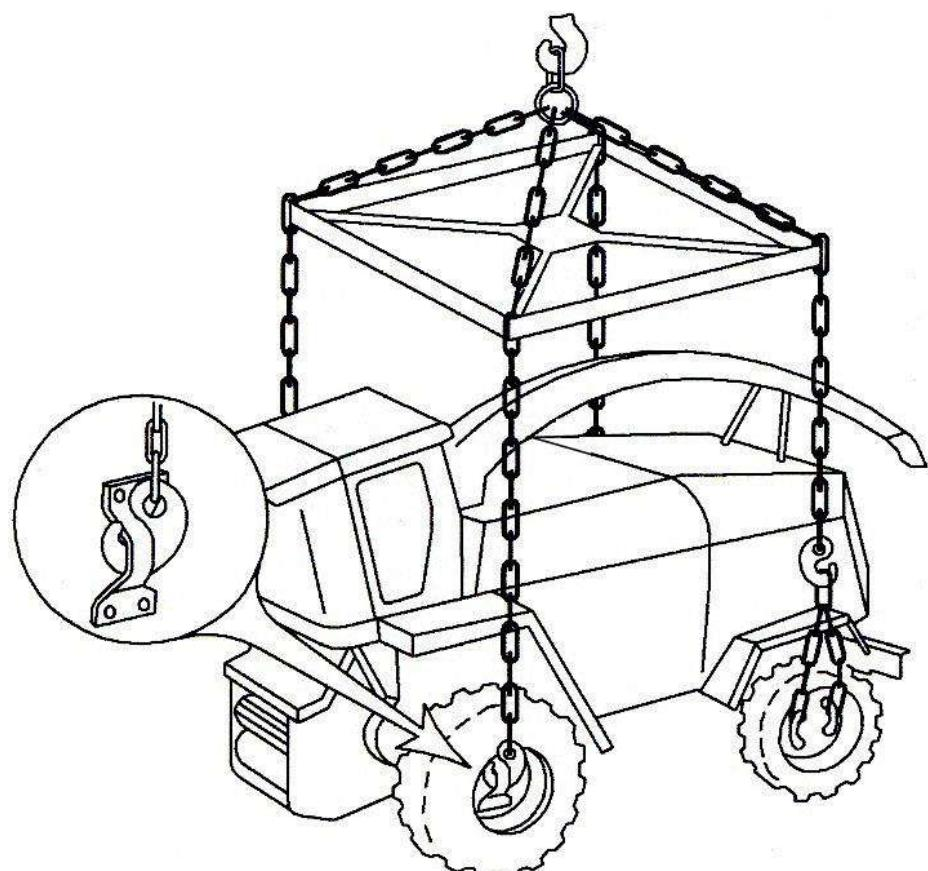
Рисунок 6.1 – Схема строповки
