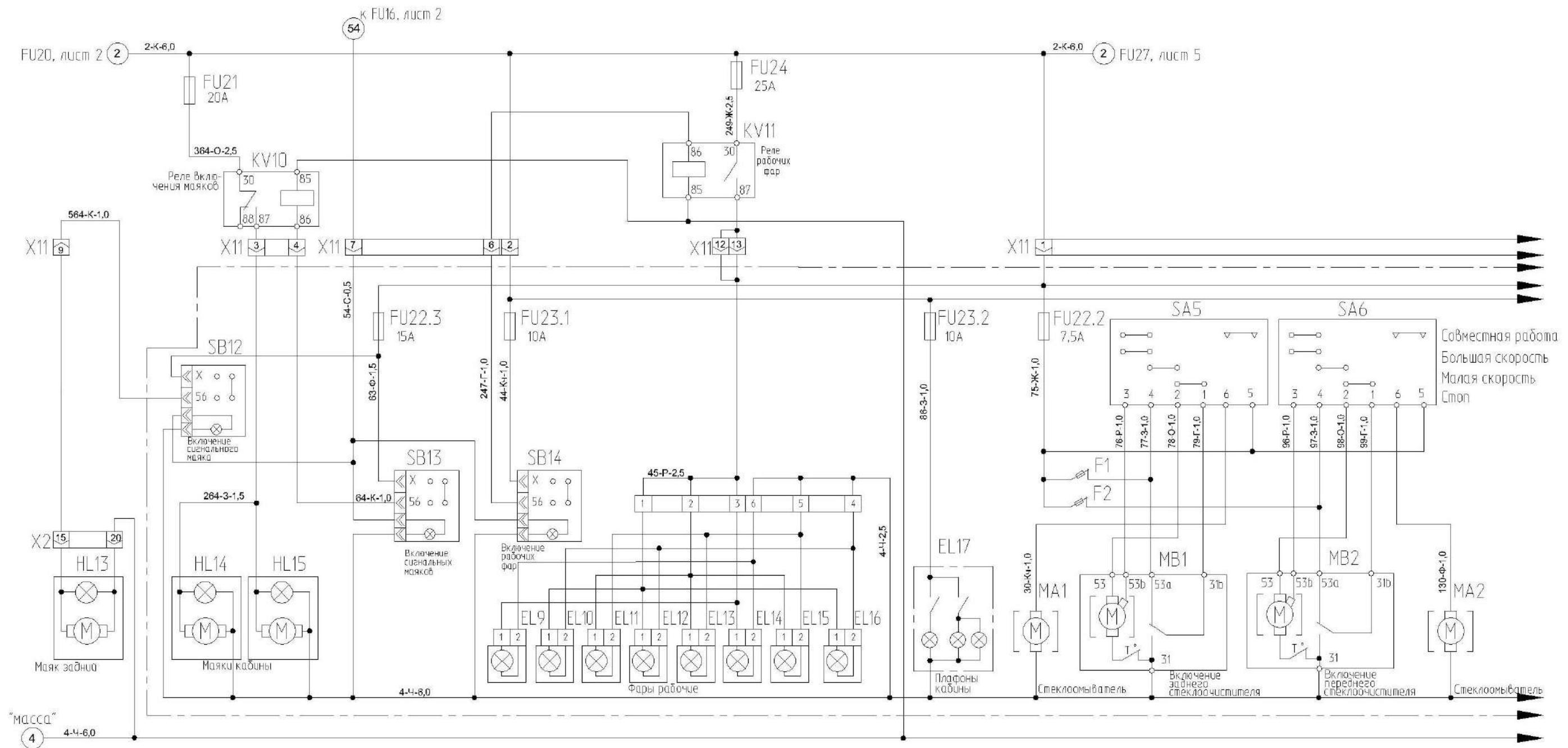
Рисунок Б.3 – Схема электрическая принципиальная комбайна (лист 1)
