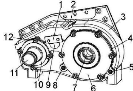
1 – упор; 2 – сапун; 3 – корпус; 4, 12 – прокладки; 5 – пробка слива; 6, 10 – крышки; 7 – колесо; 8 – пробка контрольная; 9 – ось; 11 – вал-шестерня
