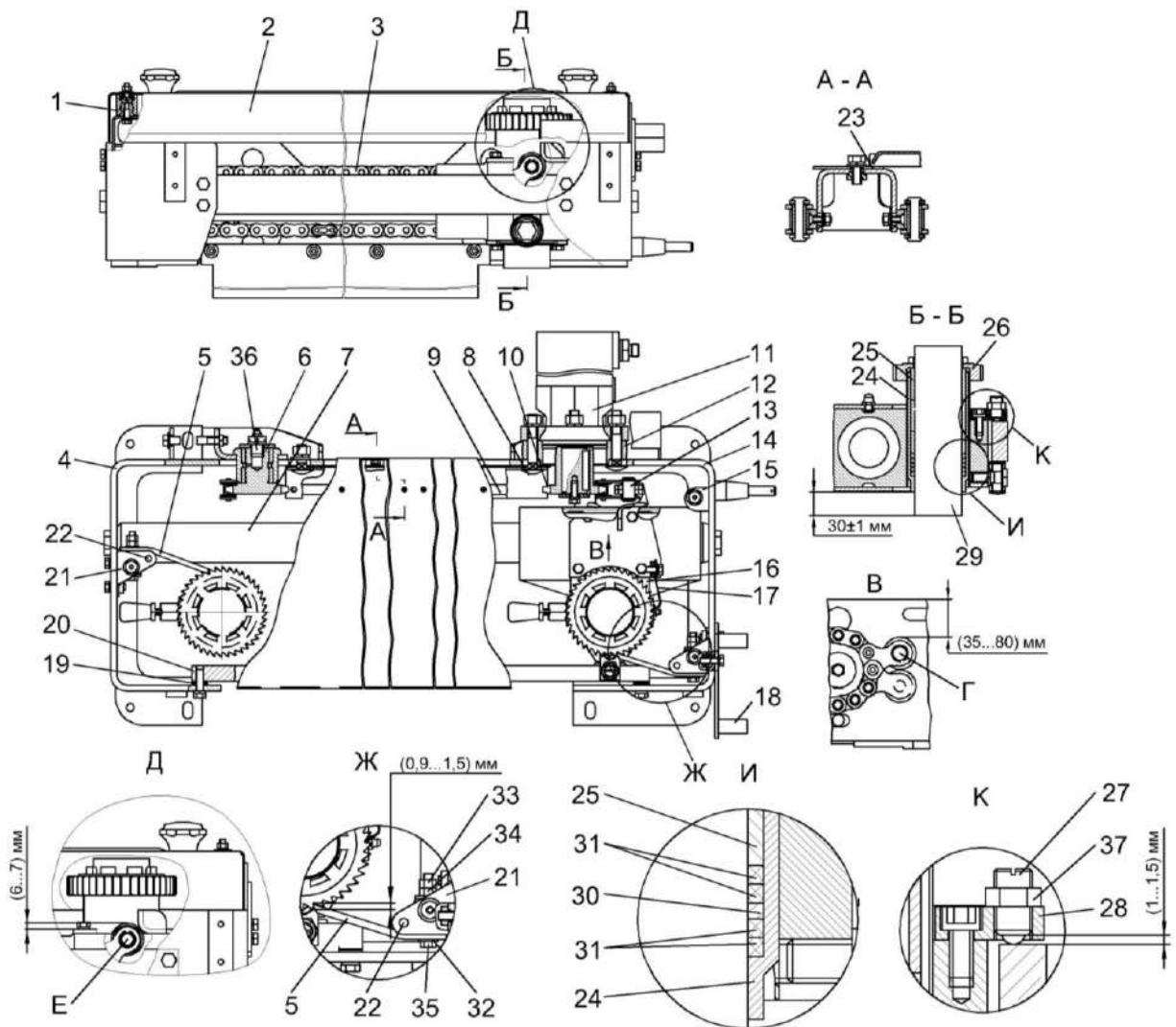
1 – обойма; 2 – крышка; 3, 13 – цепь; 4, 8, 14, 15, 18 – кронштейны; 5 – упор; 6, 10 – звездочки; 7, 9, 20 – направляющие; 11 – гидромотор заточного устройства; 12 – фланец; 16 – каретка; 17 – прижим; 19 – пластина стопорная; 21 – опора; 22 – ось; 23 – ограждение; 24 – втулка резьбовая; 25 – втулки; 26 – колесо храповое; 27 – устройство стопорное; 28 – планка; 29 – бруск абразивный; 30 – кольцо; 31 – кольца резиновые; 32 – шайба; 33, 37 – контргайки; 34 – гайка; 35 – болт; 36 – штицер
