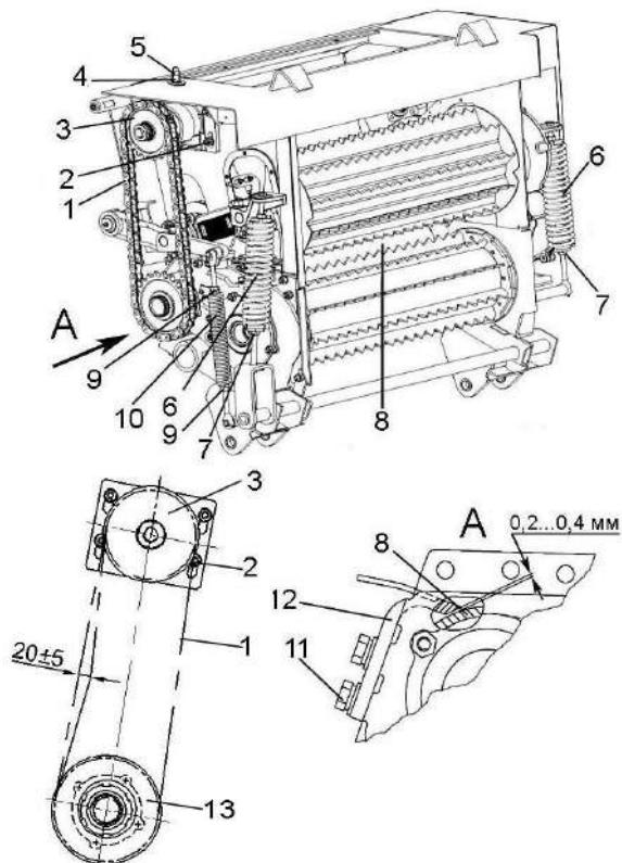
1 – цепь; 2, 4 – гайки; 3, 13 – звездочка контролпривода; 5, 7, 9 – контргайки; 6, 10 – пружины; 8 – валец гладкий; 11 – болт; 12 – чистик
