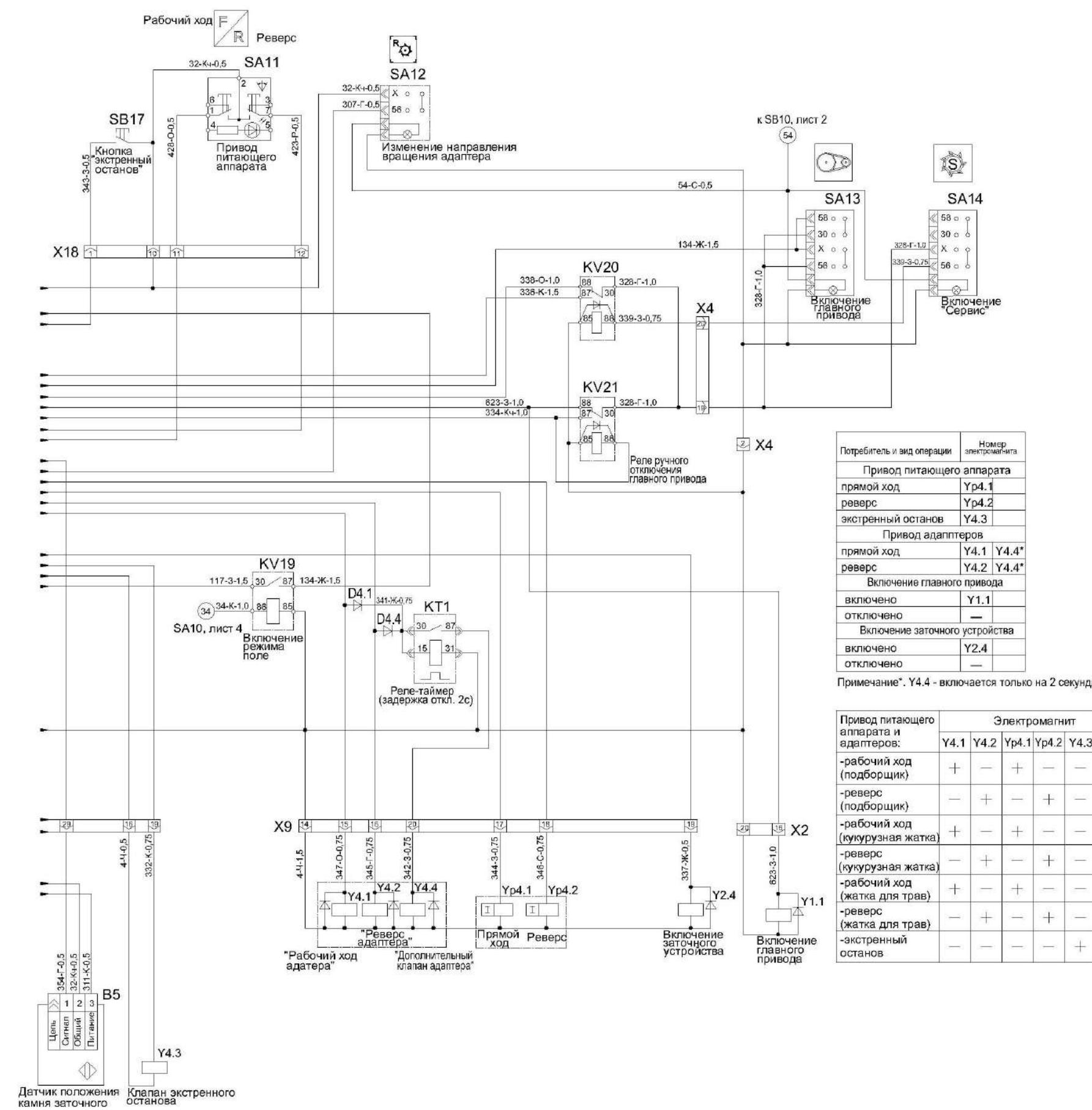
Рисунок Б.5 – Схема электрическая принципиальная комбайна (лист 2)
