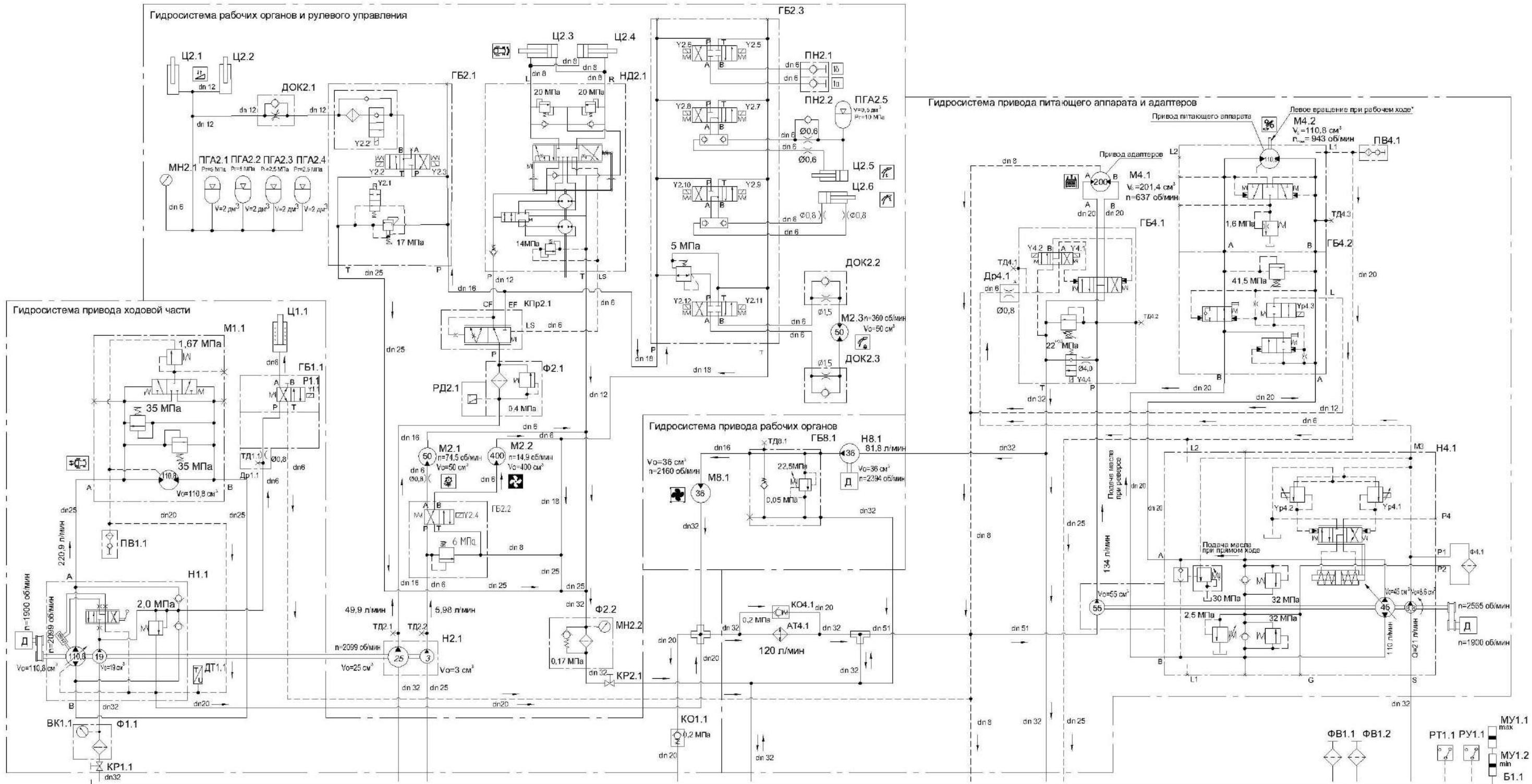
Рисунок А.1 – Схема гидравлическая принципиальная гидросистем кормоуборочного комбайна
