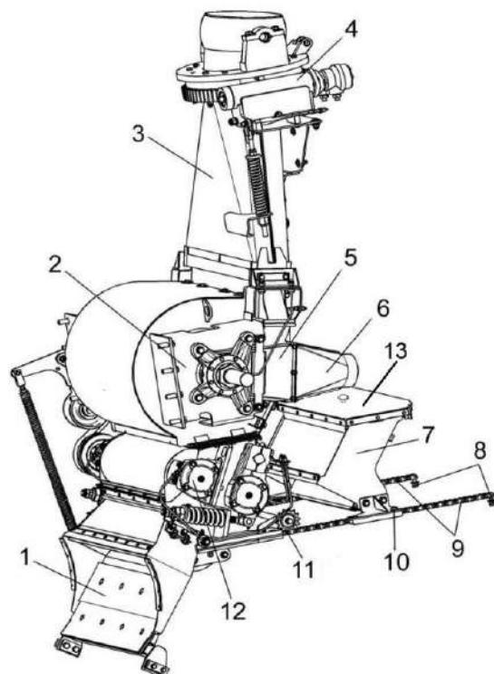
1 – камера приемная; 2 – ускоритель выброса; 3 – основание силосопровода; 4 – механизм поворота силосопровода; 5 – воздуховод; 6 – переходник; 7 – проставка; 8, 10 – болты; 9 – цепь; 11 – механизм перемещения; 12 - устройство доизмельчающее; 13 - крышка с доизмельчающим устройством
