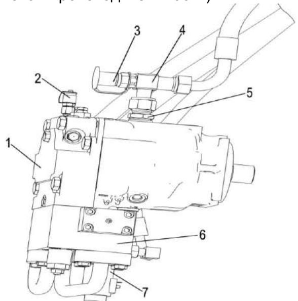
1 – гидромотор привода питающего аппарата; 2 – точка диагностики; 3 – полумуфта заправочная; 4 – тройник; 5 – штуцер; 6 – гидроблок экстренного останова
