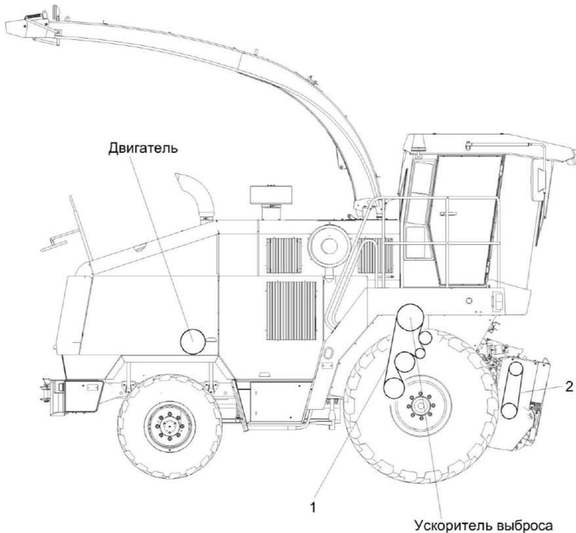
Рисунок М.2 – Схема приводов комбайна (вид справа)
