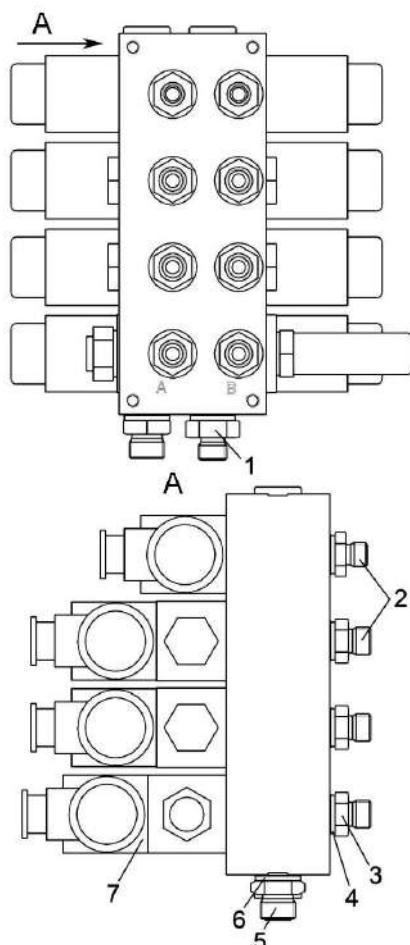
Рисунок 1.10 - Гидроблок четырехсекционный ГБ2.3
