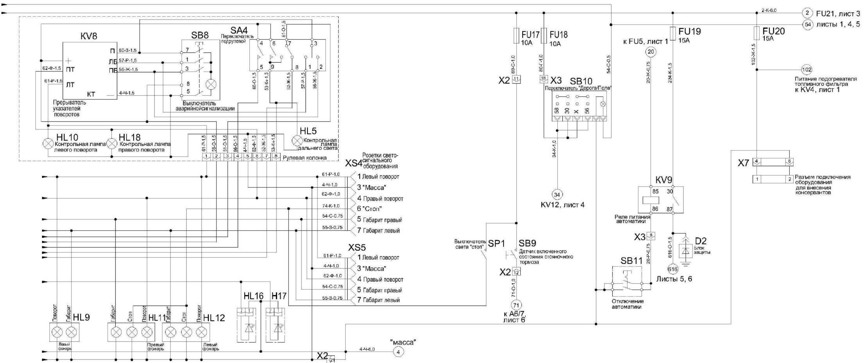
Рисунок Б.2 – Схема электрическая принципиальная комбайна (лист 2)
