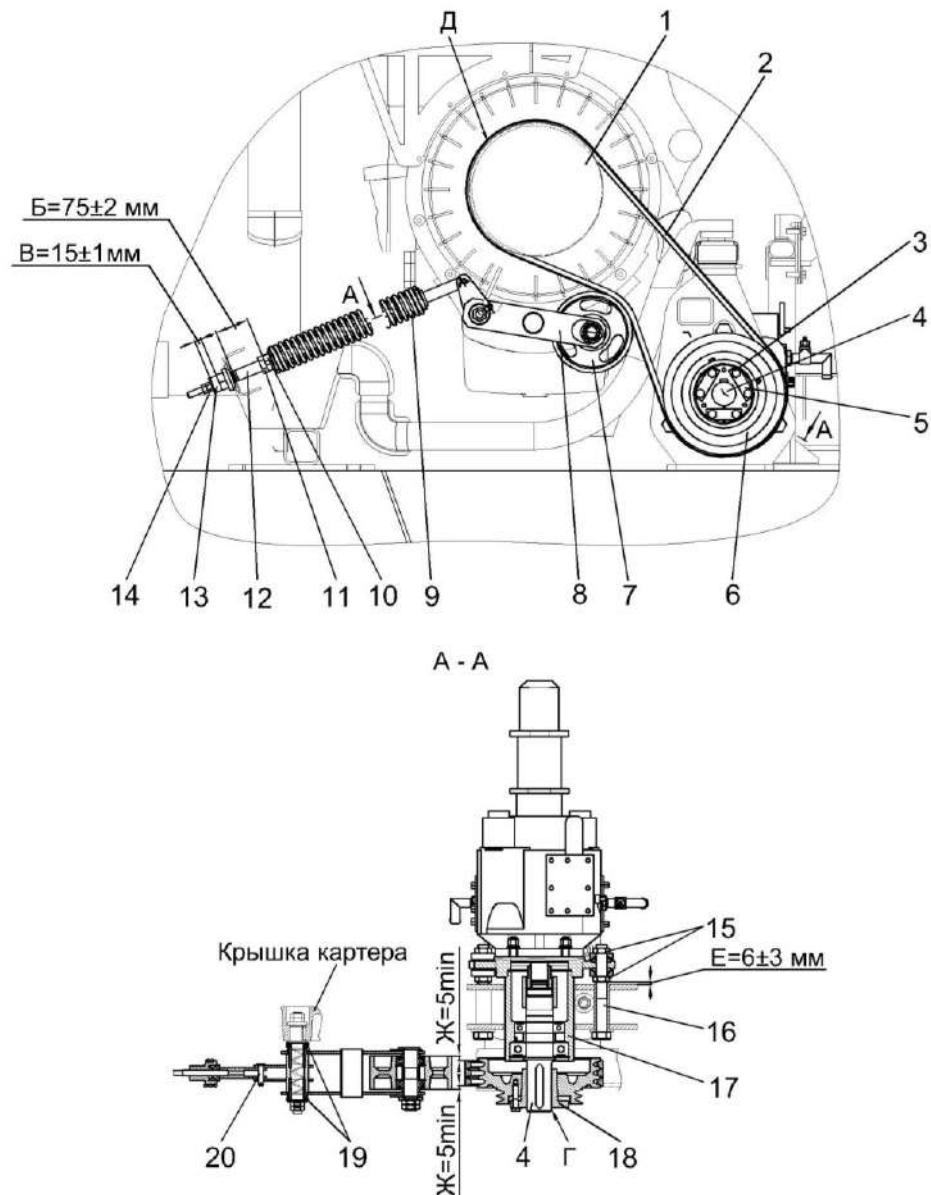
1, 6 – шкивы; 2 – ремень; 3, 16 – болты; 4 – вал; 5 – пластина; 7 - ролик; 8 – рычаг;
