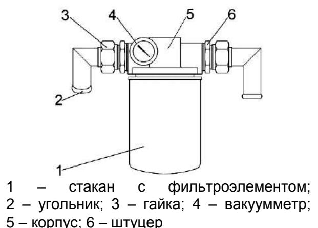
1 – стакан с фильтроэлементом; 2 – угольник; 3 – гайка; 4 – вакуумметр; 5 – корпус; 6 – штуцер
