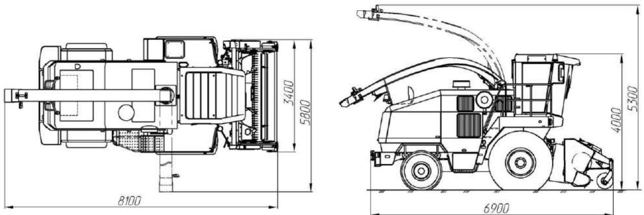
Рисунок 1.1 – Габаритные размеры комбайна с подборщиком
