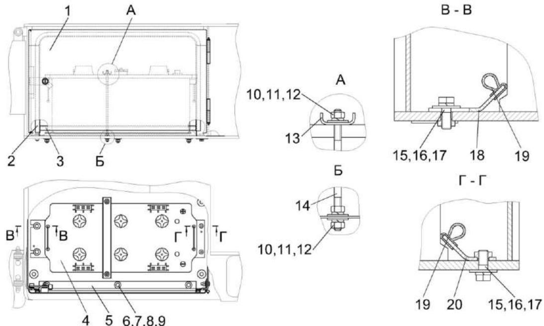
1 – дверка; 2, 3, 19 – уплотнители; 4 – аккумуляторная батарея; 5 – уголок; 6, 15 – болты; 7, 10 – гайки; 8, 9, 11, 12, 16, 17 – шайбы; 13 – планка; 14 – шпилька; 18, 20 – прижимы
