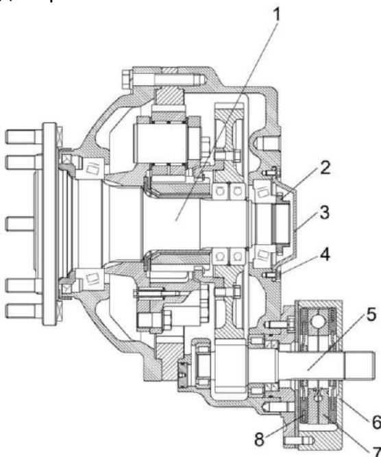
1 – ось колеса; 2 – гайка; 3 – крышка; 4 – болт; 5 – вал ведущий; 6 – корпус тормоза; 7 – диск нажимной; 8 – диск фрикционный
