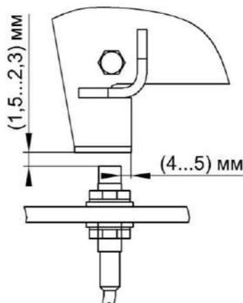
Рисунок 2.14 – Установка датчика положения бруска абразивного
