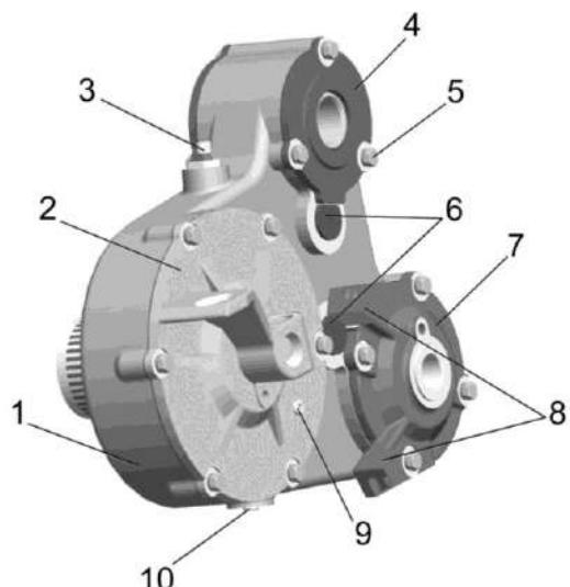
1- корпус; 2, 4, 7 – крышки; 3 – сапун; 5 - болт; 6 - оси; 8 - ограничители угла поворота рычага верхних вальцов; 9 – пробка контрольная; 10 – пробка слива
