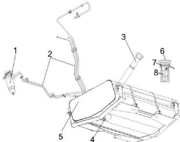
1 – фильтр; 2 – топливопроводы; 3 - заливная горловина; 4 – клапан сливной; 5 – бак; 6 – крышка; 7 – пружина; 8 - сетка
