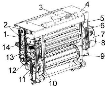
1 – валец верхний передний; 2 – передача цепная; 3 – вал карданный; 4 – корпус; 5 – датчик камнедетектора; 6 – редуктор верхних вальцов; 7 – коробка передач; 8, 11, 12 – пружины; 9 – вальцы нижние; 10 – редуктор нижних вальцов; 14 - валец верхний задний
