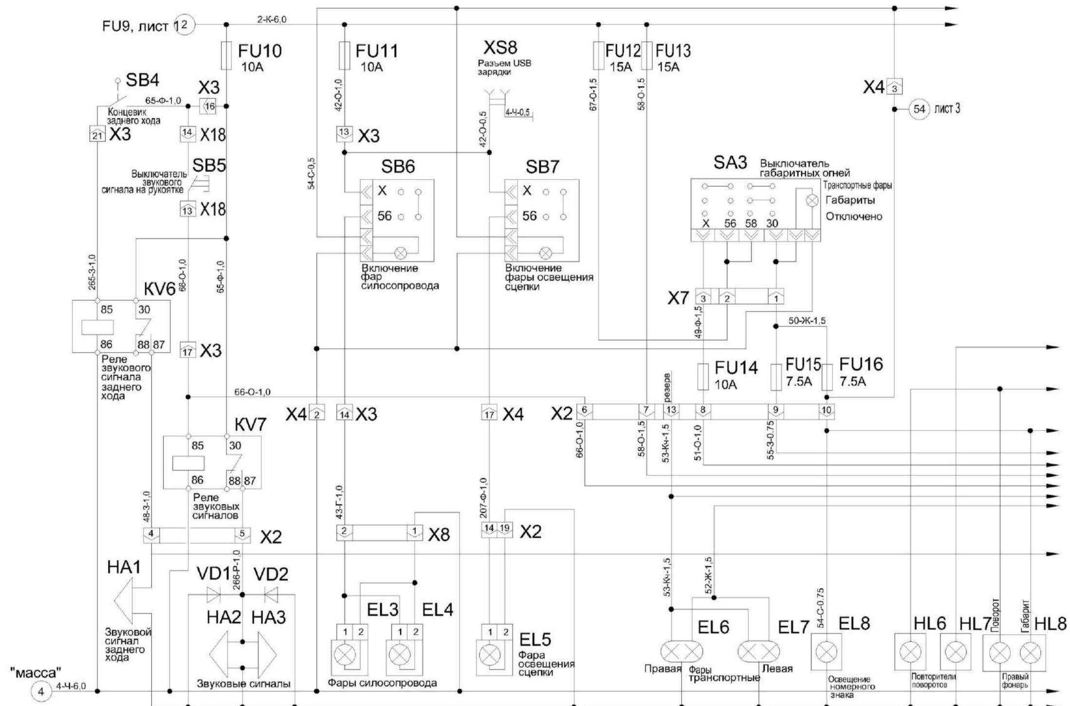
Рисунок Б.2 – Схема электрическая принципиальная комбайна (лист 1)
