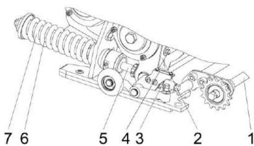
1 – механизм перемещения; 2 – указатель; 3 – контргайка; 4 – шкала; 5 – тяга; 6 – гильза; 7 – пружина
