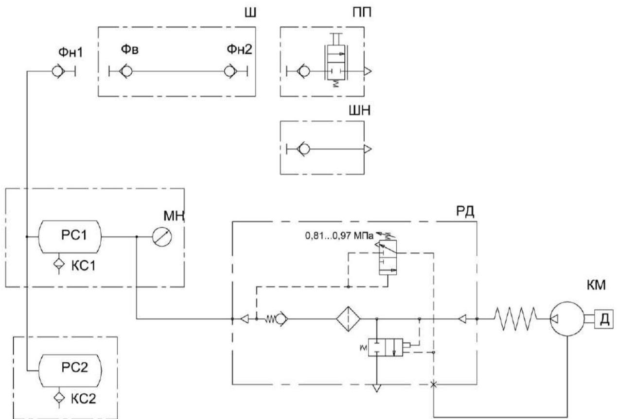
КМ – компрессор; КС1, КС2 – кран слива конденсата; МН – манометр; ПП – пневмопистолет обдувочный; РД – регулятор давления; РС1, РС2 – ресиверы ( $V=40\text{дм}^3$ ); Фн1, Фн2, Фв - фитинги; Ш – шланг; ШН – шланг для накачивания шин
