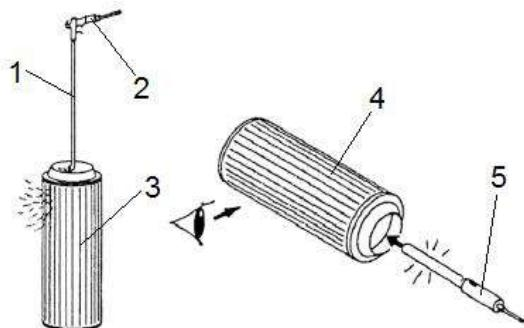
1 – трубка; 2 - пневмопистолет;
