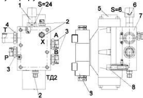
1 – клапан предохранительный;
