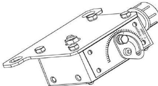
Рисунок 2.7 – Датчик камнедетектора
