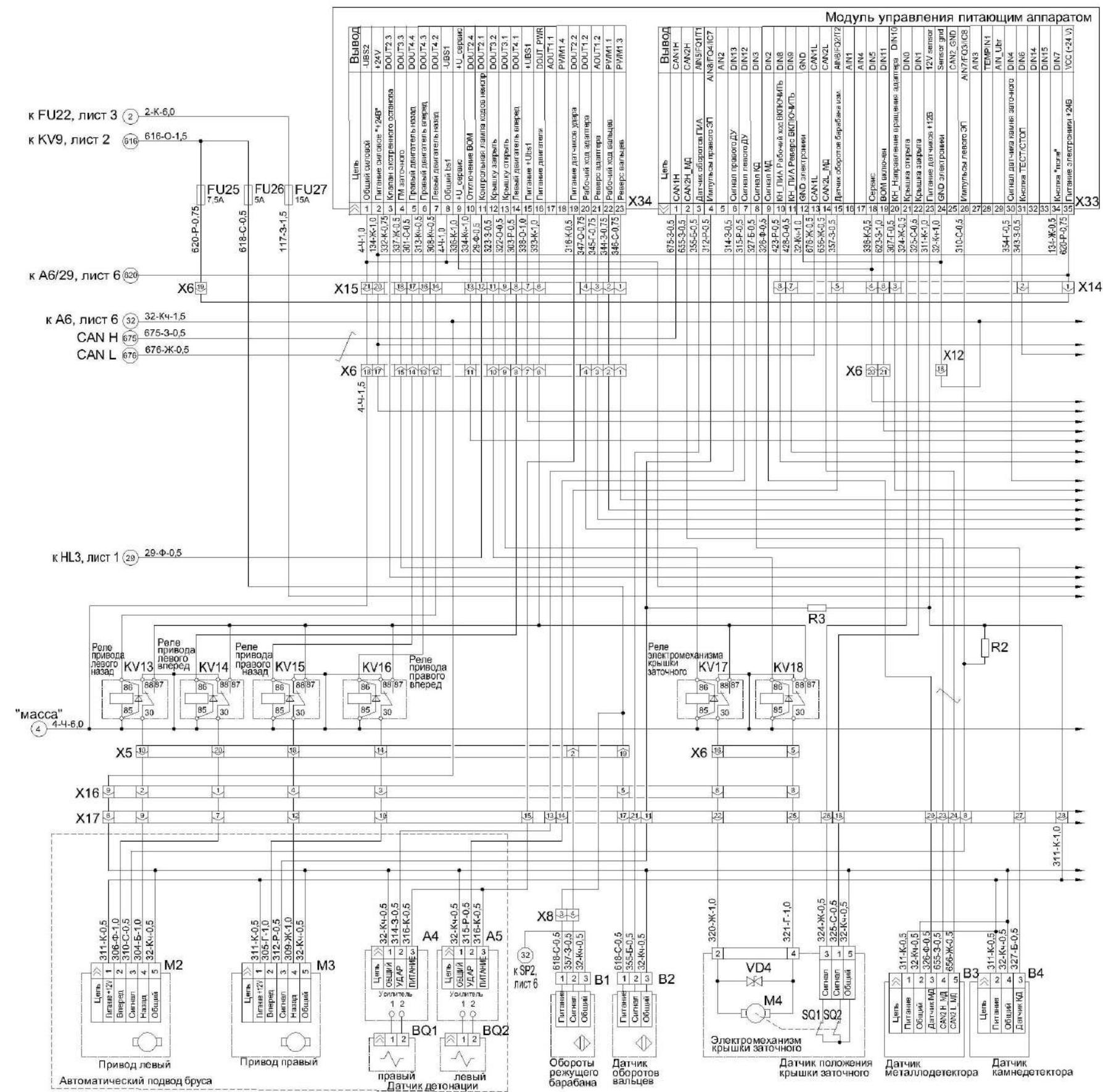
Рисунок Б.5 – Схема электрическая принципиальная комбайна (лист 1)
