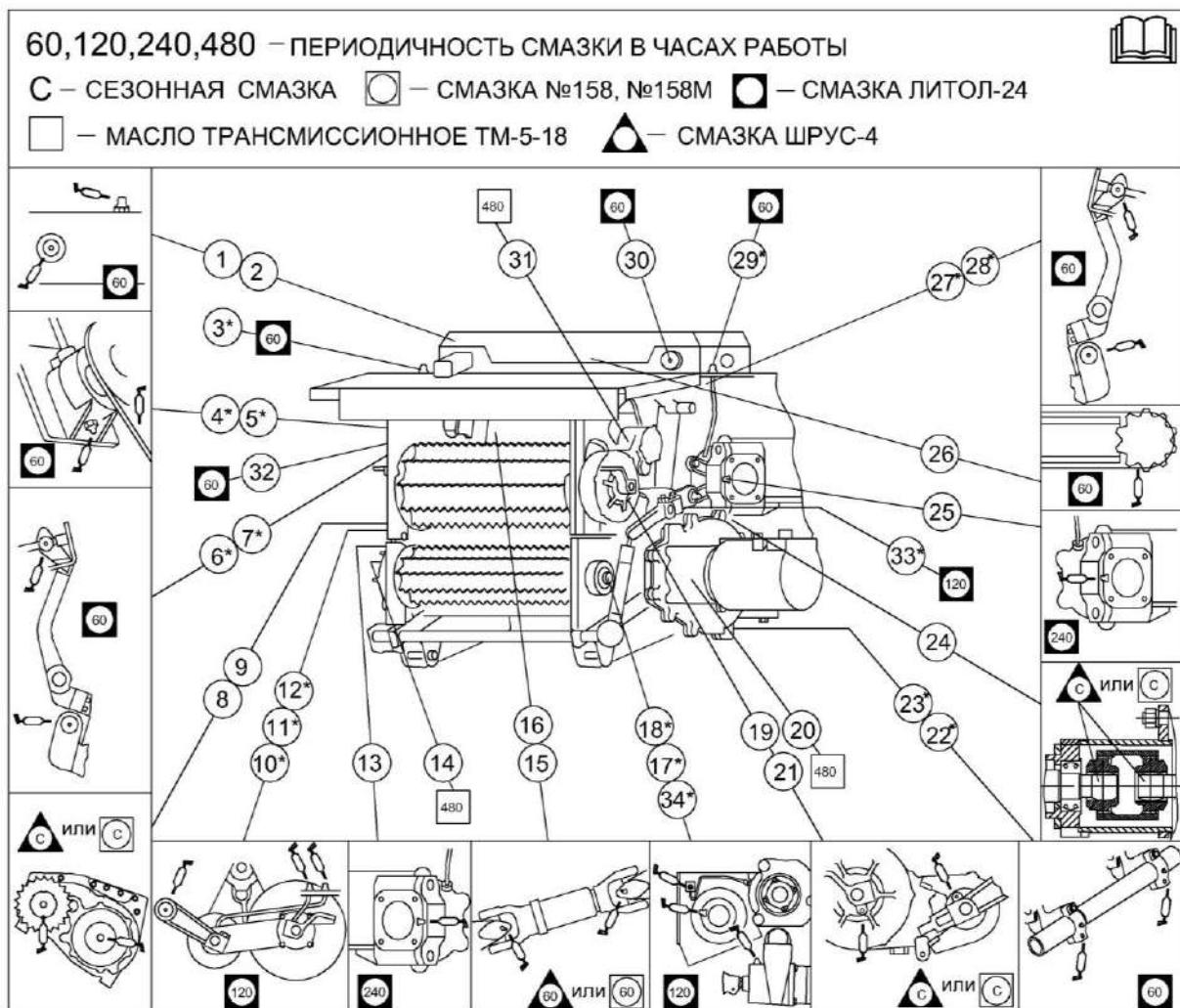
Рисунок 3.15 – Схема смазки питающе - измельчающего аппарата
