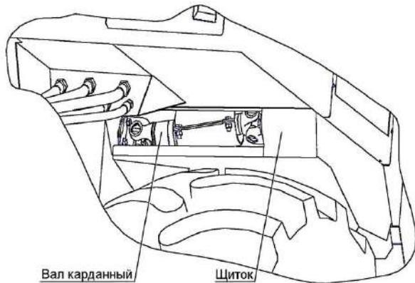
Рисунок 3.12 – Смазка шарниров карданного вала привода редуктора гидроусилителей
