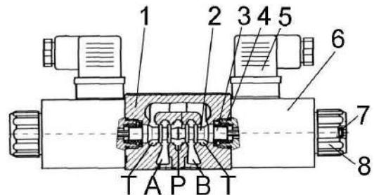
1 – корпус; 2 – золотник; 3 – толкатель; 4 – пружина; 5 – штепельный разъем; 6 – катушка электромагнита; 7 – аварийная (контрольная) кнопка; 8 – гайка
