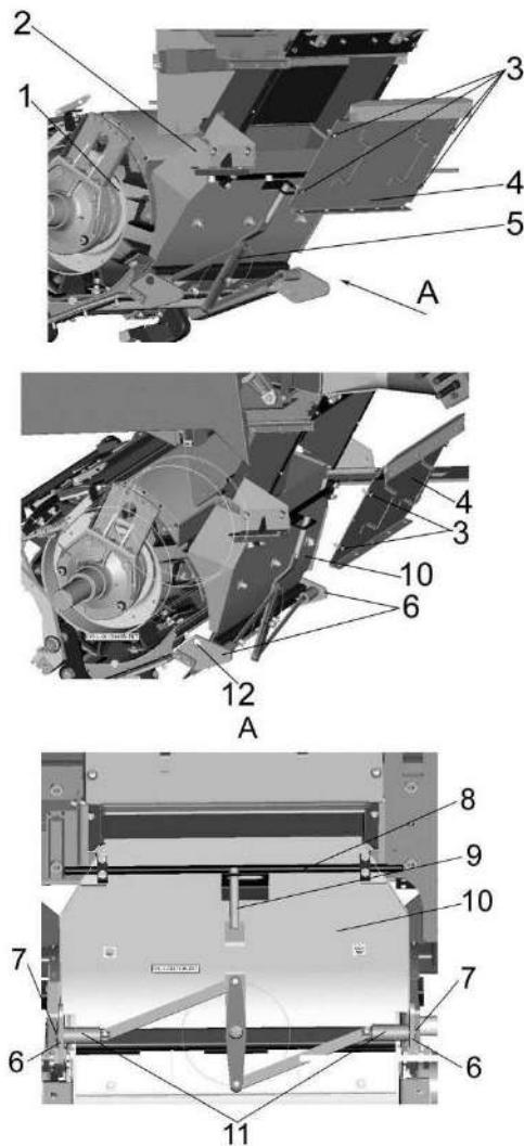
1 – барабан измельчающий; 2 – простоявка; 3 – фиксаторы быстросъемные; 4 – стенка съемная; 5 – механизм открытия приемной камеры; 6 – направляющие; 7 – фиксаторы; 8 – ось; 9 – рычаг; 10 – приемная камера; 11 – втулки; 12 – отверстия для фиксации
