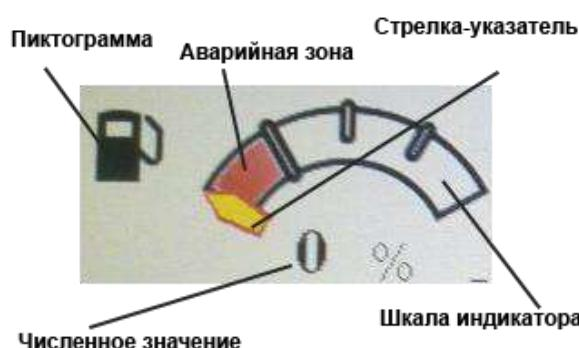
Рисунок Н.3– Пример стрелочного индикатора
