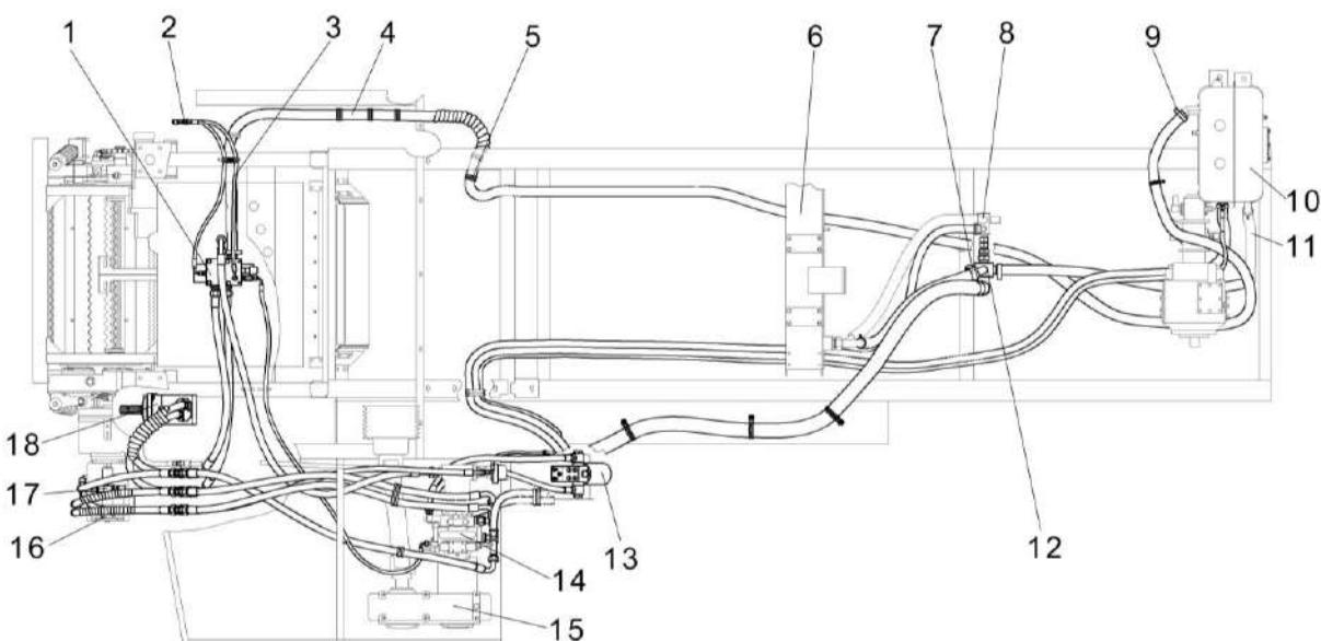
1 – гидроблок адаптеров; 2 – точки диагностики; 3, 4, 11 – рукава; 5, 7, 9 – хомуты; 6 – радиатор масляный; 8, 12 – коллекторы; 10 - бак масляный; 13– фильтр напорный; 14– гидронасос двухсекционный; 15 – редуктор привода гидронасосов; 16 – гидромотор привода питающего аппарата с гидроблоком экстренного останова; 17 - полумуфта заправочная; 18 – гидромотор привода режущего аппарата
