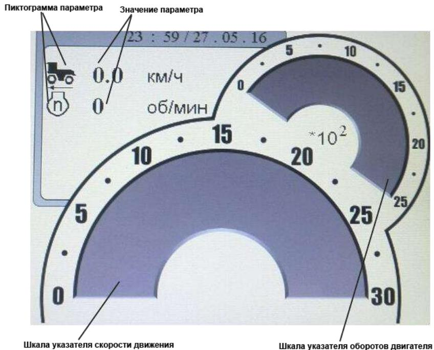
Рисунок Н.5 – Индикатор приборной панели
