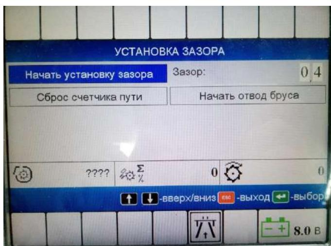
Рисунок Н.21 – Меню установки зазора
