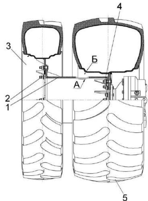
1 - проставка; 2, 4 - гайки; 3, 5 - колеса
