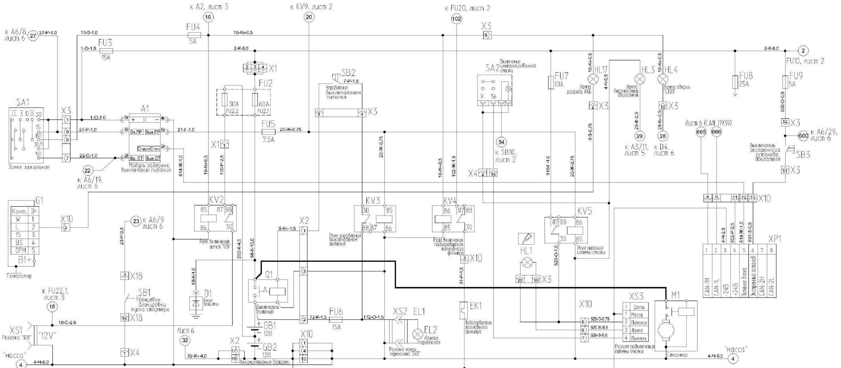
Рисунок Б.1 – Схема электрическая принципиальная комбайна
