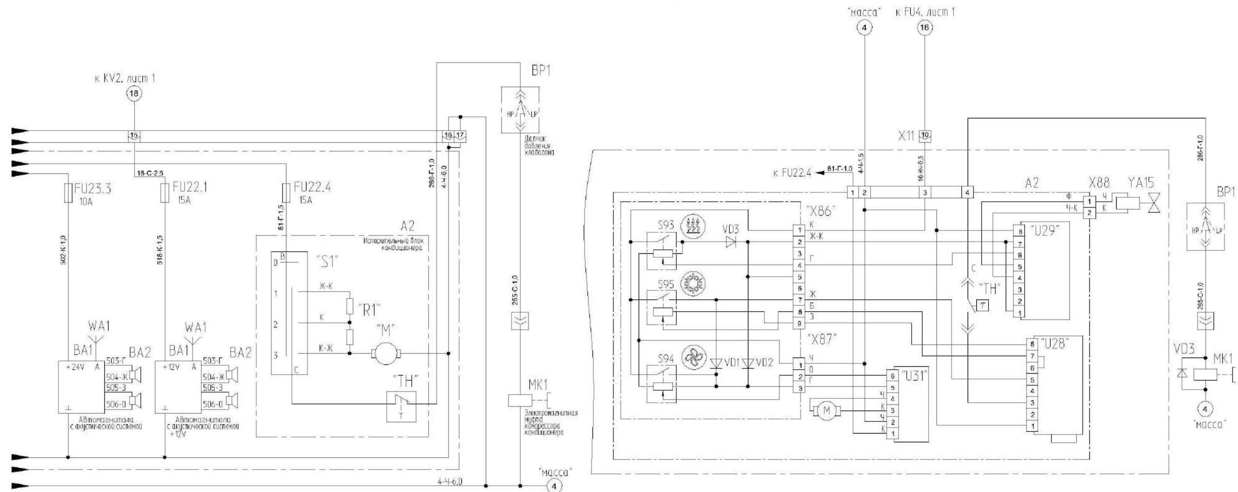
Рисунок Б.3 - Схема электрическая принципиальная комбайна (лист 2)
