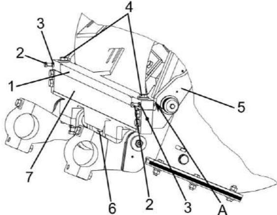
1 – брус противорежущий; 2 – болты упорные; 3 – контргайки; 4 – болты верхние крайние крепления бруса; 5 – рычаг; 6 – болт нижний крепления бруса; 7 – подбруски
