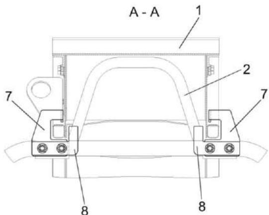
Рисунок 2.3 – Механизм фиксации силосопровода
