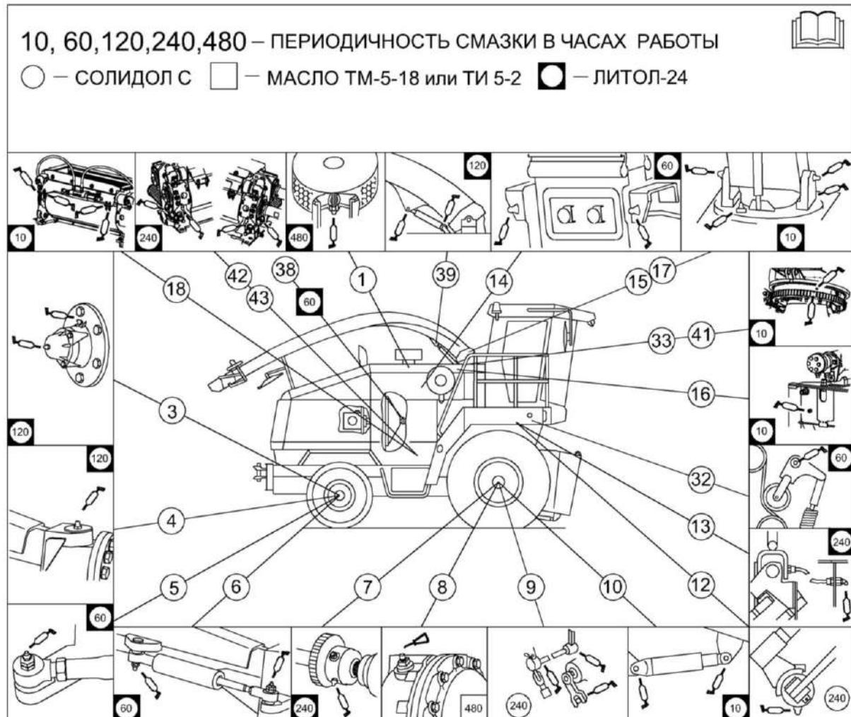
Рисунок 3.13 – Схема смазки комбайна (вид справа)
