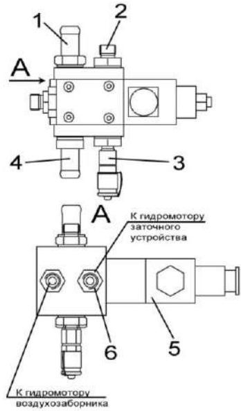
Рисунок 1.9 - Гидроблок воздухозаборника
