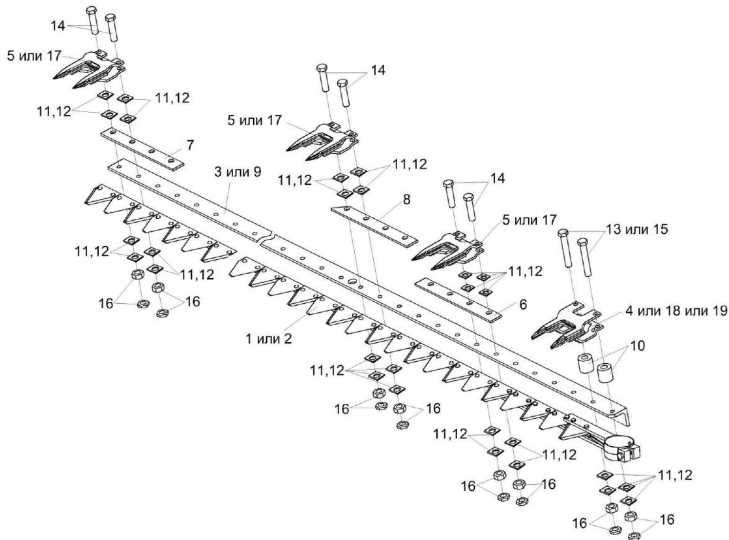
Рисунок 4 – Аппарат режущий КЗК-1492-1547000
