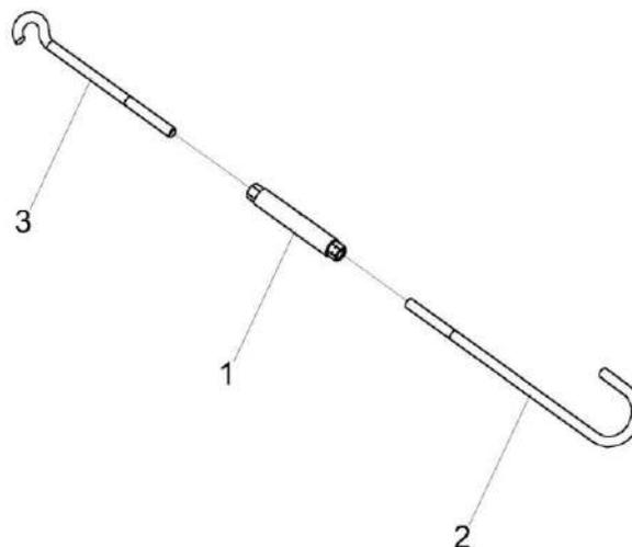
Рисунок 21 – Устройство стяжное КЗ-1-1540170А-01
