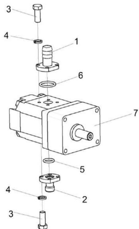
Рисунок 10 – Гидронасос КЗК-9-1542170
