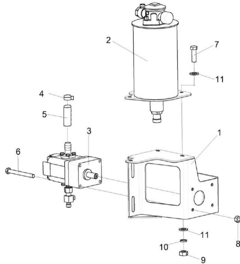
Рисунок 8 – Установка гидронасоса КЗК-9-1540400А
