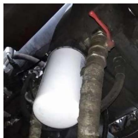
Рисунок 3.8 – Перекрытый кран сливного фильтроэлемента
