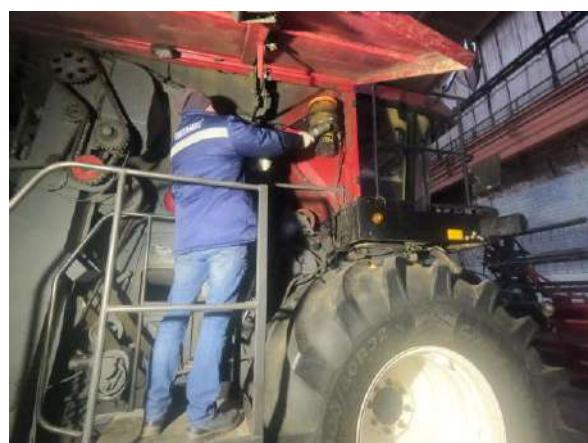
Рисунок 3.4 – Заправка насоса АЦСС
