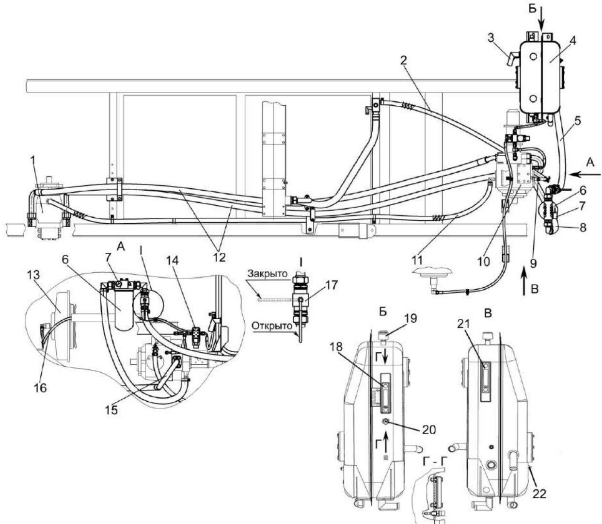
1 – гидромотор; 2, 11 – рукава; 3 – угольники; 4 - бак масляный; 5, 8 – рукава всасывающие; 6 – фильтр; 7 – вакуумметр; 9 - дроссель; 10 - гидронасос; 12, 15, 16 – рукава высокого давления; 13 – муфта включения главного привода; 14 – гидроблок включения главного привода; 17 – кран; 18 – маслоуказатель нижний; 19 – сапун; 20 – датчик аварийного уровня масла; 21 – маслоуказатель
