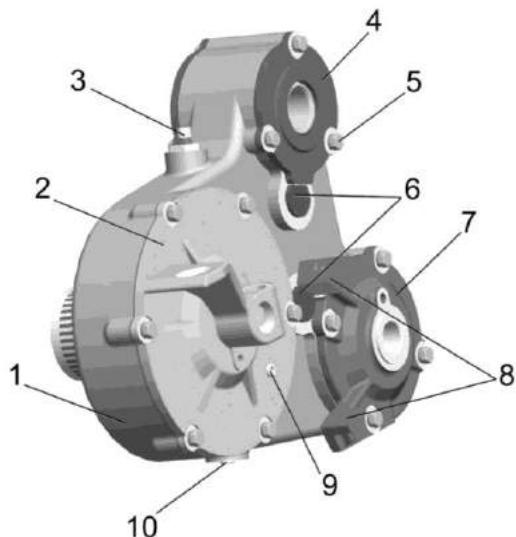
1 - корпус; 2, 4, 7 – крышки; 3 – сапун; 5 - болт; 6 - оси; 8 - ограничители угла поворота рычага верхних вальцев; 9 – пробка контрольная; 10 – пробка сливная
