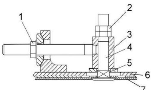
1, 2 – гайки; 3 – стяжка; 4 – болт;
