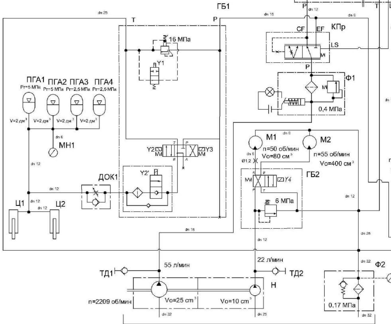
Рисунок А.1 – Схема гидравлическая принципиальная гидросистемы рабочих органов и рулевого управления комплекса
