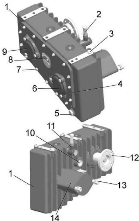
1 - корпус; 2 - сапун; 3 - маслоуказатель; 4, 6, 9 – крышки; 5 - пробка; 7 - болт; 8 – упор; 10 - ось; 11 – угольник; 12 - фланец; 13 - гайка; 14 - муфта
