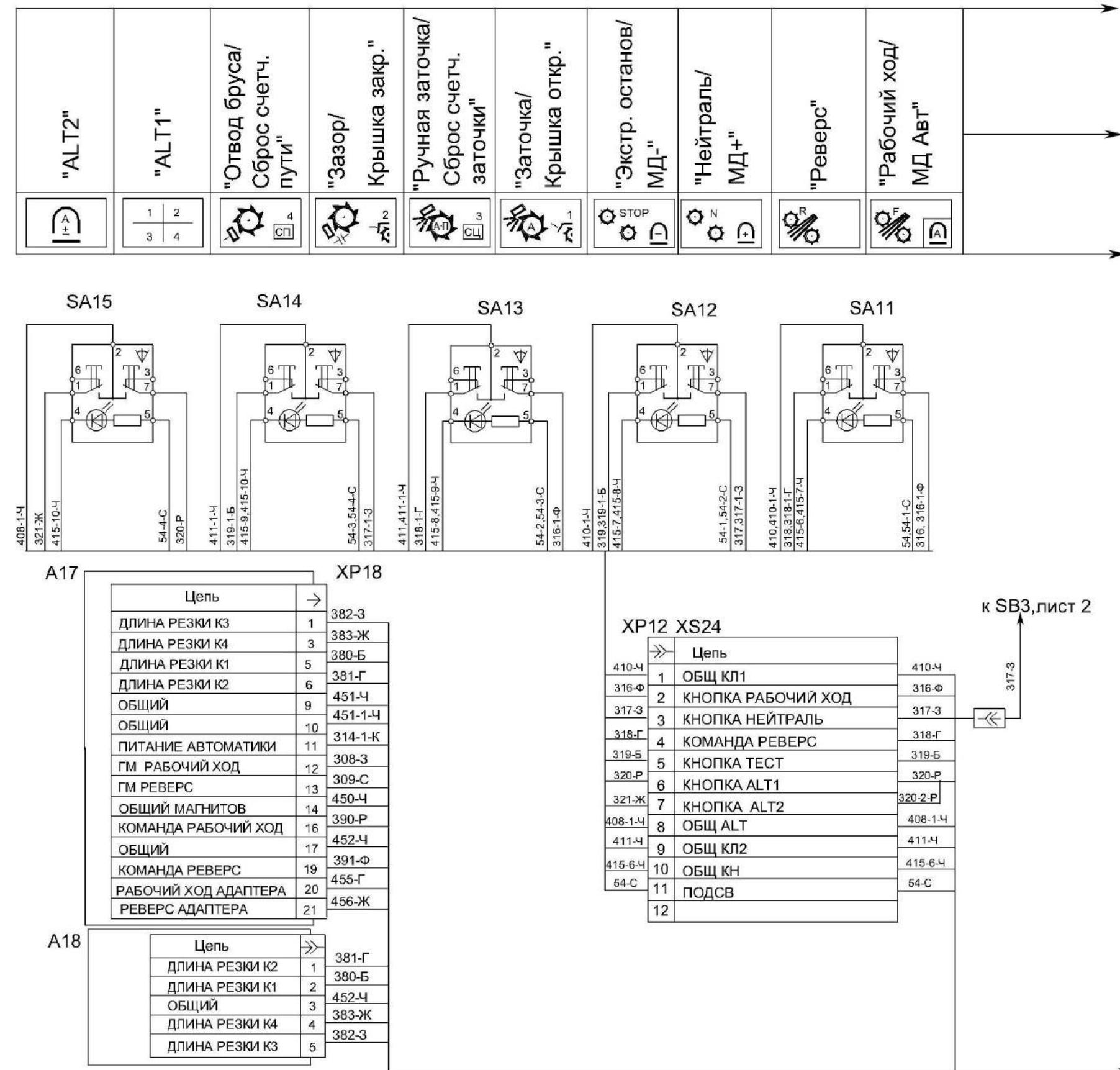
Рисунок Б.5 – Схема электрическая принципиальная комплекса (лист 1)
