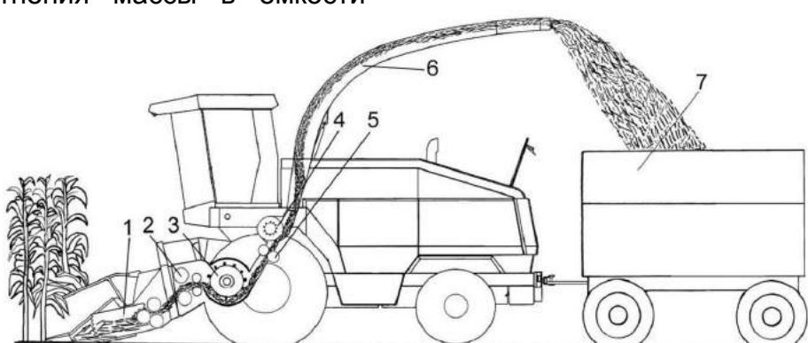
1 – жатка для грубостебельных культур; 2 – аппарат питающий; 3 – аппарат измельчающий; 4 – ускоритель выброса массы; 5 – устройство доизмельчающее; 6 – силосопровод; 7 – транспортное средство
