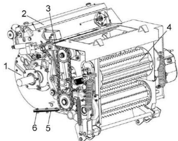
1 – аппарат измельчающий; 2 – заточное устройство; 3 - скоба; 4 – аппарат питающий; 5 – прокладки регулировочные; 6 – болт
