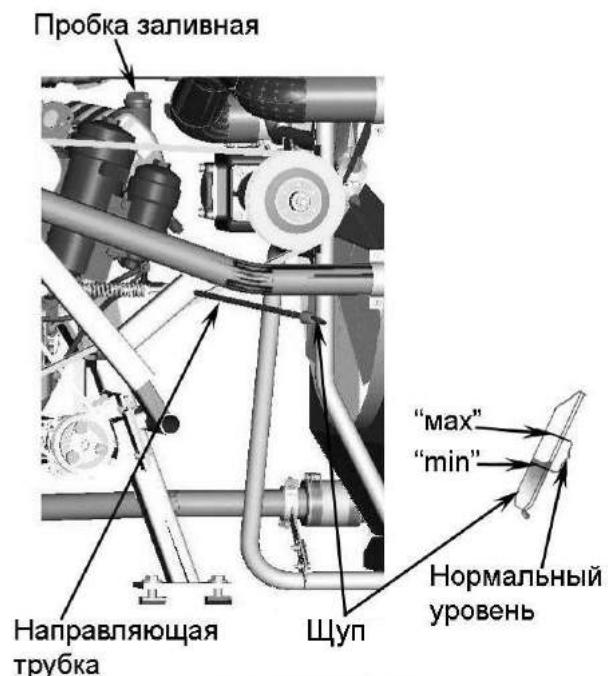
Рисунок 3.4 - Проверка уровня масла в поддоне двигателя
