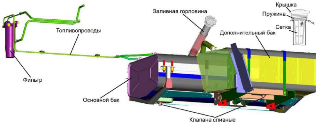
Рисунок 3.11 – Топливная система
