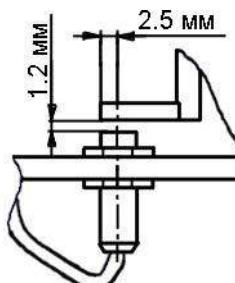
Рисунок 2.9– Установка датчика положения бруска абразивного
