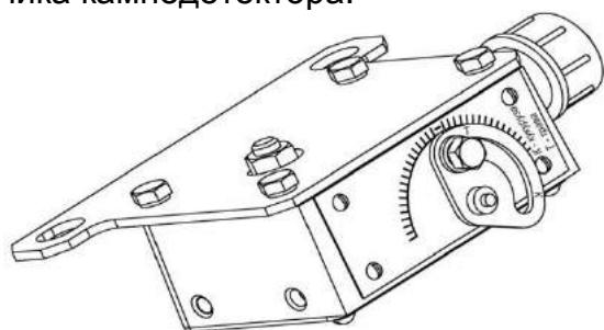
Рисунок 2.3 – Датчик камнедетектора
