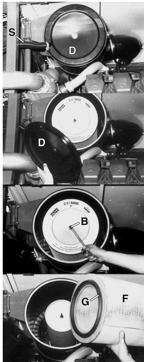
Рисунок 3.8 - Очистка или замена фильтр – патрона воздухоочистителя двигателя
