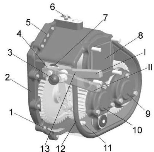
1 – болт; 2, 12 – корпуса; 3 – ручка шаровая; 4 – клеммовое соединение; 5 – штифт; 6 – сапун; 7 – пробка; 8 – крышка входного вала; 9 – крышка вала привода нижних вальцев; 10 – крышка промежуточного вала; 11 – пробка слива; 13 – рычаг переключения передач I, II – положения рычага переключения передач 13
