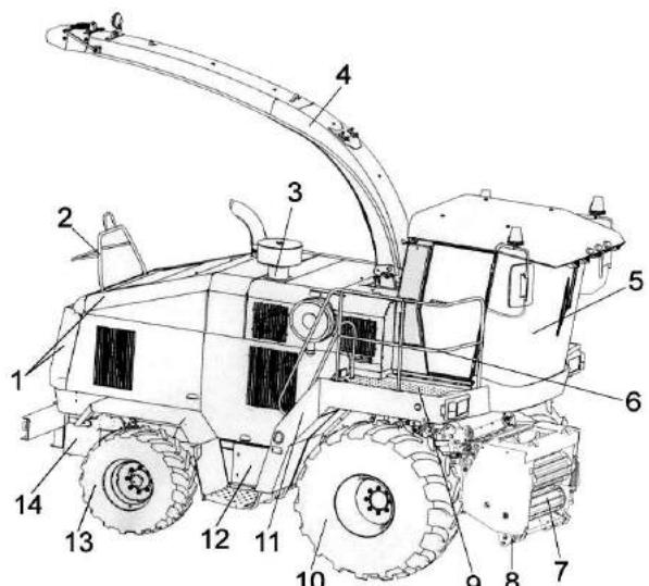
1 – капоты; 2 - стойка; 3 – установка двигателя; 4 - силосопровод; 5 - кабина; 6 - поручень; 7 - аппарат питающе - измельчающий; 8 - механизм вывешивания; 9 - площадка входа; 10 - мост ведущий; 11 - трап; 12 – дополнительный топливный бак; 13 – мост управляемых колес; 14 - рама
