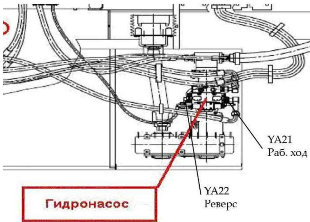
Рисунок М.2 - Расположение магнитов гидронасоса
