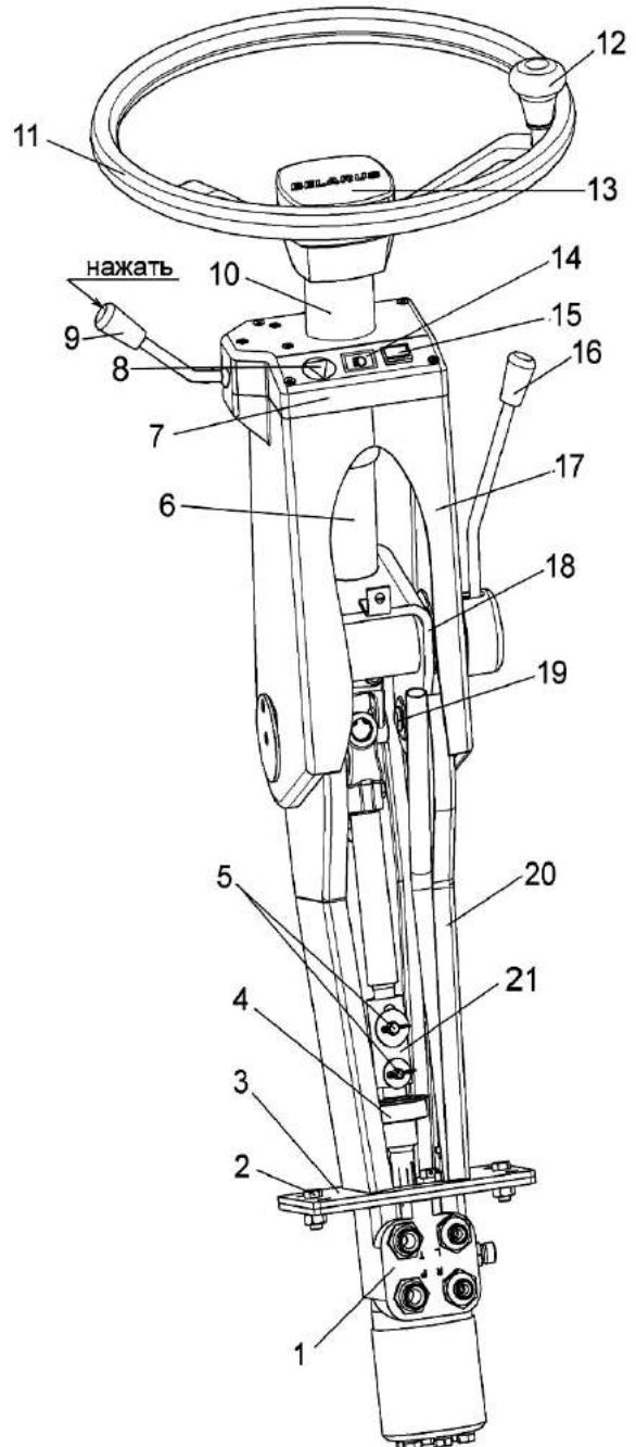
1 – насос дозатор; 2 – болт; 3, 18 – кронштейны; 4 – опора; 5, 19 – оси; 6 – вал рулевой; 7 – крышка; 8 – включение/выключение аварийной сигнализации; 9 – подрулевой переключатель с кнопкой включения звукового сигнала; 10 – колпак; 11 – колесо рулевое; 12 – ручка; 13 – крышка; 14 – контрольная лампа включения дальнего света; 15 – контрольная лампа указателей поворотов; 16 – рукоятка фиксации угла наклона колонки; 17 – кожух; 20 – стойка; 21 – втулка
