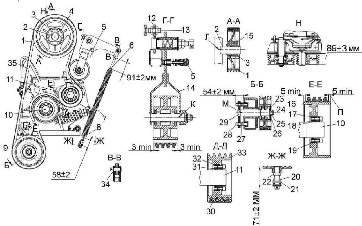
1, 33 – шкивы; 2 – вал ускорителя; 3 – болт; 4 - пластина; 5 – фиксатор; 6, 8, 13, 22, 28 – гайки; 7 – пружина; 9, 16 – ролики; 10 – вал вальца нижнего; 11 – вал вальца верхнего; 12, 29 – опоры; 14 - рычаг; 15, 18, 31 – ступицы; 17, 23, 32 - втулки; 19, 30 - винты; 20 - пальцы; 21, 26 – шайбы; 24 - гайка специальная; 25 – шайба специальная; 27 – шпилька; 34 – ось; 35– ремень; К – ось рычага; Л – ось вала ускорителя; М – ось опоры
