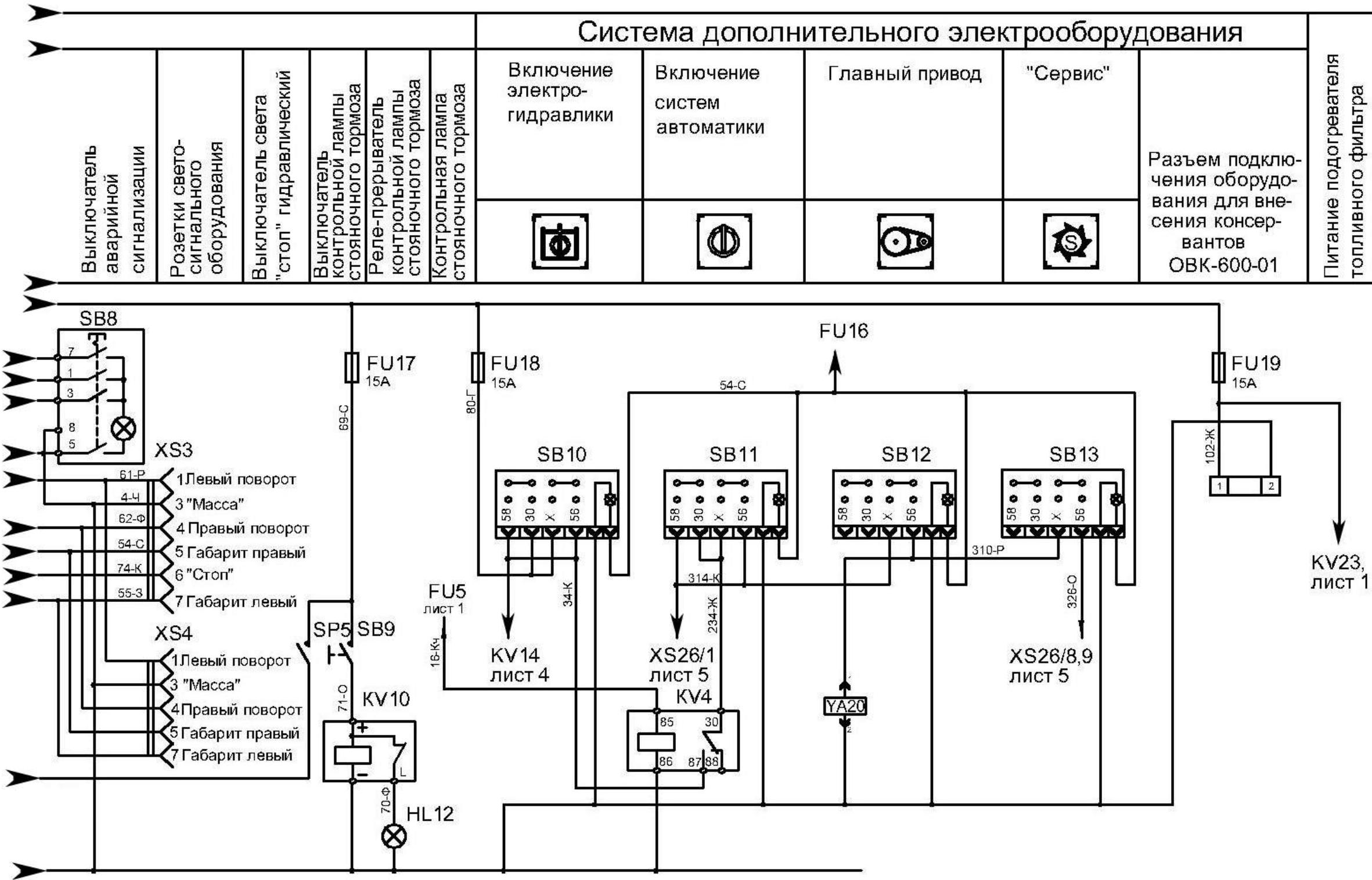
Рисунок Б.2 – Схема электрическая принципиальная комплекса (лист 2)
