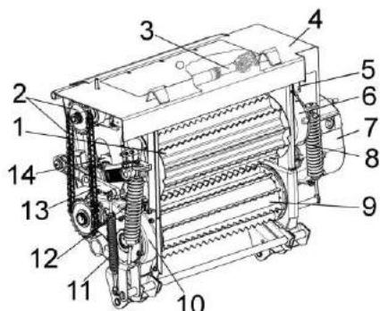
1 – валец верхний передний; 2 – передача цепная; 3 – вал карданный; 4 – корпус; 5 – датчик камнедетектора; 6 – редуктор верхних вальцев; 7 – коробка передач; 8, 11, 12 – пружины; 9 – валцы нижние; 10 – редуктор нижних вальцев; 14 - валец верхний задний
