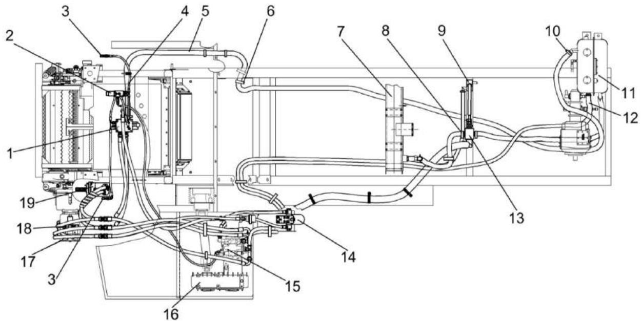
1 – гидроблок адаптеров; 2 – гидроблок управления адаптерами; 3 – точки диагностики; 4, 5, 12 – рукава; 6, 8, 10 – хомуты; 7 – радиатор масляный; 9 – коллектор; 11 - бак масляный; 13 – клапан обратный; 14 – фильтр напорный; 15 – гидронасос двухсекционный; 16 – редуктор привода гидронасосов; 17 – гидромотор привода питающего аппарата с гидроблоком экстренного останова; 18 - полумуфта заправочная; 19 – гидромотор привода адаптеров
