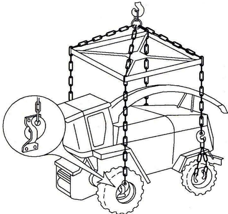
Рисунок 6.1 – Схема строповки
