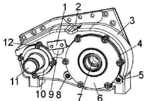
1 – упор; 2 – сапун; 3 – корпус; 4, 12 – прокладки; 5 – пробка сливная; 6, 10 – крышки; 7 – колесо; 8 – пробка контрольная; 9 – ось промежуточной шестерни; 11 – вал-шестерня
