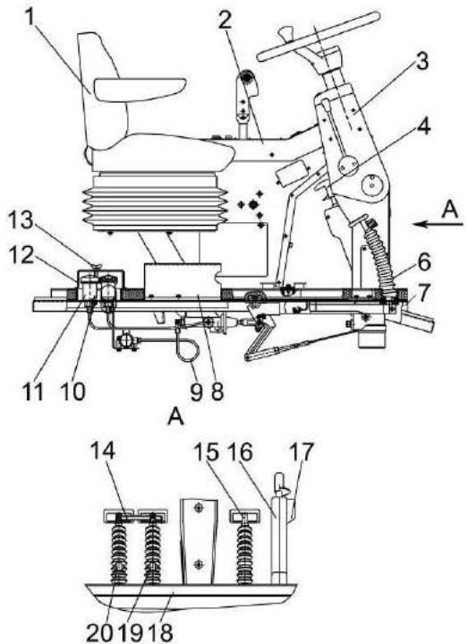
1 – сиденье; 2 – пульт управления; 3 – рулевая колонка; 4 – рукоятка стояночного тормоза; 6 – чехол; 7 – площадка; 8 – кронштейн сиденья; 9 – трубопровод; 10 – шпилька; 11 – бачок главного цилиндра тормоза; 12, 16, 17 – крышки; 13 – гайка; 14 – пластина; 15 – педаль управления блокировкой коробки диапазонов; 18 – коврик; 19, 20 – педали управления тормозами
