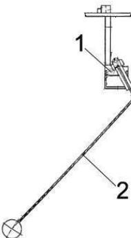
1 - резистор датчика указателя уровня топлива; 2 - датчик указателя уровня топлива
