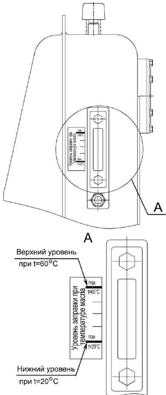
Рисунок 2.2 – Заправка гидросистем
