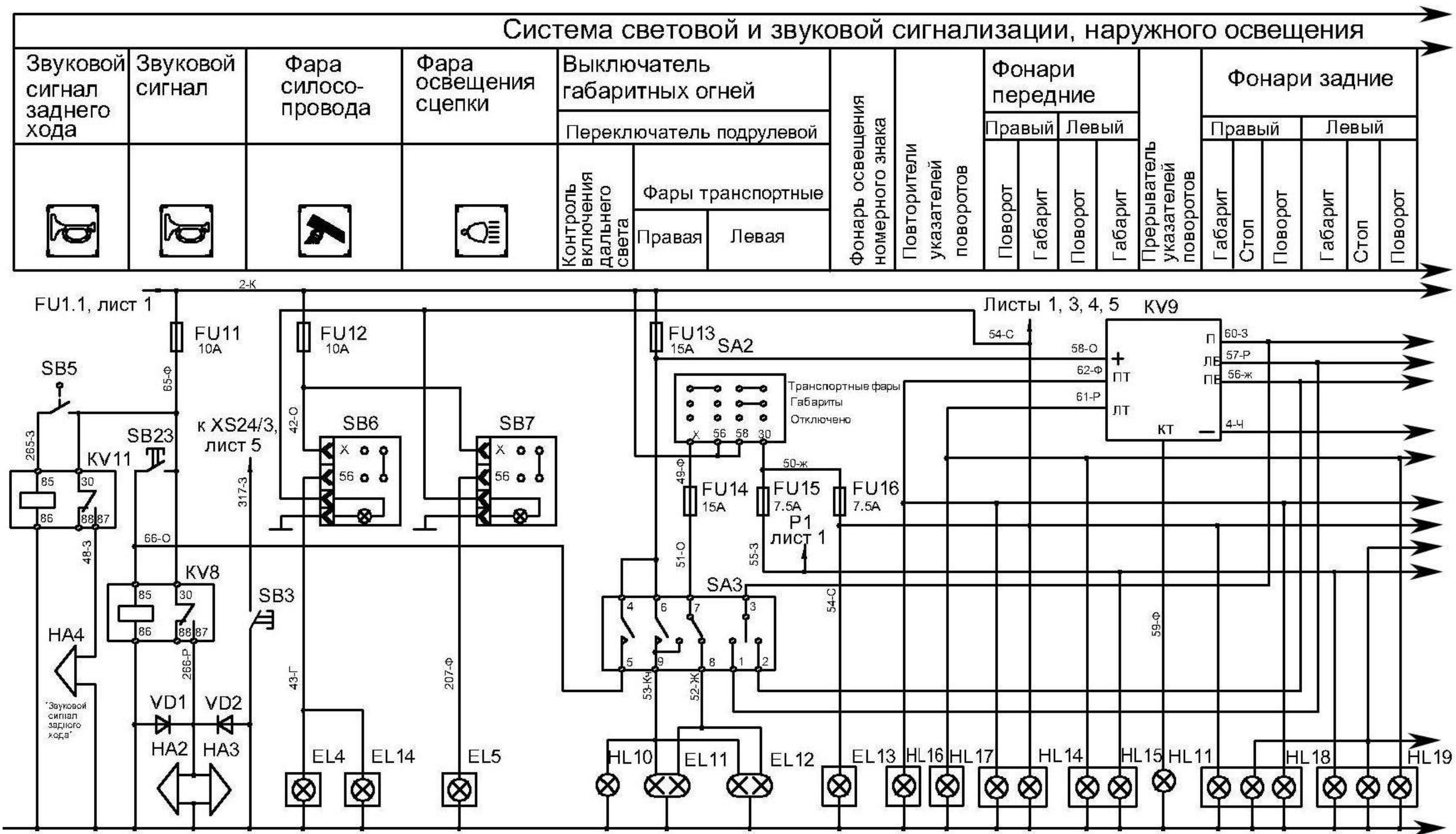
Рисунок Б.2 - Схема электрическая принципиальная комплекса (лист 1)
