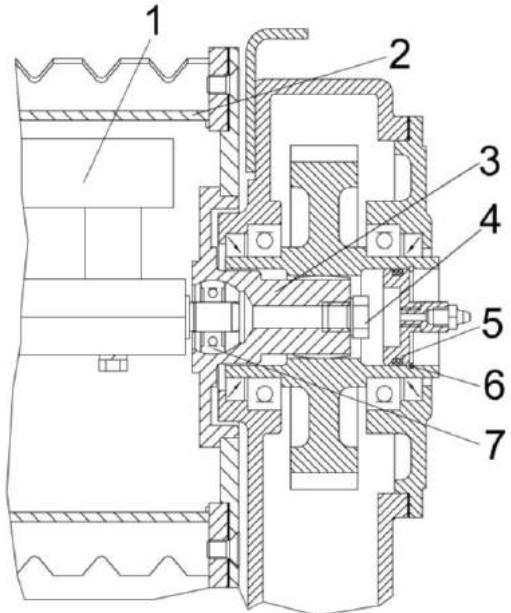
1 – датчик металлодетектора; 2 – валец передний нижний; 3 – фланец со шлицевым валом; 4 – пробка; 5 – заглушка; 6 – кольцо стопорное; 7 – подшипник
