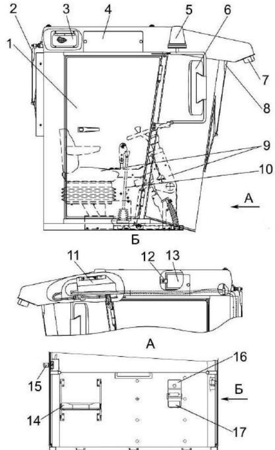
1 – дверь; 2 – задний стеклоочиститель; 3 – клапан; 4 – крышка; 5 – маяк проблесковый; 6 – зеркало; 7 – рабочие фары; 8 – передний стеклоочиститель; 9 – площадка управления; 10 – рычаг переключения передач; 11 – испаритель; 12 – прижим; 13 – фильтр; 14 – дополнительное сиденье; 15 – ручка дверная; 16 – аптечка; 17 – держатель аптечки
