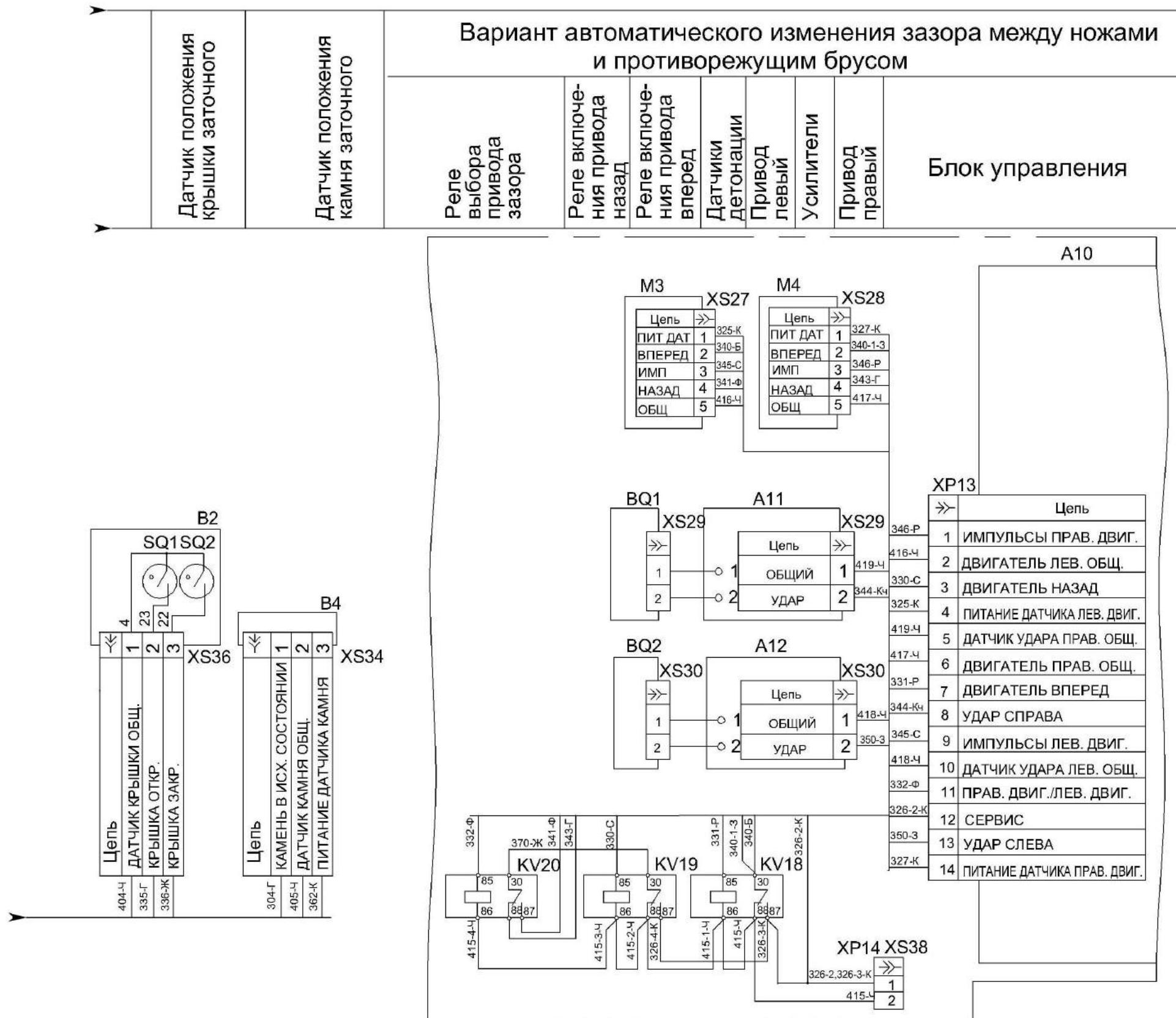
Рисунок Б.5 – Схема электрическая принципиальная комплекса (лист 3)
