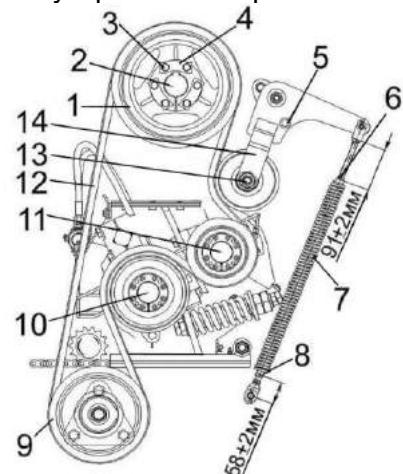
1 – шкив; 2 – вал ускорителя; 3 – болт; 4 - пластина; 5 – фиксатор; 6, 8 – контргайки; 7 – пружина; 9 – ролик; 10 – вал вальца нижнего; 11 – вал вальца верхнего; 12 – ремень; 13 - бонка; 14 - рычаг
