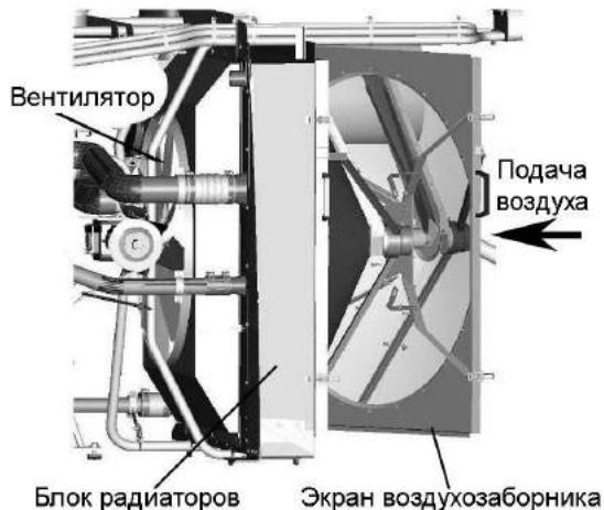
Рисунок 3.1 - Обдувка сжатым воздухом блока радиаторов
