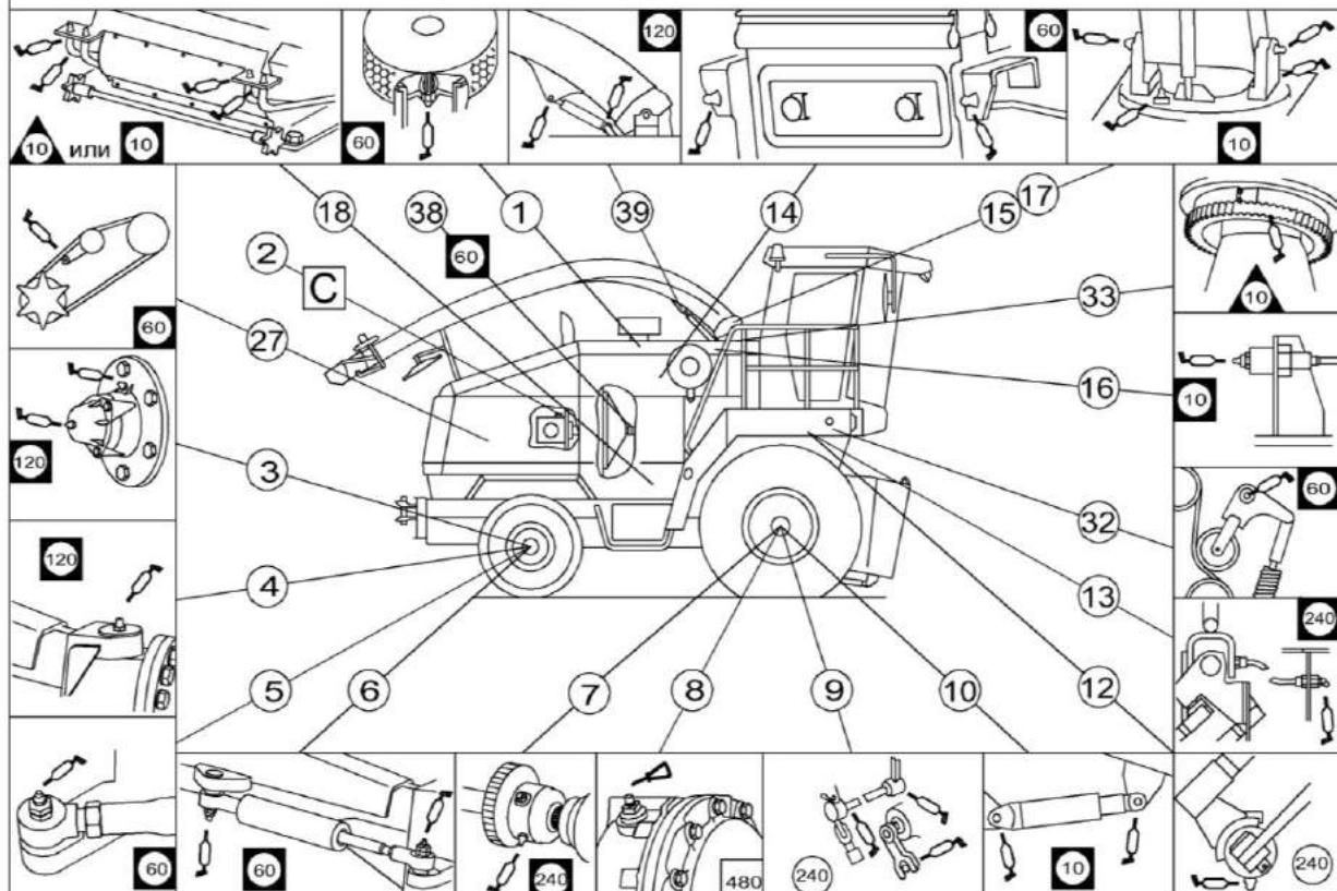
Рисунок 3.1 – Схема смазки измельчителя (вид справа)
