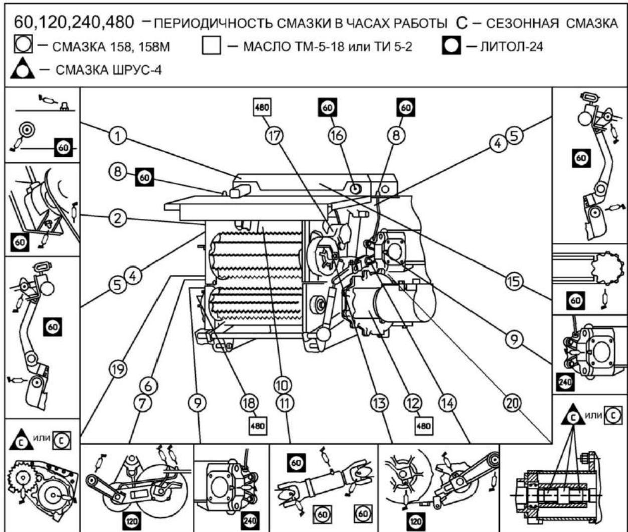
Рисунок 3.3 – Схема смазки питающе - измельчающего аппарата измельчителя
