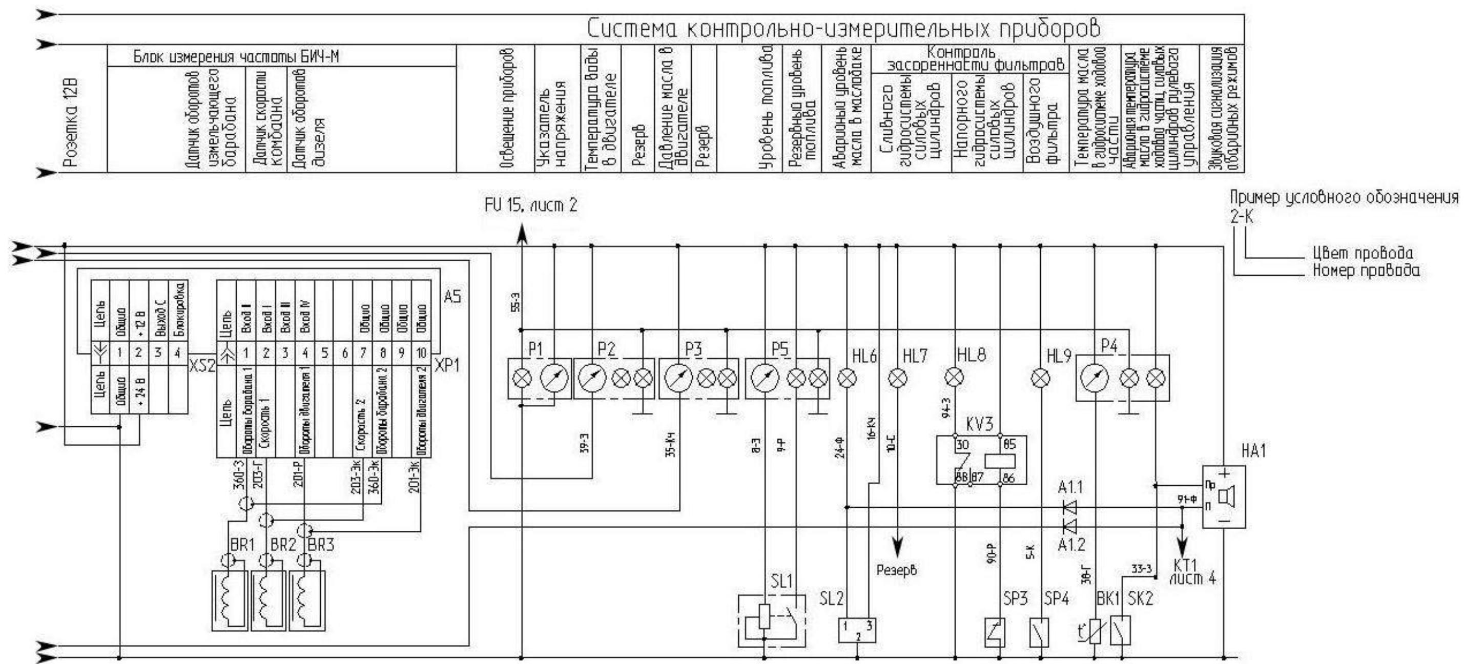
Рисунок Б.1 – Схема электрическая принципиальная комплекса (лист 3)
