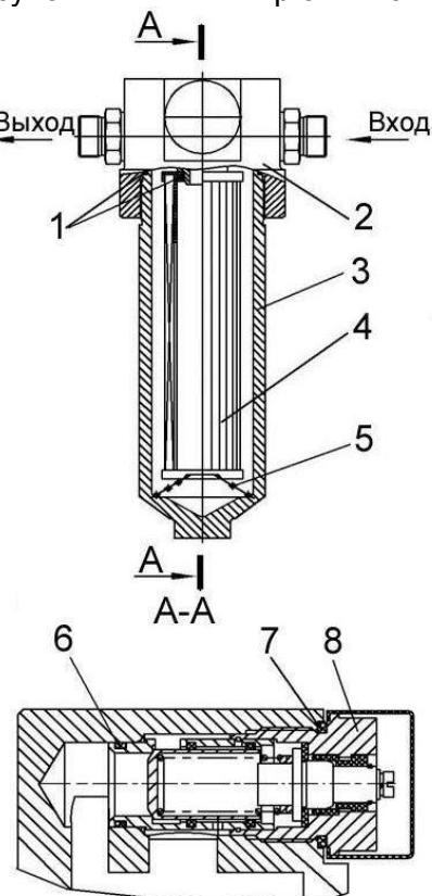
1,6,7, - кольца уплотнительные; 2 – головка фильтра; 3 – стакан; 4 - фильтроэлемент; 5 – пружина; 8 – клапан - сигнализатор
