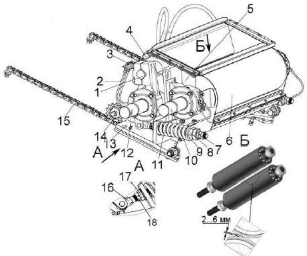
1 - вал; 2 – трубка; 3 – масленка; 4 – гидросистема регулировки зазора; 5 – корпус; 6 - кожух верхний; 7, 18 – контргайки; 8– гайка; 9 – гильза; 10 – валец верхний; 11 – пружина; 12 – валец нижний; 13 – опора; 14 – механизм перемещения; 15 – цепь; 16 – тяга; 17 – упор
