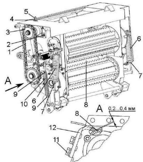
1 – цепь; 2, 4 – гайки; 3 – звездочка
