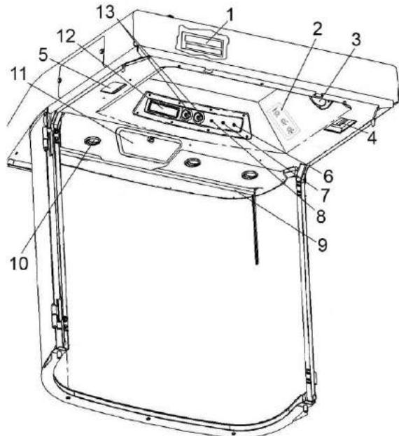
1 – крышка блока предохранителей; 2 – панель управления климатической установкой 3 – динамик автомагнитолы; 4 – фильтр рециркуляции воздуха; 5 – плафон освещения кабины; 6 – кнопка включения задних рабочих фар; 7 – кнопка включения передних рабочих фар; 8 – кнопка включения маяков; 9 – солнцезащитная шторка; 10 – дефлекторы; 11 – охлаждаемый бокс; 12 – место для магнитолы; 13 – ручки включения стеклоочистителей
