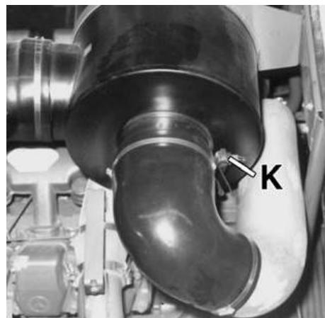
Рисунок 3.7 – Расположение контактного выключателя К
