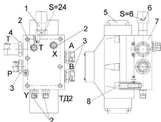
1 – клапан предохранительный; 2, 3, 5 – штуцера; 5 – гидрораспределитель; 6 – винт регулировочный предохранительного клапана; 7 – плита; 8 – винт
