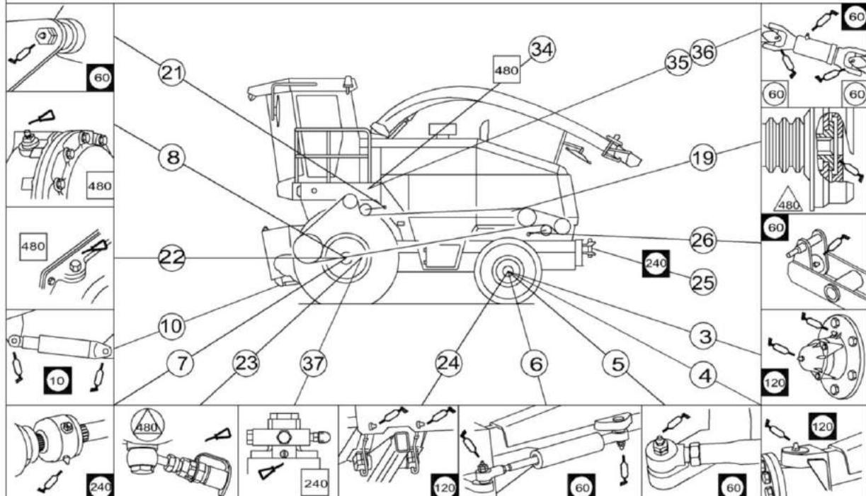
Рисунок 3.2 – Схема смазки измельчителя (вид слева)
