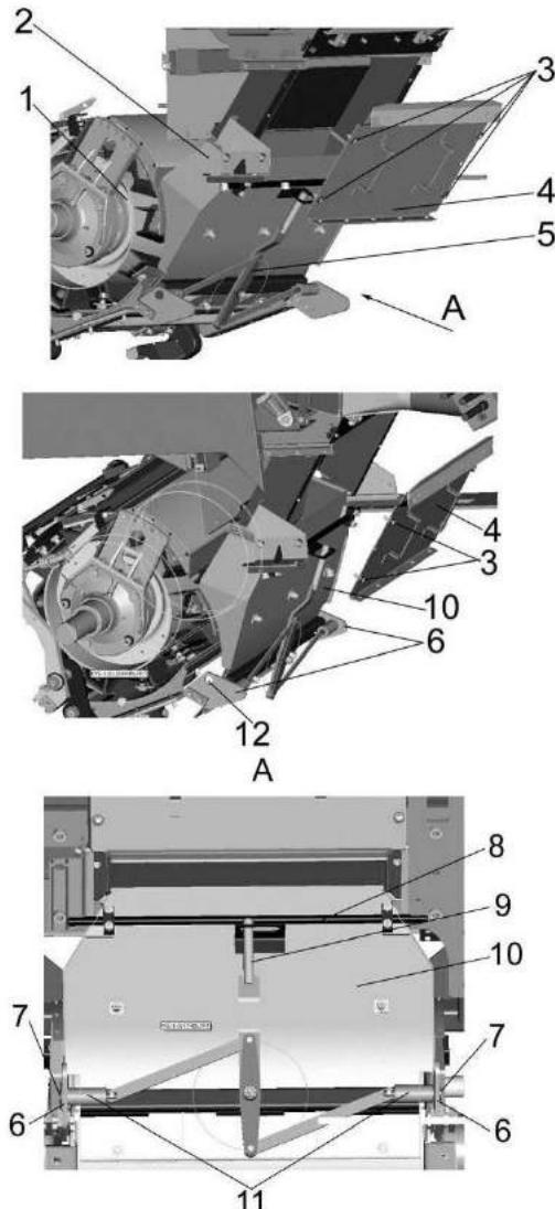
1 – барабан измельчающий; 2 – технологический тракт; 3 – фиксаторы быстросъемные; 4 – крышка; 5 – механизм открытия приемной камеры; 6 – направляющие; 7 – фиксаторы; 8 – ось; 9 – рычаг; 10 – приемная камера; 11 – втулки; 12 – отверстия для фиксации
