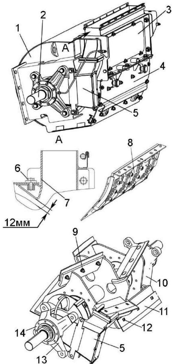
1 – корпус ускорителя; 2 – вал ускорителя выброса; 3 – стенка задняя; 4 – поддон; 5 – воздуховод; 6, 12 – болты; 7 – отсекатель; 8 – поддон бичевой; 9 – гайка; 10, 13 - корпуса; 11 – лопасть; 14 – крышка
