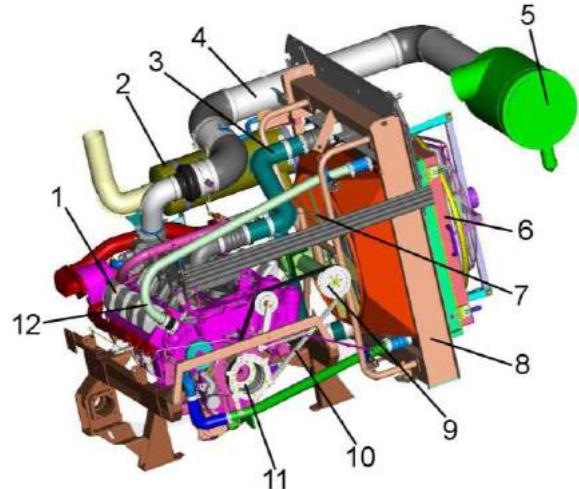
1 – двигатель; 2 – глушитель; 3, 12 – трубы водяные; 4 – труба воздушная; 5 – воздухоочиститель; 6 – воздухозаборник; 7 – вентилятор; 8 - блок радиаторов; 9 - редуктор привода вентилятора; 10 – ремень; 11 – главный привод
