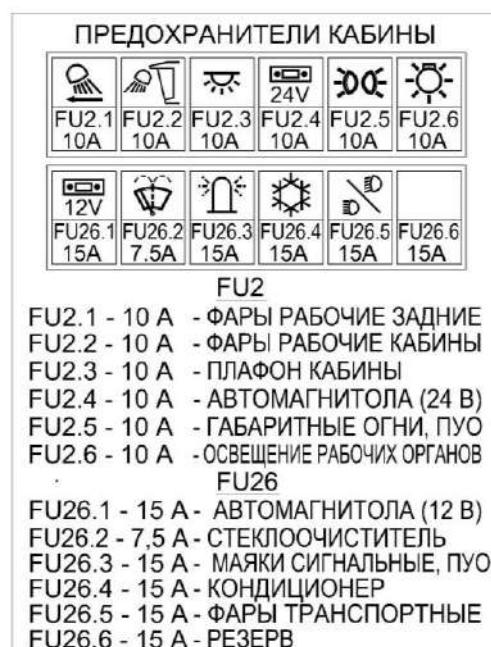
Рисунок 1.37 – Схема расположения предохранителей
