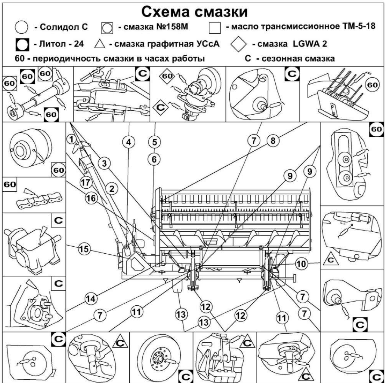
Рисунок 24 – Схема смазки
