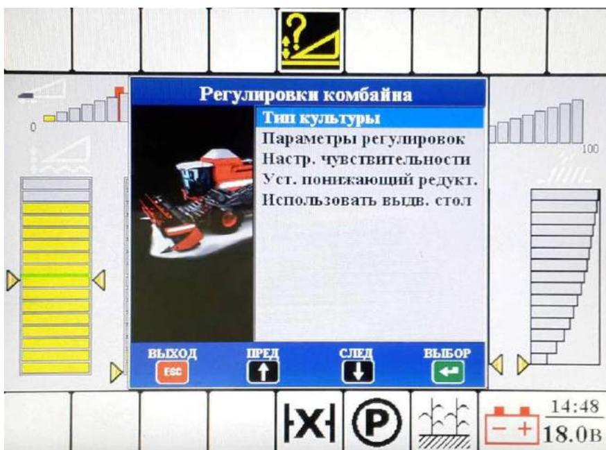
Рисунок Ж. 4 – Вид окна «Регулировки комбайна»
