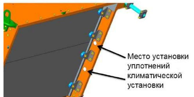
Рисунок 3.11 – Места прокладки рукавов климатической установки
