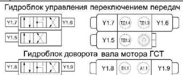
Рисунок 1.18 – Схема гидроблоков
