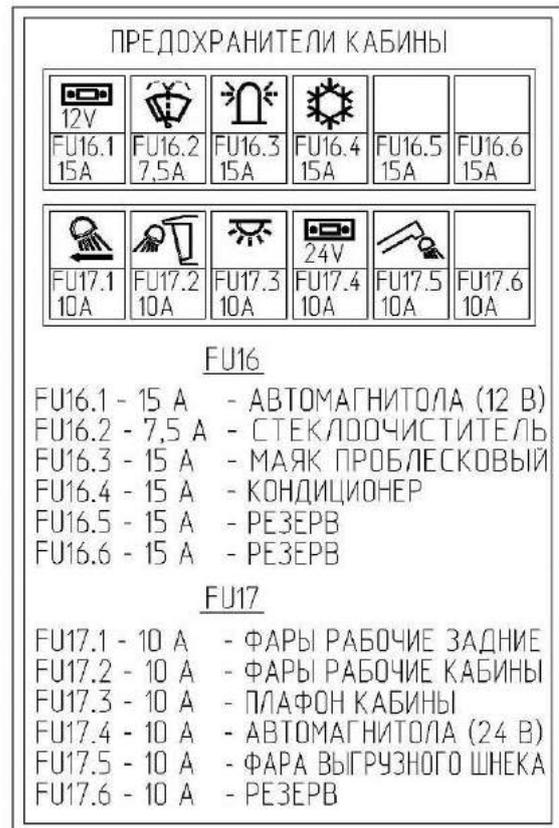
Рисунок 1.44 – Схема расположения предохранителей
