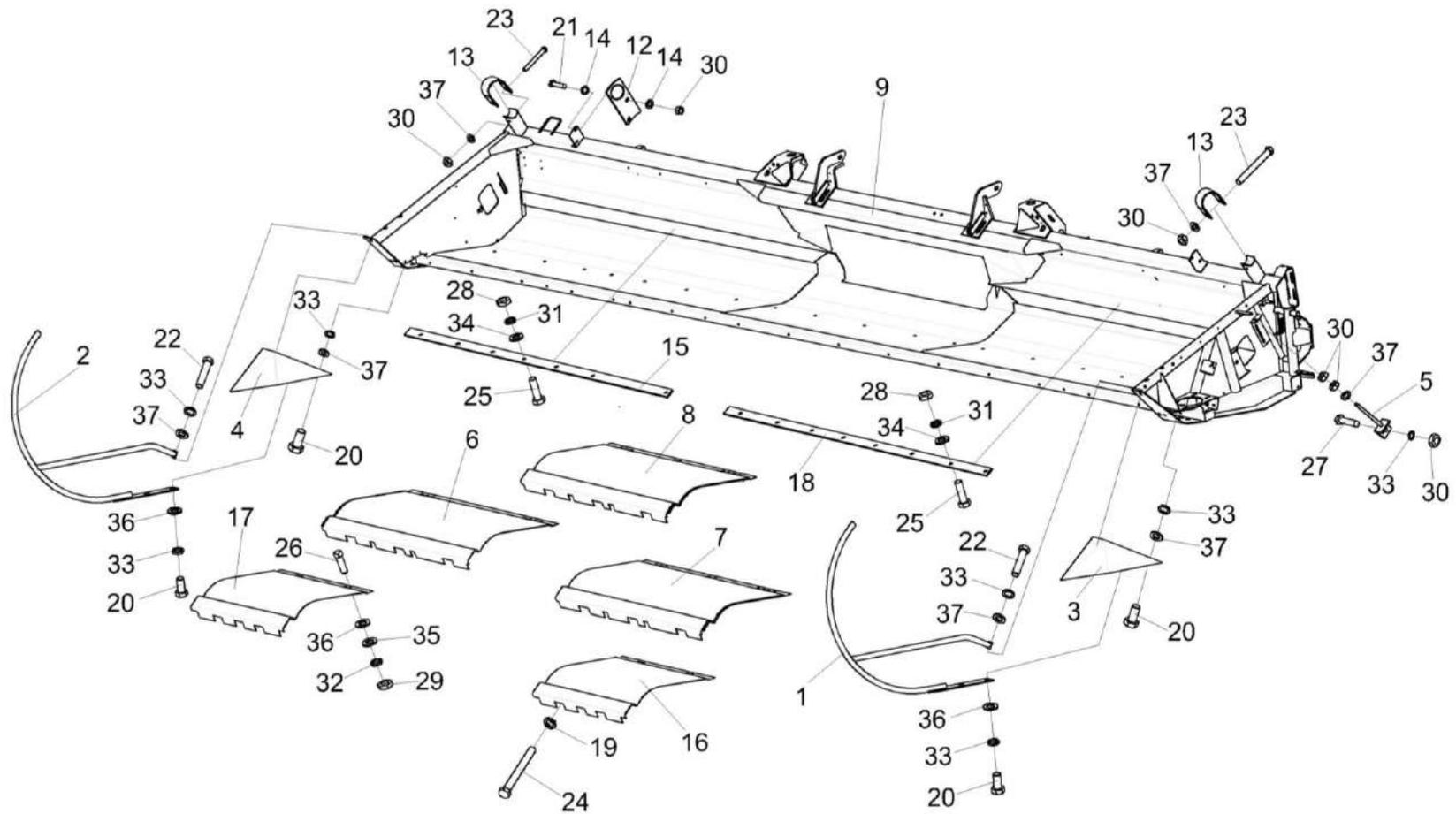
Рисунок 4 – Установка делителя КЗР 1518100 и КЗК-9-1518100
