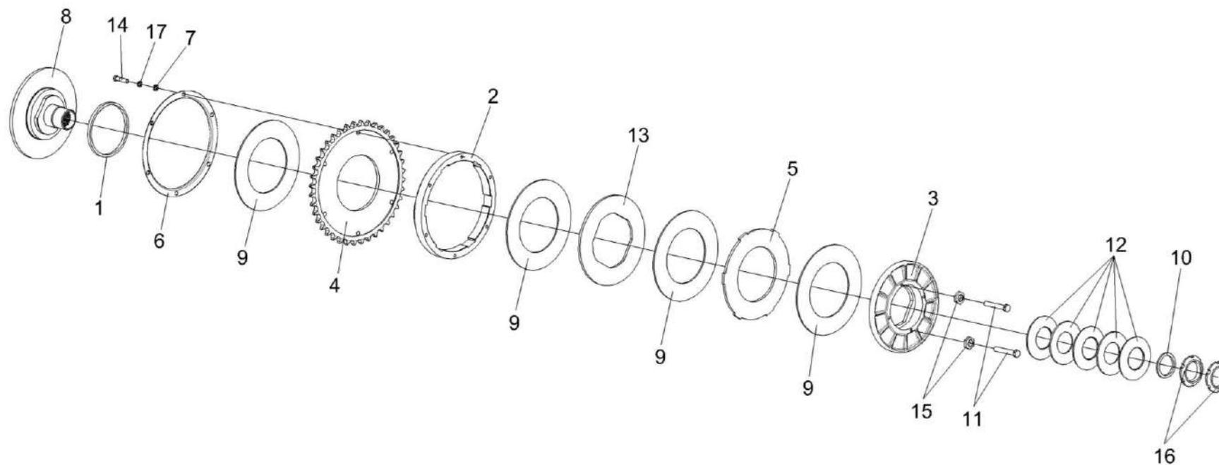
Рисунок 16 – Муфта предохранительная КГС 0202100-02
