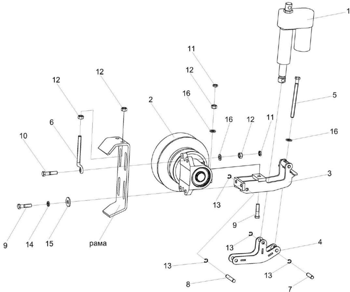
Рисунок 10 – Установка электромеханизма КЗР 0700390-01 или МК-150М-02
