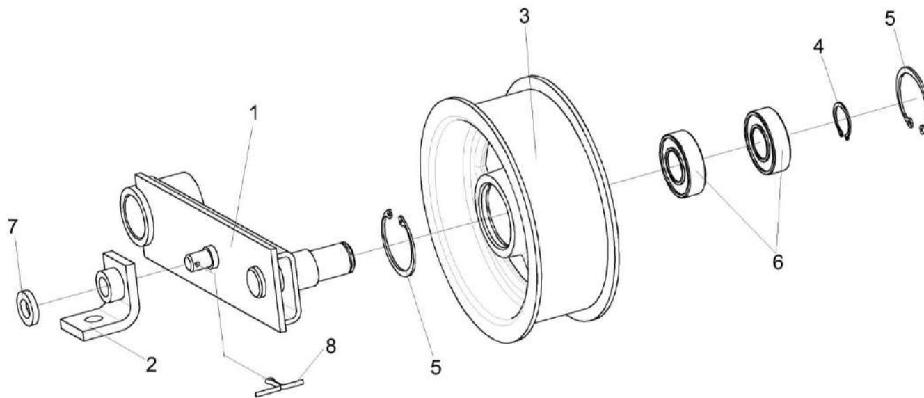
Рисунок 14 – Устройство натяжное КЗР 1512000
