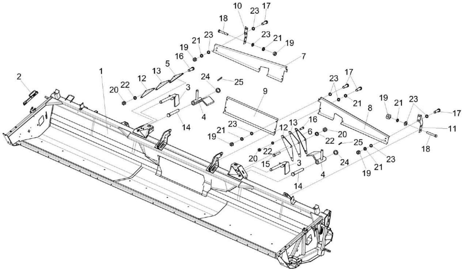
Рисунок 3 – Установка надставки КЗР 1500429, КЗР 1500429-01 и КЗР 1500432-01
