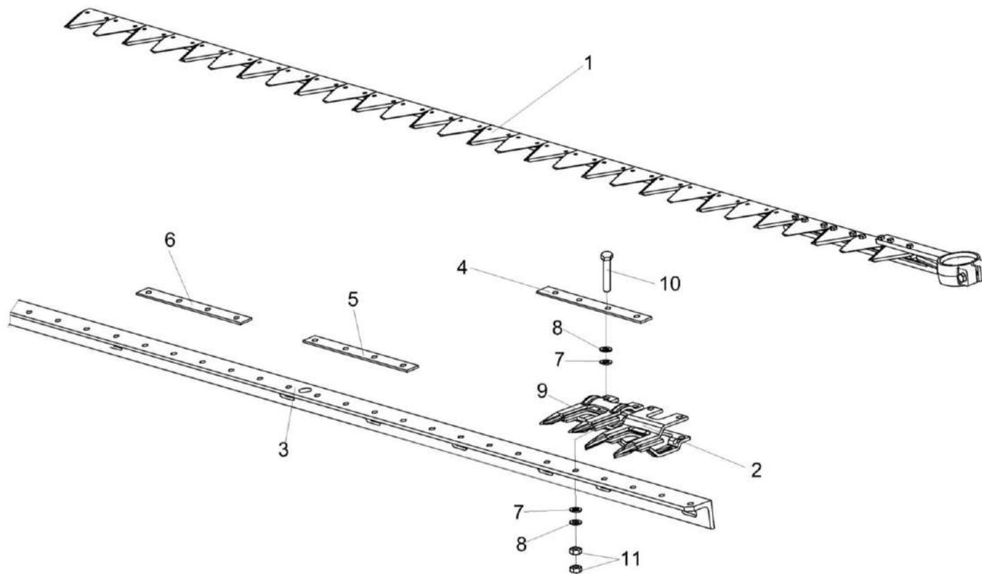
Рисунок 30 – Аппарат режущий КЗР 1507000-21
