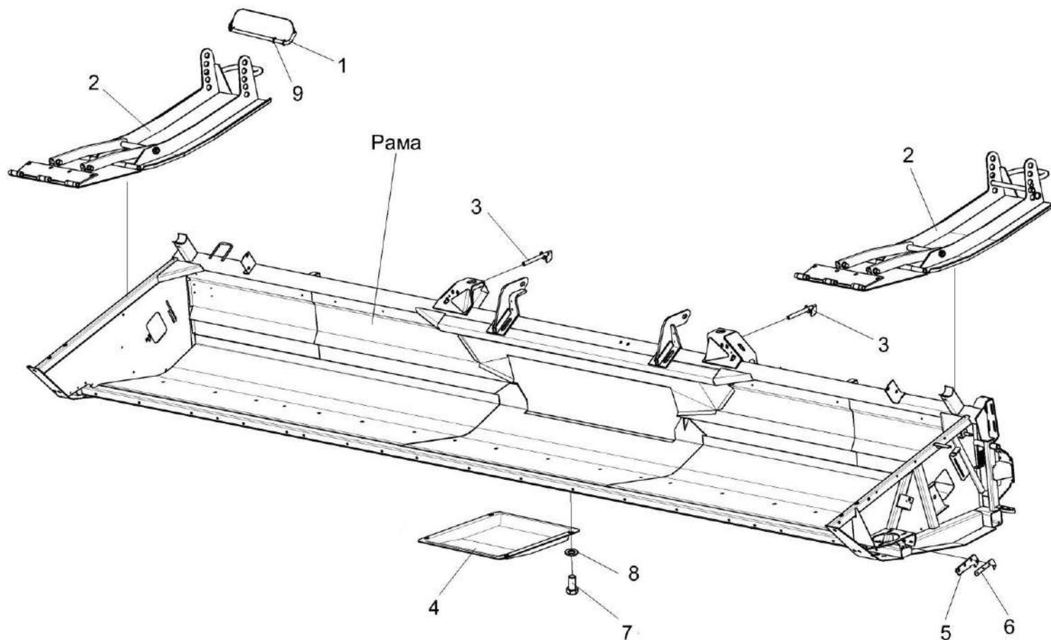
Рисунок 5 – Установка башмака КЗР 1516300 и КЗР 1500416
