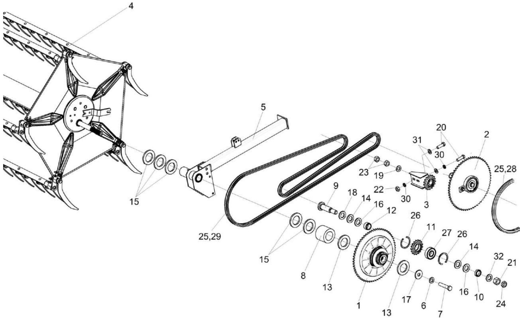
Рисунок 41 – Привод мотовила КЗК-12-1573010
