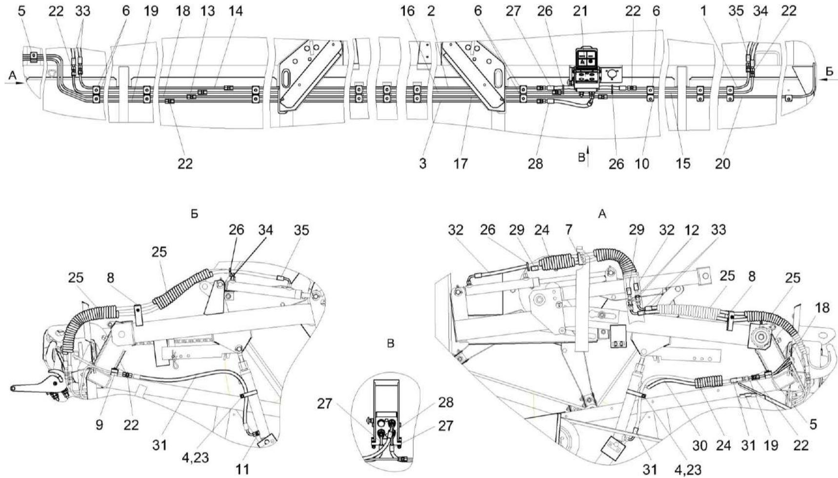
Рисунок 43 – Гидросистема жатки ЖЗК-7-6 КЗК-7-1-1589000
