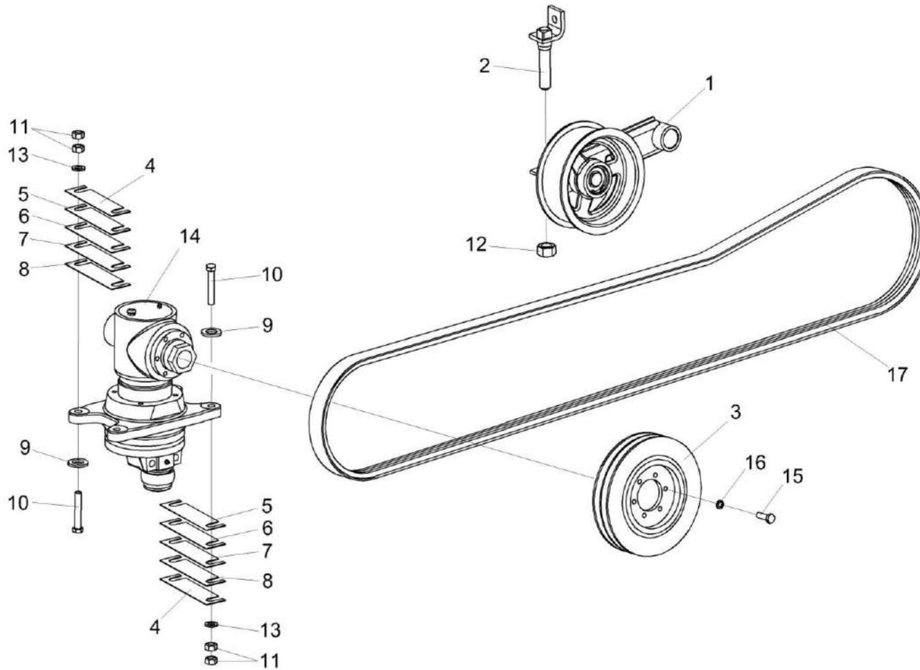
Рисунок 23 – Привод аппарата режущего КЗР 1507000-21
