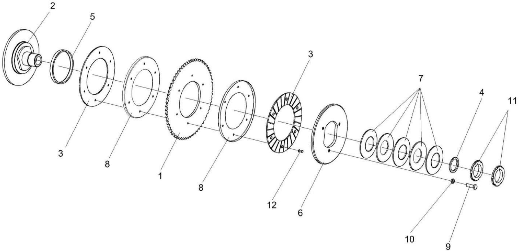
Рисунок 17 – Муфта фрикционная КЗР 1503140А
