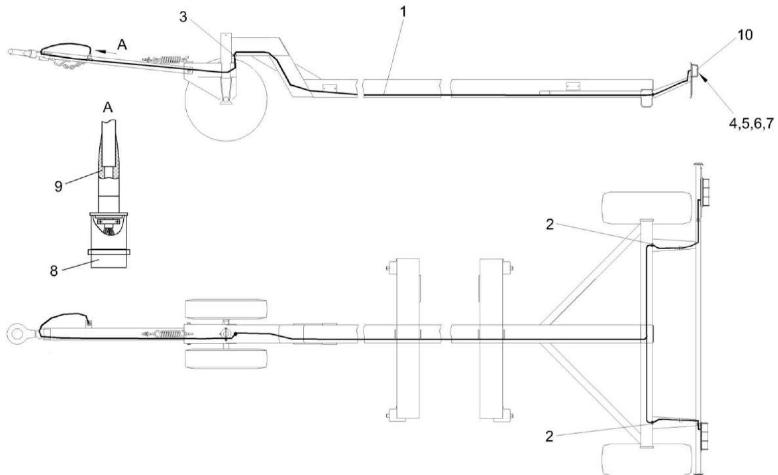
Рисунок 49 – Электрооборудование тележки транспортной КВК 0715900-03
