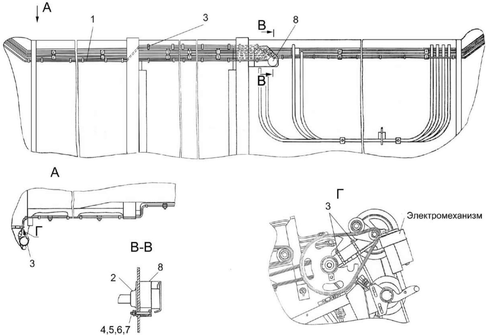
Рисунок 42 – Электрооборудование жатки для зерновых культур КЗР 1500000-09
