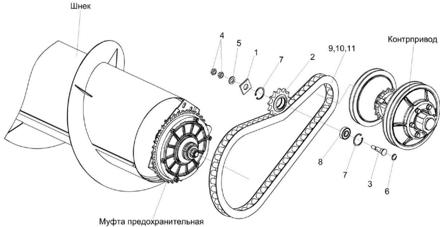
Рисунок 35 – Привод шнека КЗК-12-1502000А-01
