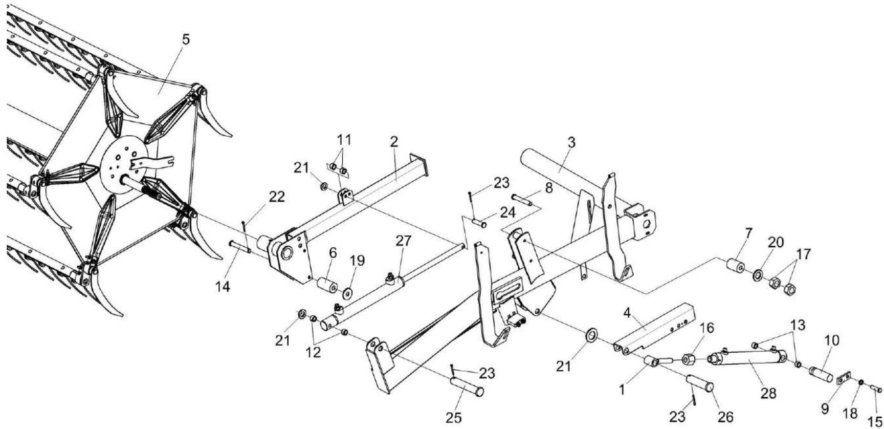
Рисунок 37 – Установка мотовила КЗК-12-1573010 (лист 2)
