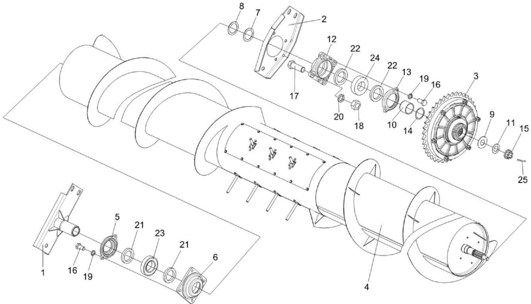
Рисунок 33 – Установка шнека КЗК-12-1502000А-01
