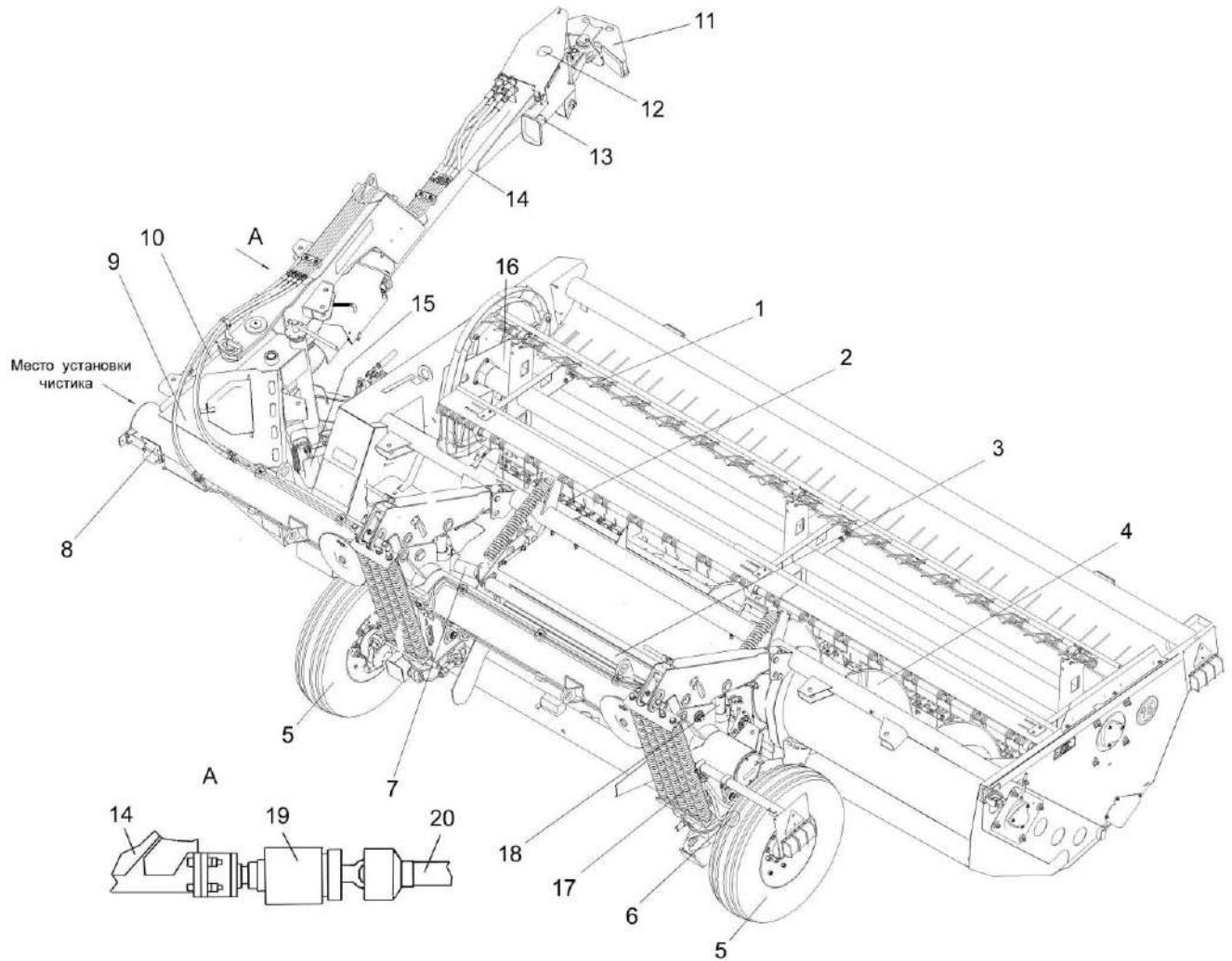
1 - мотовило; 2 - режущий аппарат; 3 - плющильный аппарат; 4 - шнек; 5 - колесо; 6 - механизм поворота колесного хода; 7, 12, 20 - карданные валы; 8 - световозвращатель; 9 - рама навески; 10 - тяга; 11 - ограничитель поворота; 13 - домкрат; 14 - сница; 15 - опорное колесо; 16 – жатка для трав; 17 – механизм вывешивания; 18 – механизм подъема и опускания жатки; 19 – предохранительная муфта
