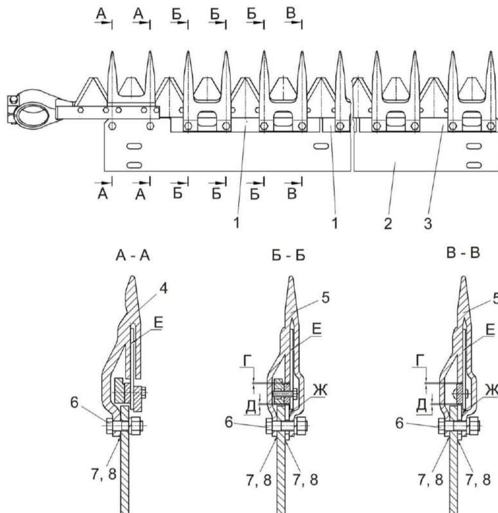
1, 3 – пластины трения; 2 – брус; 4 – палец направляющий сдвоенный; 5 – палец сдвоенный; 6 – гайка; 7 – регулировочная прокладка; 8 – прокладка
