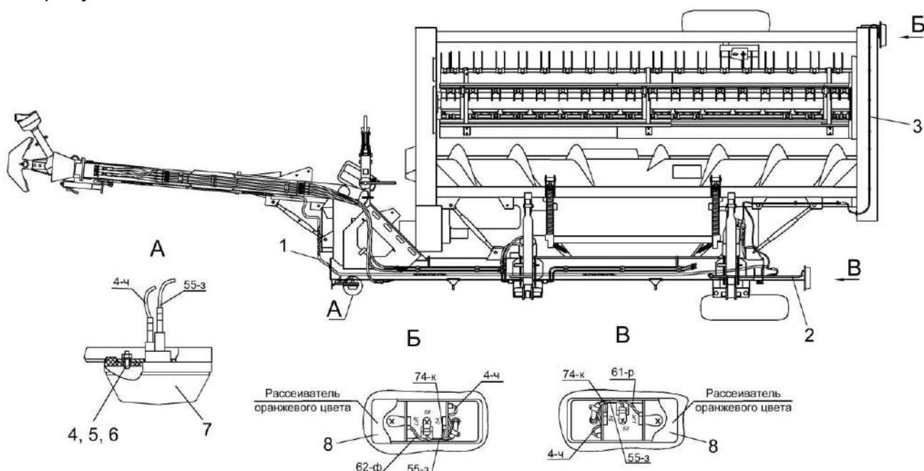
1 - центральный жгут; 2 - жгут левого фонаря; 3 - жгут правого фонаря; 4 - винт (М5-бех20); 5 - гайка (М5-6Г); 6 - шайба (5Т.65Г.06); 7 - фонарь 161.3712010; 8 - задний фонарь многофункциональный 7303.3716
