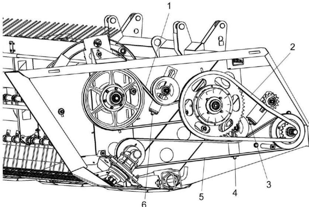
1 – ременная передача привода мотовила; 2 - цепная передача привода шнека; 3, 4, 6 – винты; 5 - ременная передача привода режущего аппарата
