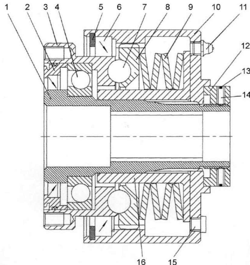
1 – вал; 2 – крышка; 3 – стакан; 4 – подшипник; 5, 13 – стопорные кольца; 6 – манжета; 7 – шарик; 8 – диск; 9 – пружина; 10 – корпус; 11 – масленка; 12 – гайка; 14 – винт; 15 – предохранительный клапан; 16 – втулка
