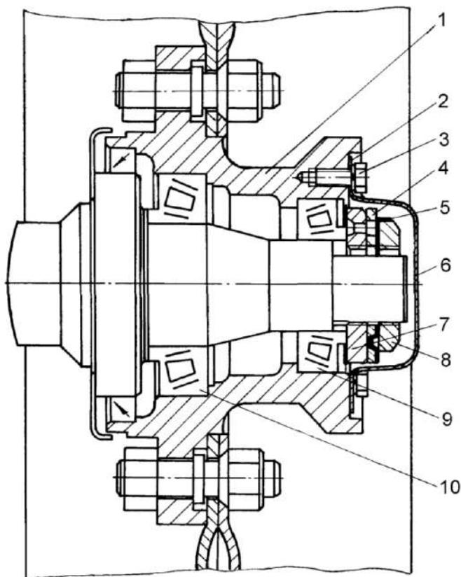
1 - ступица; 2 - прокладка; 3 - болт; 4 - замковая шайба; 5 - замочная шайба; 6 - крышка; 7 - гайка-шайба; 8 - гайка; 9, 10 – подшипники
