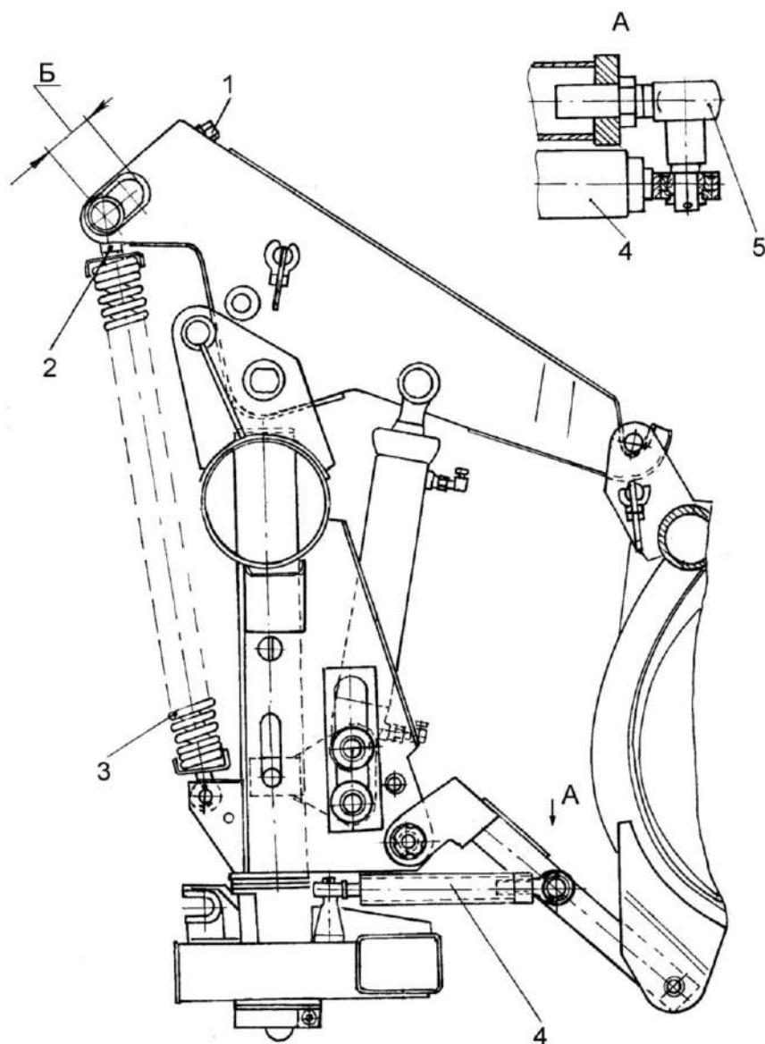
1, 2 - винты; 3 - пружина; 4 - гидроцилиндр; 5 – тяга
