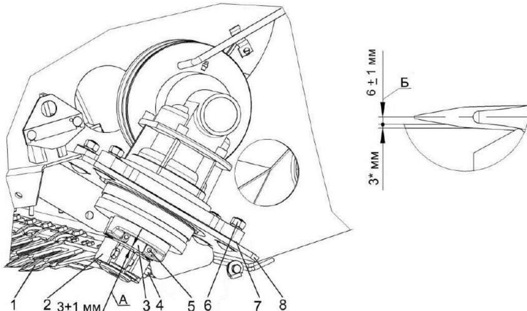
1 – режущий аппарат; 2 – головка ножа режущего аппарата; 3 – водило; 4 – болт;
