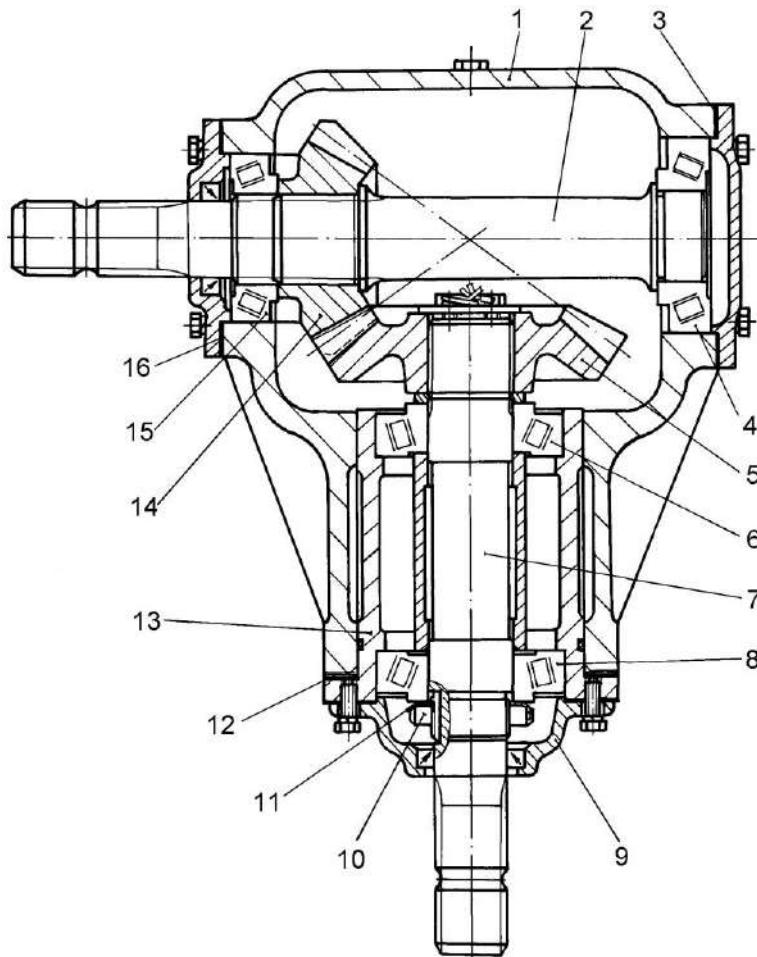
1 - корпус; 2, 7 - валы; 3, 12, 16 - прокладки; 4, 6, 8, 15 - подшипники; 5, 14 - шестерни; 9 - крышка; 10 - гайка; 11 - шайба; 13 – стакан
