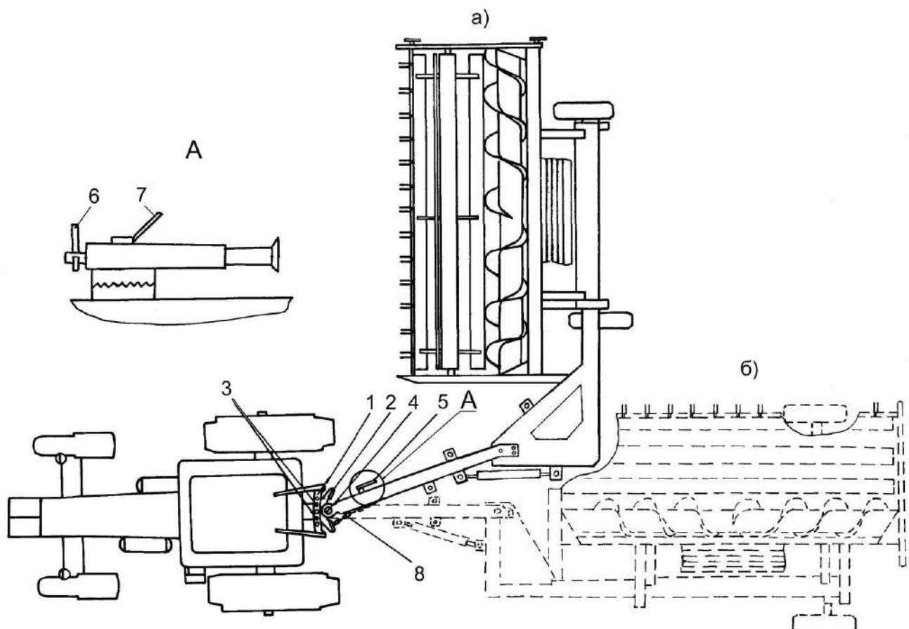
1 - поперечина; 2 - ограничитель; 3 - палец; 4 - палец-фиксатор; 5 - домкрат; 6 - рукоятка; 7 - фиксатор; 8 - страховочная цепь
