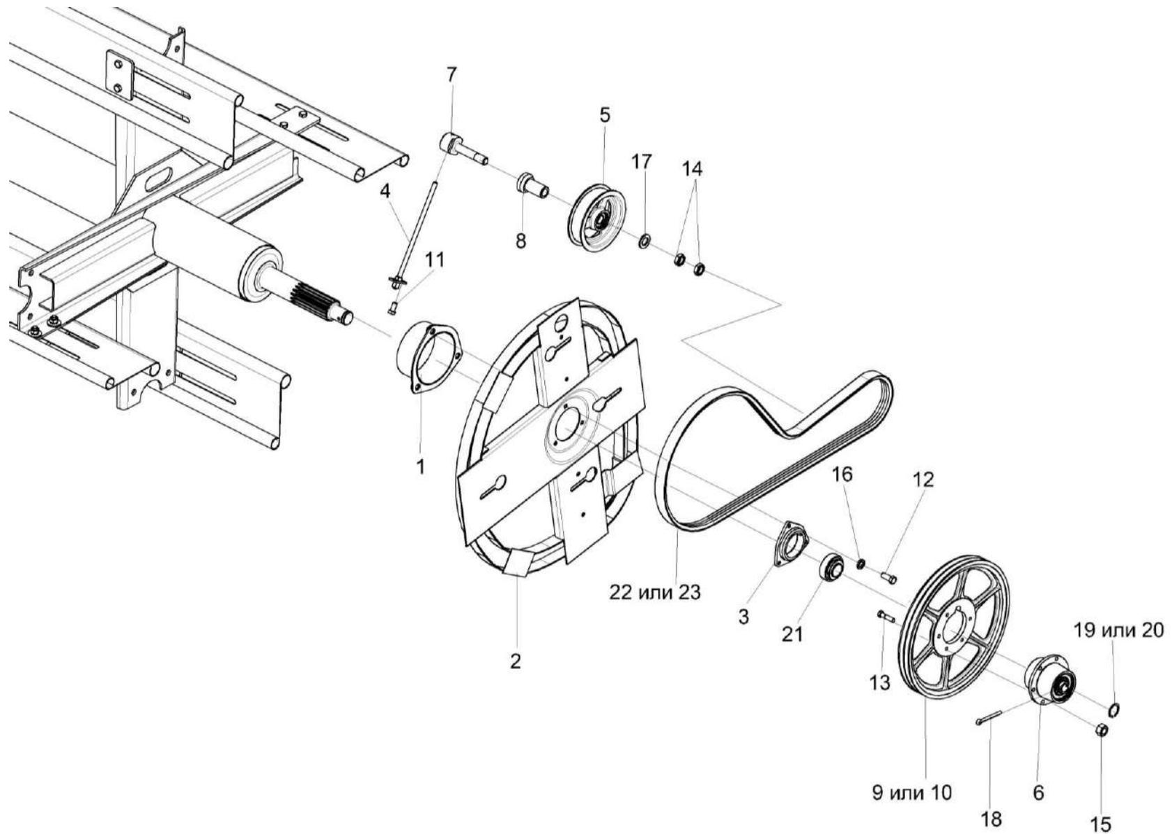
Рисунок 6 – Жатка для трав КС-100.12 КС-100-1200000 (установка мотовила КГК 1203000) (лист 1)
