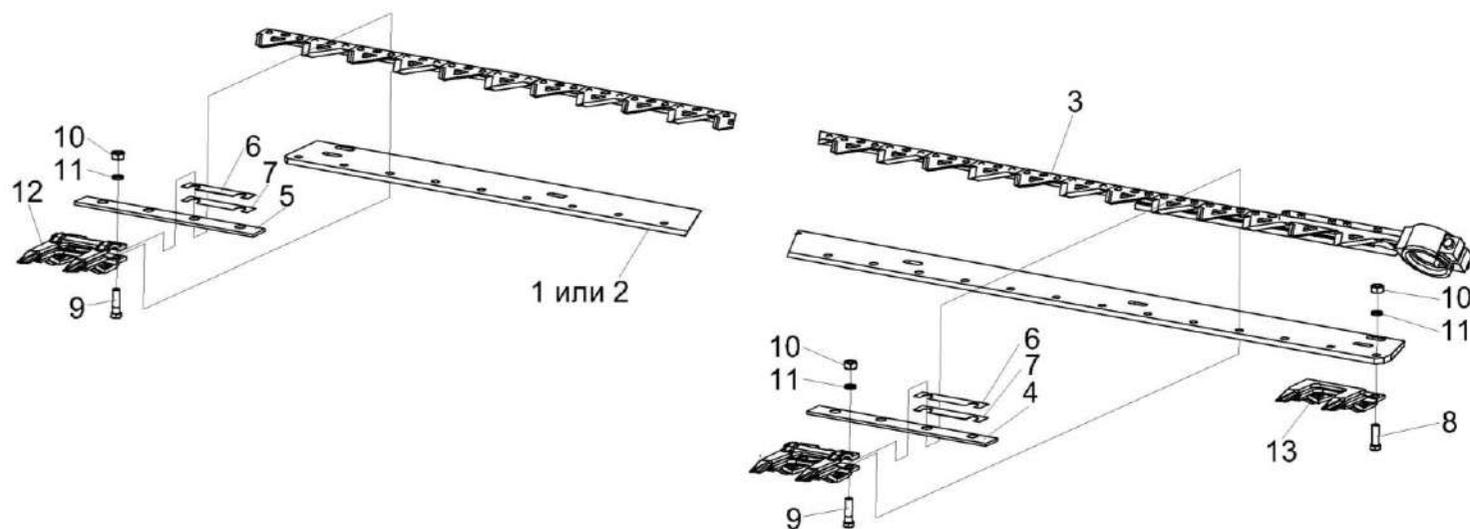
Рисунок 29 – Аппарат режущий КСК-6025-1207000
