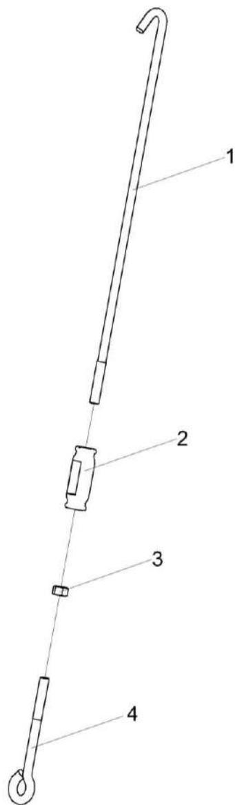
Рисунок 44 – Устройство натяжное ПКК 1209100 и КИС 0209020
