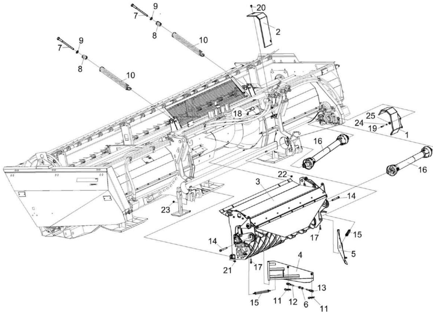
Рисунок 5 – Жатка для трав КС-100.12 КС-100-1200000 (установка аппарата плющильного КС-100-1207000)
