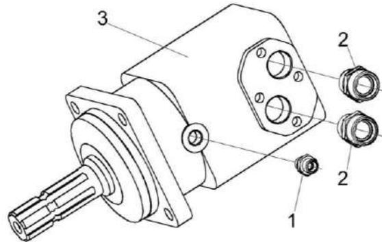
Рисунок 21 – Гидромотор привода режущего аппарата КС-200-0688210
