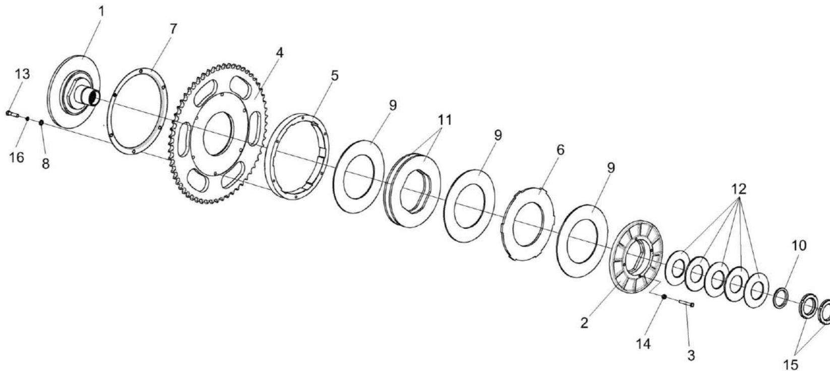
Рисунок 22 – Муфта предохранительная КГК 1202100-02
