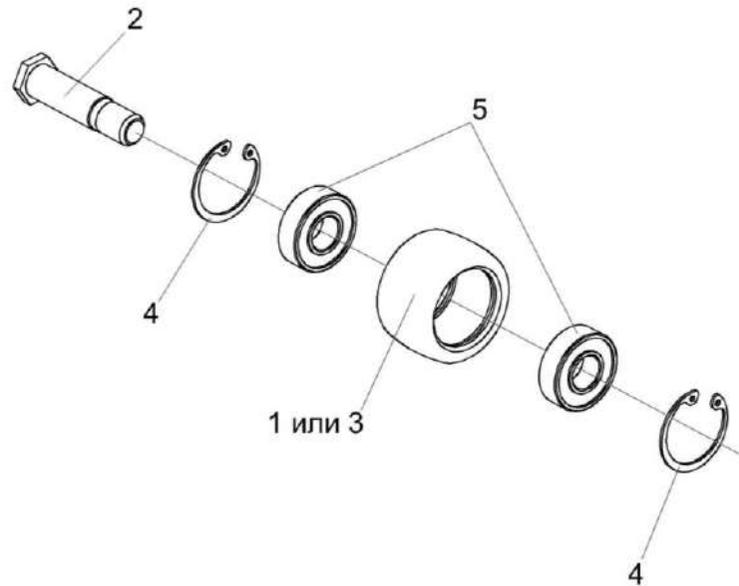
Рисунок 13 – Ролик КИС 0203120Б
