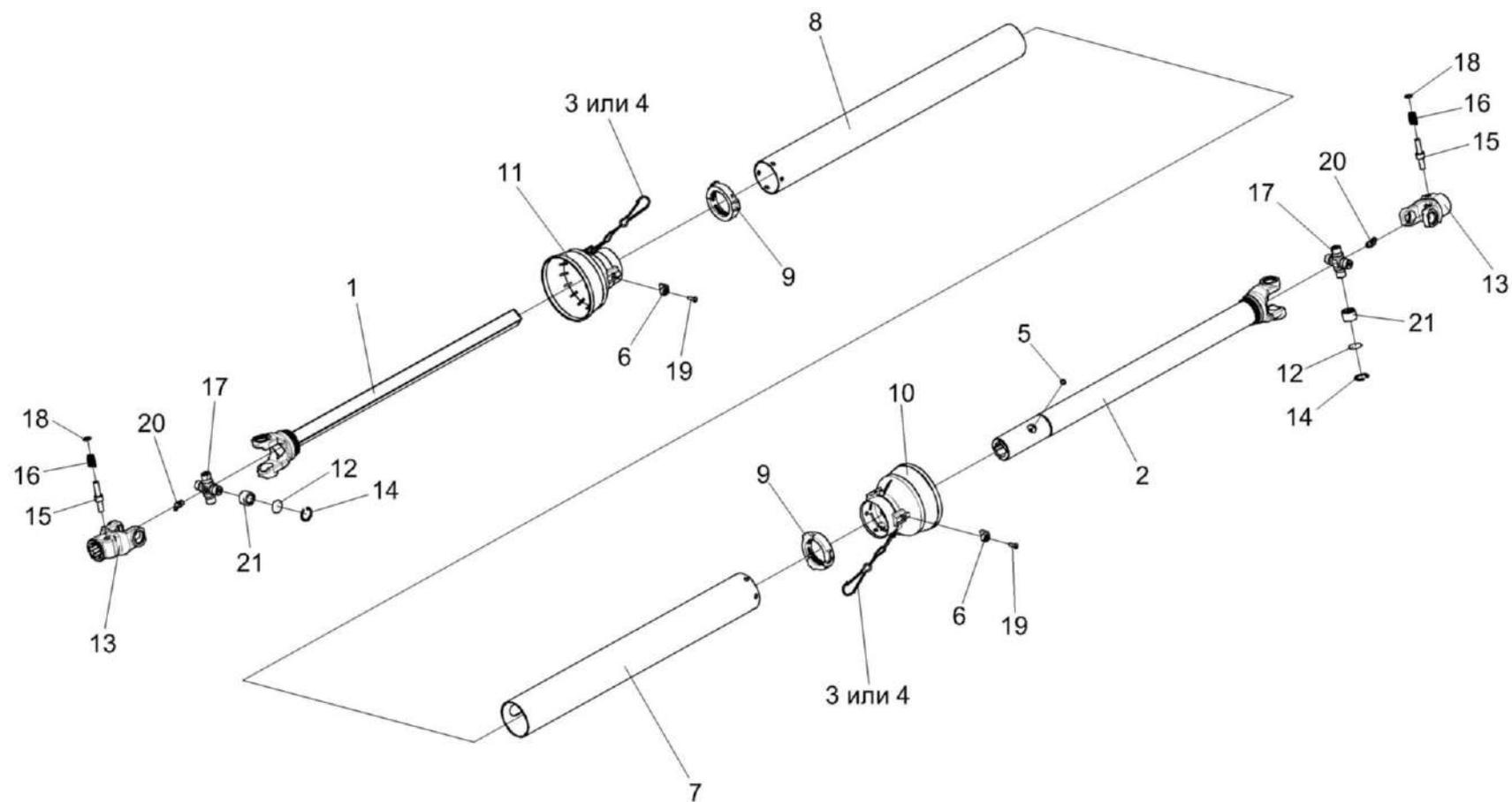
Рисунок 25 – Вал карданный телескопический КЗК 1909000
