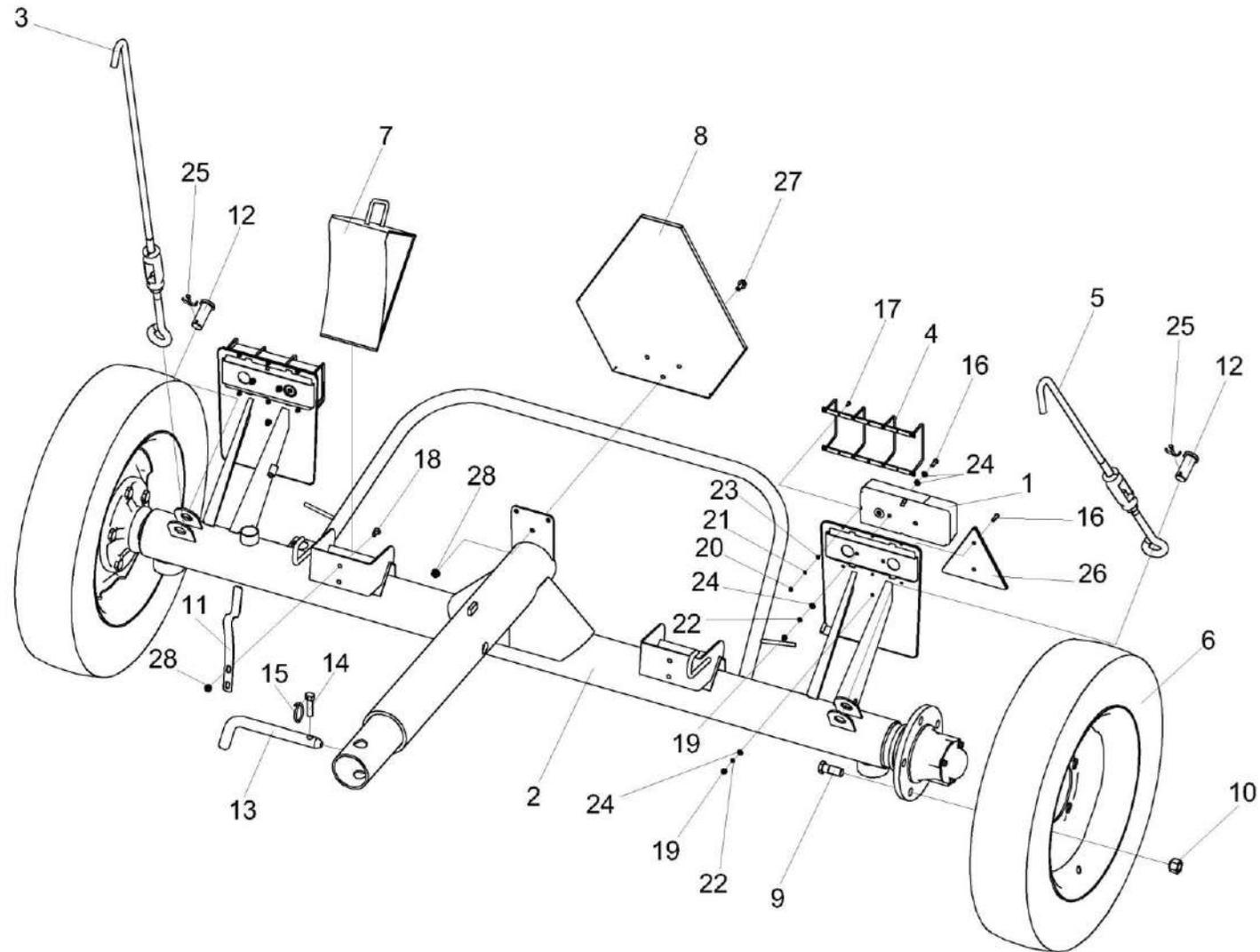
Рисунок 42 – Тележка задняя ПКК 1209000-01
