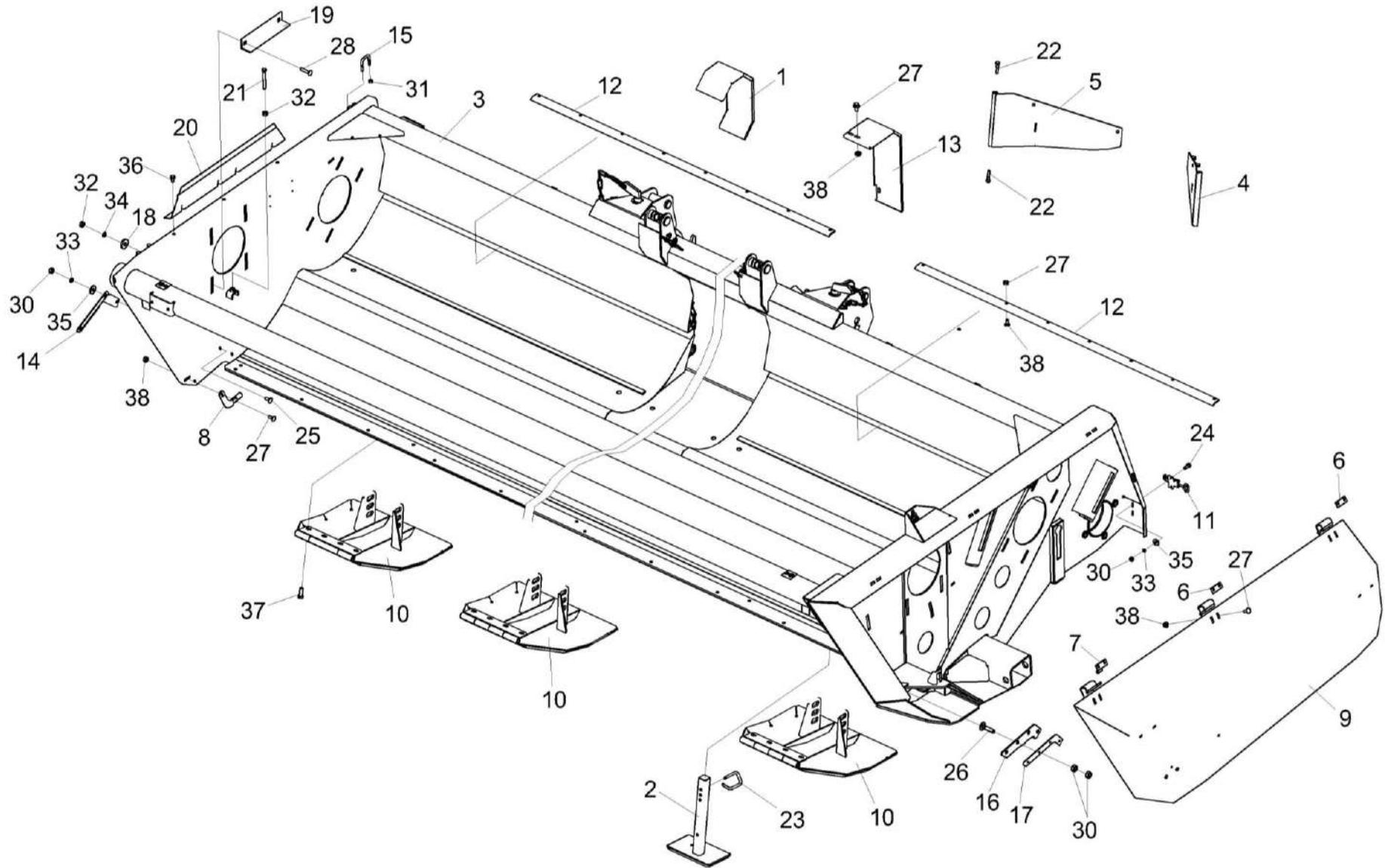
Рисунок 2 – Жатка для трав КС-100.12 КС-100-1200000 (установка щитков, кожухов и ограждений)
