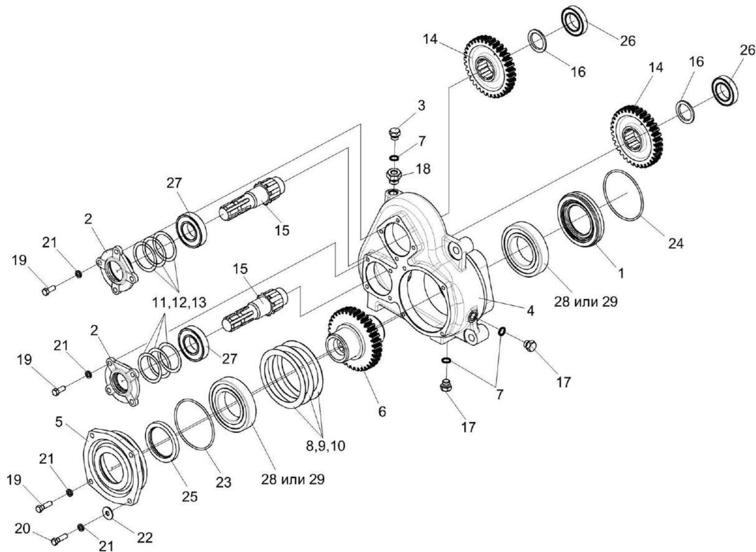
Рисунок 19 – Редуктор КС-100-1208000
