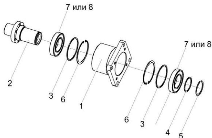
Рисунок 28 – Контрпривод КСК-6025-1204000А
