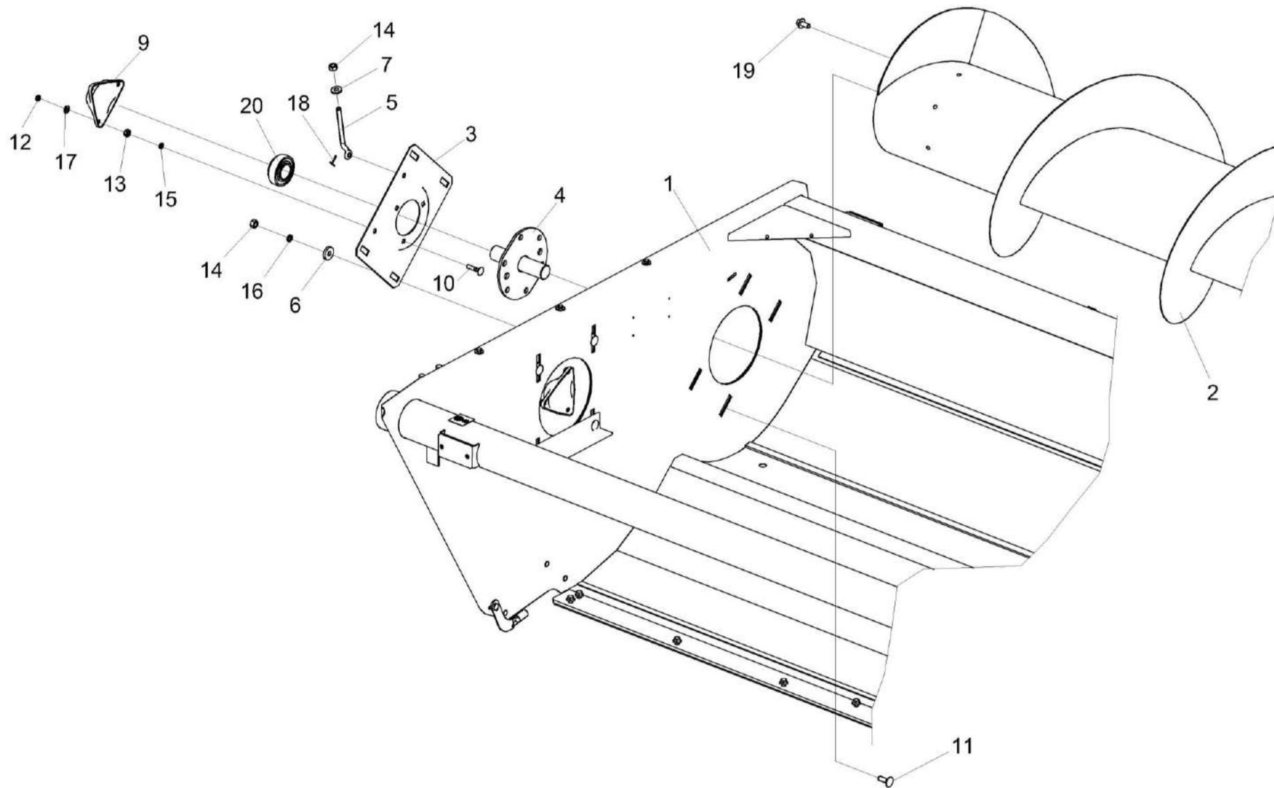
Рисунок 4 – Жатка для трав КС-100.12 КС-100-1200000 (установка шнека КС-100-1202000) (лист 2)
