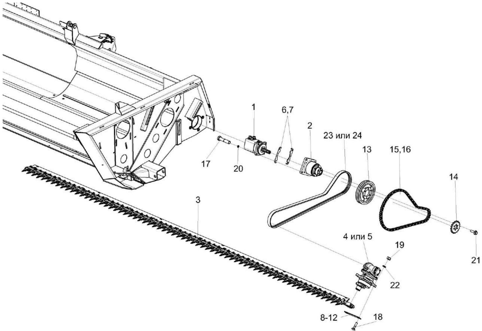
Рисунок 8 – Жатка для трав КС-100.12 КС-100-1200000 (установка аппарата режущего КСК-6025-1207000)
