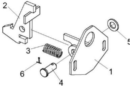
Рисунок 32 – Замок КПП 0212030
