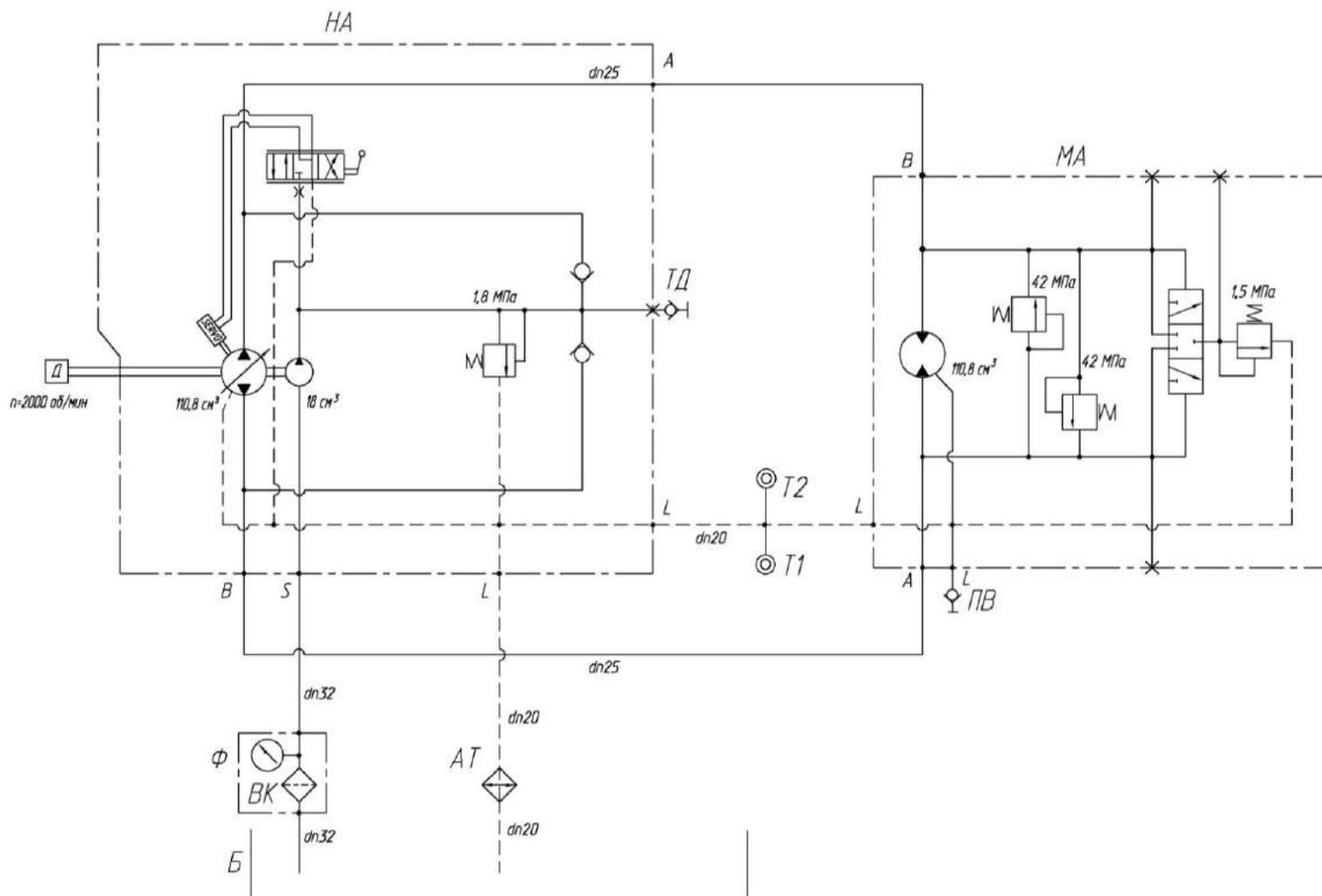
АТ– масляная секция радиатора; Б – бак масляный; МА – гидромотор аксиально-поршневой нерегулируемый; НА – насос аксиально-поршневой; ПВ – полумуфта внутренняя; Т1 – датчик указателя температуры; Т2 - датчик сигнализатора температуры; ТД - соединение резьбовое с колпачком; Ф – фильтр всасывающий; ВК - вакуумметр
