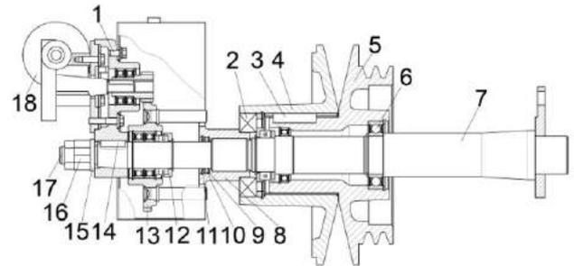
1 – болт; 2, 6 – подшипники; 3, 14 – шпонки; 4 – шкив подвижный; 5 – шкив неподвижный; 7 – ось; 8 – втулка; 9, 10, 11 – шайбы; 12 – корпус; 13 – колесо; 15 – шайба; 16, 17 – гайки; 18 – электропривод
