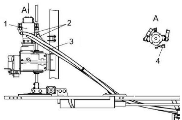
1 – гидромотор аксиально-поршневой нерегулируемый;
