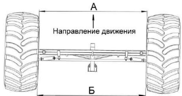
Рисунок 2.22 - Регулировка сходимости колес
