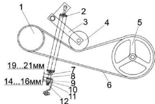
1, 5 – шкивы; 2 – пружина; 3 – рычаг; 4 – ролик натяжной; 6 – ремень; 7, 12 – контргайки; 8 – винт натяжной; 9 – зацеп; 10 – амортизатор; 11 – гайка
