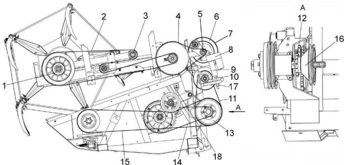
1 – муфта фрикционная; 2, 4, 14 – цепные передачи; 3, 5 – звездочки; 6, 13, 16 – шкивы; 7, 11, 15 – ременные передачи; 8 – исполнительный электромеханизм; 9 – вариатор; 10 – скоба; 12 – звездочка контрпривода; 17 – гайка; 18 – стяжка
