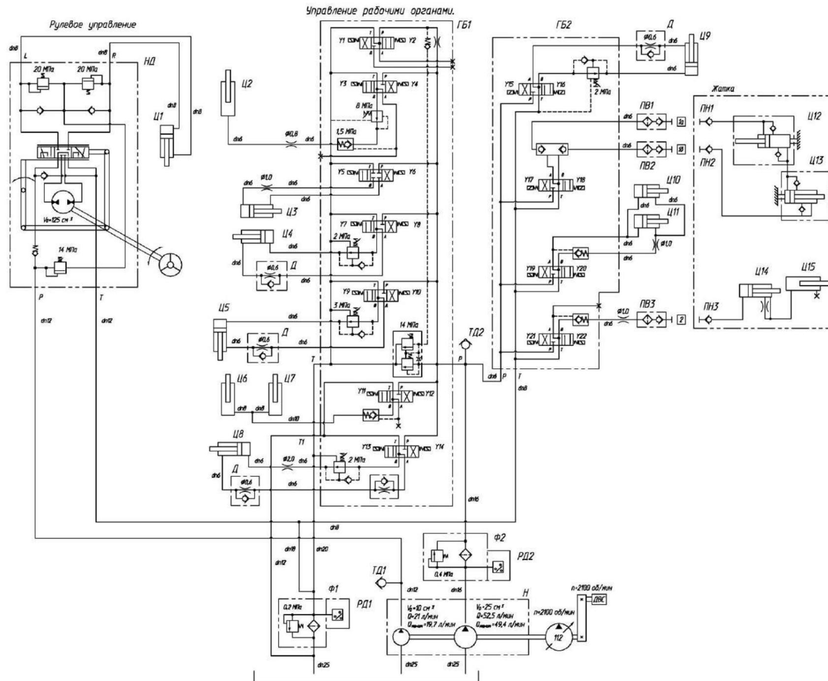
Б – бак масляный; ГБ1, ГБ2 – гидроблоки; Д – дроссель с обратным клапаном; НД – насос-дозатор; Н – насос шестеренный; ПВ1...ПВ3 – полумуфта внутренняя; РД1, РД2 - реле давления; ТД1, ТД2 - точки диагностические; Ф1 – фильтр; Ф2 – фильтр напорный.
