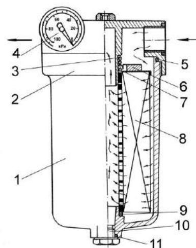
1 – стакан; 2 – корпус; 3 – пружина; 4 – вакуумметр; 5, 7, 9, 11 – уплотнительные резиновые кольца; 6 – магнитный элемент; 8 – фильтрующий элемент; 10 – сливная пробка
