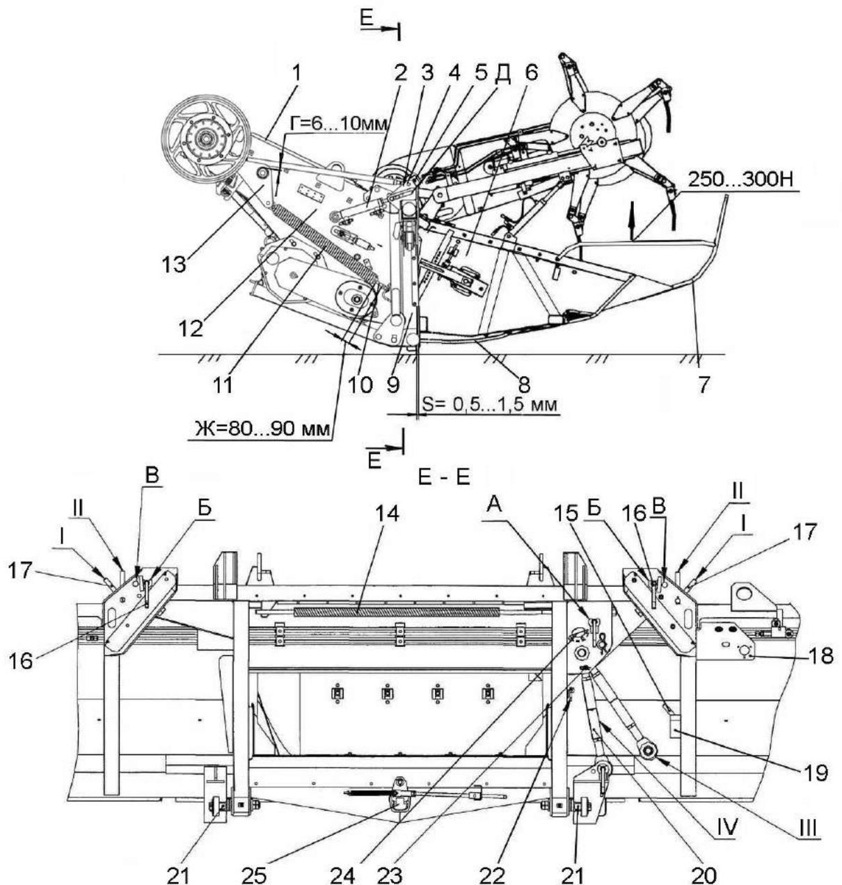
1 – регулируемая тяга; 2 – гидроцилиндр; 3 – серьга; 4, 18, 22 - кронштейны; 5 – ось; 6 – жатка; 7 – прутковый делитель; 8 - башмак; 9 – переходная рамка наклонной камеры; 10 – винт; 11, 14 – блоки пружин; 12 – корпус наклонной камеры; 13 – рычаг; 15, 16 – пальцы-фиксаторы; 17 – рукоятка упора; 19 – втулка; 20 – толкатель; 21 – эксцентрик; 23 – ось со шплинтом; 24 – рычаг двуплечий; 25 - фиксатор; Д - паз
