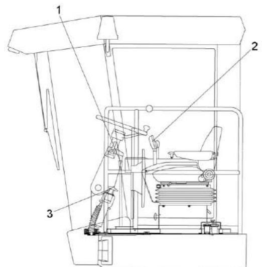
1 – рычаг переключения передач; 2 – рукоятка управления скоростью движения; 3 - рукоятка стояночного тормоза
