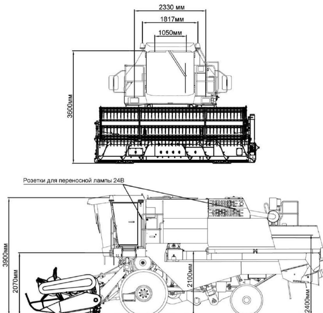
Рисунок 1.32 – Расположение наружного освещения и световой сигнализации комбайна
