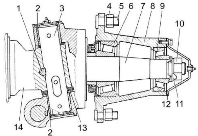
1 – клин шкворня; 2 – подшипники скольжения; 3 – шкворень; 4, 10 – гайка; 5 – болт; 6, 9 – подшипники; 7 – поворотный кулак; 8 – ступица; 11 – стопорная шайба; 12 – колпак ступицы; 13 – шайбы опорные; 14 – кронштейн
