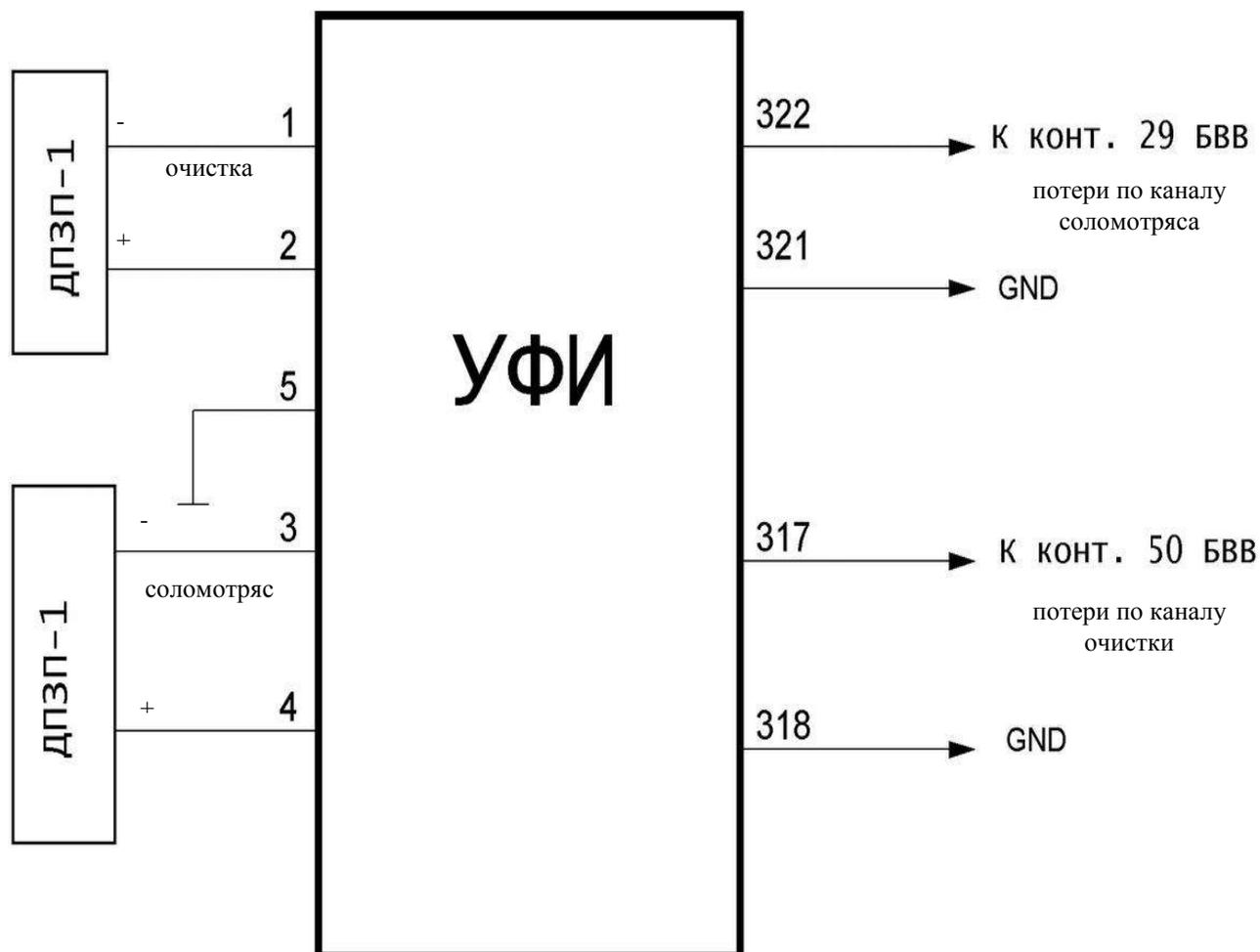
ДПЗП-1 – датчик потерь зерна пьезоэлектрический
