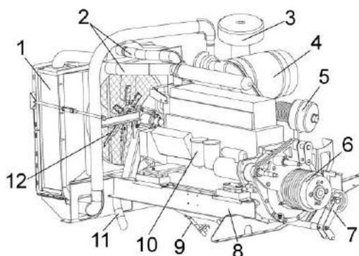
1 – блок радиаторов; 2 - трубы воздушные; 3 – воздухозаборник вращающийся; 4 – воздухозаборник; 5 - глушитель; 6 – главный привод; 7 - привод гидронасоса; 8 - рамка подмоторная; 9 - маслопровод сливной; 10 - двигатель; 11 – труба водяная; 12 – вентилятор
