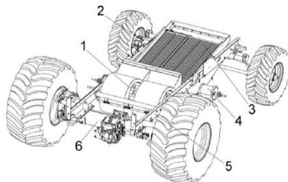
1 – вентилятор; 2 – мост управляемых колес; 3 – стан решетный нижний; 4 – блок шнеков; 5 – рама; 6 – мост ведущих колес
