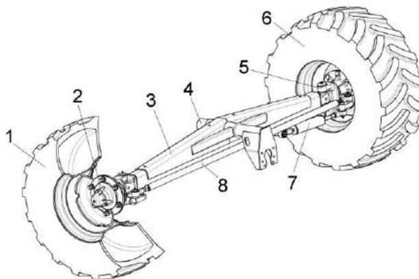
1, 6 – колеса; 2 – ступица колеса; 3 – балка моста; 4 – ось; 5 – поворотный кулак; 7 – гидроцилиндр; 8 – рулевая тяга
