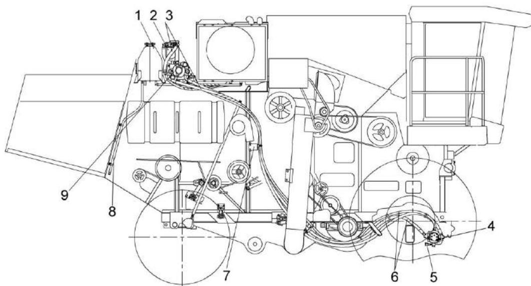
1 – бак масляный; 2 – фильтр; 3 – рукава низкого давления; 4 – гидромотор аксиально-поршневой; 5 – заправочная полумуфта; 6 – рукава высокого давления; 7 – кронштейн; 8 – сливной рукав; 9 – насос аксиально – поршневой
