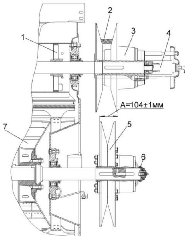
1 – биту отбойный; 2 – ремень; 3, 5 – вариаторы барабана; 4 - гидроцилиндр; 6 - прокладки регулировочные; 7 - барабан молотильный
