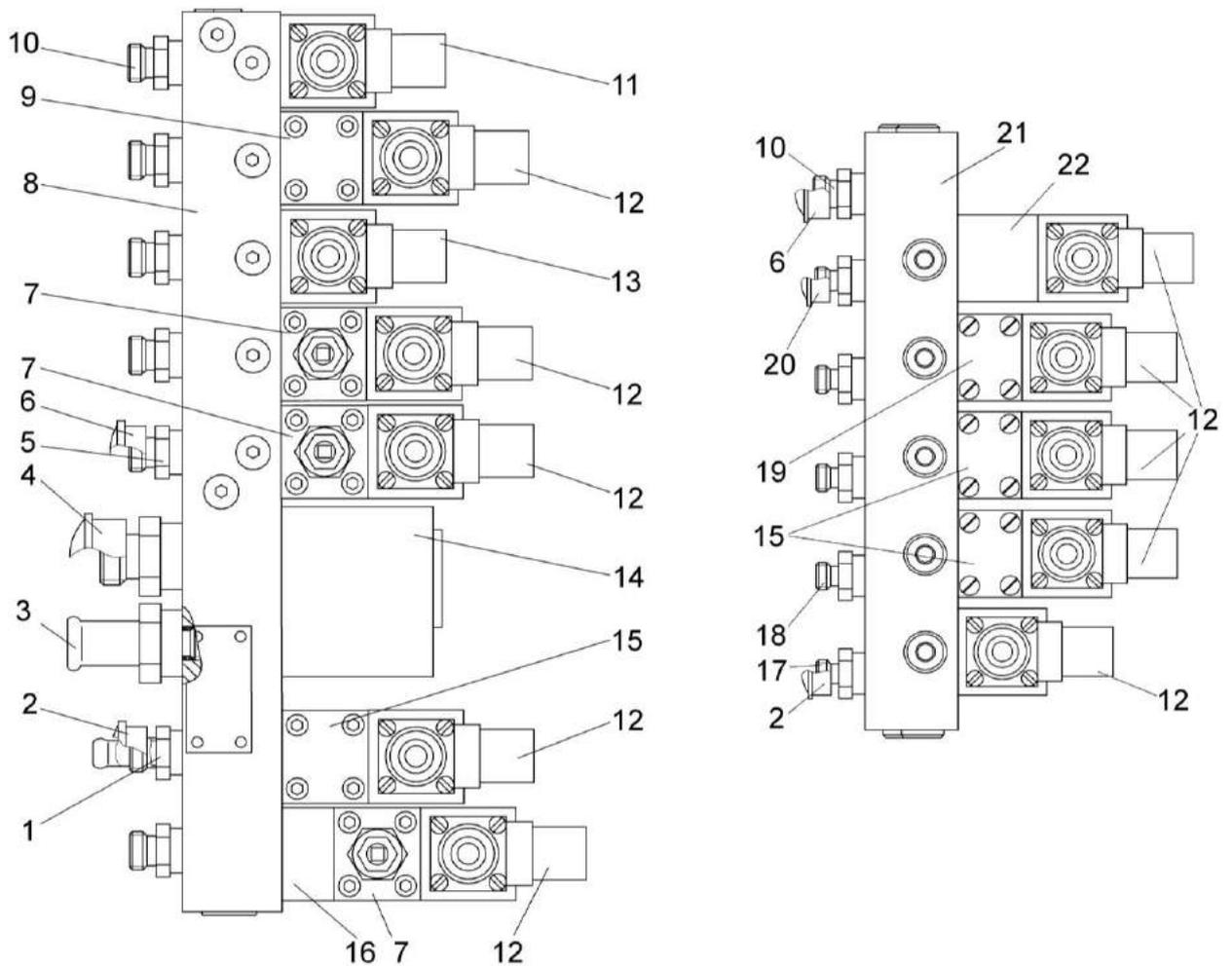
1, 5, 10, 17, 18 – штуцера; 2, 6, 20 – заглушки; 3 – ниппель; 4 – крышки; 7, 22 – клапана редуционные; 8, 21 – плиты; 9, 15, 19 – гидрозамки; 11, 12, 13 – гидрораспределители; 14 – клапан предохранительный; 16 – гидродроссель с обратным клапаном
