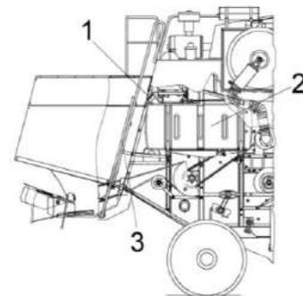
1 – заливная горловина; 2 - топливный бак; 3 - лестница
