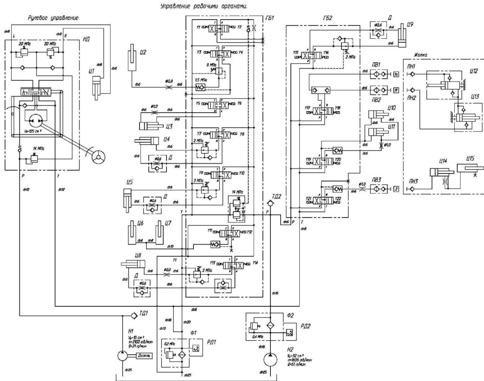
Б – бак масляный; ГБ1, ГБ2 – гидроблоки; Д – дроссель с обратным клапаном; НД – насос-дозатор; Н1, Н2 – насосы шестеренные; ПВ1...ПВ3 – полумуфта внутренняя; РД1, РД2 - реле давления; ТД1, ТД2 - точки диагностические; Ф1 – фильтр; Ф2 – фильтр напорный.
