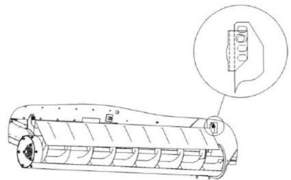
Рисунок 2.18 – Регулировка ограждения над горизонтальным шнеком бункера
