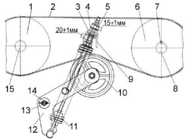
1, 6 – шкивы; 2 – ремень; 3 – винт натяжной; 4 – амортизатор; 5 – гайка; 7, 14 – шайбы; 8 – вал привода гидронасоса; 9 – кронштейн рамы подмоторной; 10 – ролик натяжной; 11 – пружина; 12 – рычаг; 13 – ось рамы подмоторной; 15 – вал двигателя
