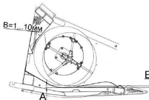
А – зазор между витками шнека и днищем жатки;
