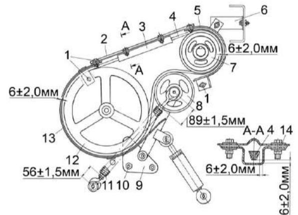
1 – болты, 2 – пластина; 3, 6 – кронштейны; 4 – ремень; 5, 13 – щиток 7, 12 – шкивы; 8 – рычаг; 9 – опора; 10 – гайка; 11 – пружина; 14 – шайба
