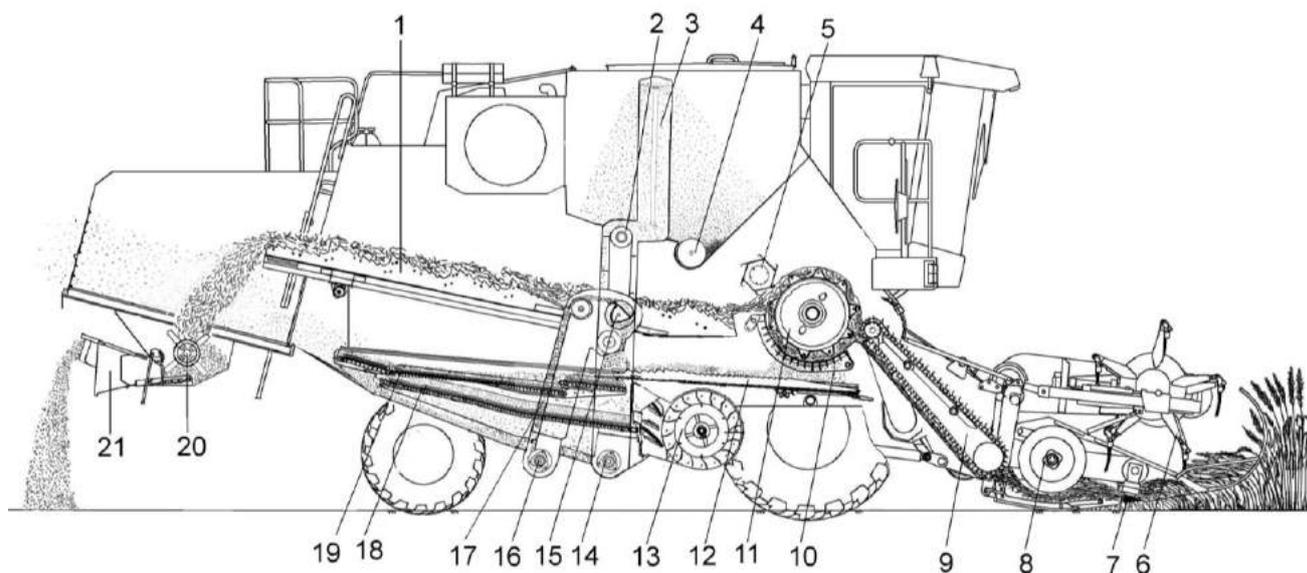
1 - соломотряс; 2 - элеватор зерновой; 3 - шнек загрузной зерновой; 4 - шнек горизонтальный; 5 - битек отбойный; 6 - мотовило; 7 - режущий аппарат; 8 - шнек; 9 - транспортер наклонной камеры; 10 - подбарабанье; 11 - молотильный барабан; 12 - стрясная доска; 13 - вентилятор; 14 - шнек зерновой; 15 - устройство домолачивающее; 16 - шнек колосовой; 17 - элеватор колосовой; 18 - стан решетный нижний; 19 - стан решетный верхний; 20 - соломоизмельчитель; 21 - дефлектор
