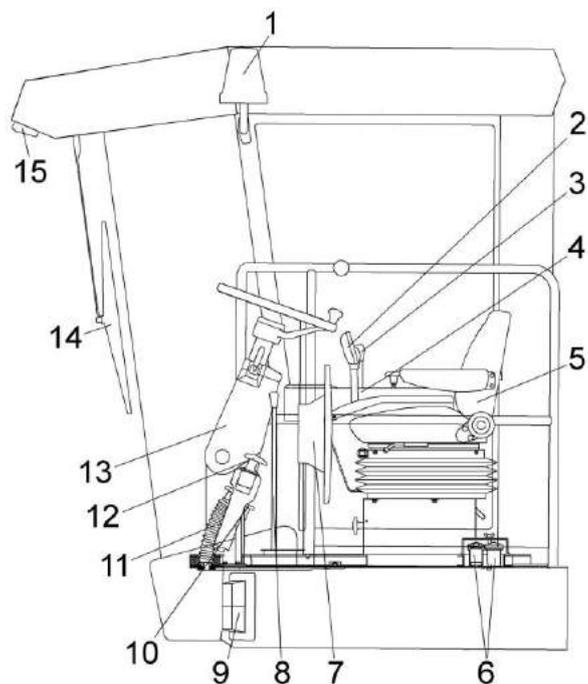
1 – маяк проблесковый; 2 – рукоятка управления скоростью движения; 3 – рукоятка регулирования оборотов двигателя; 4 – пульт управления; 5 – сиденье; 6 – бачки с тормозной жидкостью; 7 – зеркало; 8 – рычаг переключения передач; 9 - транспортные фары; 10 – тормозные педали; 11 – педаль блокировки коробки диапазонов; 12 – рукоятка стояночного тормоза; 13 – колонка рулевая; 14 – стеклоочиститель; 15 – рабочие фары
