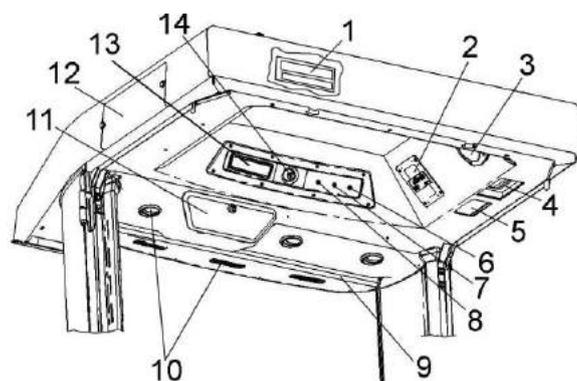
1 – крышка блока предохранителей; 2 – панель управления кондиционером; 3 – динамик автомагнитолы; 4 – фильтр рециркуляции воздуха; 5 – плафон освещения кабины; 6 – кнопка включения задних рабочих фар; 7 – кнопка включения передних рабочих фар; 8 – кнопка включения маяков; 9 – солнцезащитная шторка; 10 – дефлекторы; 11 – охлаждаемый бокс; 12 – место установки воздушного фильтра; 13 – место для магнитолы; 14 – ручка включения стеклоочистителя
