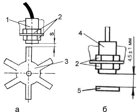
1 – датчик; 2 – регулировочные гайки; 3 – звездочка; 4 – датчик; 5 – пластина
