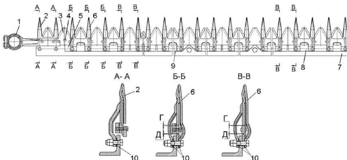
1 – головка ножа; 2 – палец направляющий; 3 – сегмент; 4 – полоса ножевая; 5, 8, 9 – пластины трения; 6 – сдвоенные пальцы; 7 – брус пальцевый; 10 - регулировочные прокладки
