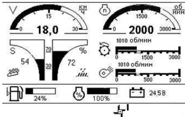
Рисунок 1.93 – Экран технологического режима уборки (комбайнирования)
