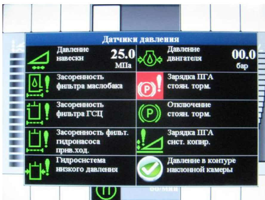
Рисунок Ж.2.9 – Вид окна «Датчики давления»
