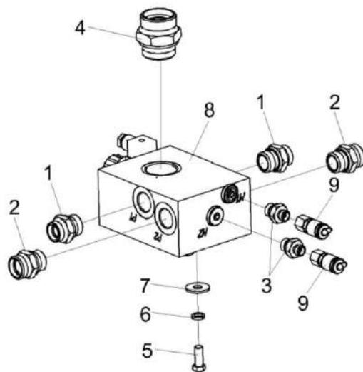
Рисунок 241 – Гидроблок КП-6-0604320
