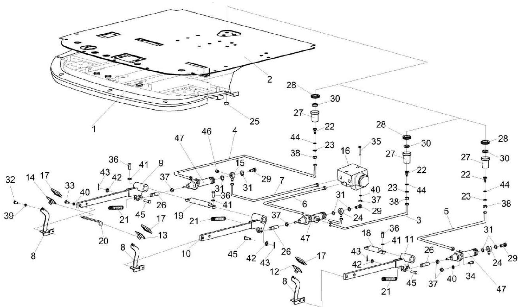
Рисунок 177 – Рычаги и трубопроводы площадки управления
