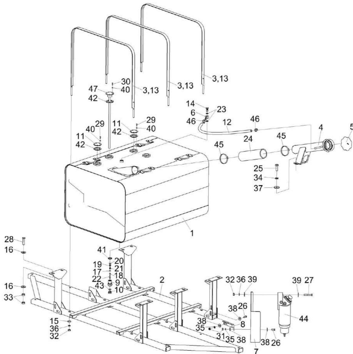
Рисунок 250 – Установка топливного оборудования КП-6-0126000 (лист 1)
