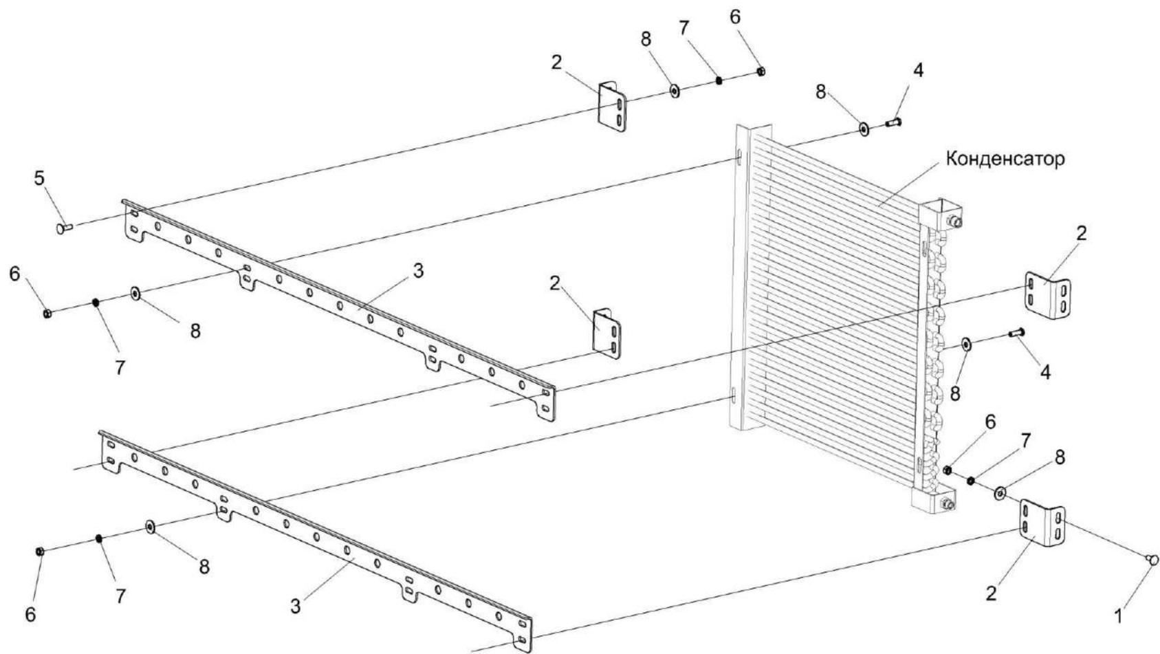
Рисунок 215 – Установка конденсатора КП-6-0121050
