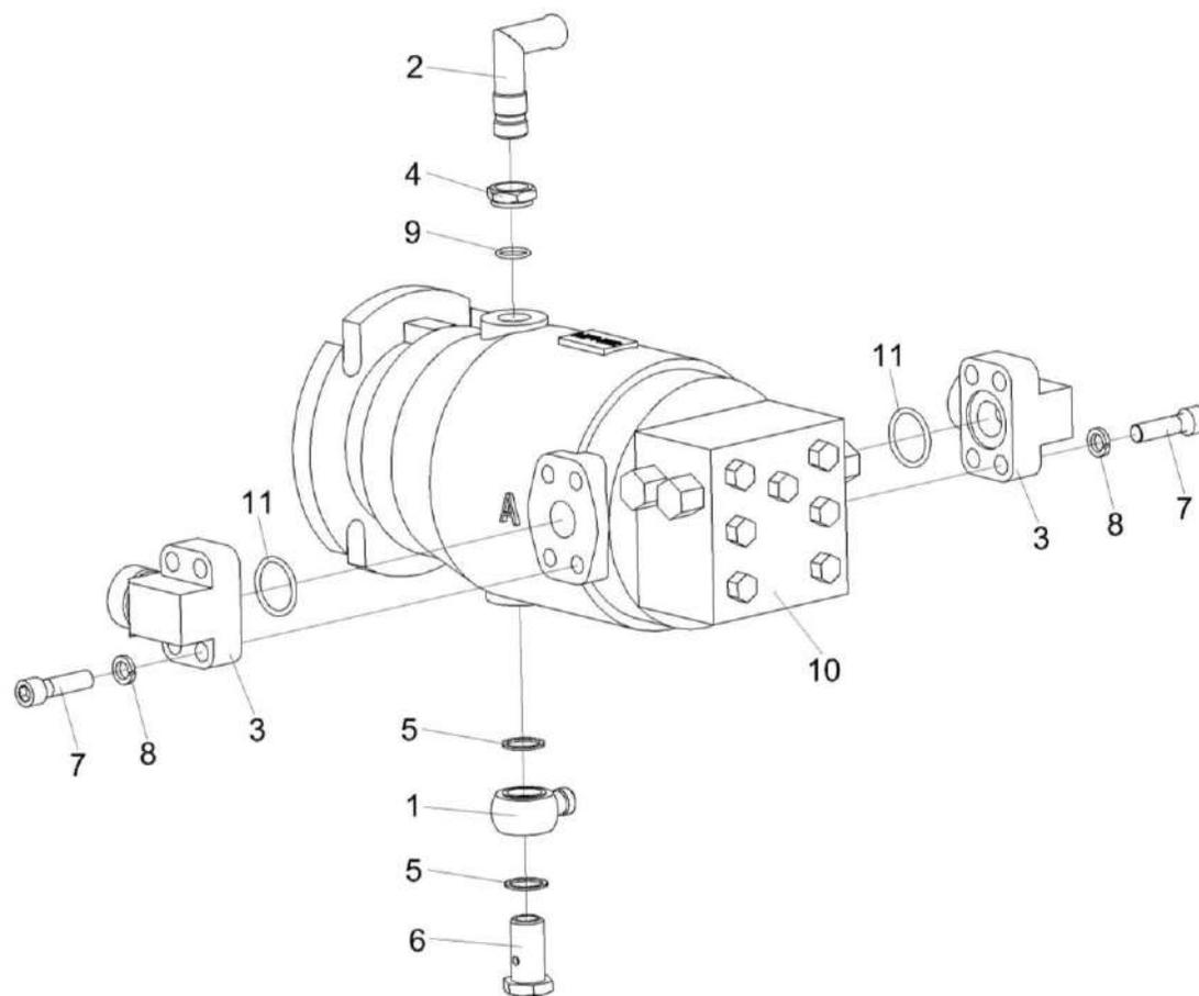
Рисунок 248 – Гидромотор КП-6-0601230
