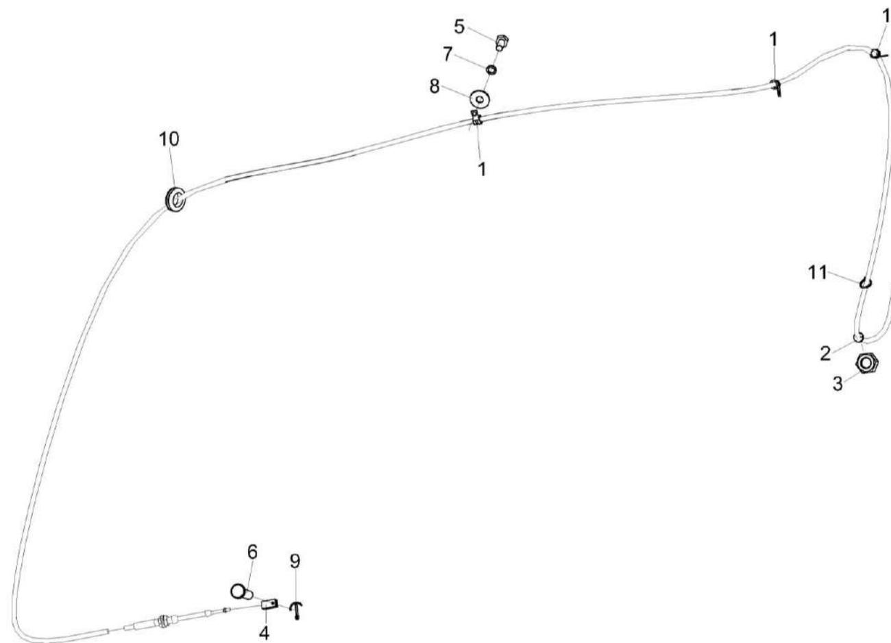
Рисунок 199 – Установка троса управления гидронасосом хода КП-6-0119220А
