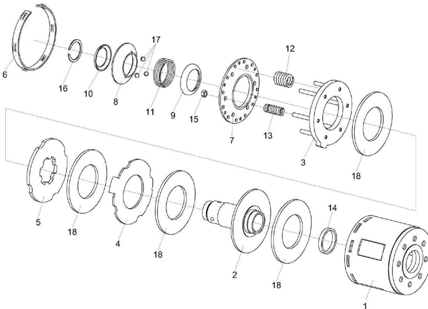
Рисунок 47 – Муфта предохранительная фрикционная 04.141.000А
