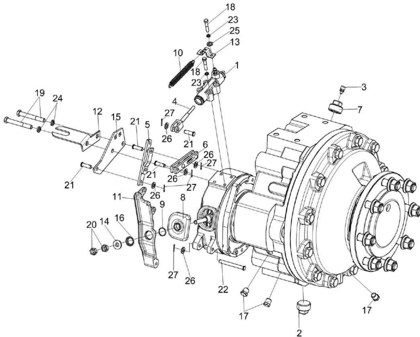
Рисунок 158 – Редуктор бортовой КЗК-10-0107200-04 (лист 1)
