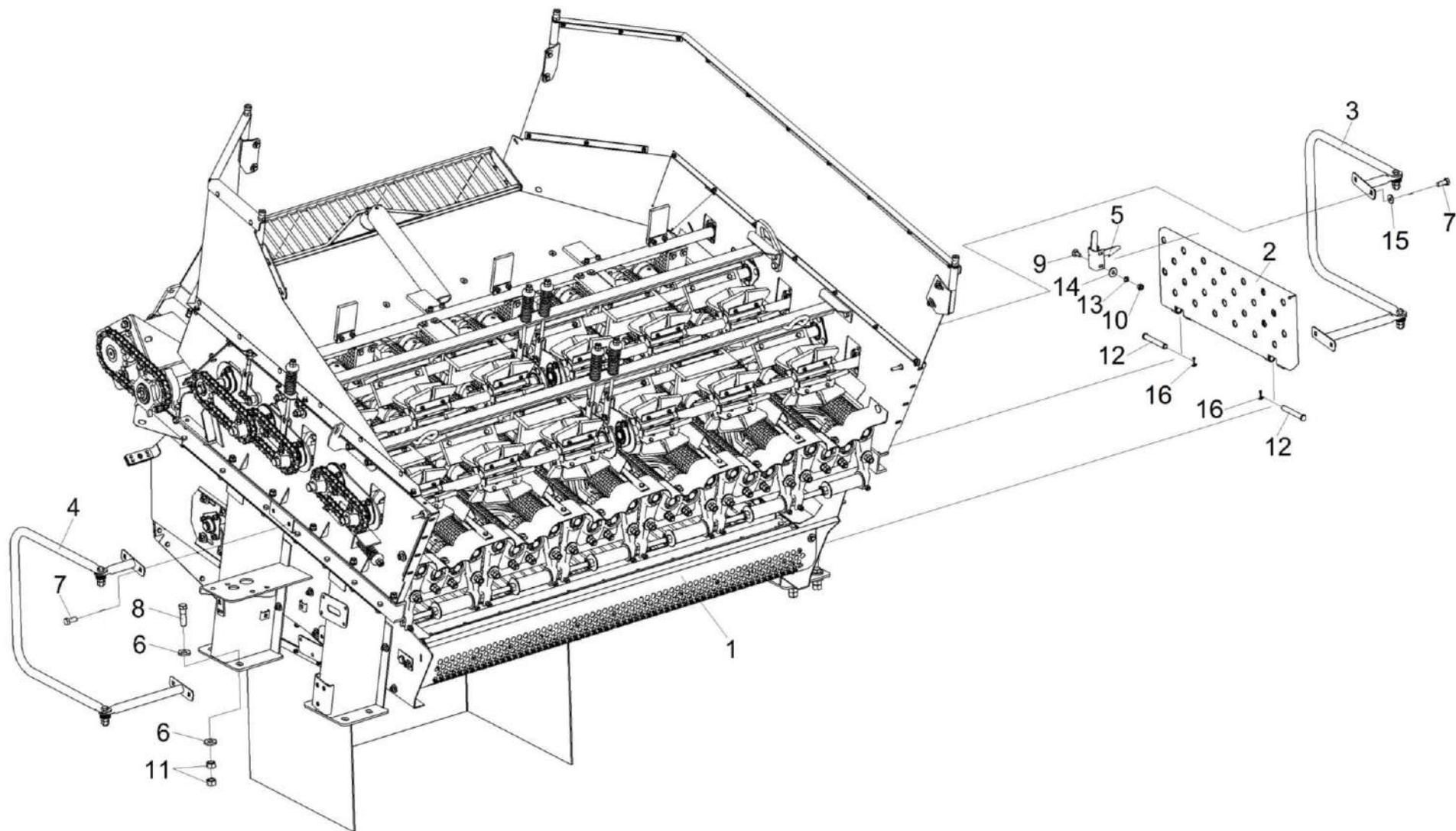
Рисунок 77 – Установка устройства початкоочистительного КП-6-0102000А (лист 1)
