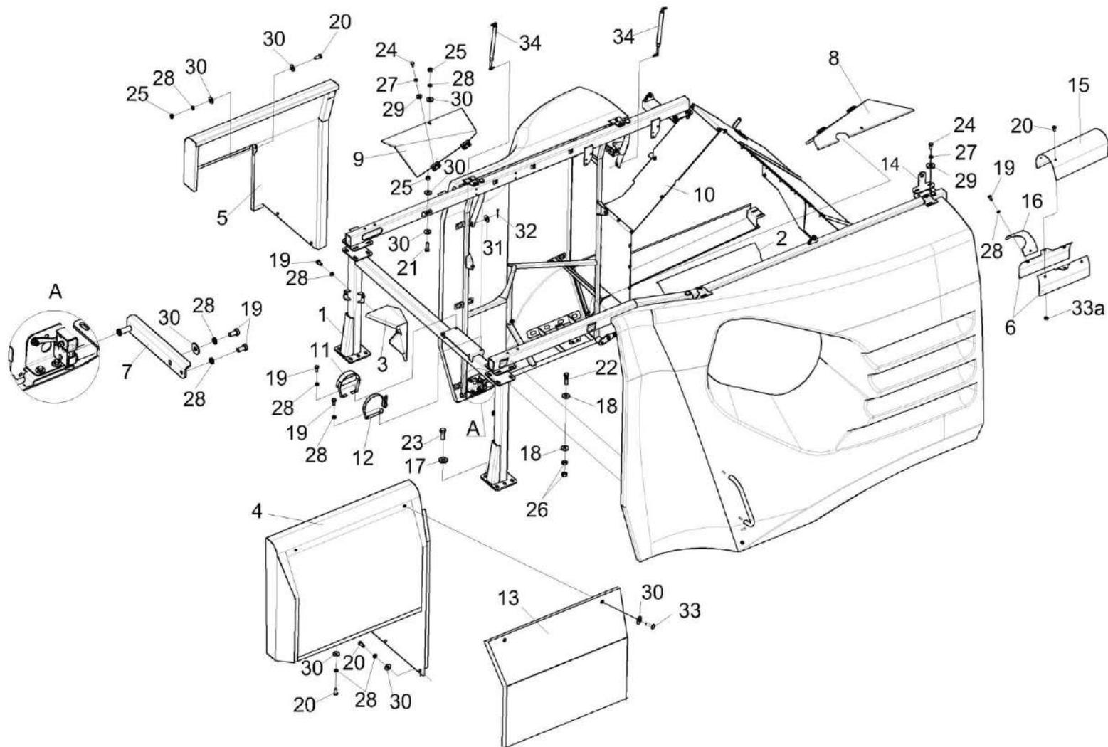
Рисунок 219 – Установка капотов КП-6-0128000А (лист 1)
