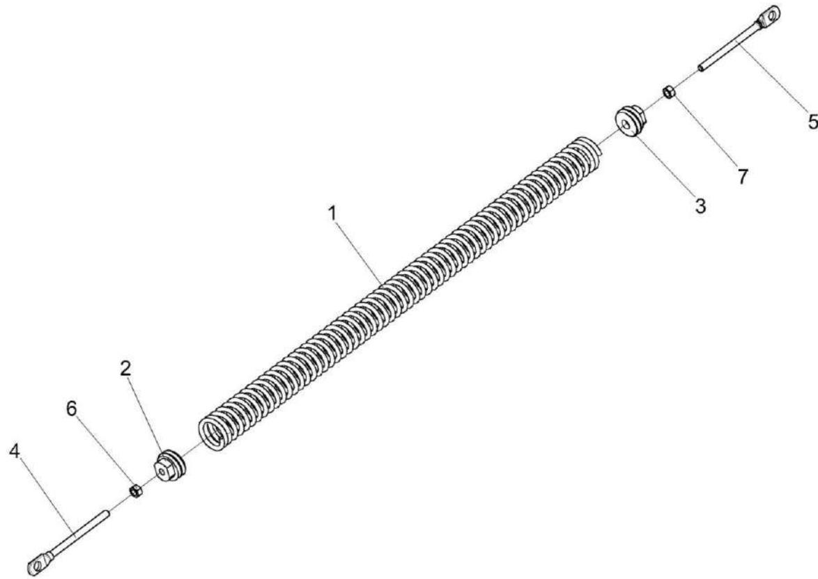
Рисунок 121 – Пружина КП-6-0108470
