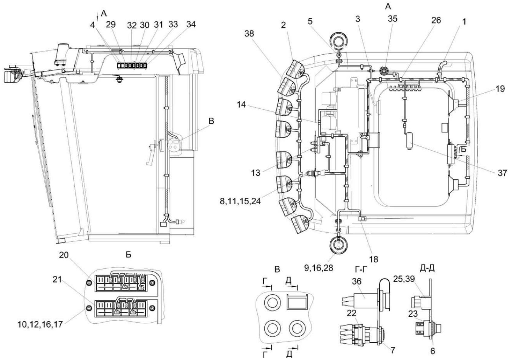
Рисунок 210 – Установка электрооборудования кабины КП-6-0722000
