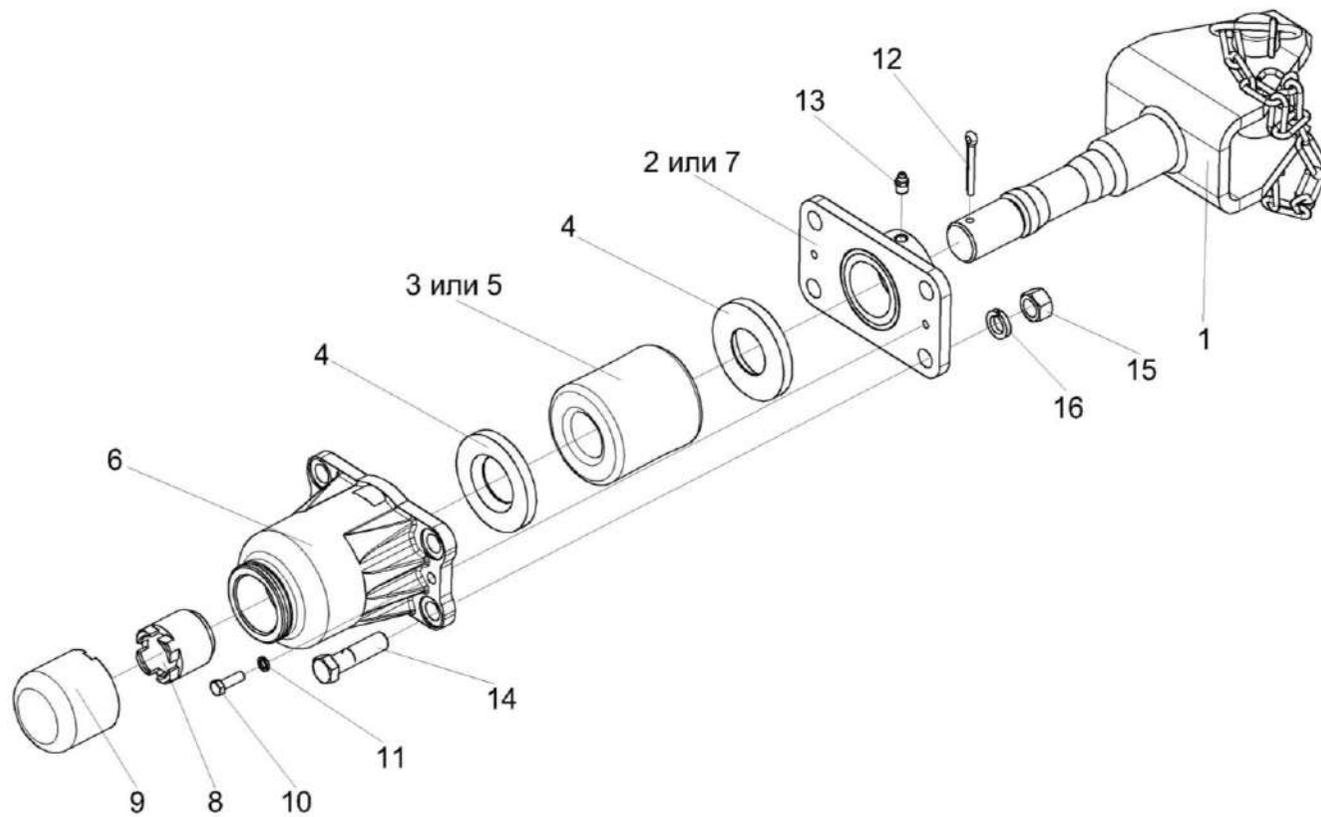
Рисунок 174 – Установка устройства прицепного КИС 0122000А
