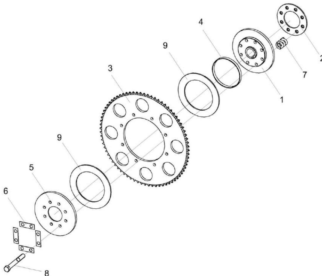
Рисунок 37 – Муфта предохранительная КПС-5-0202040
