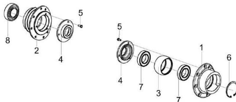
Рисунок 60 – Корпус КЗК 1873010 и КЗК 1873020
