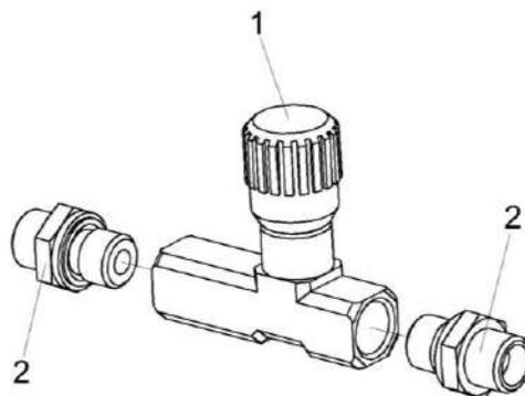
Рисунок 237 – Дроссель с обратным клапаном регулируемый КСК-6025-0602420
