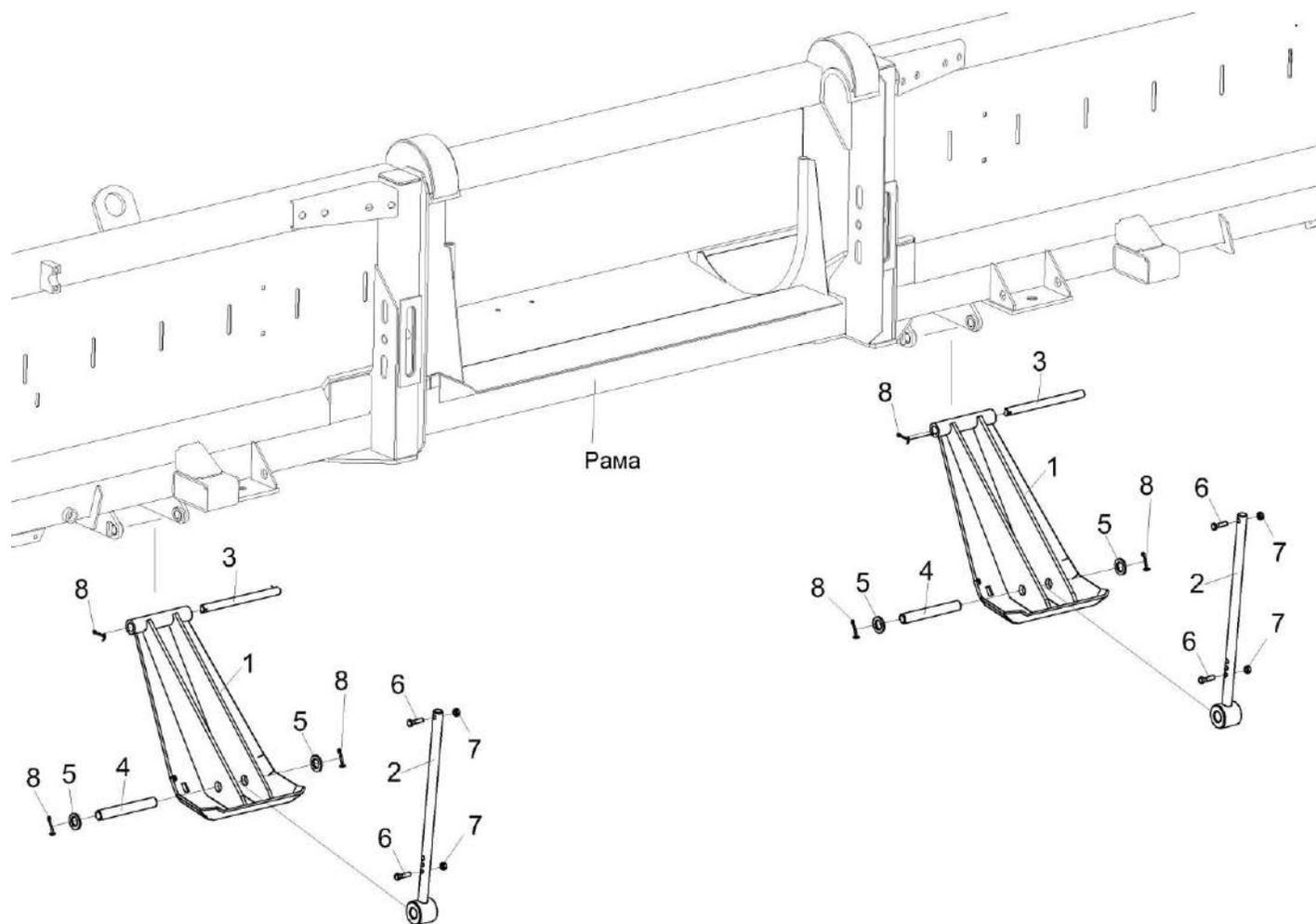
Рисунок 10 – Устройство загиба стерни КП-6-0506000
