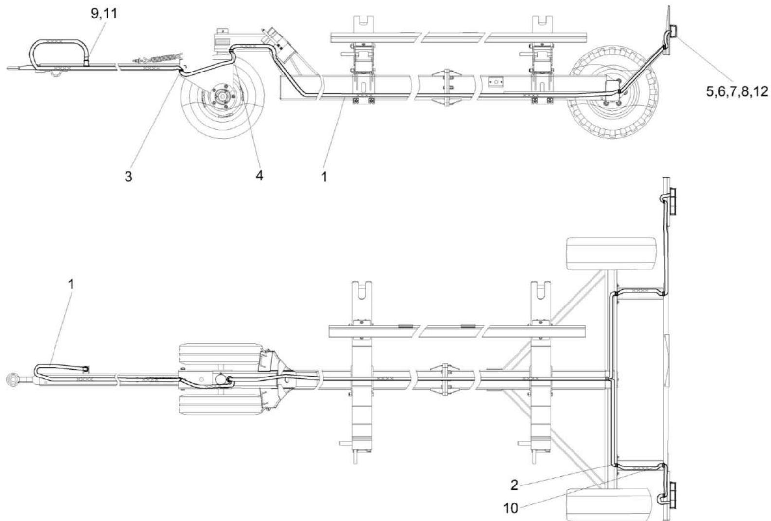
Рисунок 52 – Установка электрооборудования тележки транспортной КП-6-0715900
