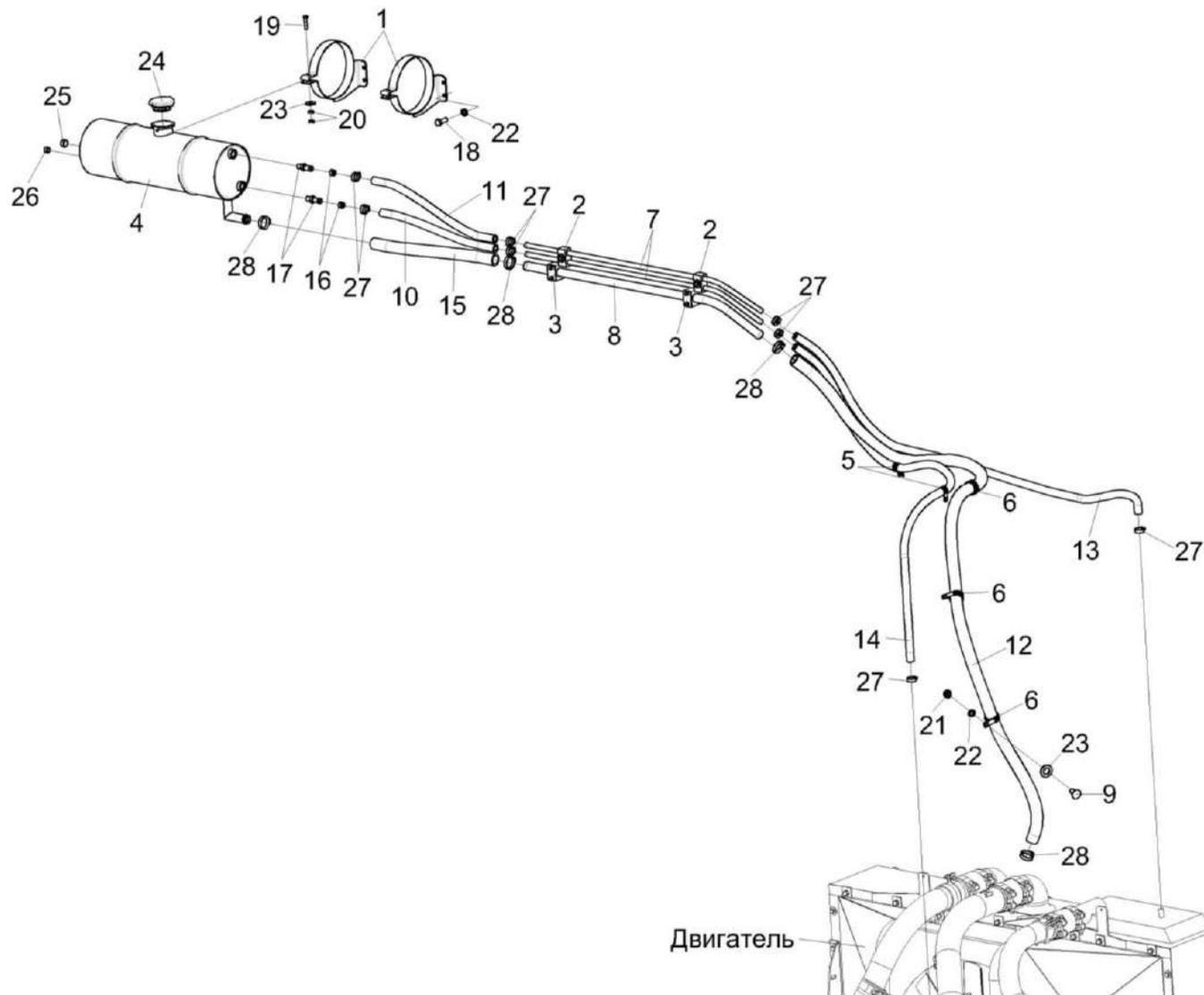
Рисунок 151 – Установка бачка расширительного КП-6-0106070
