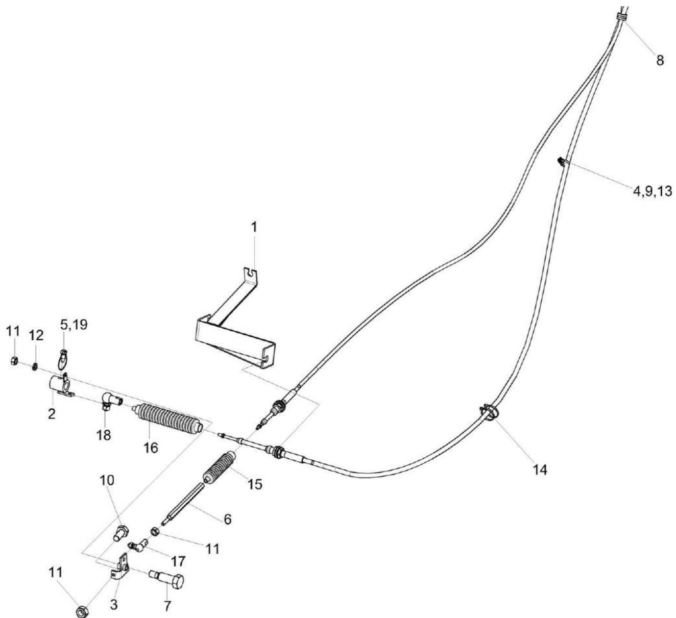
Рисунок 198 – Установка тросов управления КПП КП-6-0119210
