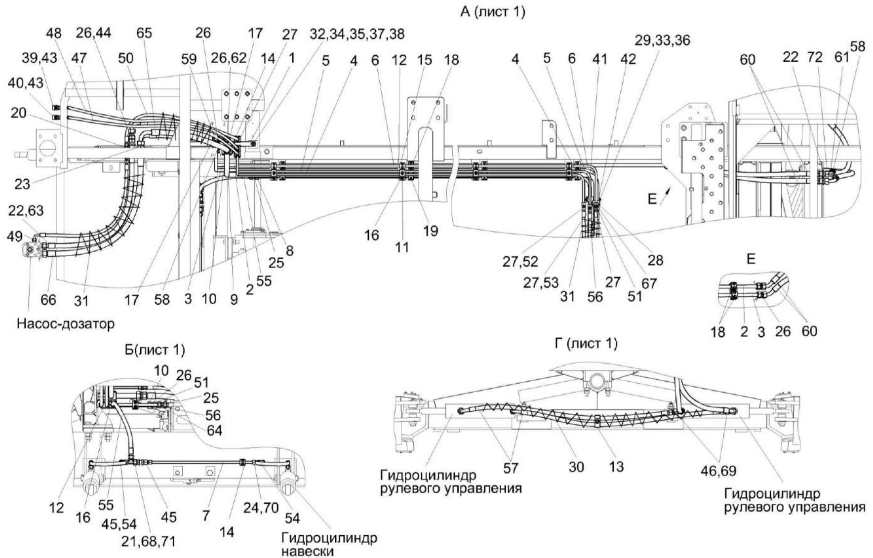
Рисунок 233 – Гидросистема силовых цилиндров и рулевого управления КП-6-0602000 (лист 2)
