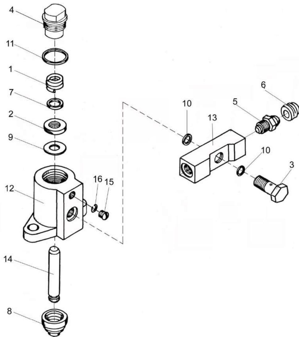
Рисунок 170 – Гидроцилиндр КЗК-12-0107200
