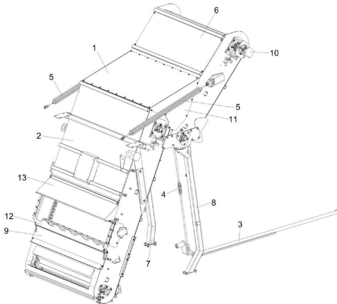
Рисунок 113 – Установка транспортеров загрузочных КП-6-0108000А (лист 1)
