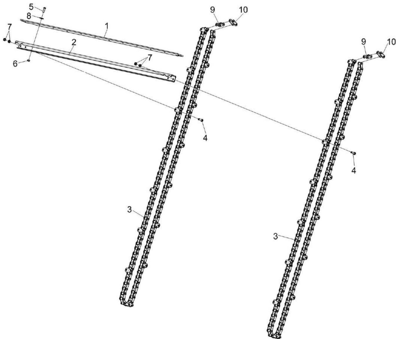
Рисунок 119 – Транспортер КП-6-0108170Б
