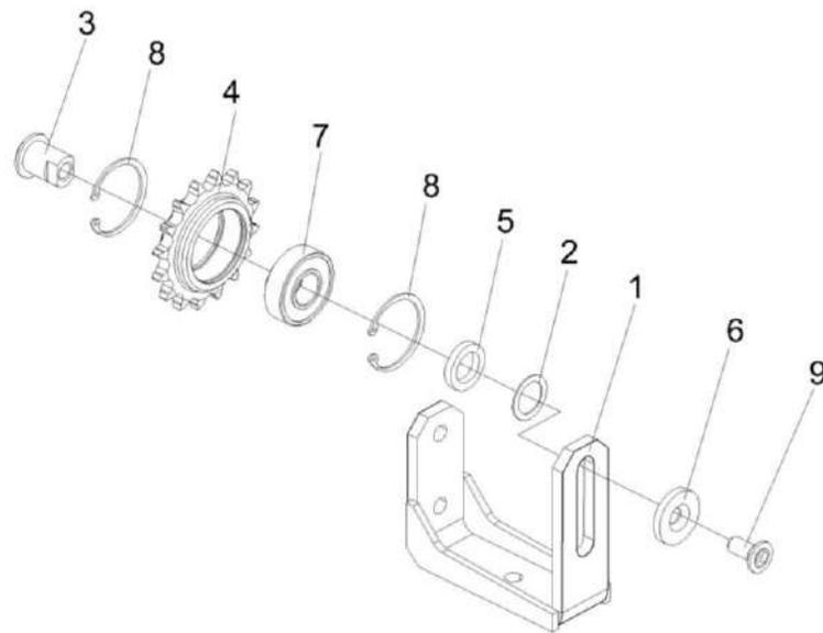
Рисунок 42 – Устройство натяжное КП-6-0523000
