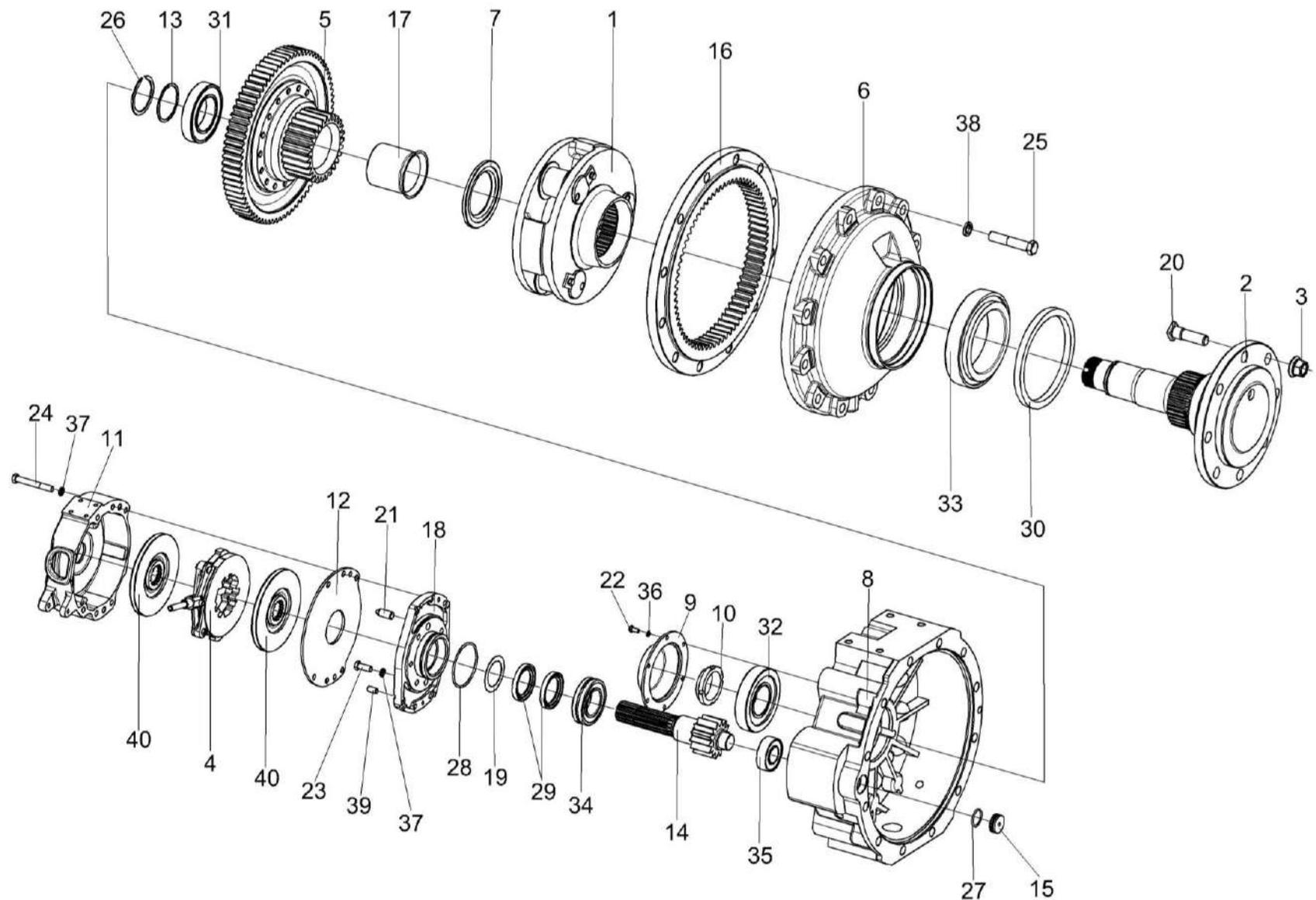
Рисунок 159 – Редуктор бортовой КЗК-10-0107200-04 (лист 2)
