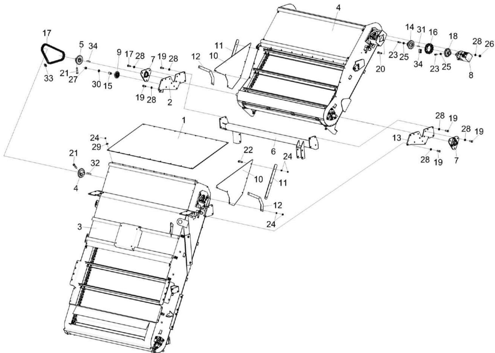
Рисунок 114 – Установка транспортеров загрузочных КП-6-0108000А (лист 2)
