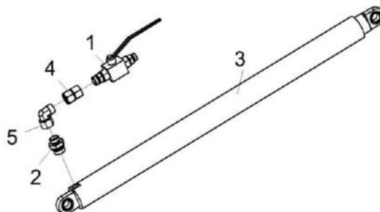
Рисунок 134 – Гидроцилиндр КП-6-0602520 и КП-6-0602520-01
