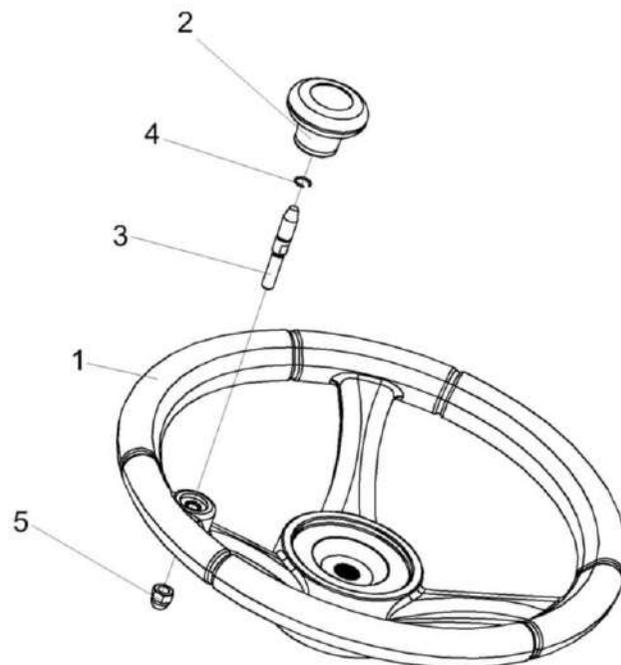
Рисунок 191 – Установка колеса рулевого КЗК-12-0122300
