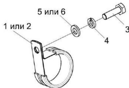
Рисунок 217 – Установка хомута КЗК-8-3-0113090 и КЗК-8-3-0113090-01
