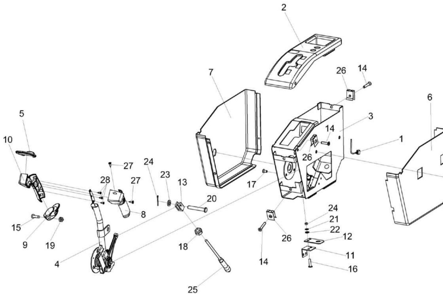
Рисунок 180 – Блок управления КП-6-0119890
