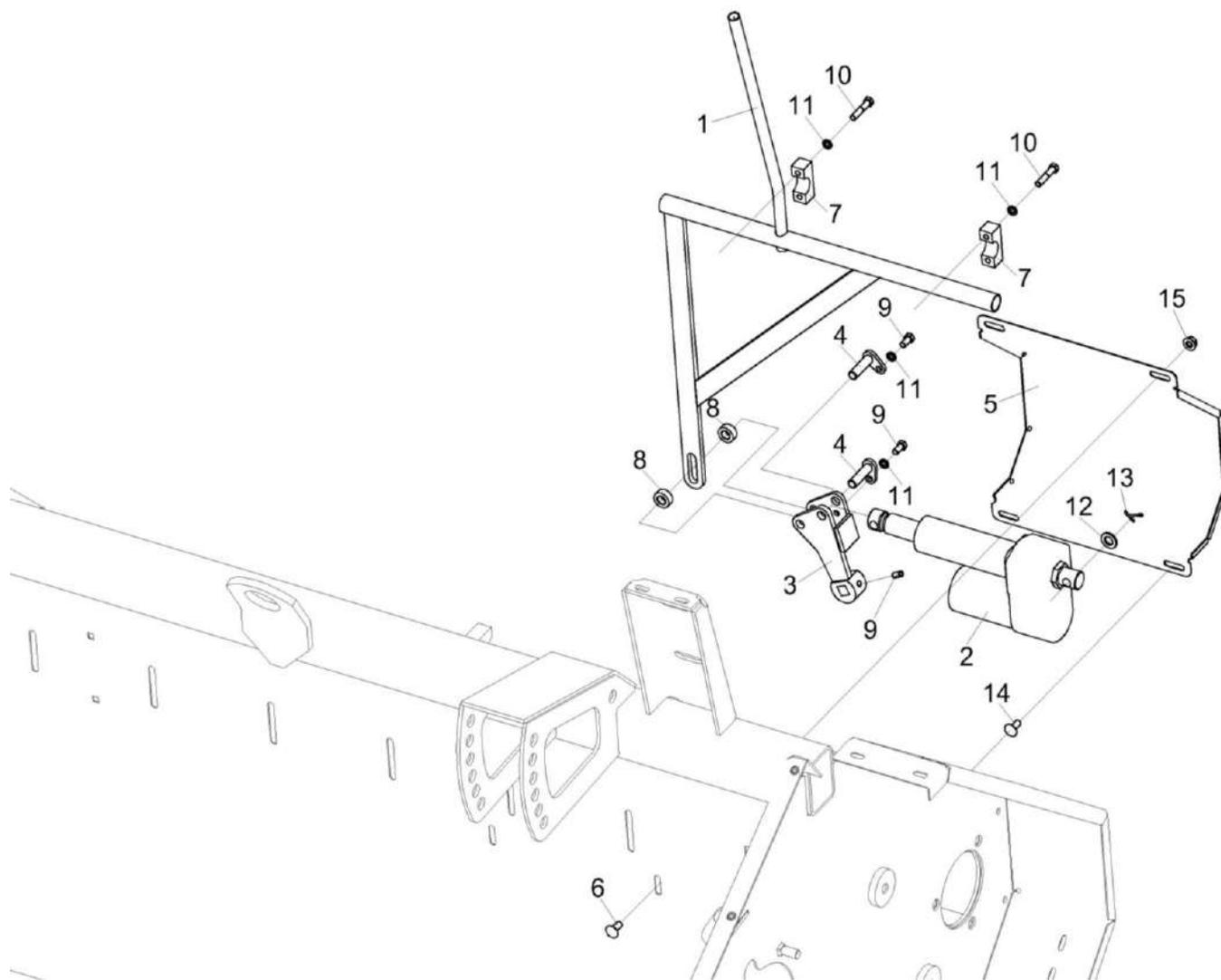
Рисунок 17 – Установка электромеханизма КП-6-0505000
