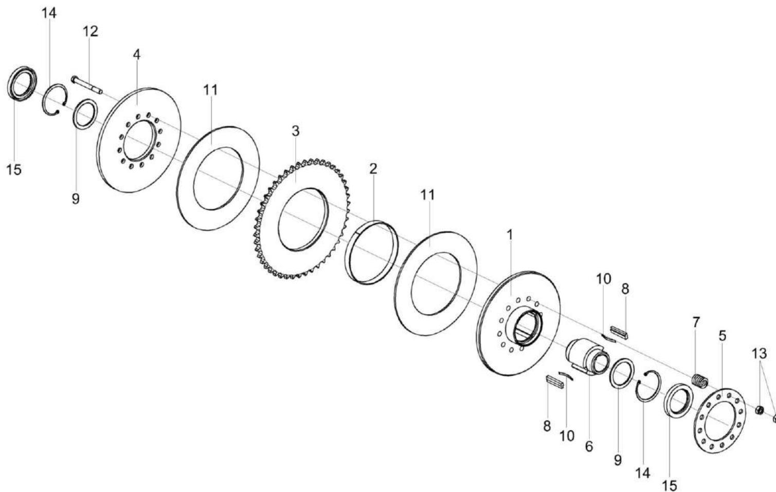
Рисунок 59 – Муфта предохранительная обгонная КП-6-0103250
