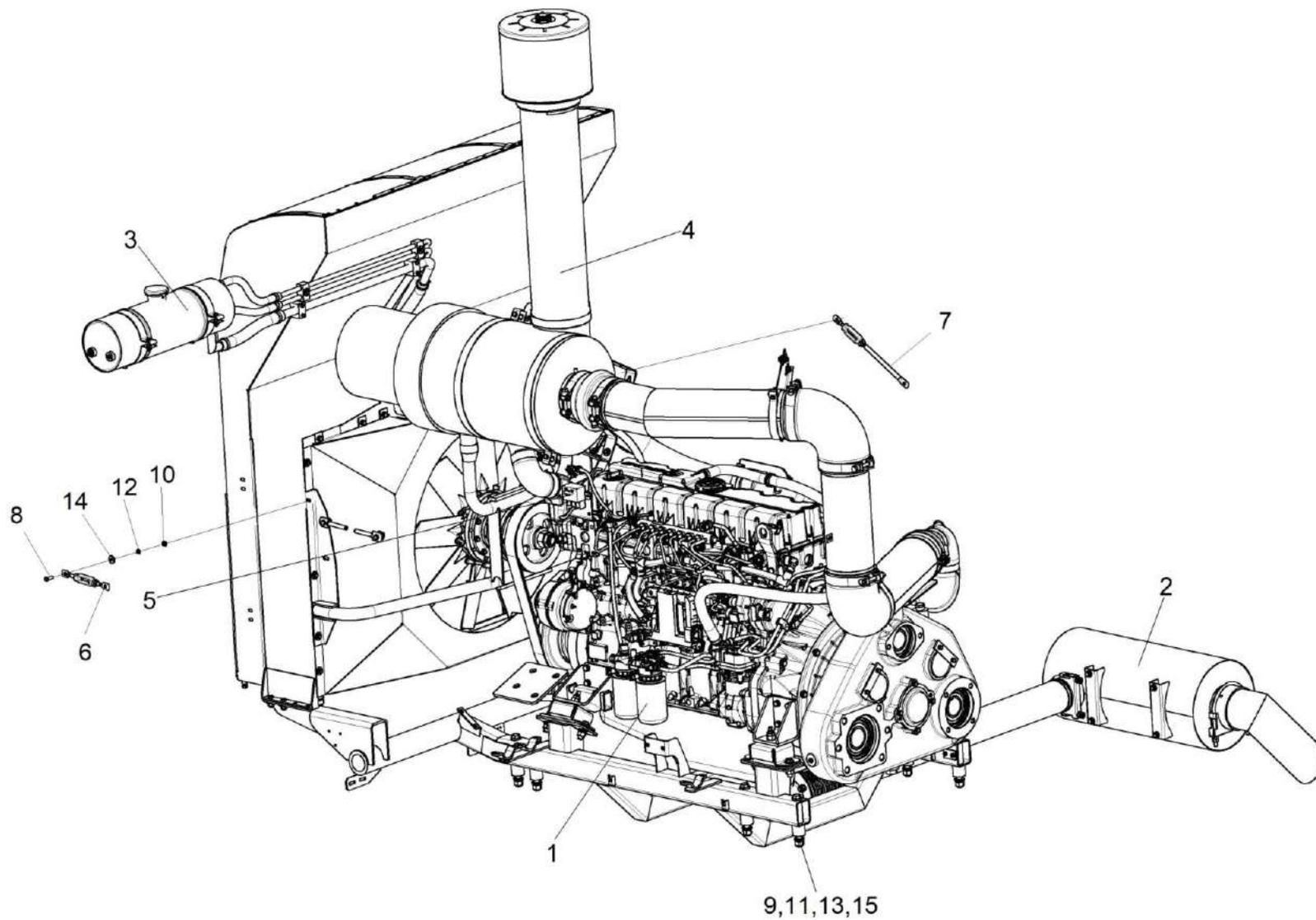
Рисунок 135 – Установка двигателя ЯМЗ-53649 КП-6-0106000
