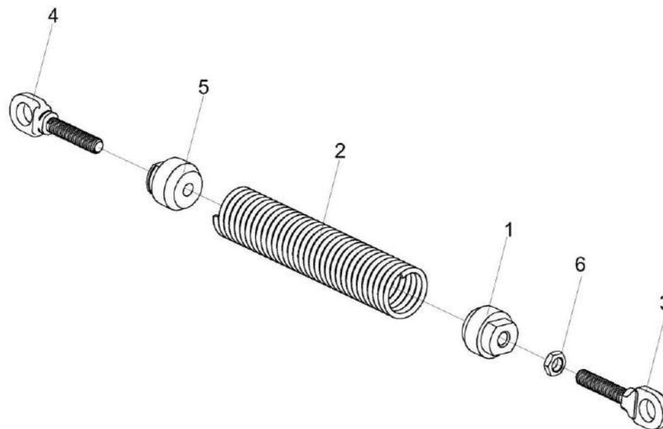
Рисунок 145 – Механизм натяжения КП-6-0106610
