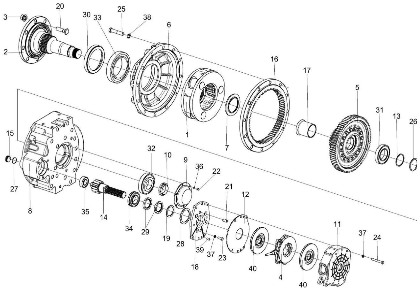
Рисунок 157 – Редуктор бортовой КЗК-10-0107200 (лист 2)
