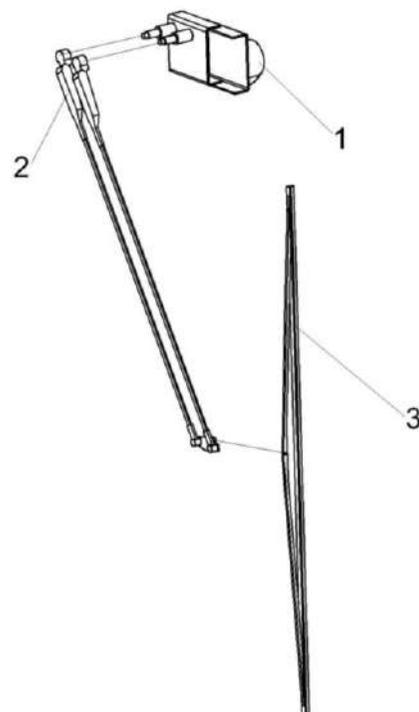
Рисунок 209 – Установка стеклоочистителя КЗК-12-0120810
