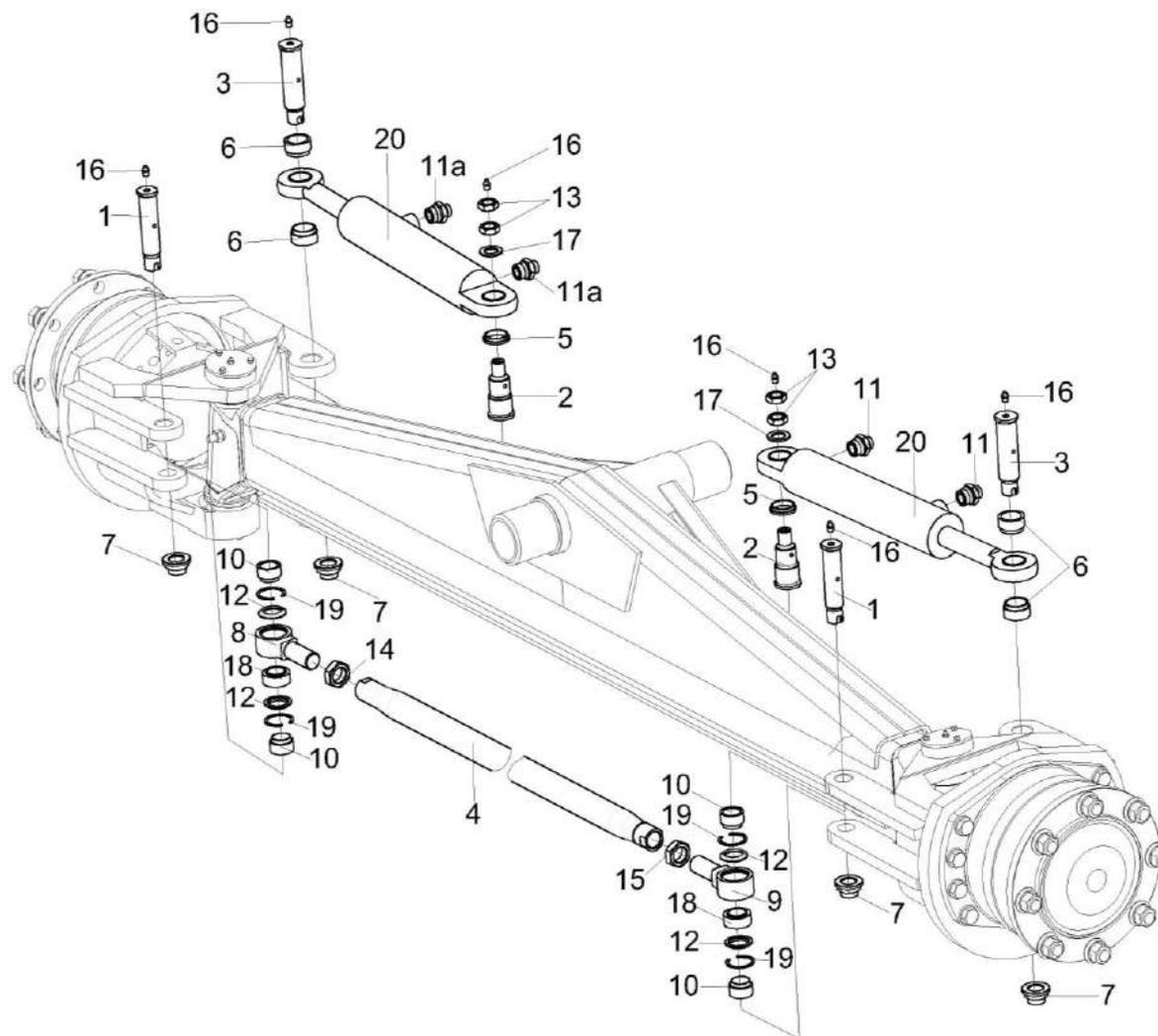
Рисунок 172 – Мост управляемых колес КП-6-0109000 (лист 2)
