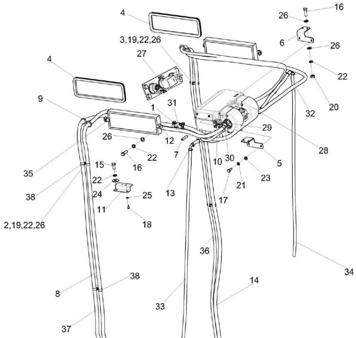
Рисунок 218 – Установка испарителя КП-6-0121020
