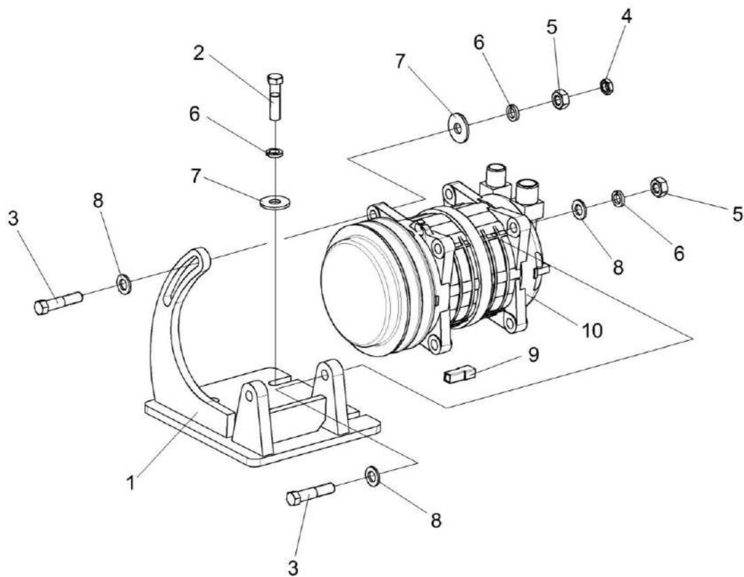
Рисунок 214 – Установка компрессора КП-6-0121030
