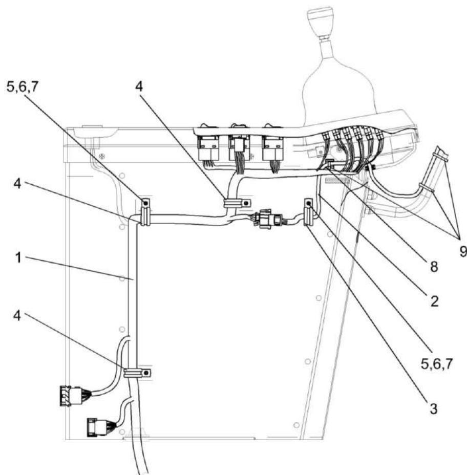
Рисунок 186 – Установка электрооборудования пульта управления КП-6-0725000
