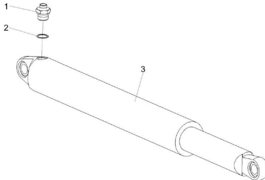
Рисунок 249 – Гидроцилиндр КП-6-0602530
