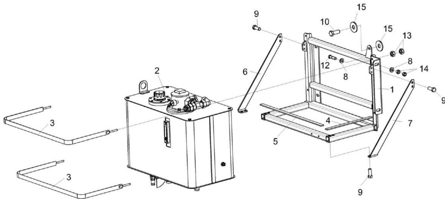
Рисунок 252 – Установка бака масляного КП-6-0127000Б
