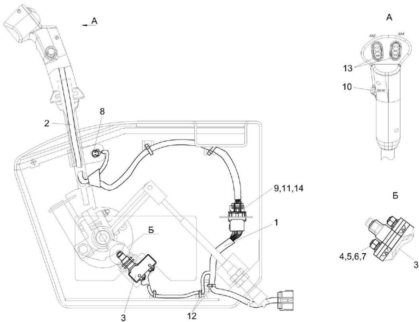
Рисунок 182 – Установка электрооборудования блока управления КП-6-0728000
