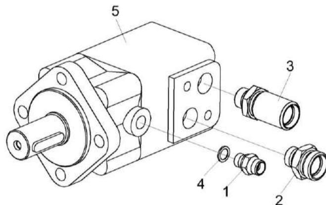
Рисунок 103 – Гидромотор КП-6-0604160
