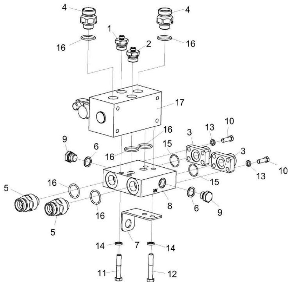
Рисунок 230 – Гидроблок подключения управляемого моста КП-6-0601310
