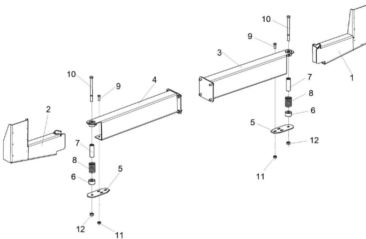
Рисунок 152 – Установка балки габаритной КП-6-0115000
