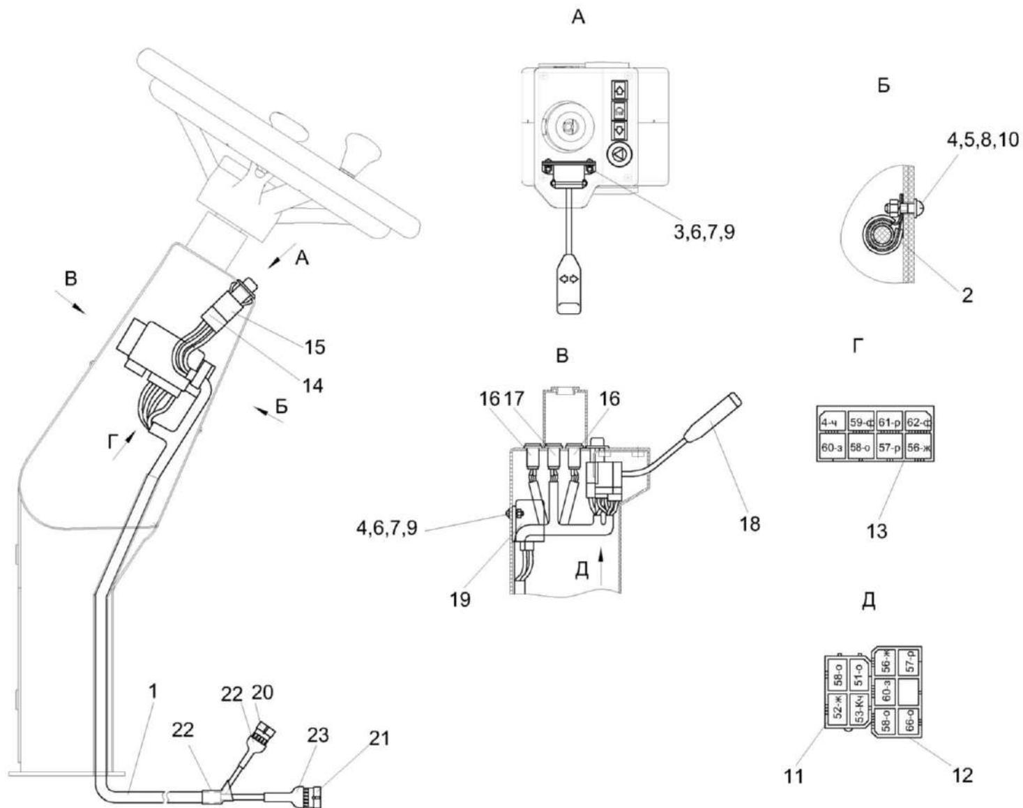
Рисунок 192 – Установка электрооборудования колонки рулевой КП-6-0723000
