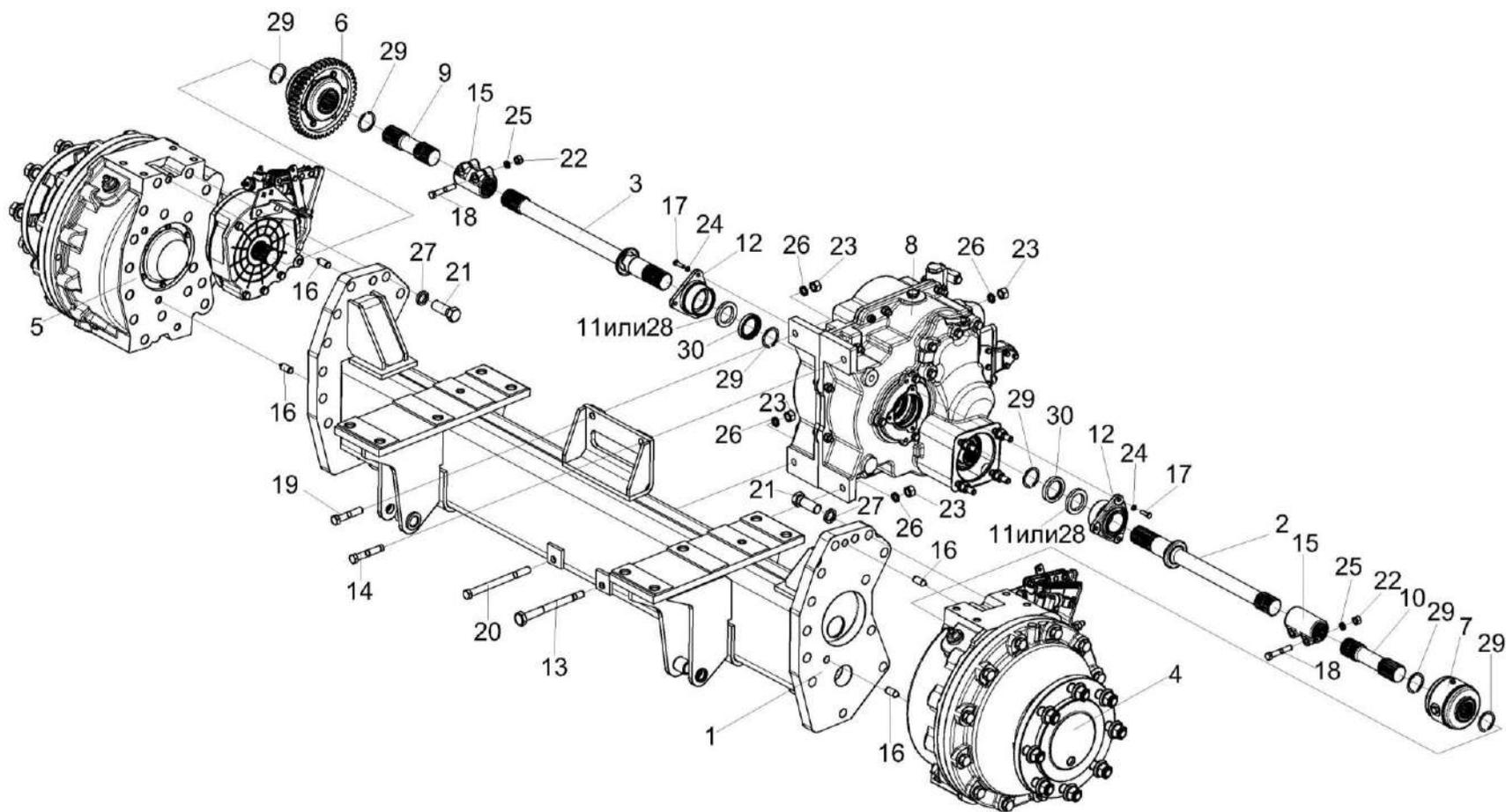
Рисунок 155 – Мост ведущих колес КП-6-0107000
