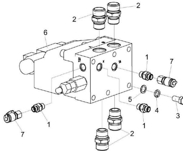
Рисунок 244 – Гидроблок КП-6-0604350
