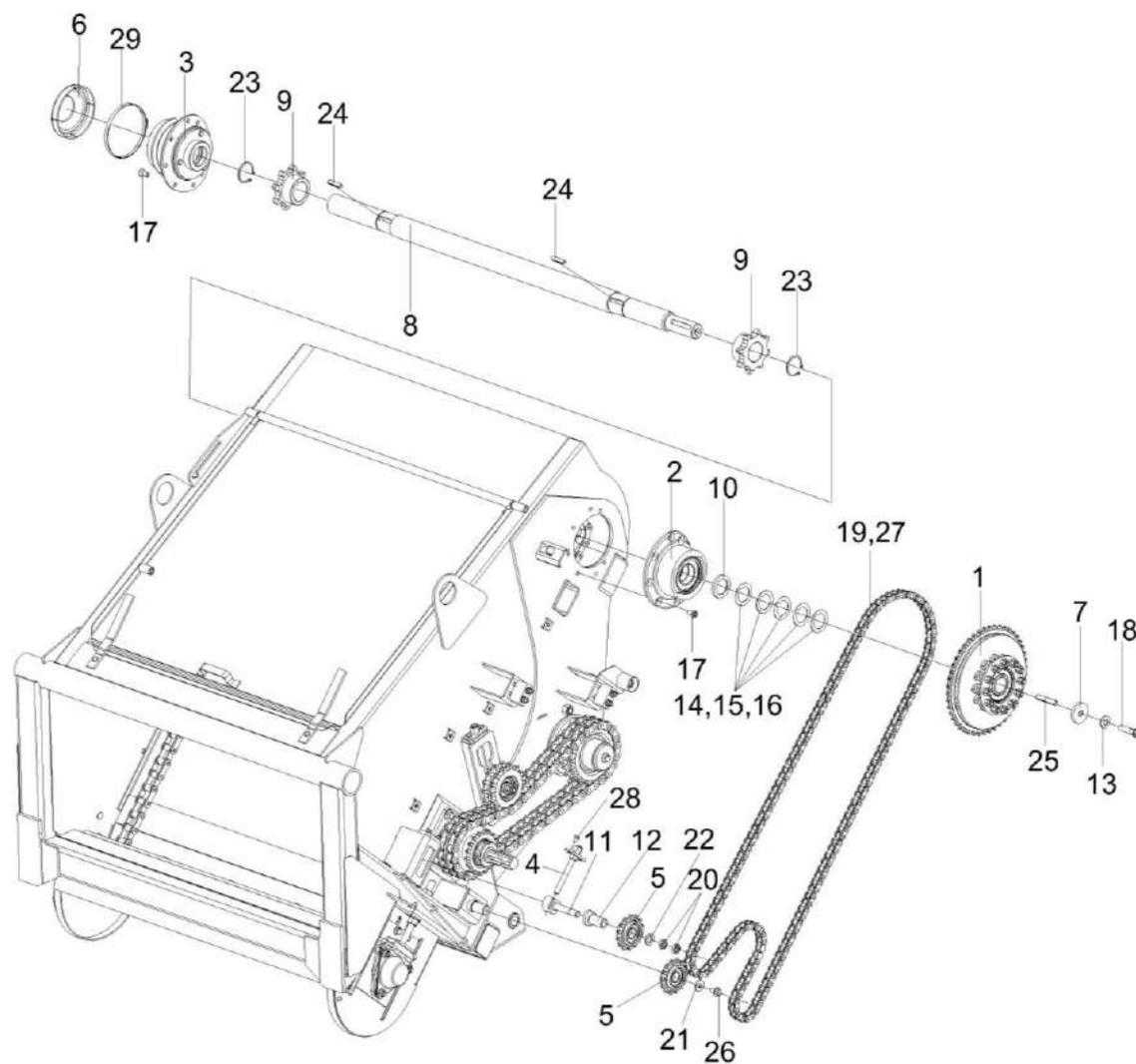
Рисунок 54 – Камера наклонная КП-6-0103000 (лист 2)
