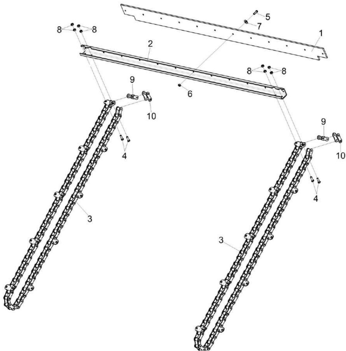
Рисунок 84 – Транспортер КП-6-0102180Б
