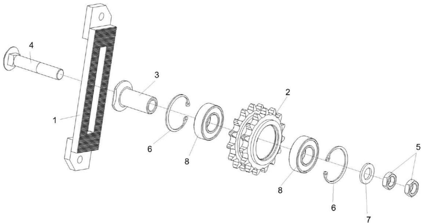
Рисунок 43 – Устройство натяжное КП-6-0524000
