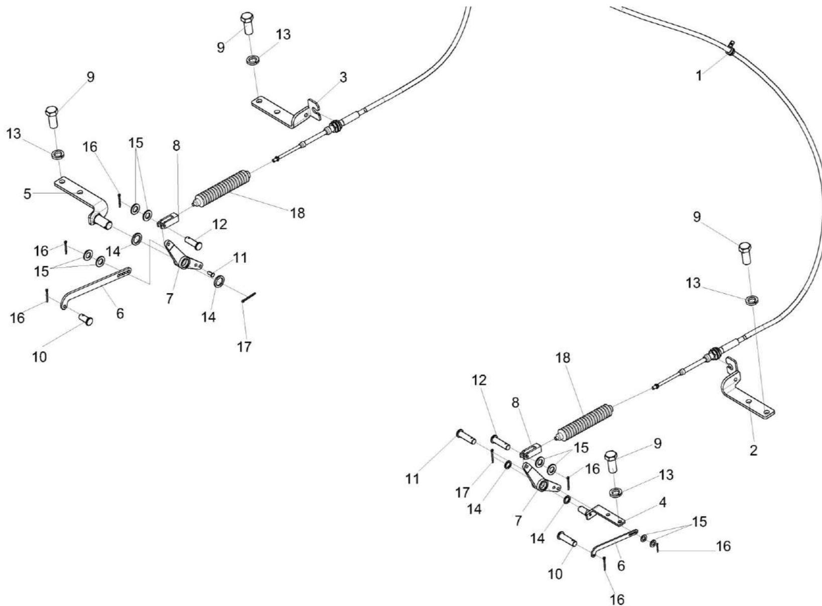
Рисунок 196 – Установка тросов управления стояночным тормозом КП-6-0119140
