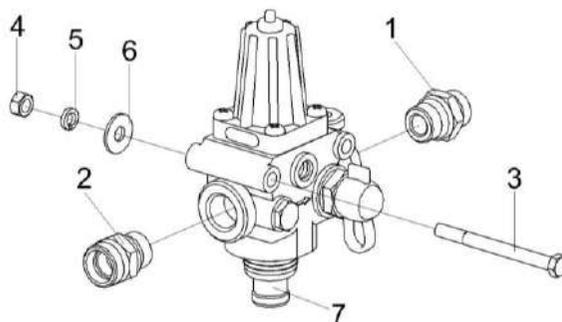
Рисунок 261 – Регулятор давления КНС-6028-0180190-01
