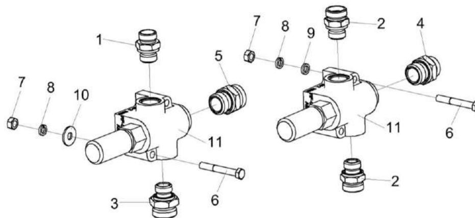
Рисунок 240 – Регулятор-делитель потока КП-6-0604300 и КП-6-0604310
