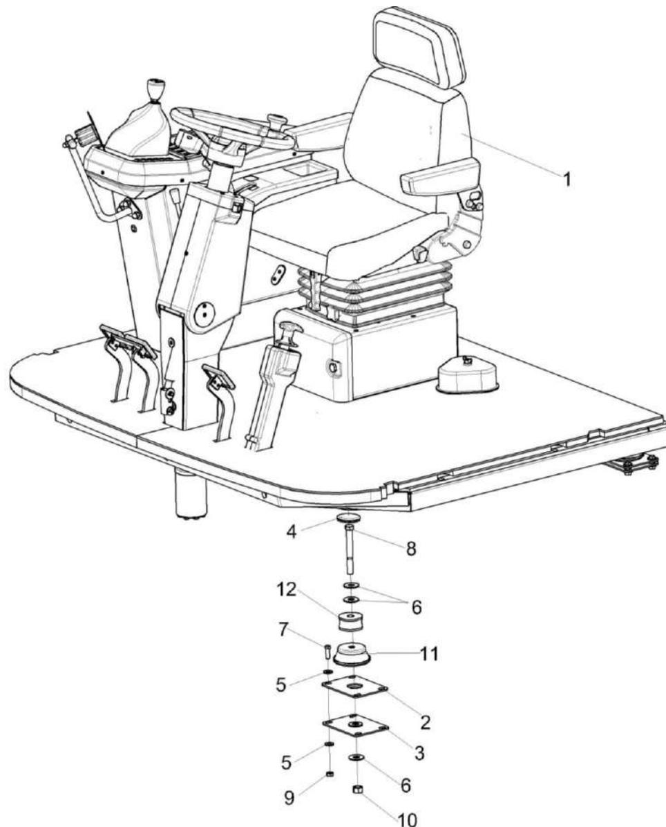
Рисунок 175 – Установка площадки управления КП-6-0119200
