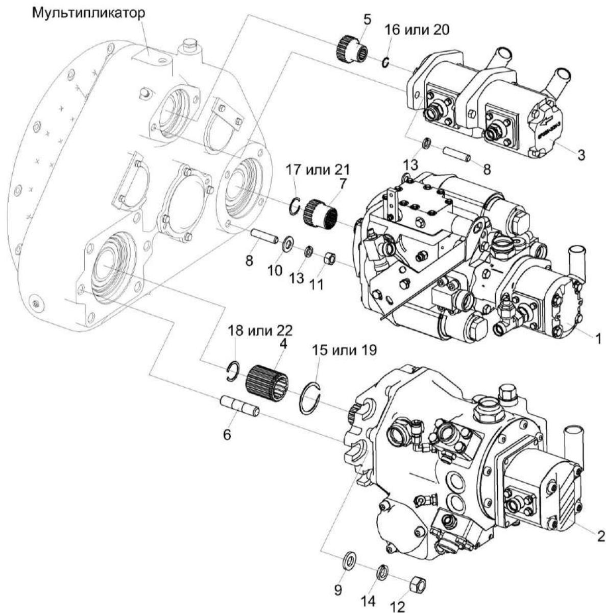
Рисунок 255 – Установка гидронасосов КП-6-0117000
