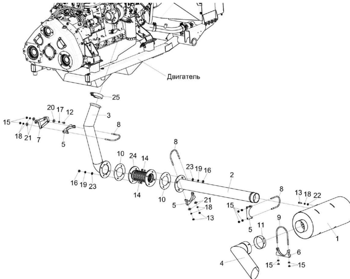
Рисунок 150 – Установка глушителя КП-6-0106060
