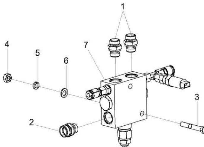
Рисунок 243 – Клапан промывочный КП-6-0604340
