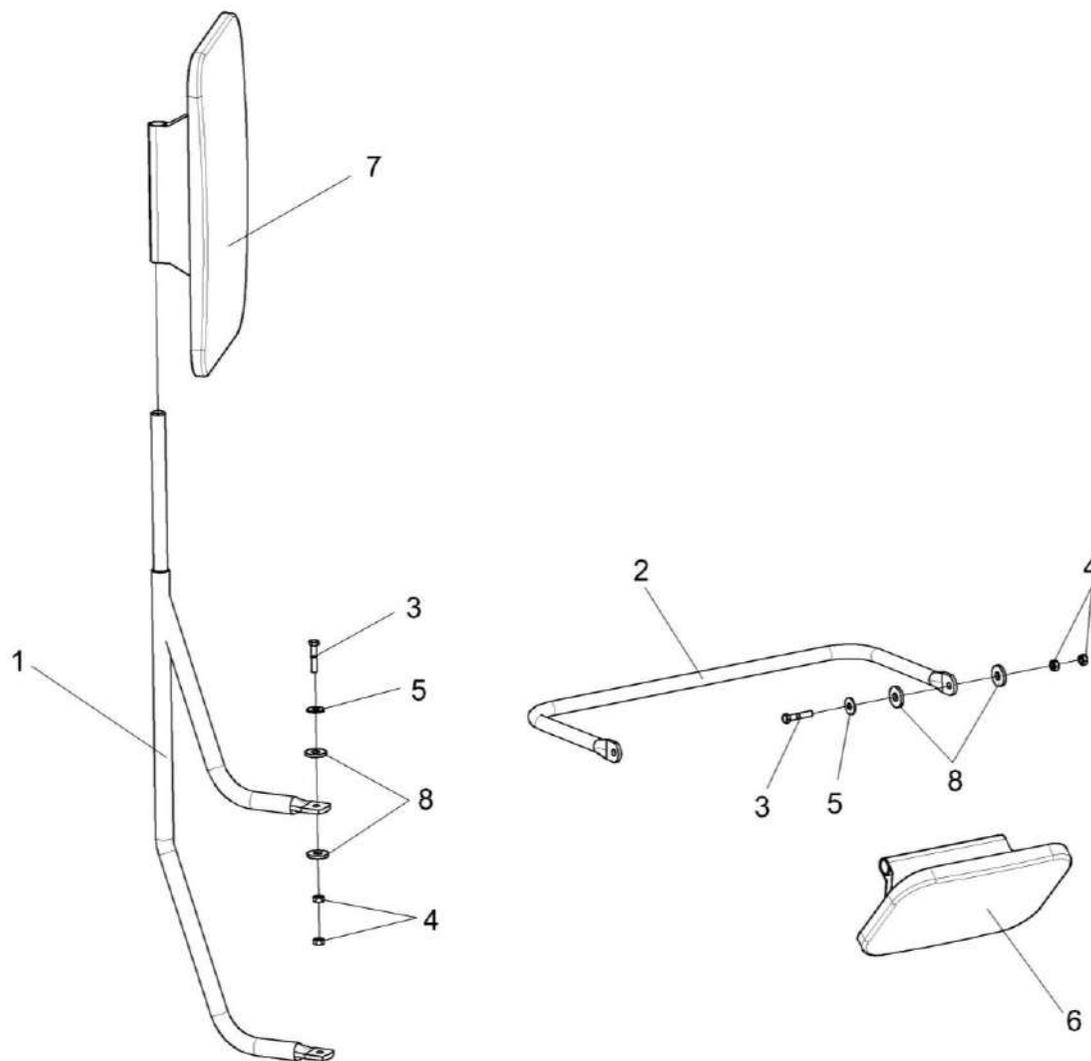
Рисунок 211 – Установка зеркал КП-6-0116000
