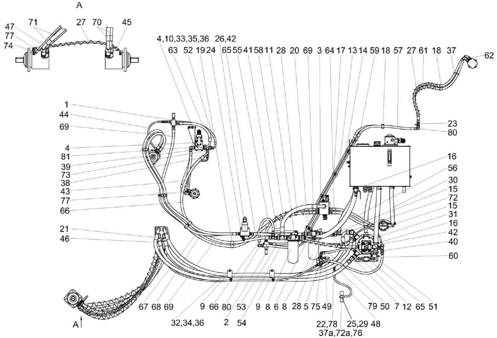
Рисунок 238 – Гидропривод рабочих органов КП-6-0604000 (лист 1)
