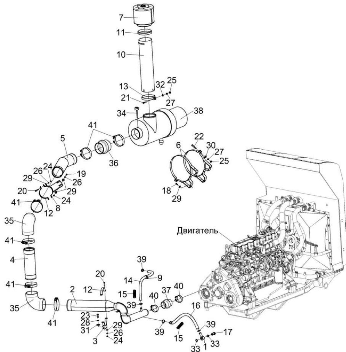
Рисунок 153 – Установка воздухоочистителя КП-6-0106080
