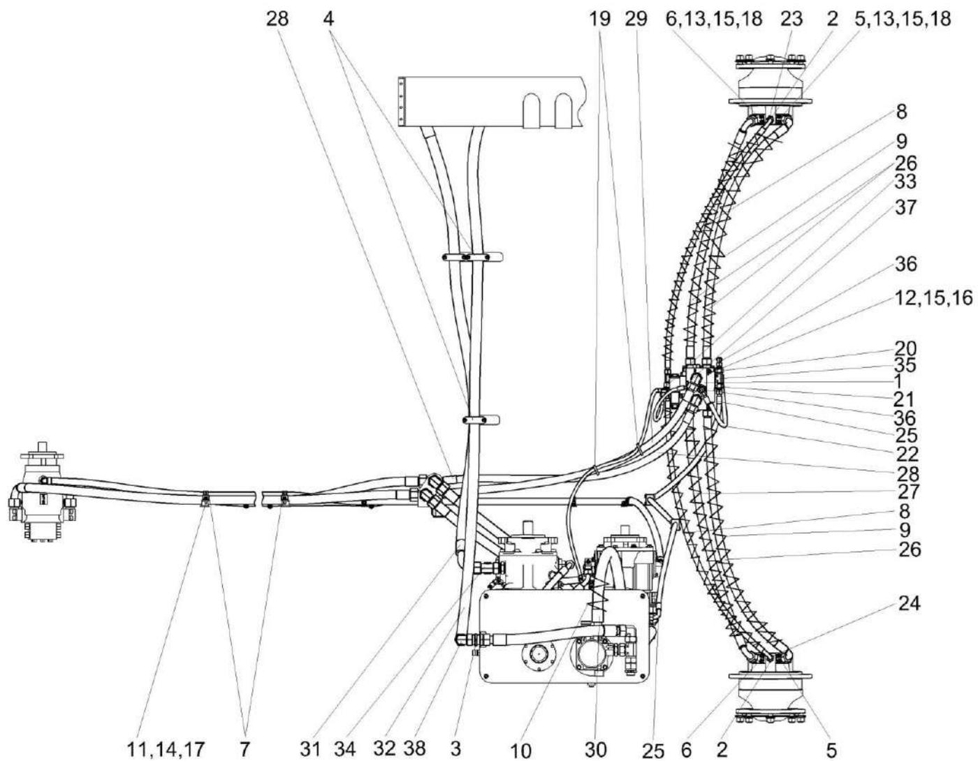
Рисунок 229 – Гидропривод ходовой части КП-6-0601000 (лист 2)
