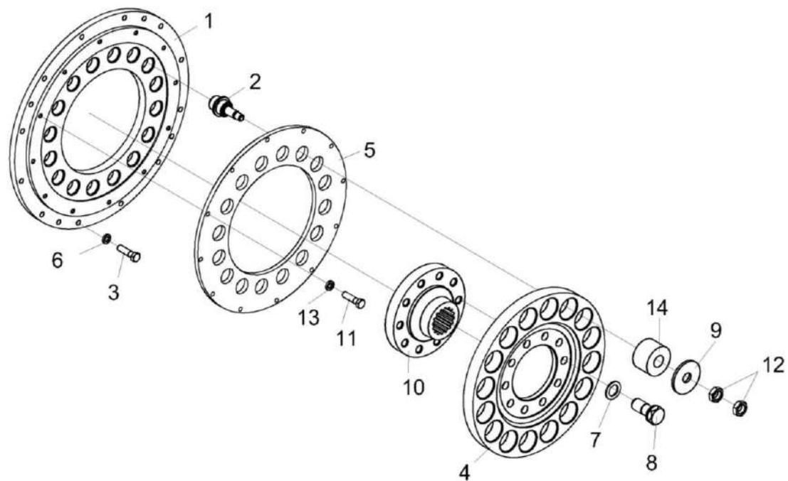
Рисунок 138 – Установка муфты КП-6-0106030
