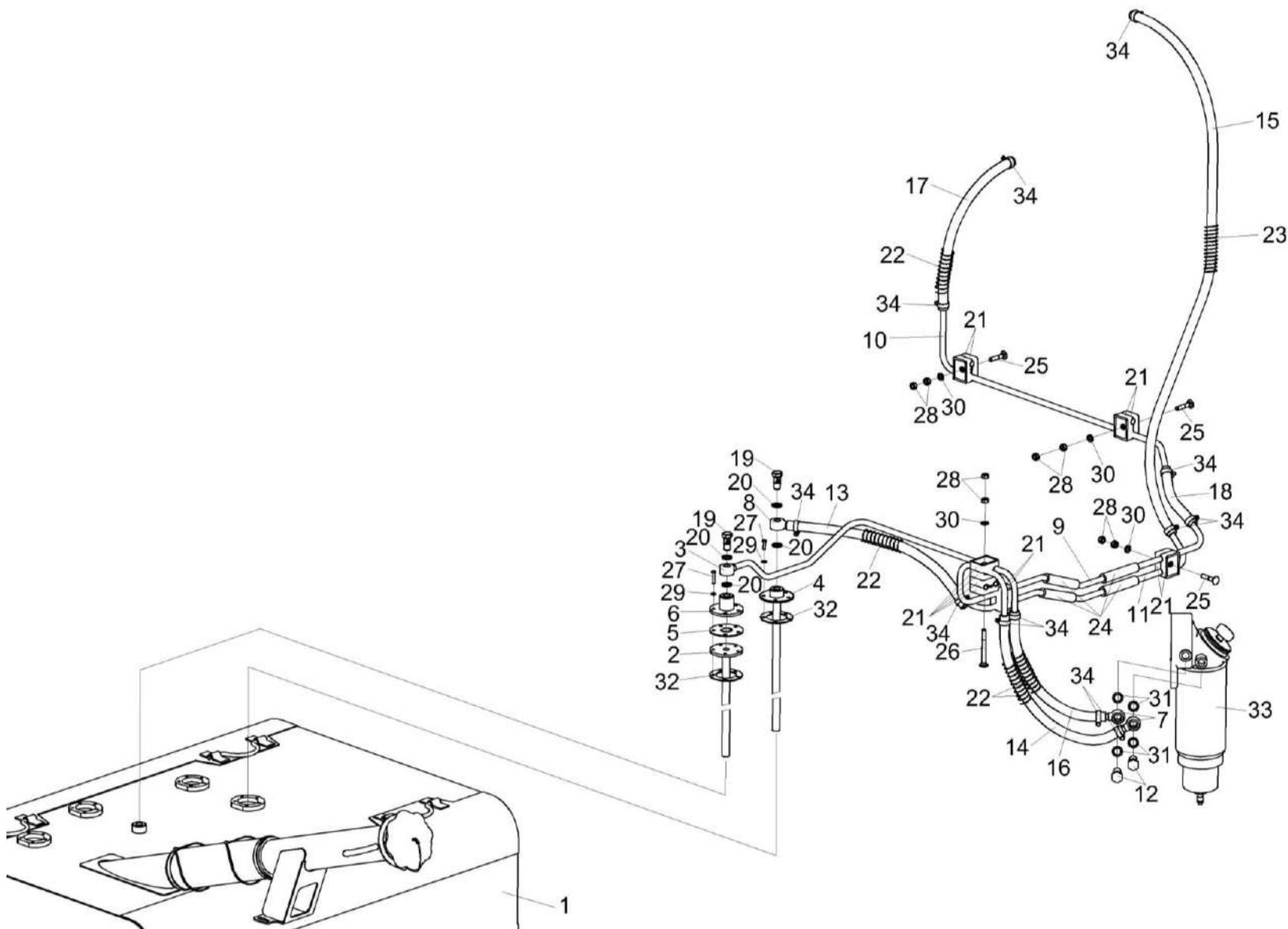
Рисунок 251 – Установка топливного оборудования КП-6-0126000 (лист 2)
