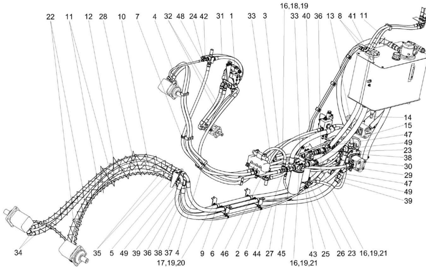
Рисунок 239 – Гидропривод рабочих органов КП-6-0604000 (лист 2)
