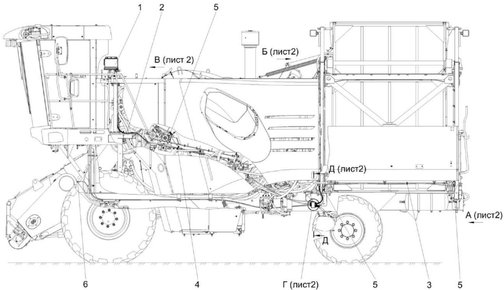
Рисунок 267 – Установка автоматической централизованной системы смазки КП-6-0185000А (лист 1)
