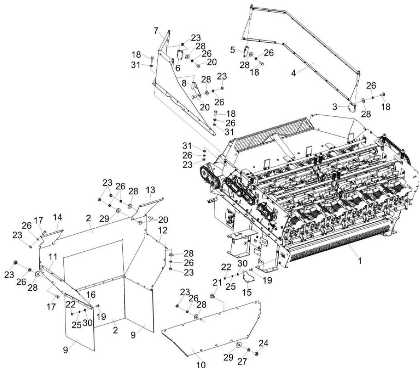
Рисунок 78 – Установка устройства початкоочистительного КП-6-0102000А (лист 2)
