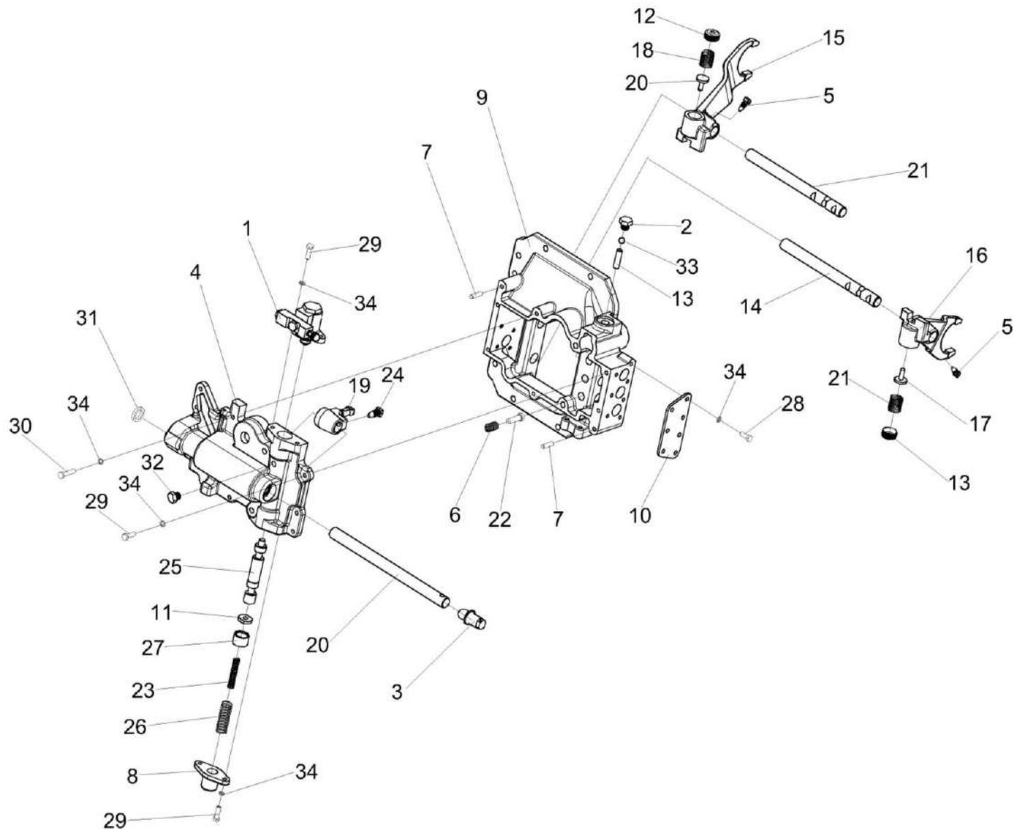
Рисунок 169 – Механизм переключения передач КЗК-8-0107560
