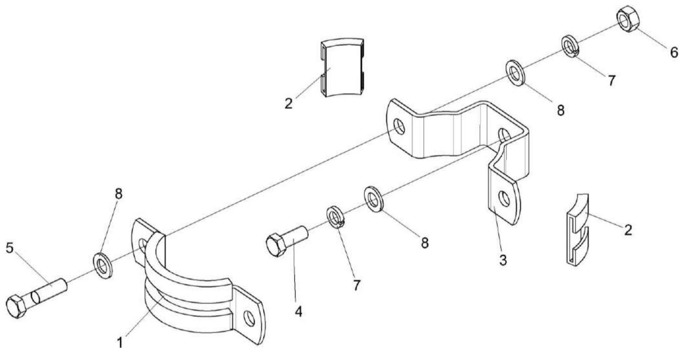
Рисунок 216 – Установка ресивера КЗК-8-3-0113050
