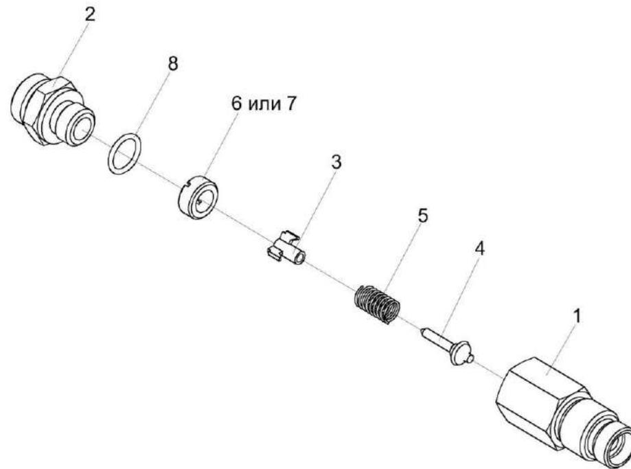
Рисунок 231 – Клапан дренажный КЗК-2-12-0601300
