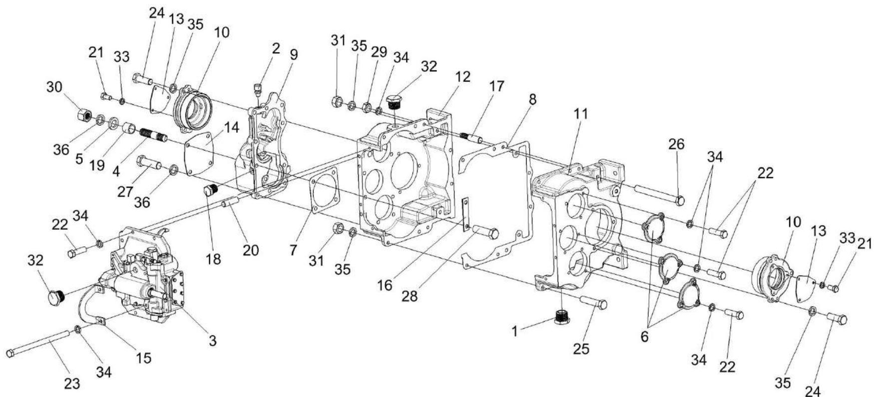
Рисунок 166 – Коробка диапазонов КЗК-8-0107530 (корпус, крышки)
