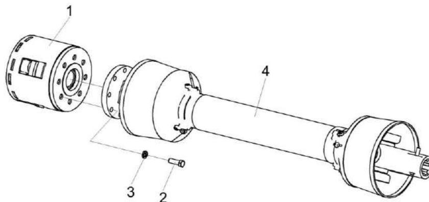
Рисунок 46 – Вал карданный телескопический КЗК 0500250
