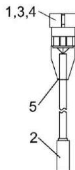
Рисунок 266 – Датчик оборотов КВК 0700770
