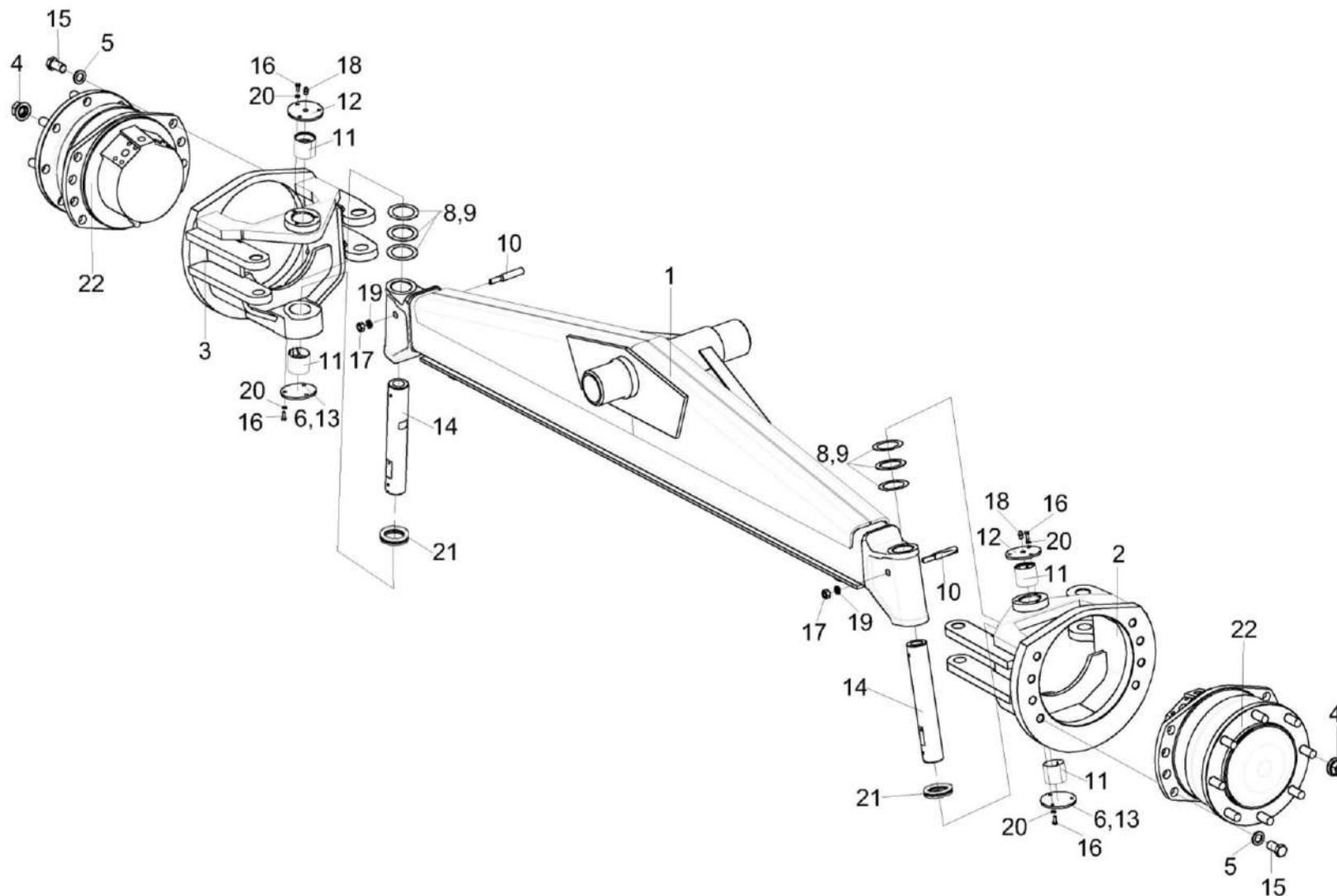
Рисунок 171 – Мост управляемых колес КП-6-0109000 (лист 1)
