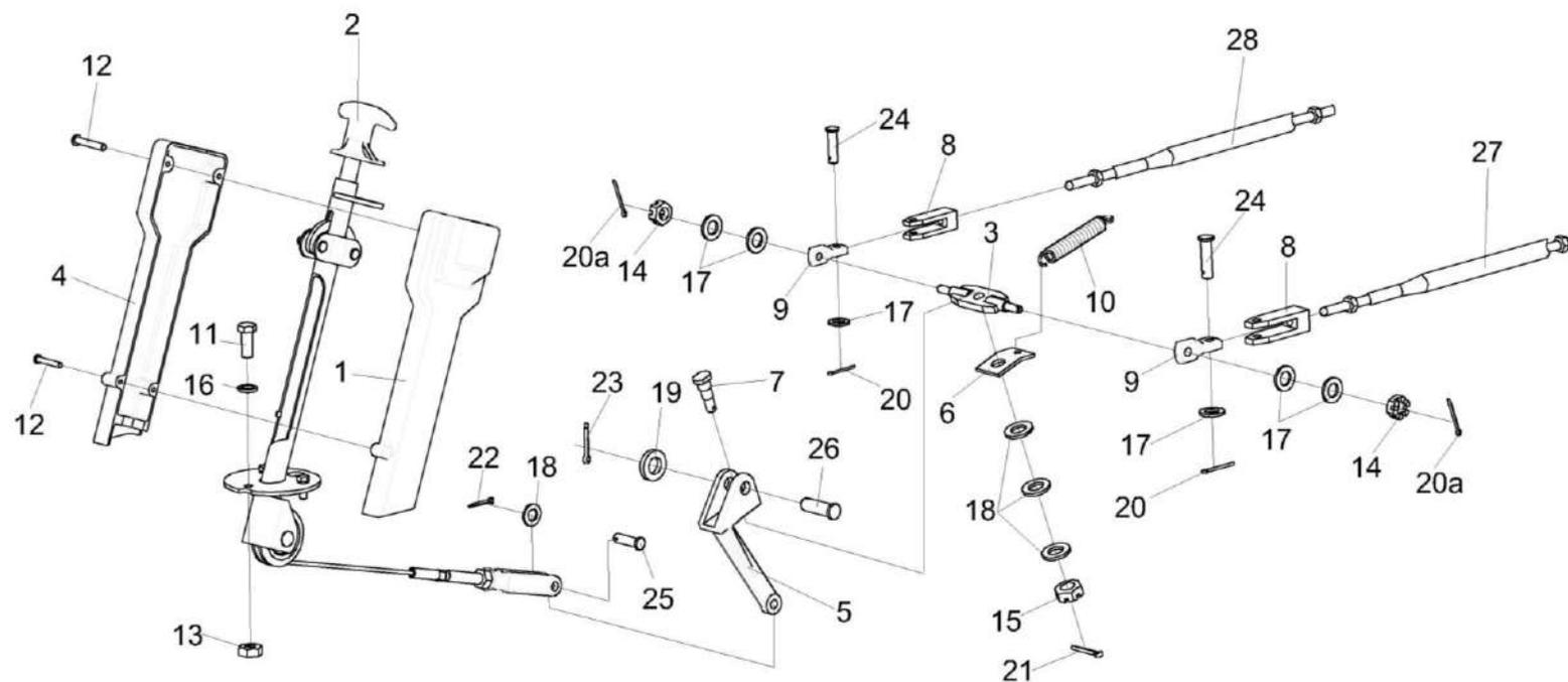
Рисунок 193 – Установка колонки привода УЭС 0300710
