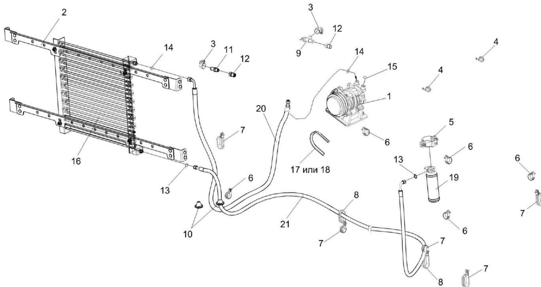
Рисунок 213 – Установка оборудования кондиционера КП-6-0121010
