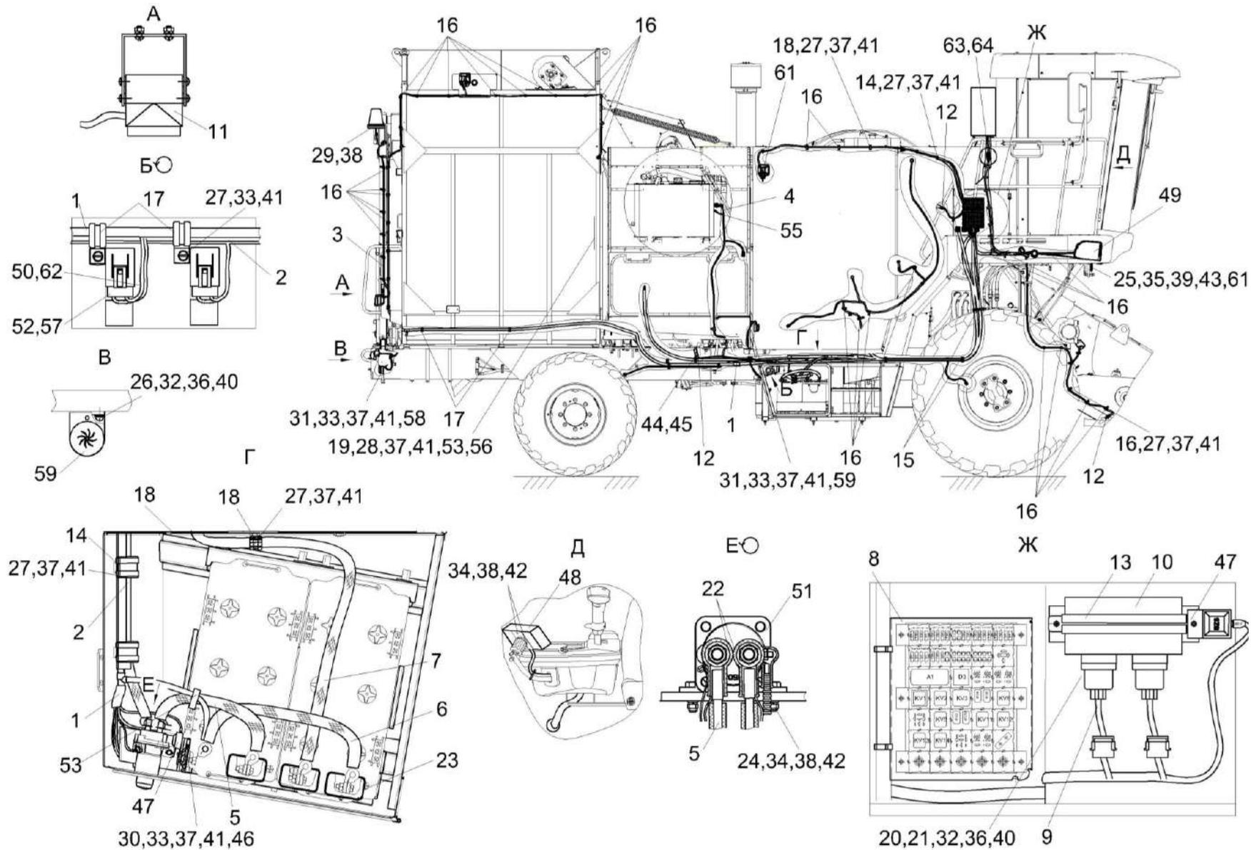
Рисунок 262 – Установка электрооборудования комбайна КП-6 КП-6-0721000 (лист 1)
