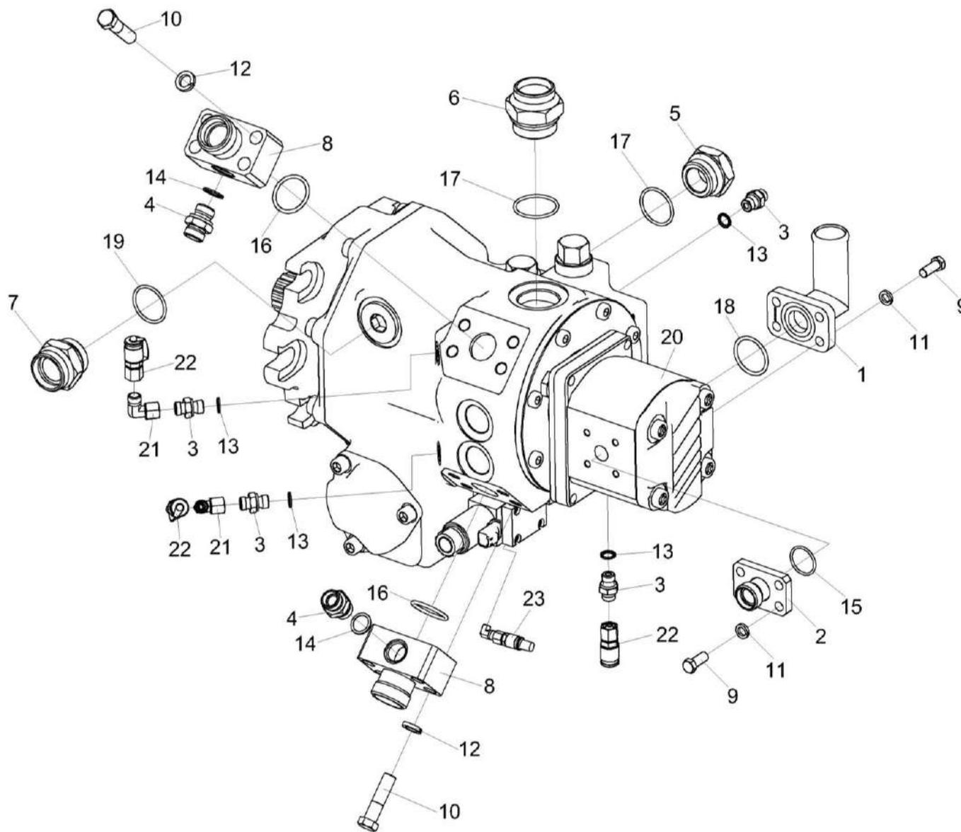
Рисунок 257 – Гидронасос двухсекционный КП-6-0604100
