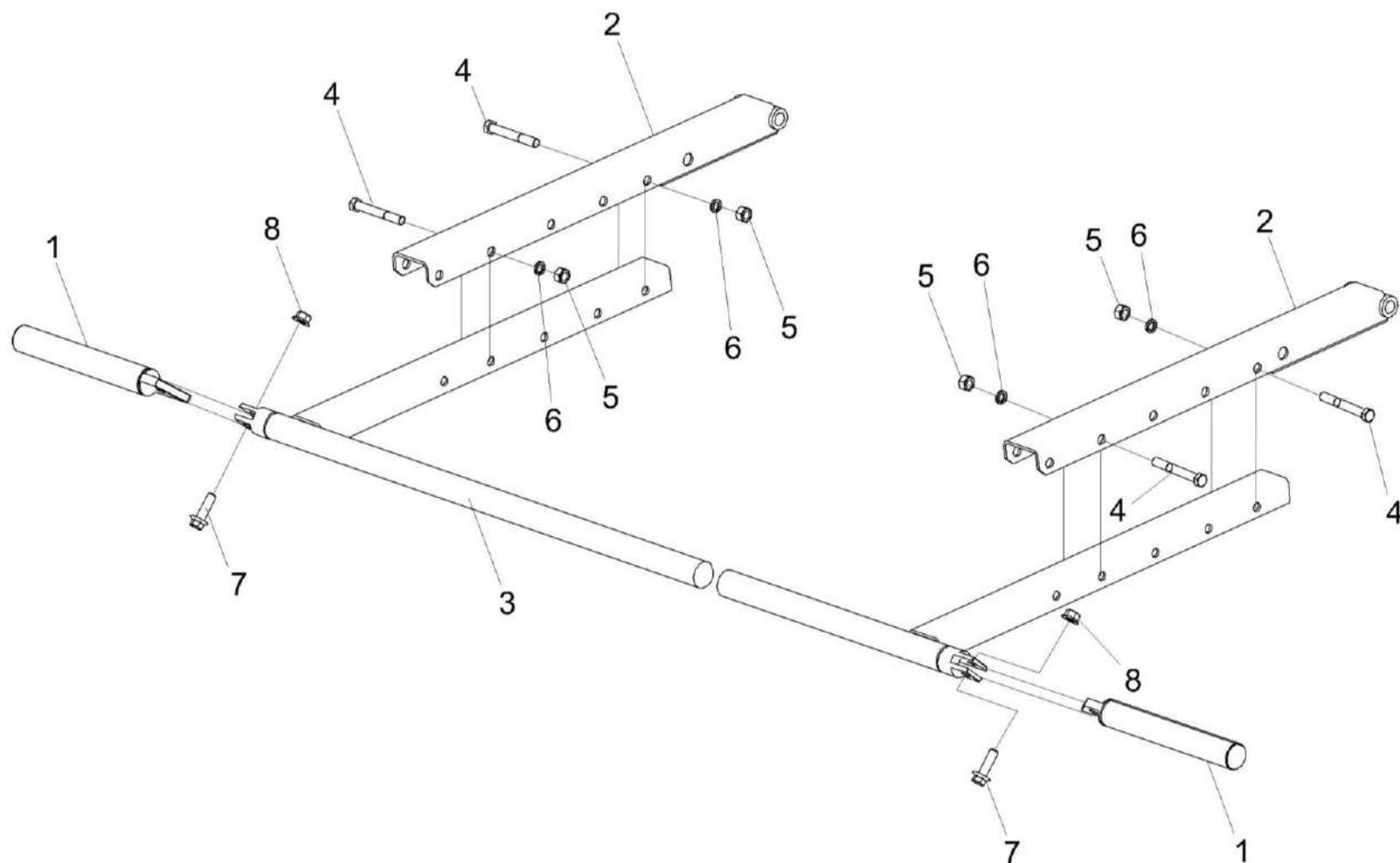
Рисунок 45 – Наклонитель КП-6-0500090
