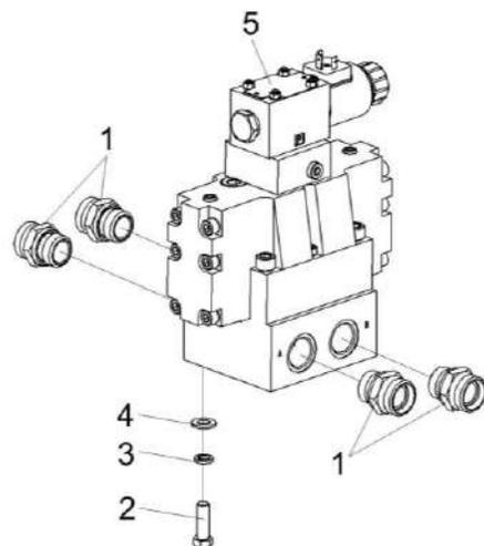
Рисунок 242 – Гидроблок КП-6-0604330
