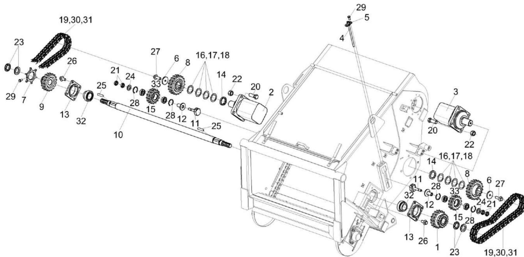
Рисунок 55 – Камера наклонная КП-6-0103000 (лист 3)
