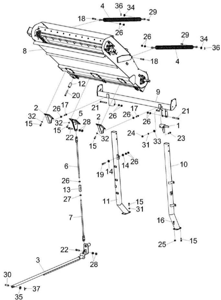
Рисунок 116 – Установка транспортеров загрузочных КП-6-0108000А (лист 4)
