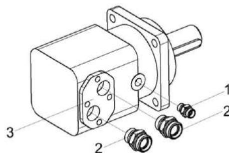
Рисунок 65 – Гидромотор КП-6-0604150
