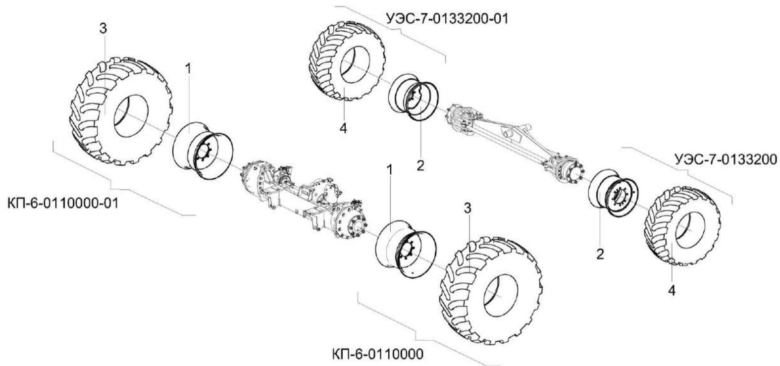
Рисунок 173 – Установка колес
