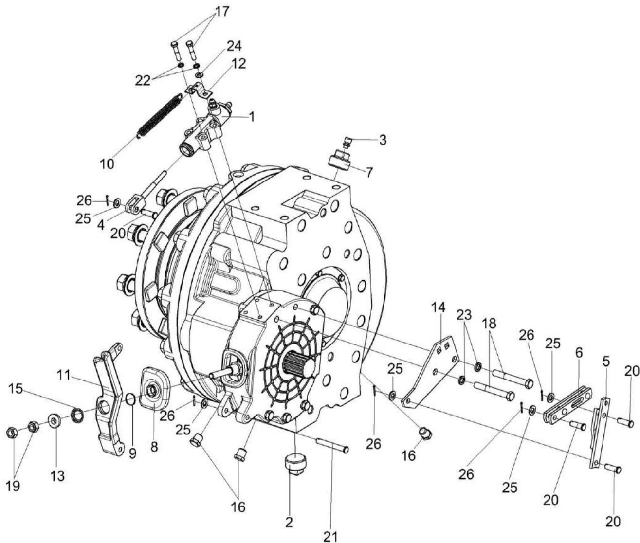
Рисунок 156 – Редуктор бортовой КЗК-10-0107200 (лист 1)
