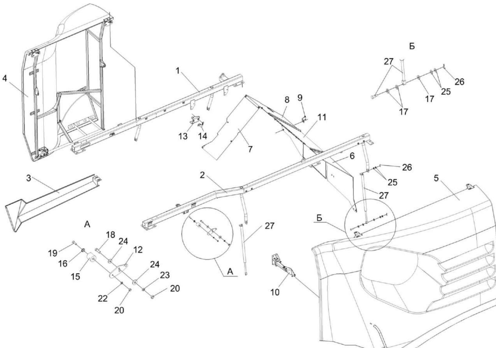
Рисунок 220 – Установка капотов КП-6-0128000А (лист 2)
