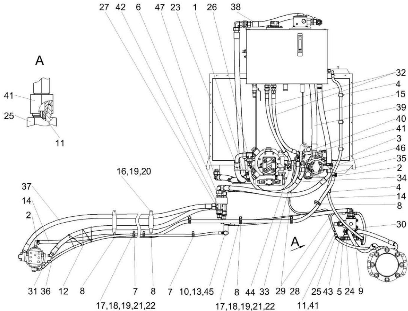
Рисунок 228 – Гидропривод ходовой части КП-6-0601000 (лист 1)
