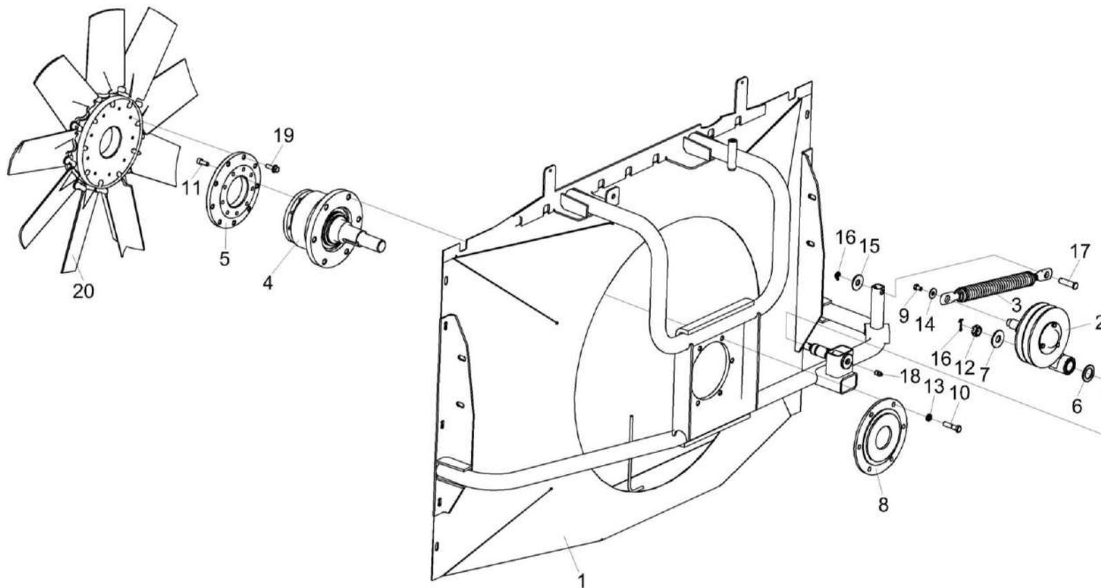
Рисунок 143 – Установка диффузора КП-6-0106130
