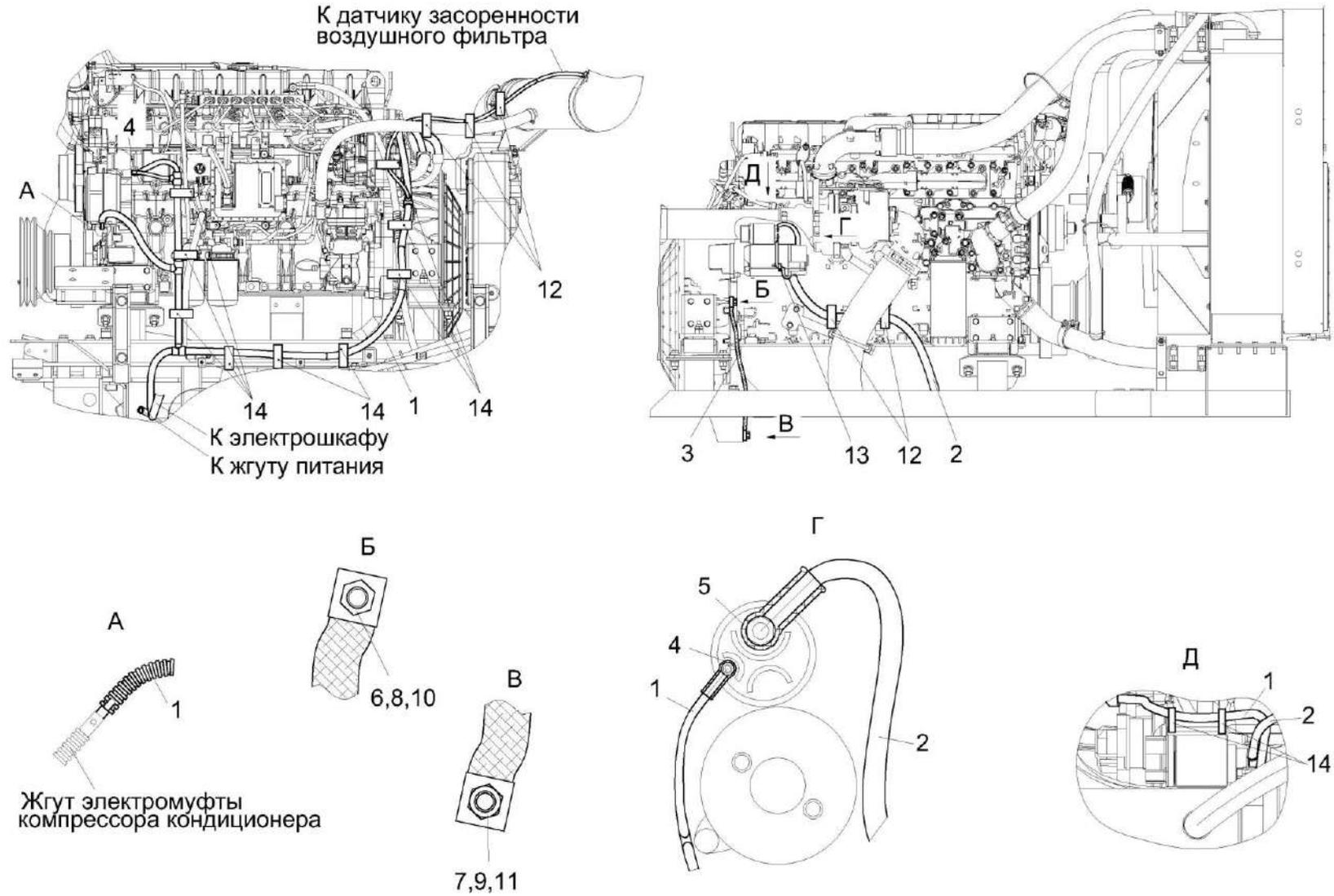
Рисунок 154 – Установка электрооборудования двигателя КП-6-0726000
