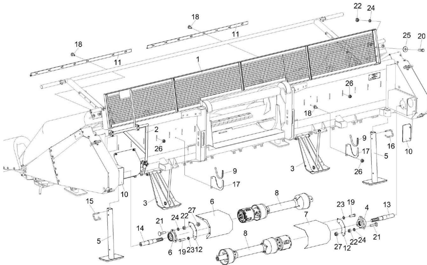
Рисунок 9 – Жатка КП-6-0500000 (вид сзади)
