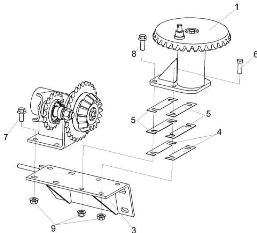
Рисунок 105 – Привод распределителя КП-6-0102400
