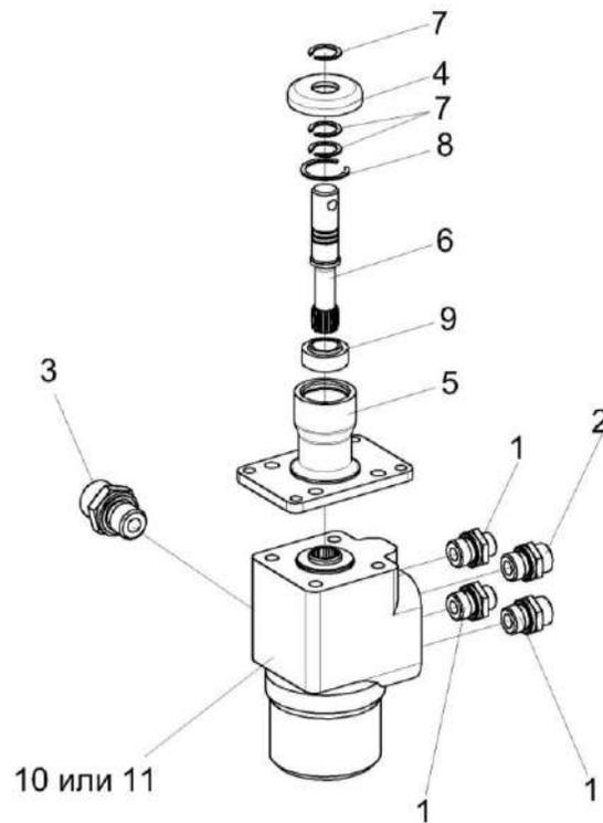
Рисунок 190 – Установка насоса-дозатора КП-6-0602230
