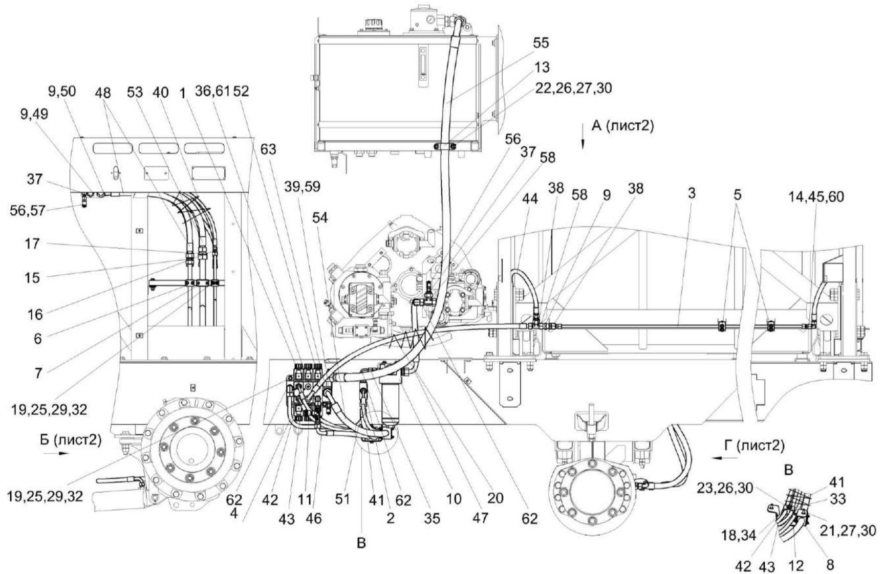
Рисунок 232 – Гидросистема силовых цилиндров и рулевого управления КП-6-0602000 (лист 1)
