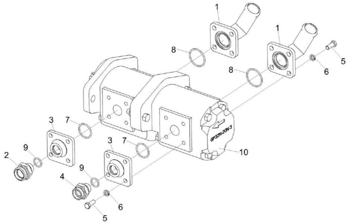
Рисунок 258 – Гидронасос двухсекционный КП-6-0604110
