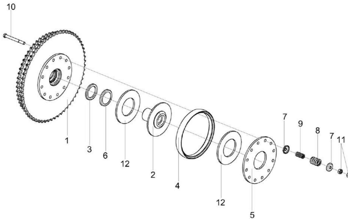
Рисунок 72 – Муфта фрикционная КП-6-0104360А
