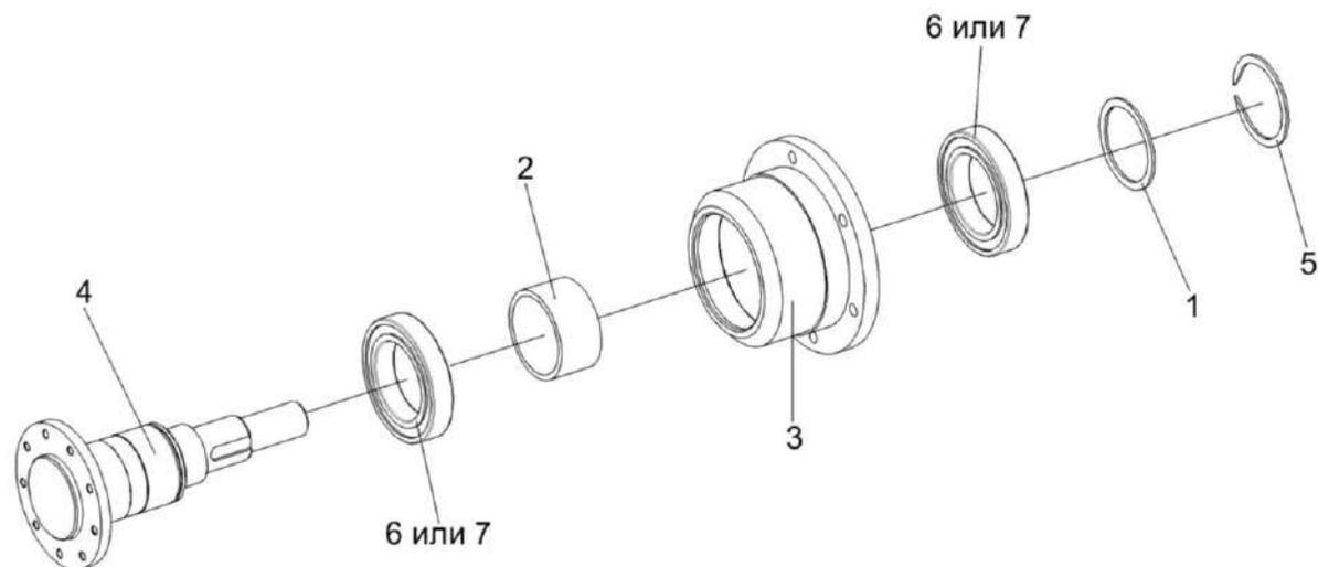
Рисунок 146 – Привод вентилятора КЗК-12-2-0106550
