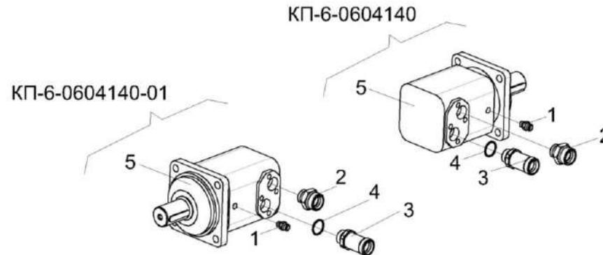
Рисунок 61 – Гидромотор КП-6-0604140 и КП-6-0604140-01
