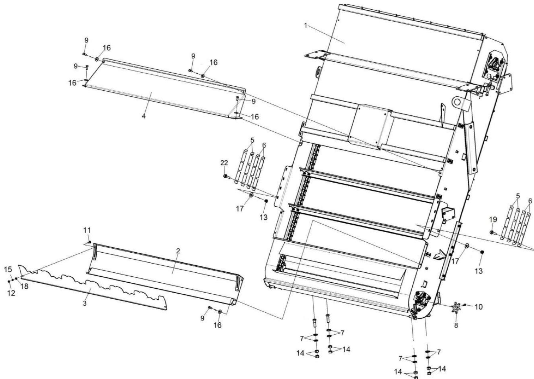
Рисунок 115 – Установка транспортеров загрузочных КП-6-0108000А (лист 3)
