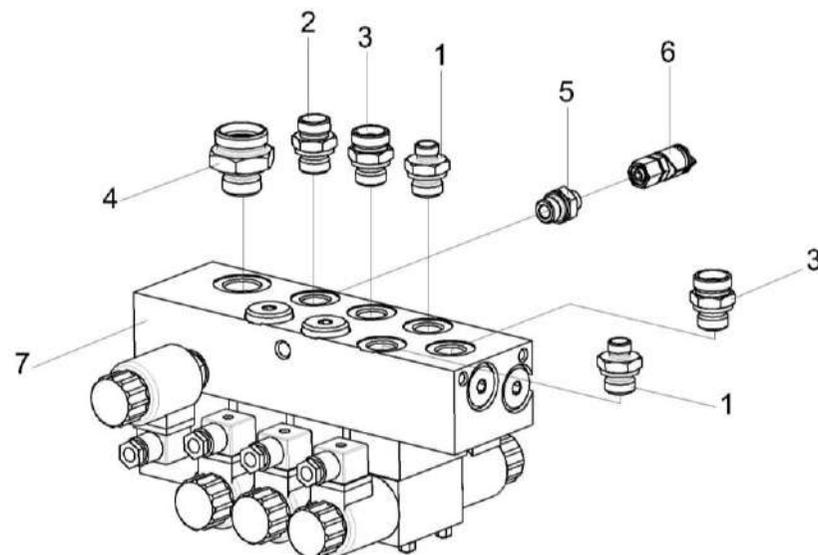
Рисунок 234 – Гидроблок трехсекционный КП-6-0602300А
