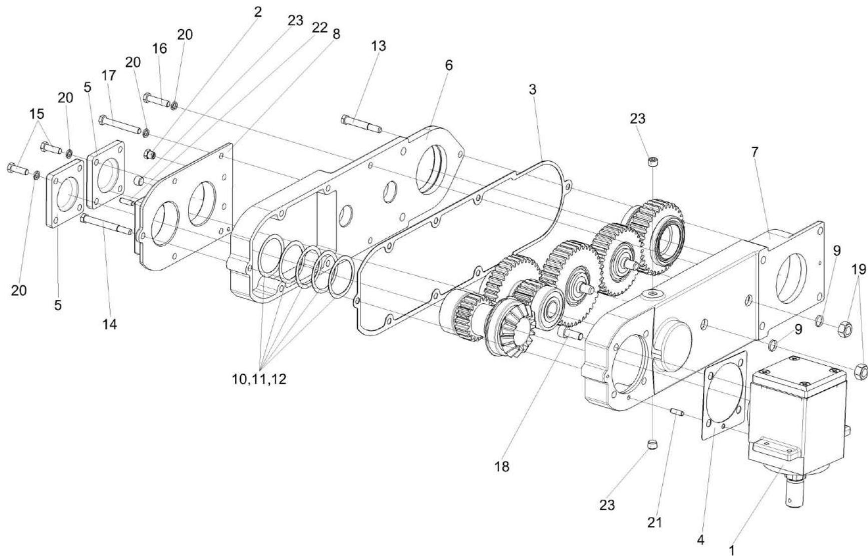
Рисунок 33 – Мультипликатор КПС-4-0517100-01 (корпуса, крышки)
