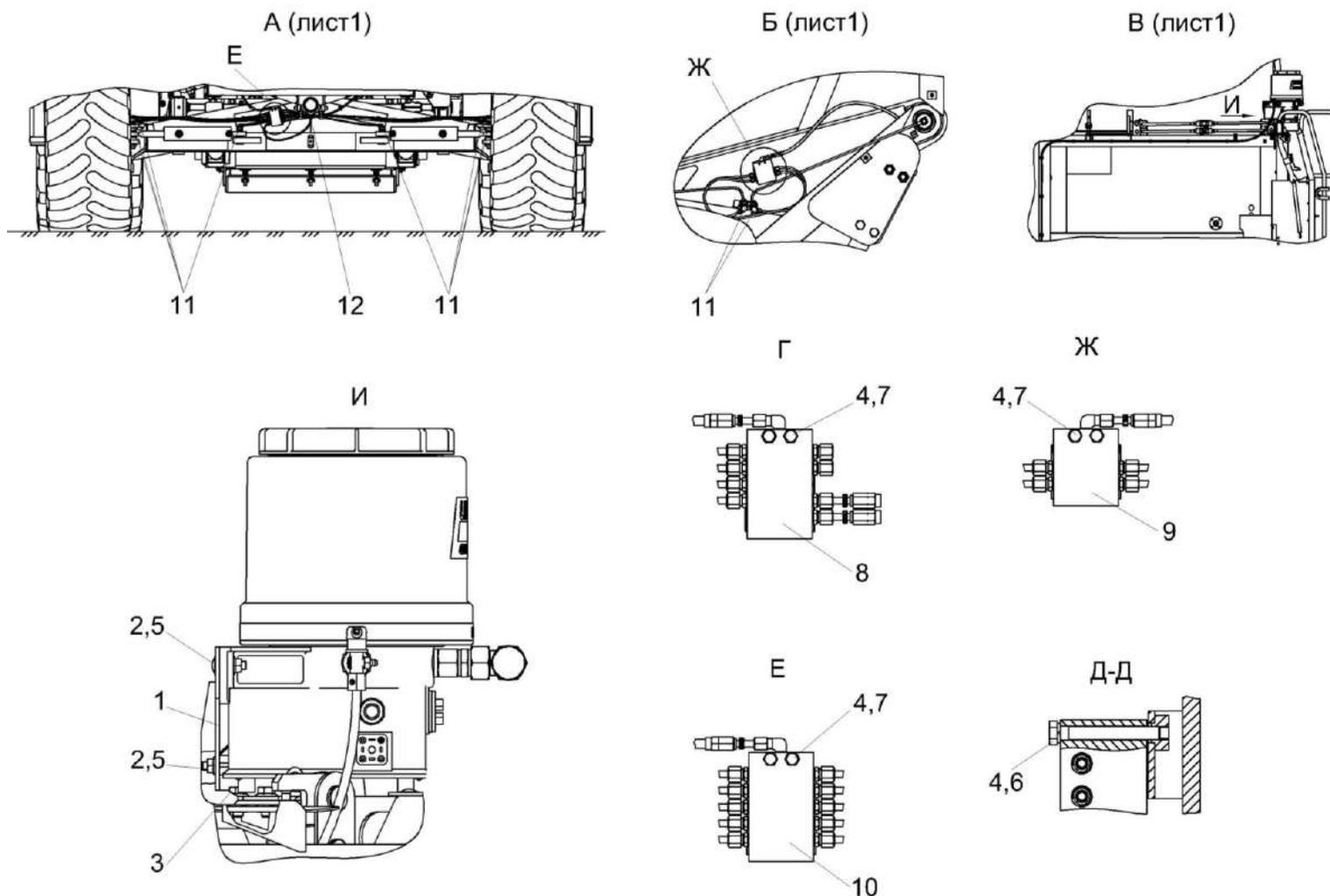
Рисунок 268 – Установка автоматической централизованной системы смазки КП-6-0185000А (лист 2)
