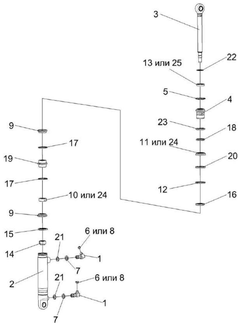
Рисунок 34 – Гидроцилиндр ПКК 0113200-06
