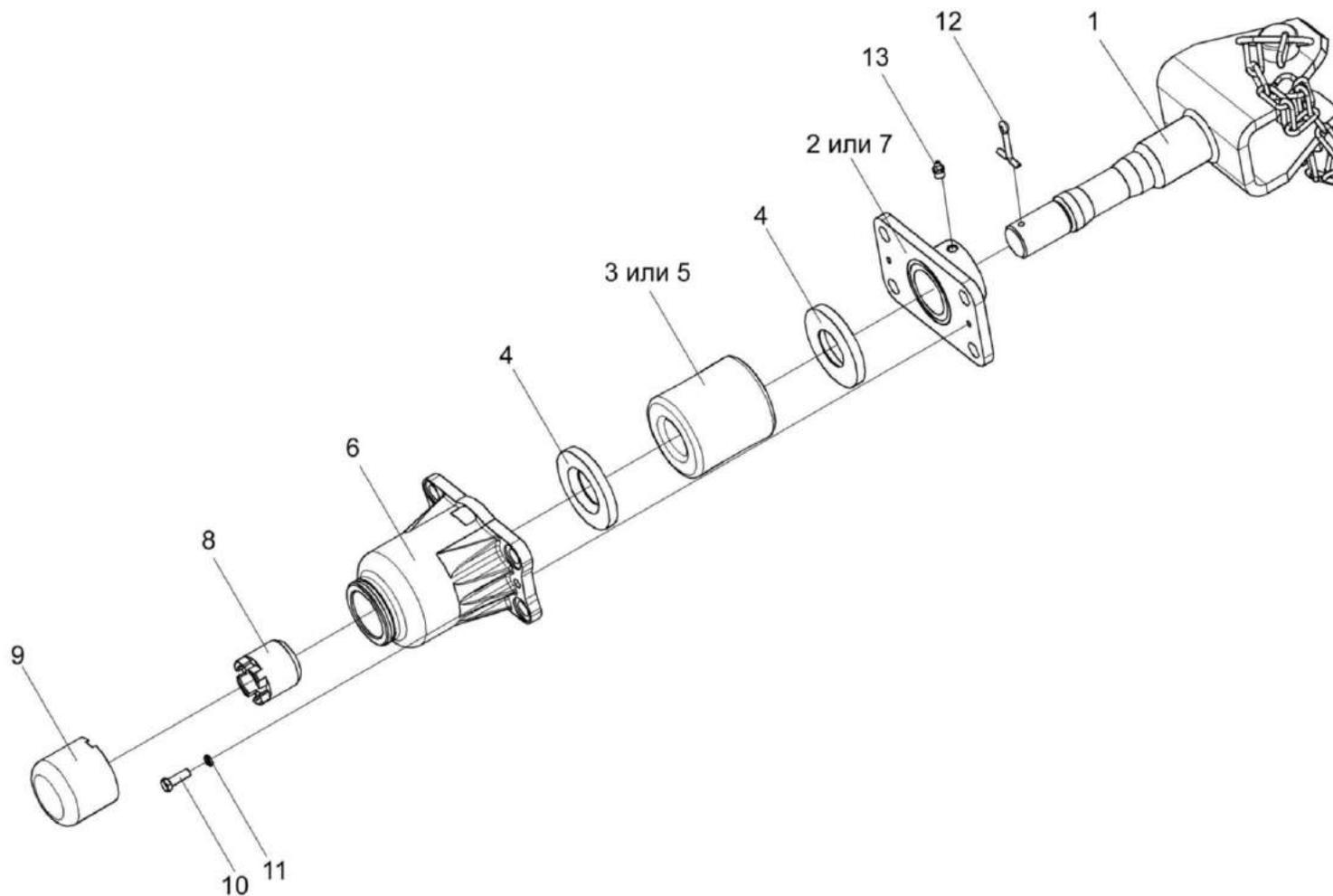
Рисунок 135 – Устройство прицепное КИС 0122000А
