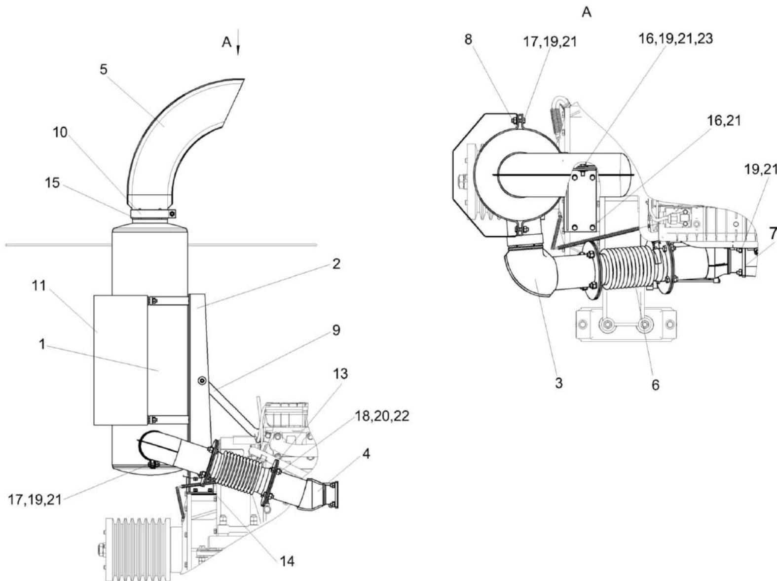
Рисунок 39 – Установка выпускной системы КГС-10-0116060
