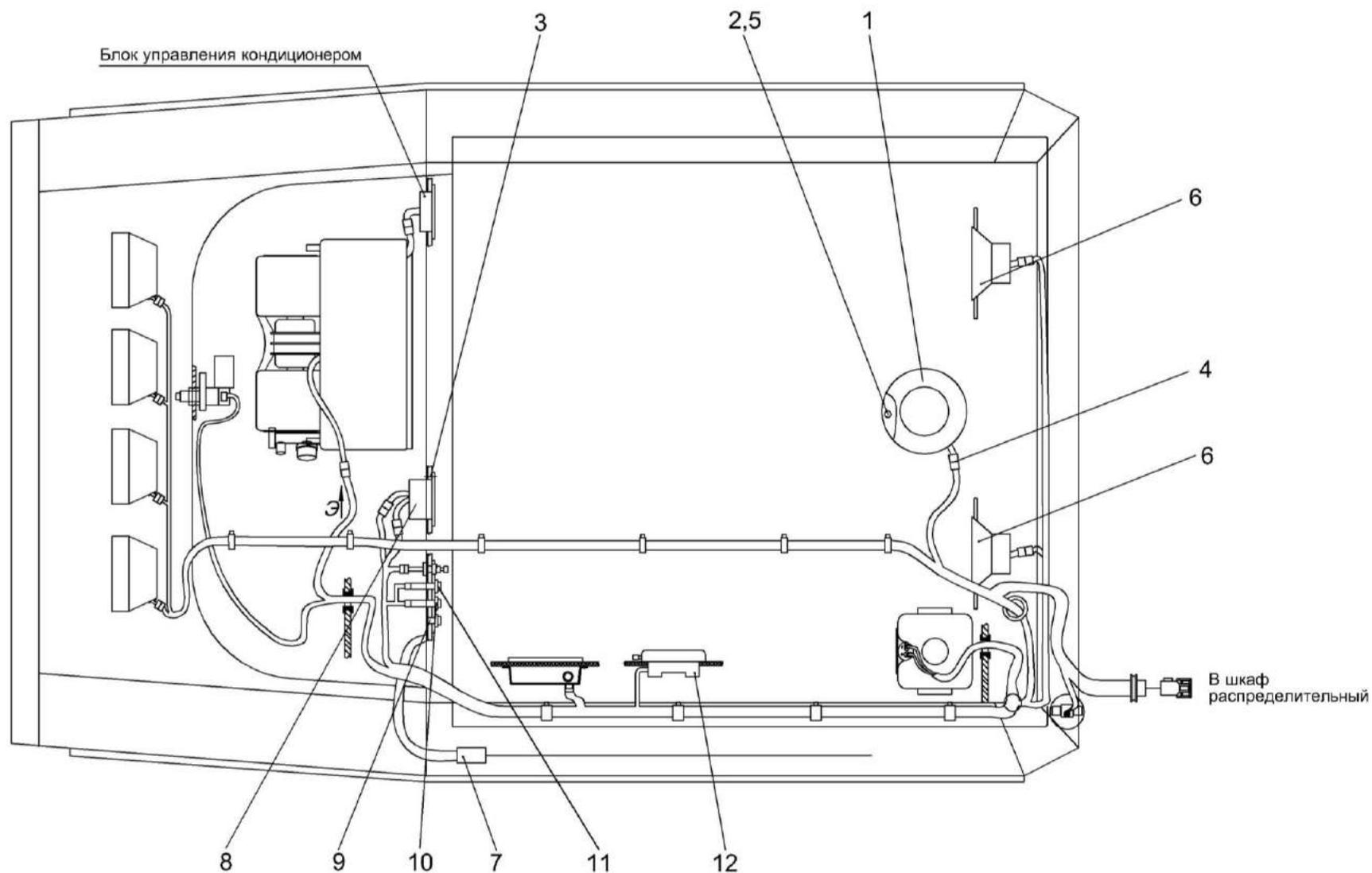
Рисунок 97 – Электрооборудование кабины КГС 0120000 (вид сверху)
