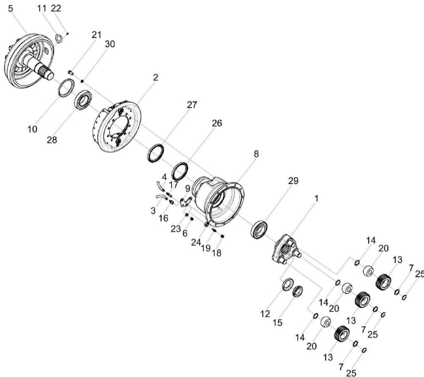
Рисунок 76 – Редуктор бортовой 54-4-4
