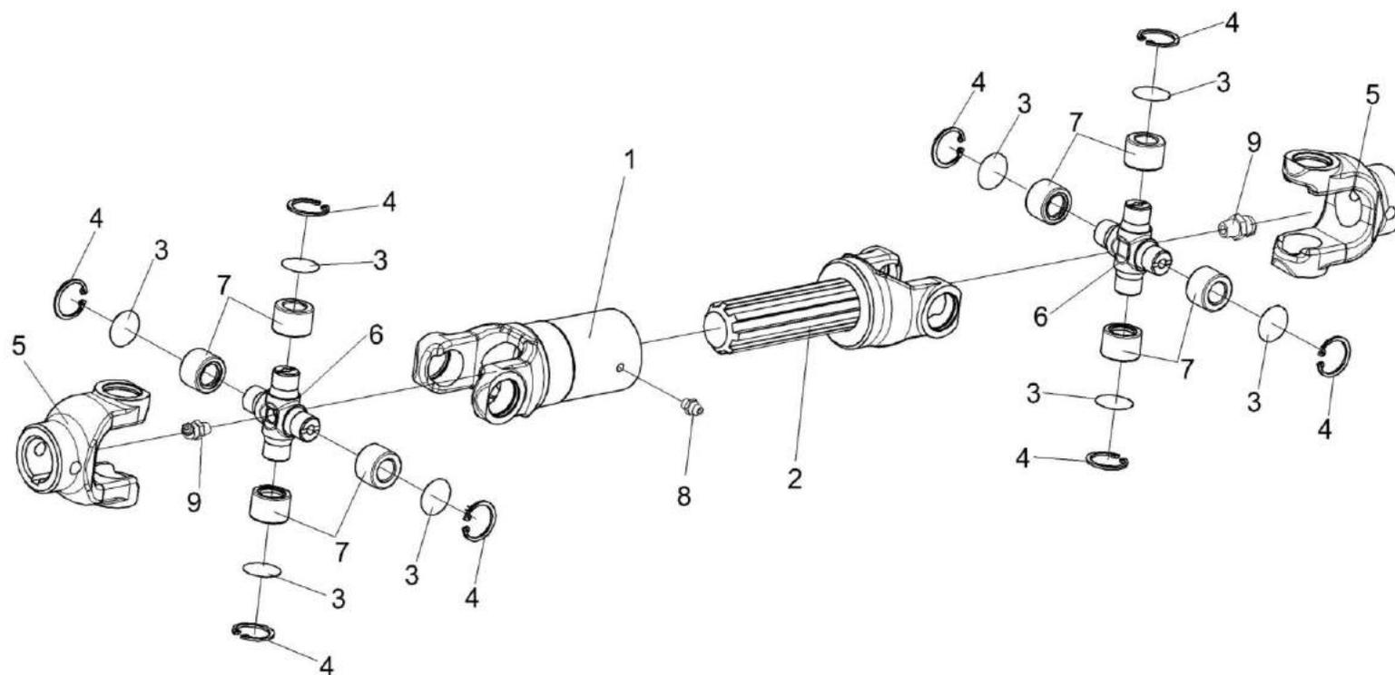
Рисунок 67 – Вал карданный телескопический КГС 0112400
