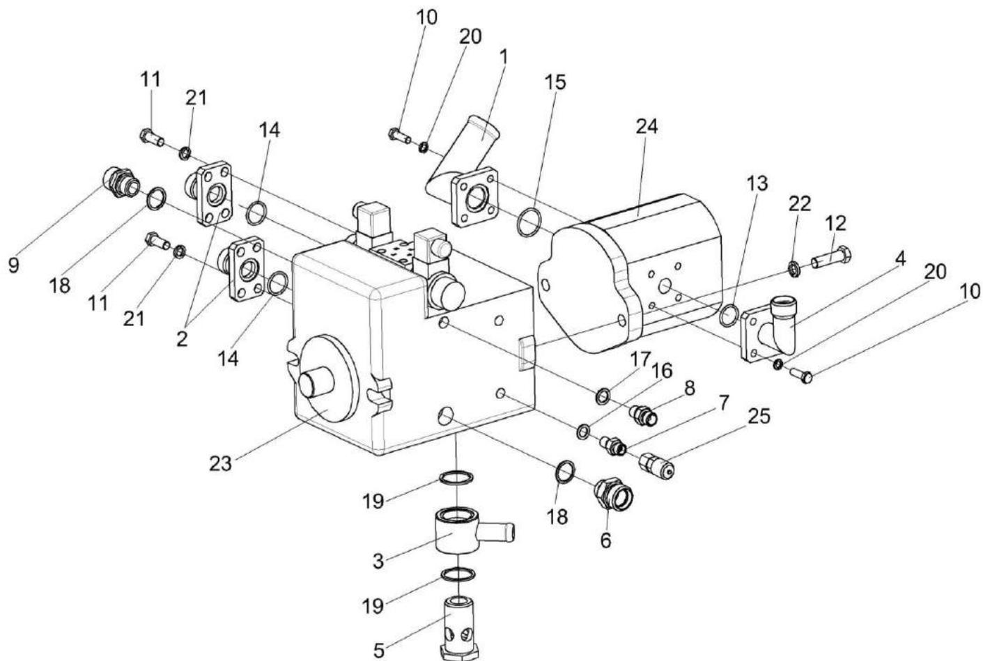
Рисунок 151 – Гидронасос двухсекционный КГС 0115300А
