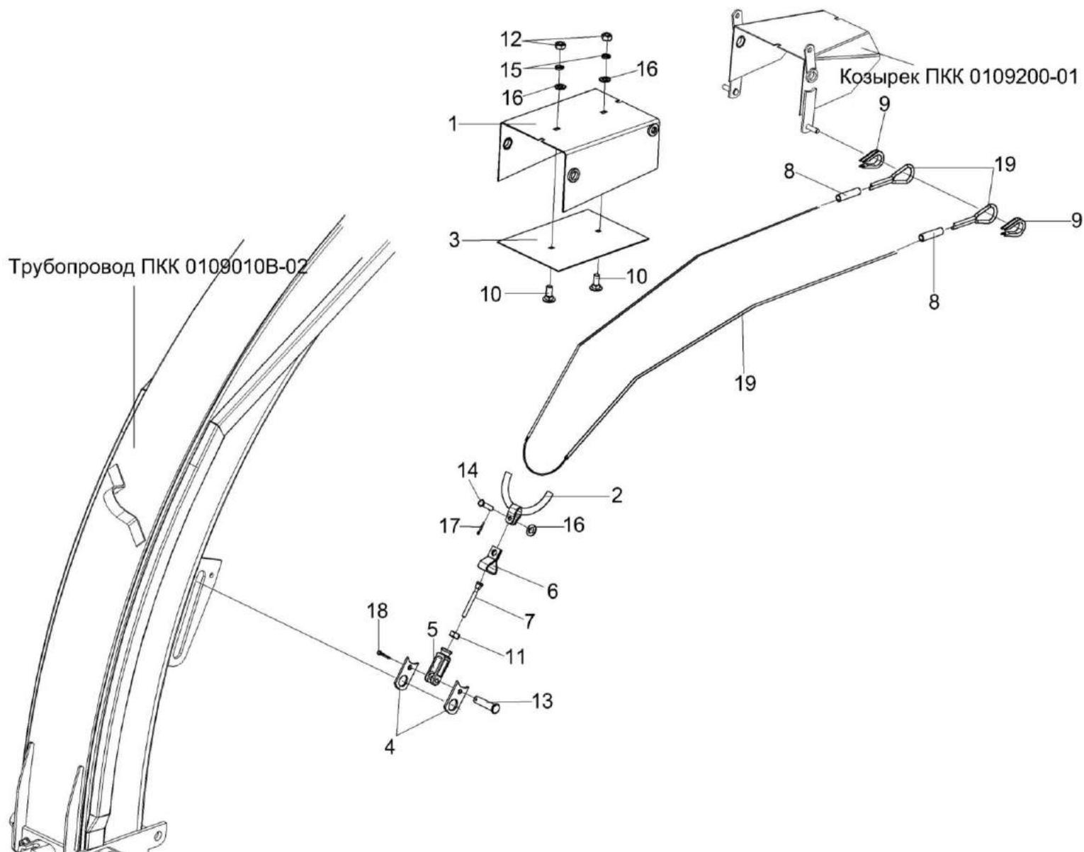
Рисунок 33 – Устройство натяжное, канат, козырьки силосопровода
