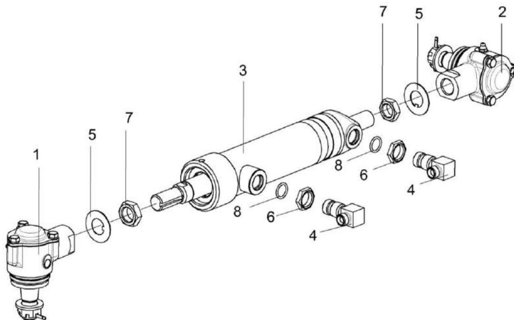
Рисунок 84 – Гидроцилиндр КИЛ 0118450
