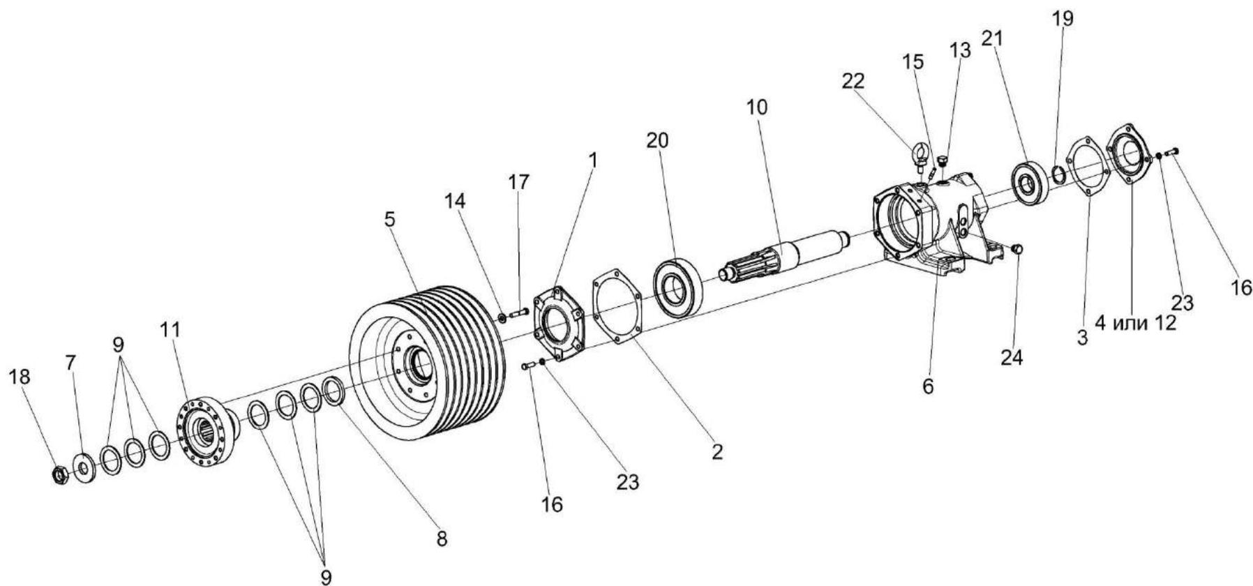
Рисунок 61 – Контрпривод КИЛ 0149100
