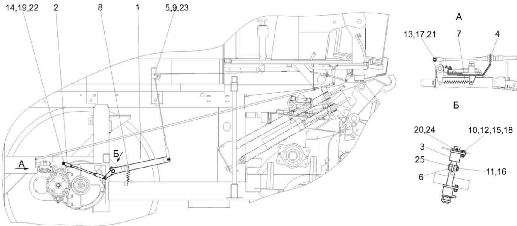
Рисунок 122 – Установка приводов стояночного тормоза и блокировки КГС 0119530
