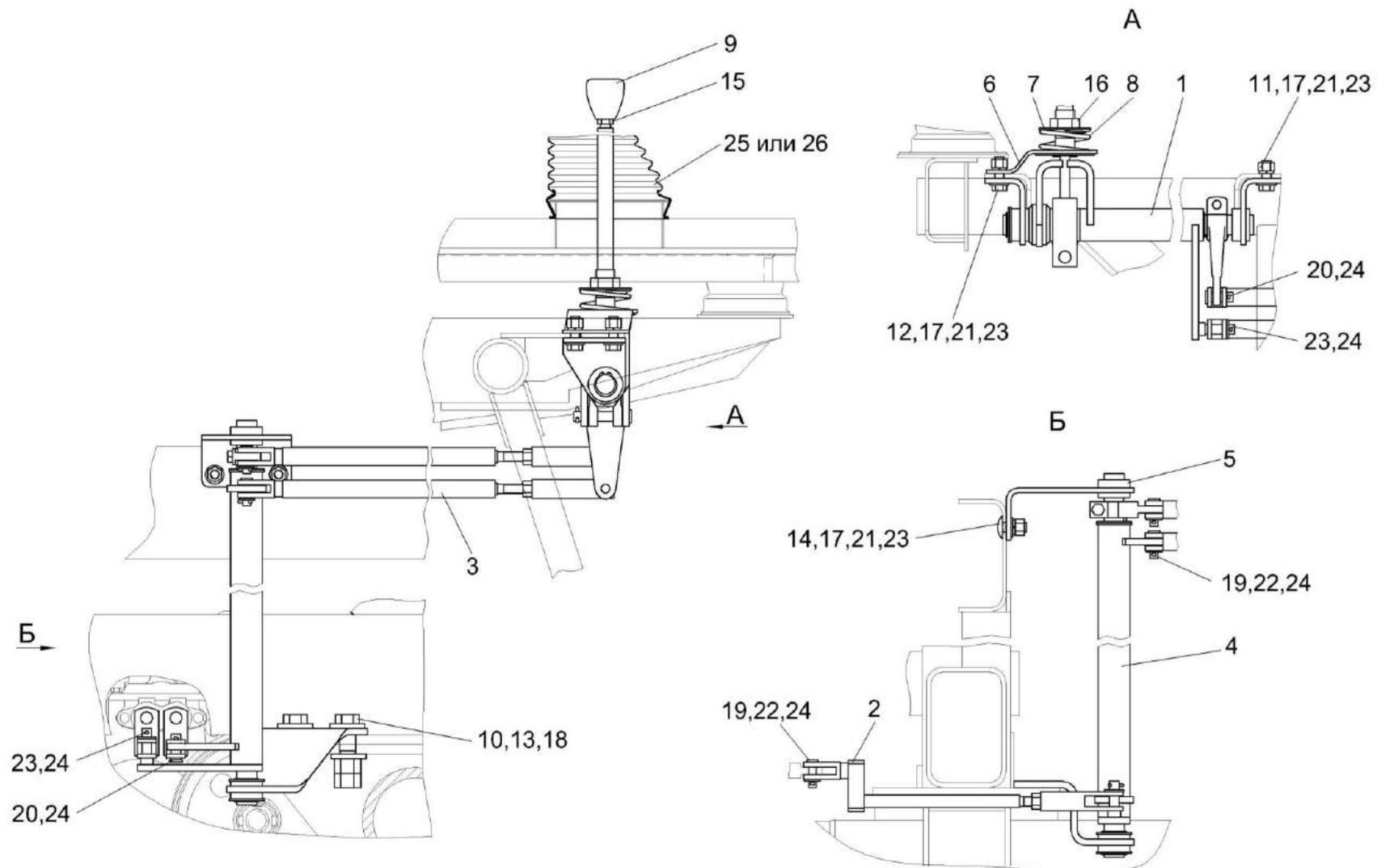
Рисунок 120 – Установка механизма управления коробкой передач КГС 0119030
