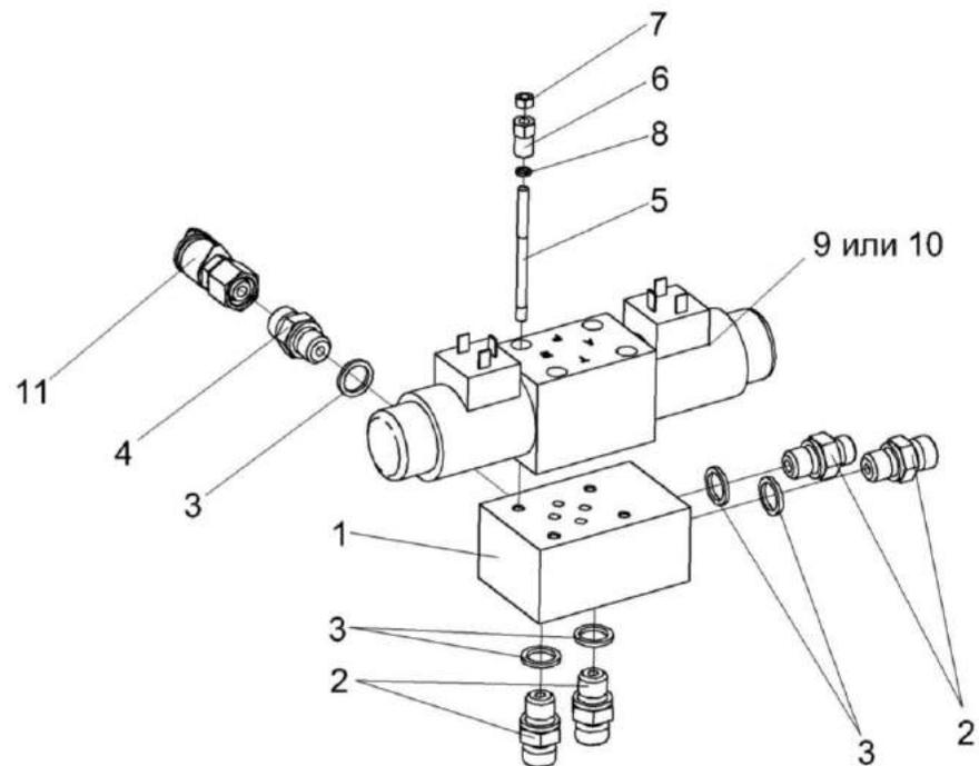
Рисунок 147 – Гидроблок управления КГС 0115120А
