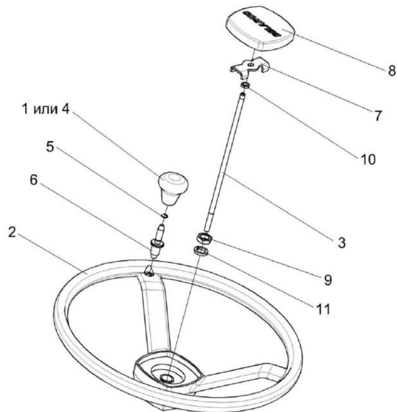
Рисунок 115 – Установка колеса рулевого КЗК-12-0122600-01
