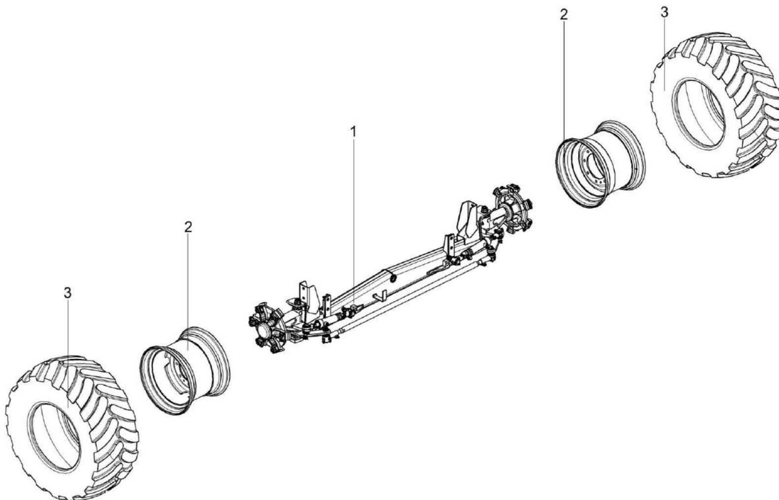
Рисунок 80 – Установка колес КГС 0110000 и КГС 0110000-01
