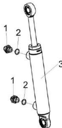
Рисунок 60 – Гидроцилиндр КЗК-12-0602310
