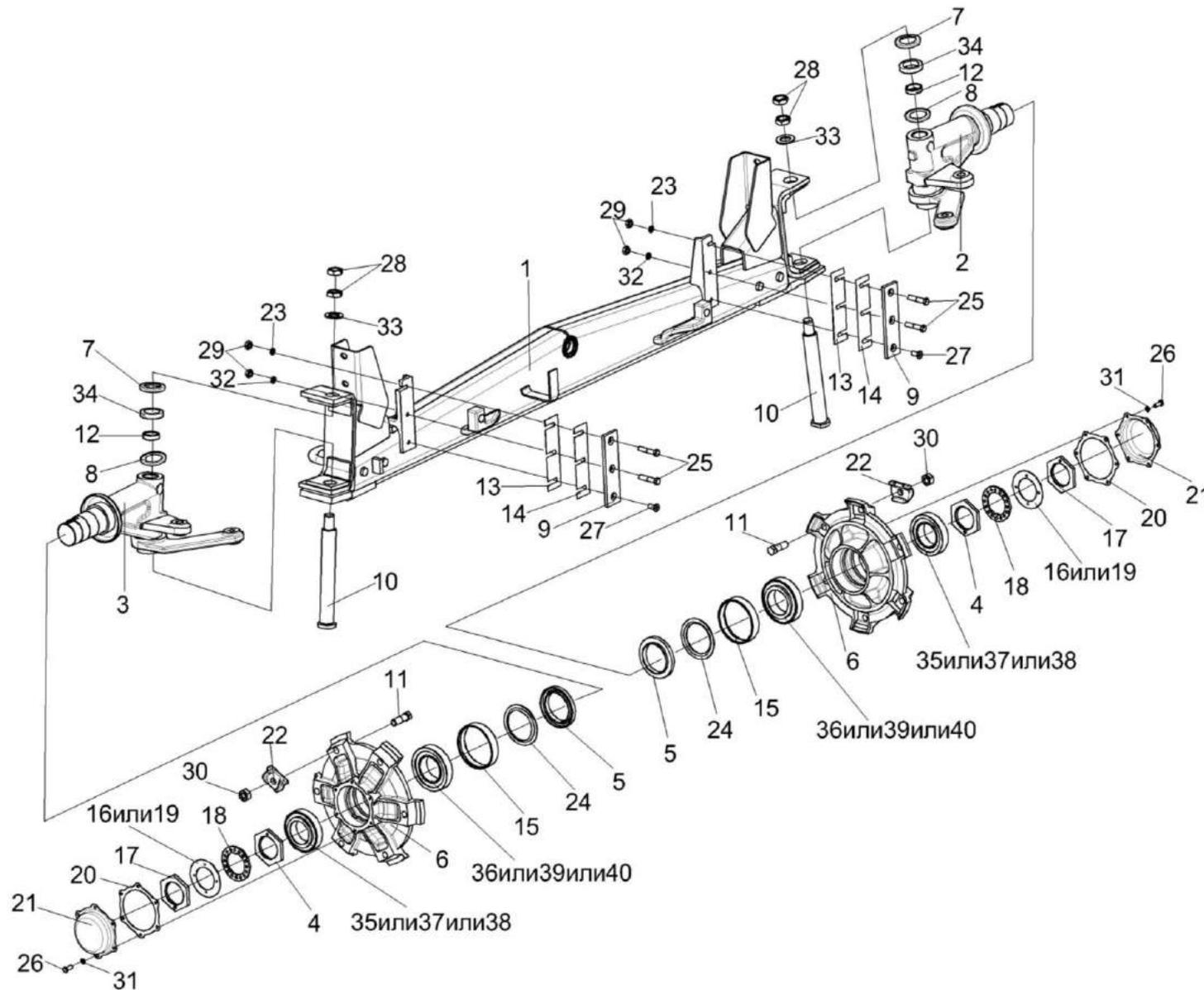
Рисунок 81 – Мост управляемых колес КГС 0109000 (установка ступиц)
