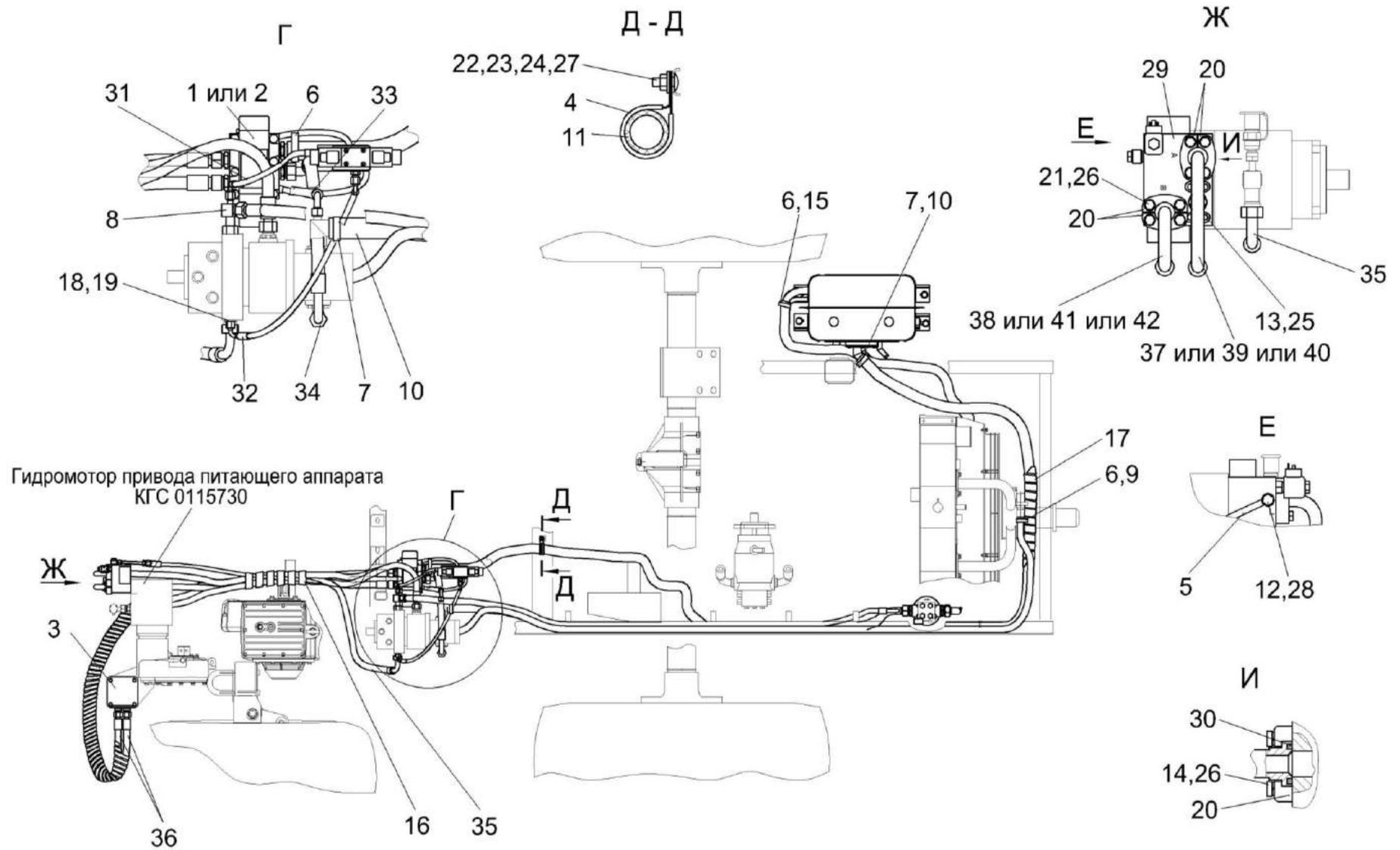
Рисунок 144 – Гидросистема привода питающего аппарата и адаптеров КГС-1-0115000 (вид сверху)
