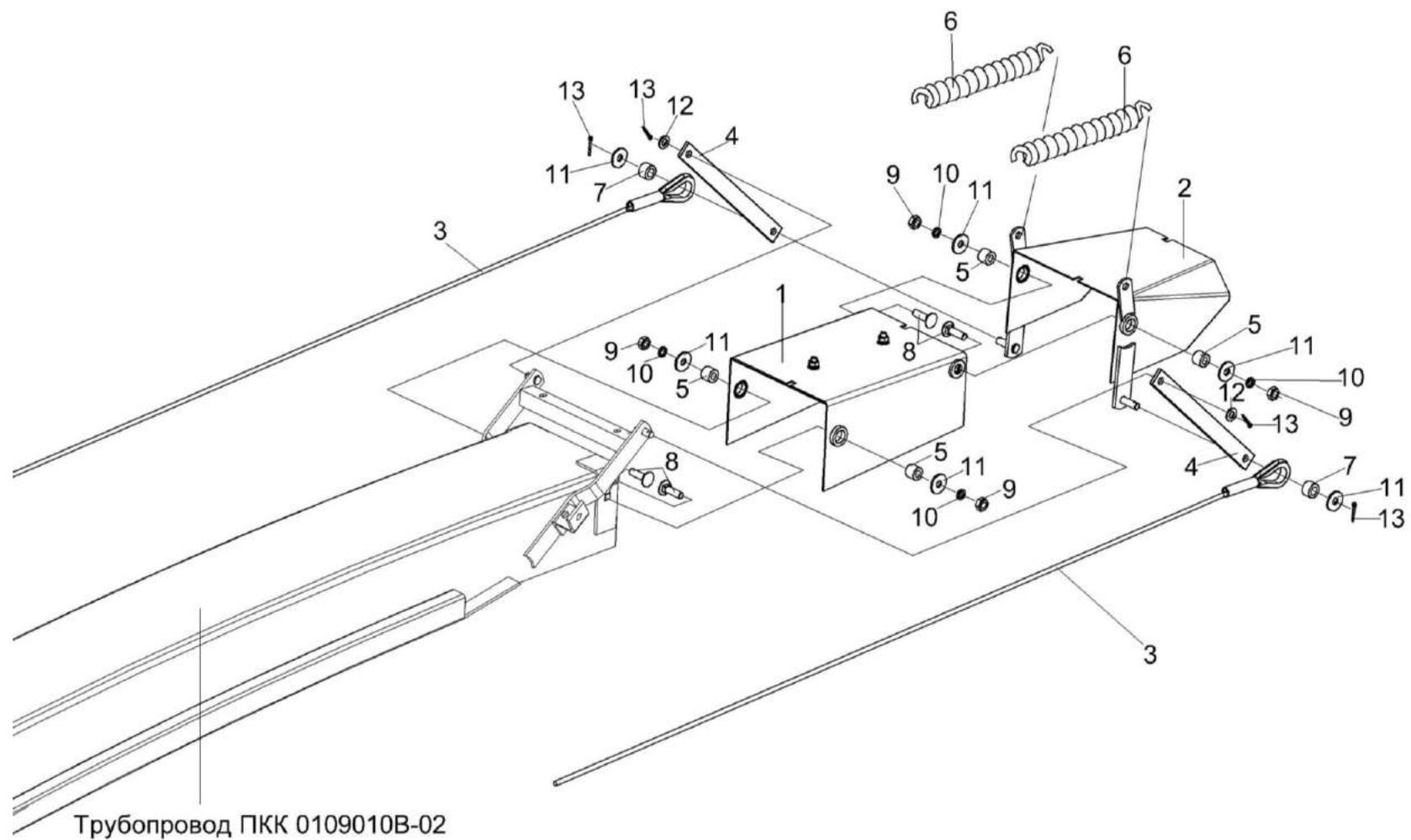
Рисунок 30 – Силосопровод ПКК 0109000В-03 (установка козырьков)
