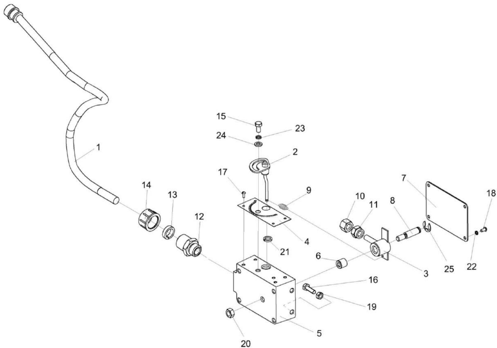
Рисунок 24 – Датчик камнедетектора КВС-1-0111440А
