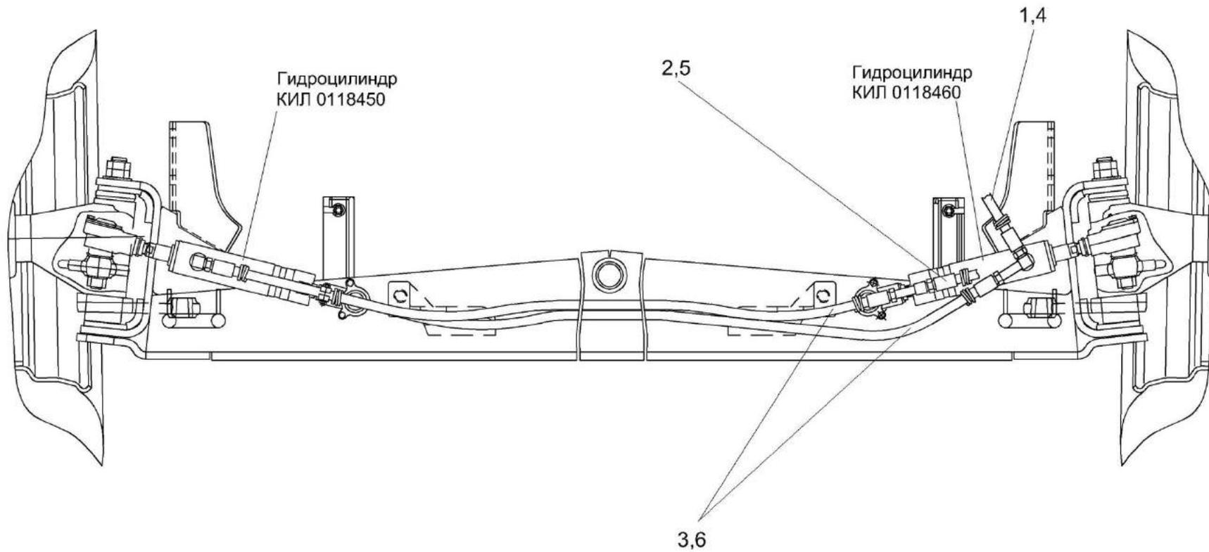
Рисунок 154 – Гидросистема рабочих органов и рулевого управления КГС-4-0125000
