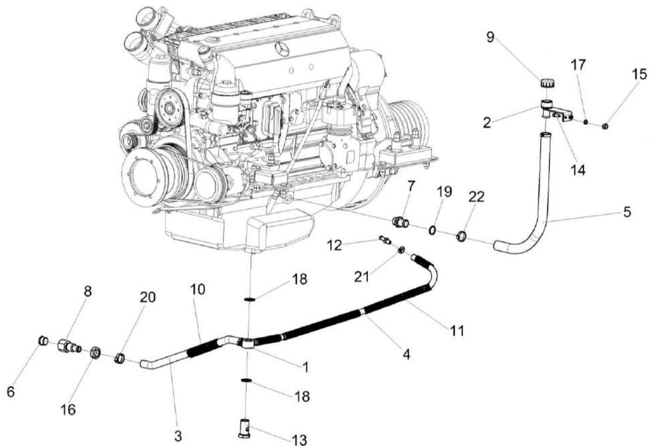
Рисунок 49 – Маслопровод сливной КГС-1-0116270 и установка системы заправки двигателя КГС-1-0116490
