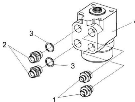
Рисунок 111 – Насос-дозатор КЗК-8-0602160-01
