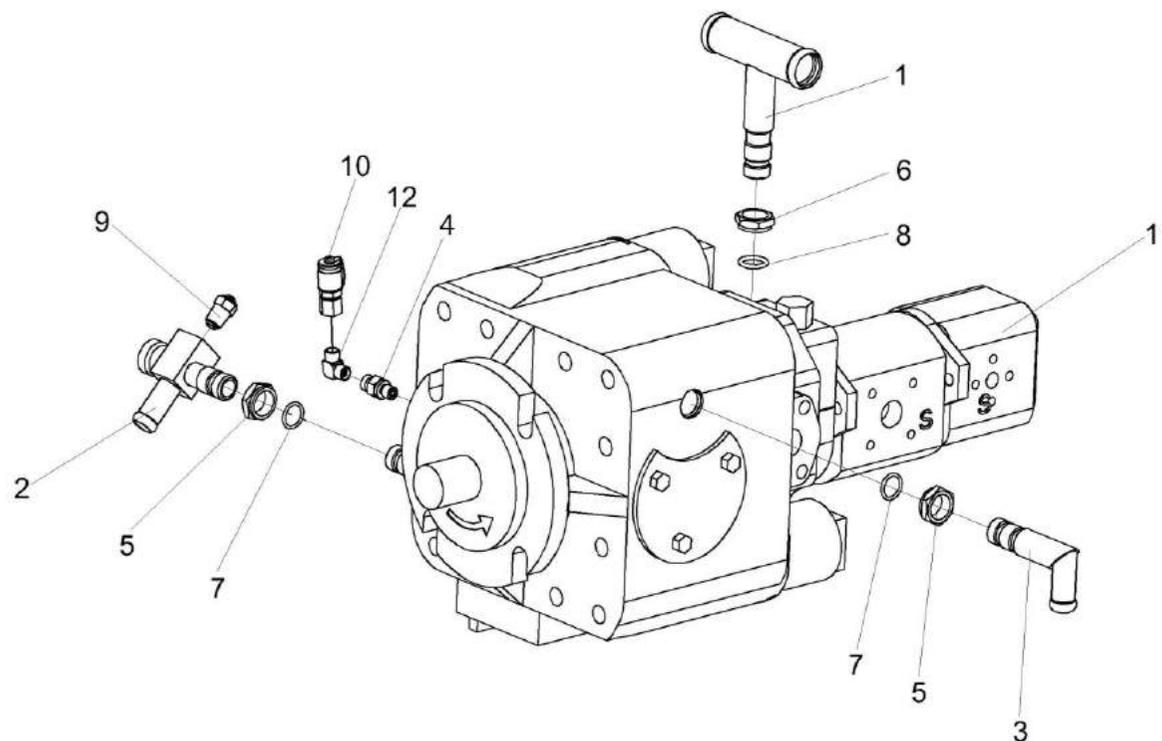
Рисунок 141 – Гидронасос трехсекционный КГС-4-0108010
