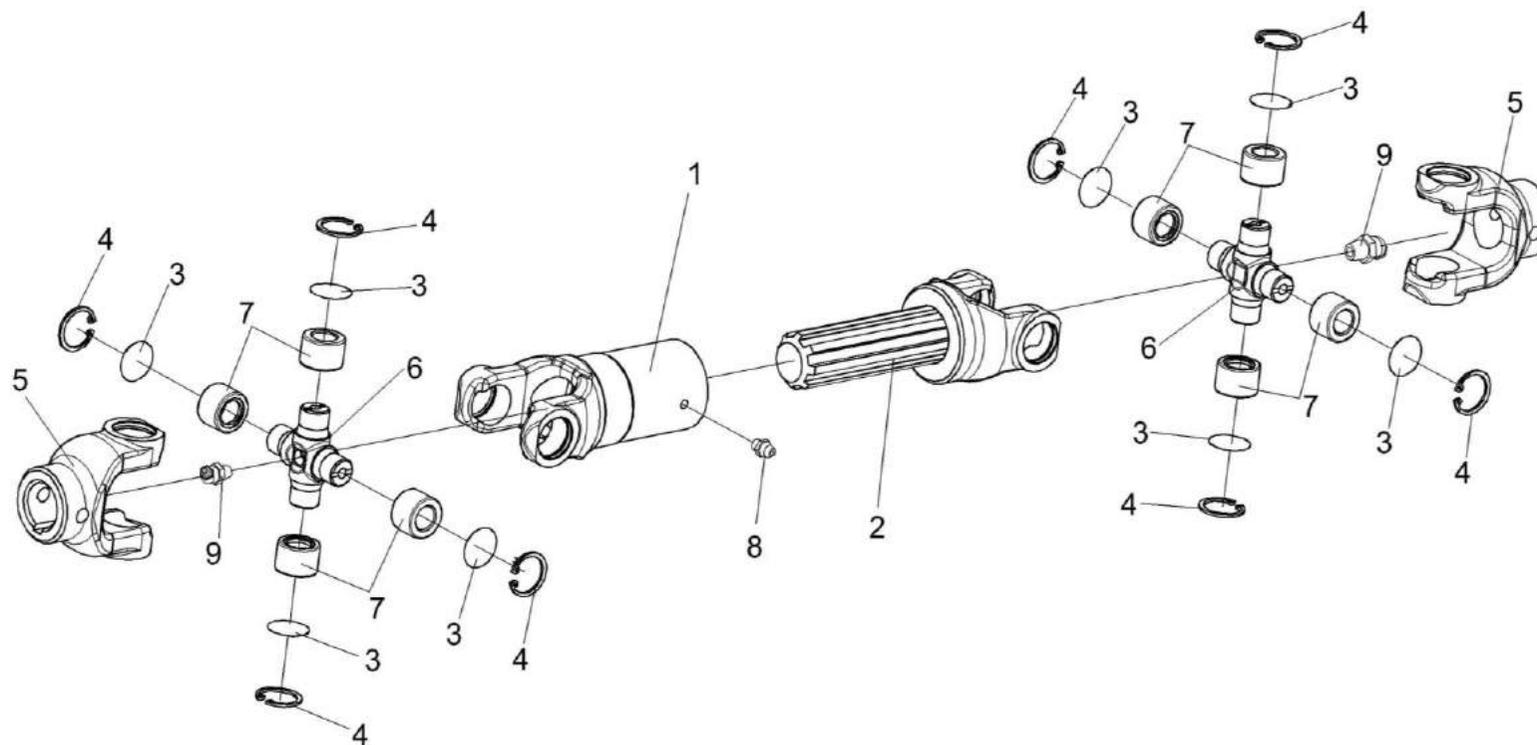
Рисунок 66 – Вал карданный телескопический КГС 0112200
