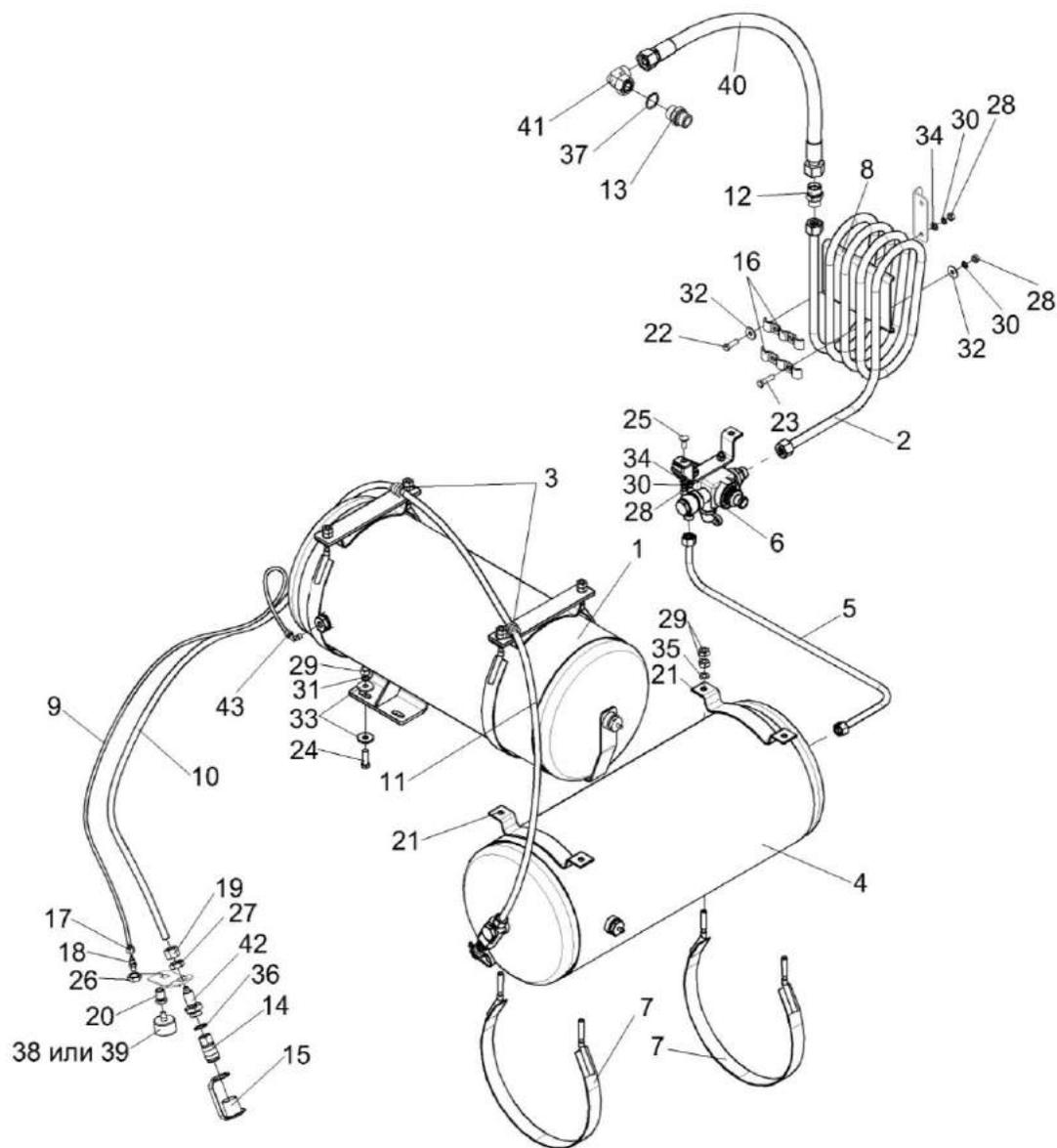
Рисунок 161 – Пневмосистема КГС-1-0180000
