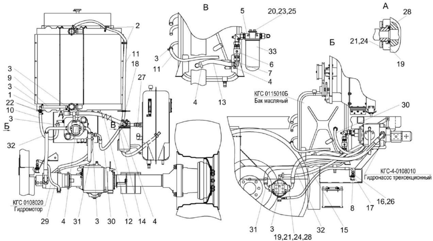
Рисунок 137 – Гидросистема привода ходовой части КГС-4-0108000
