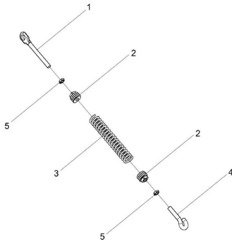
Рисунок 44 – Пружина КГС-1-0116750
