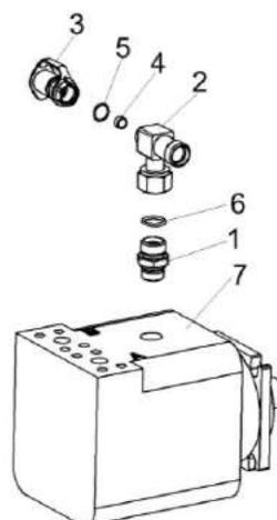
Рисунок 68 – Гидромотор привода питающего аппарата КГС 0115730
