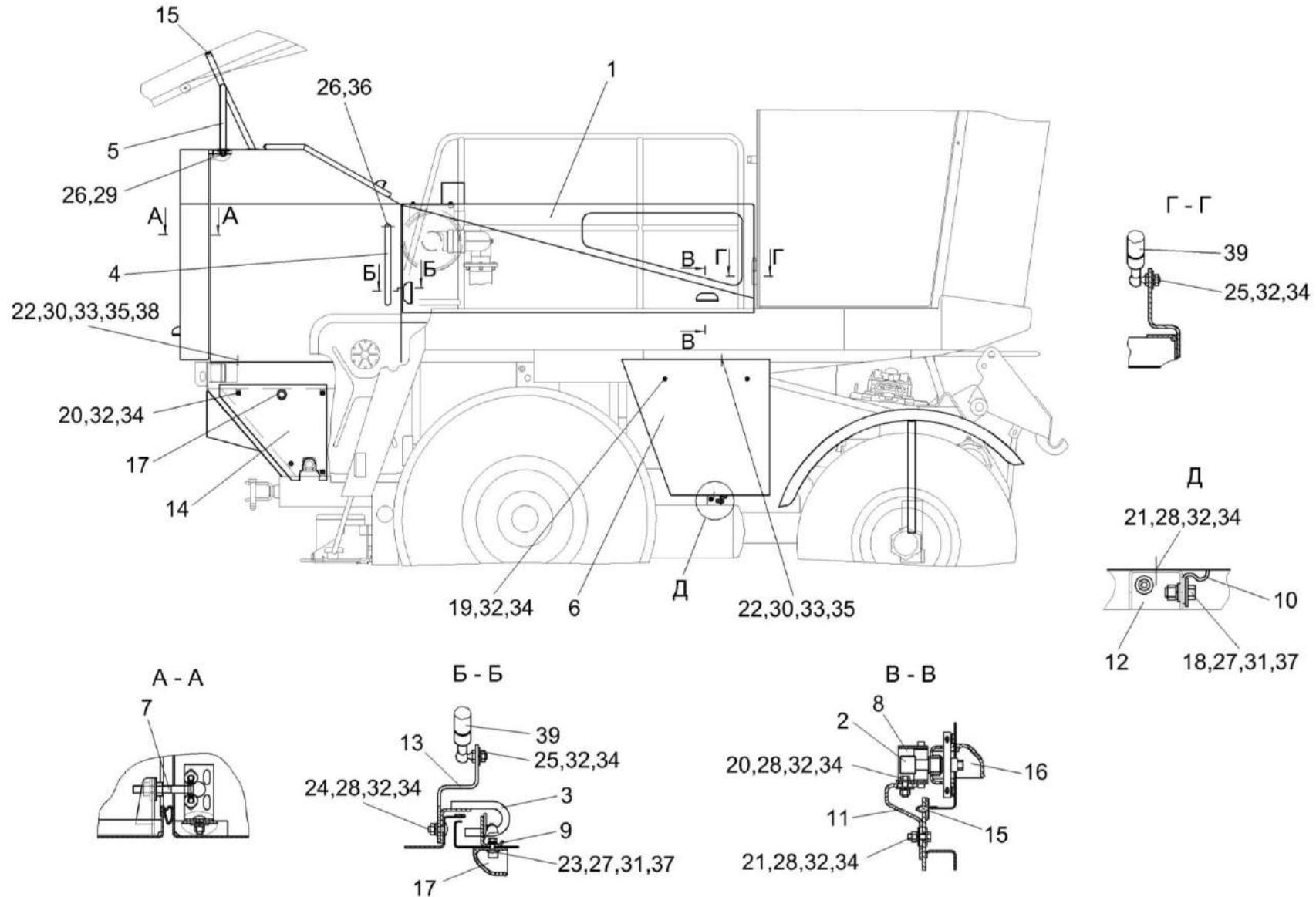
Рисунок 127 – Установка капотов КГС 0128000-02 (вид справа)
