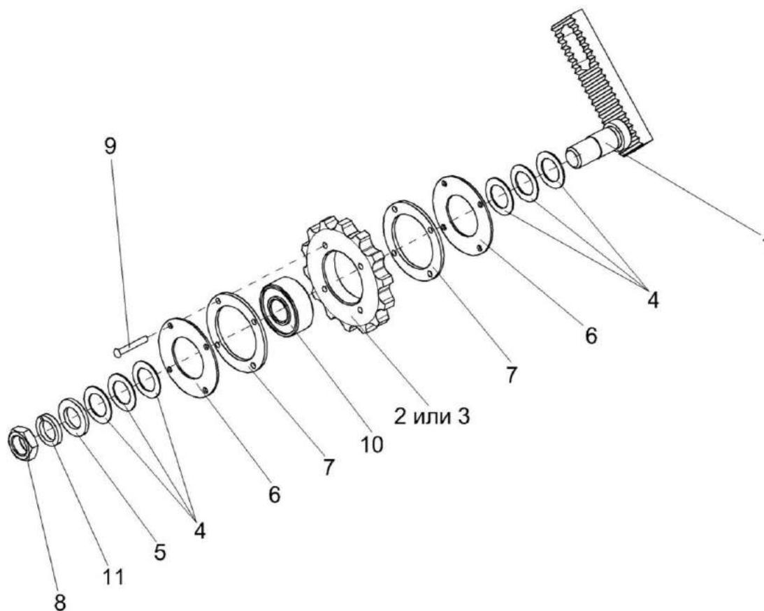
Рисунок 25 – Устройство натяжное КИС 0103470
