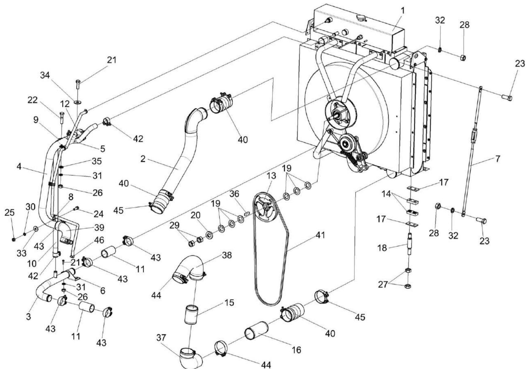
Рисунок 41 – Установка радиатора КГС-10-0116040
