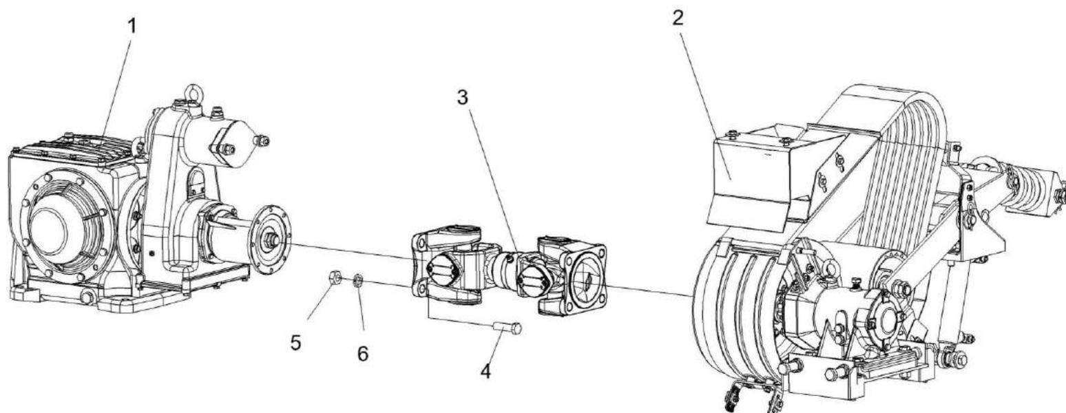
Рисунок 52 – Установка вала карданного КИЛ 0113070
