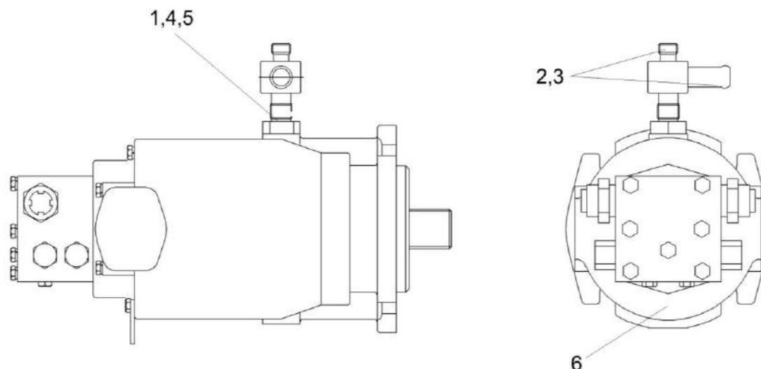
Рисунок 142 – Гидромотор КГС 0108030
