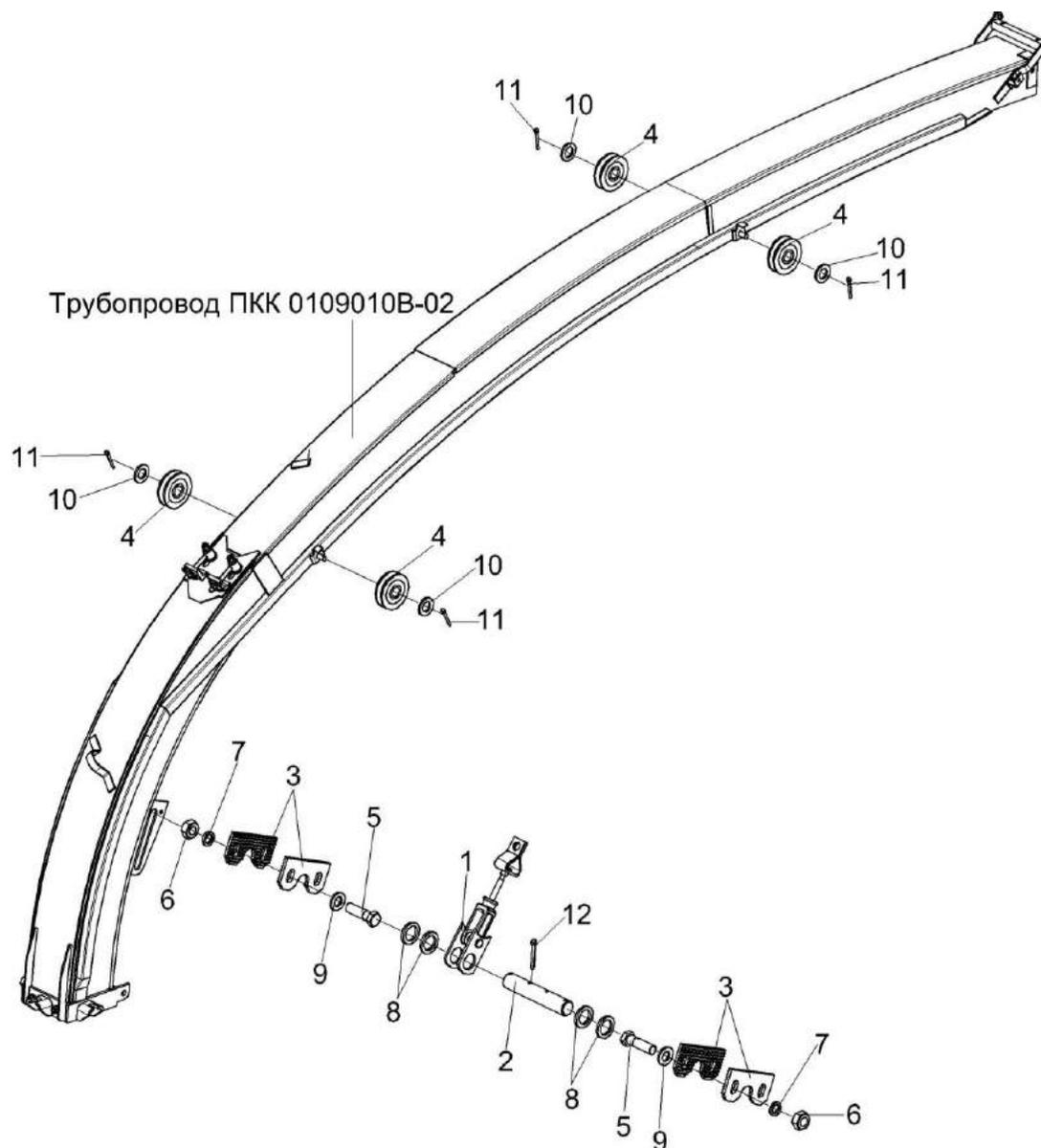
Рисунок 31 – Силосопровод ПКК 0109000В-03 (установка устройства натяжного)
