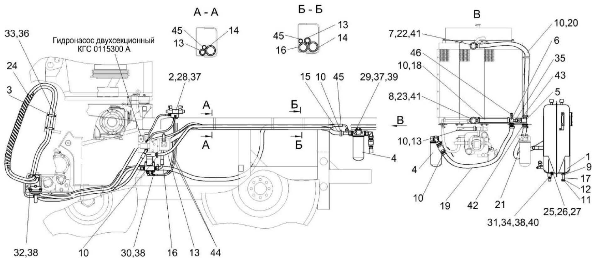
Рисунок 143 – Гидросистема привода питающего аппарата и адаптеров КГС-1-0115000 (вид слева)
