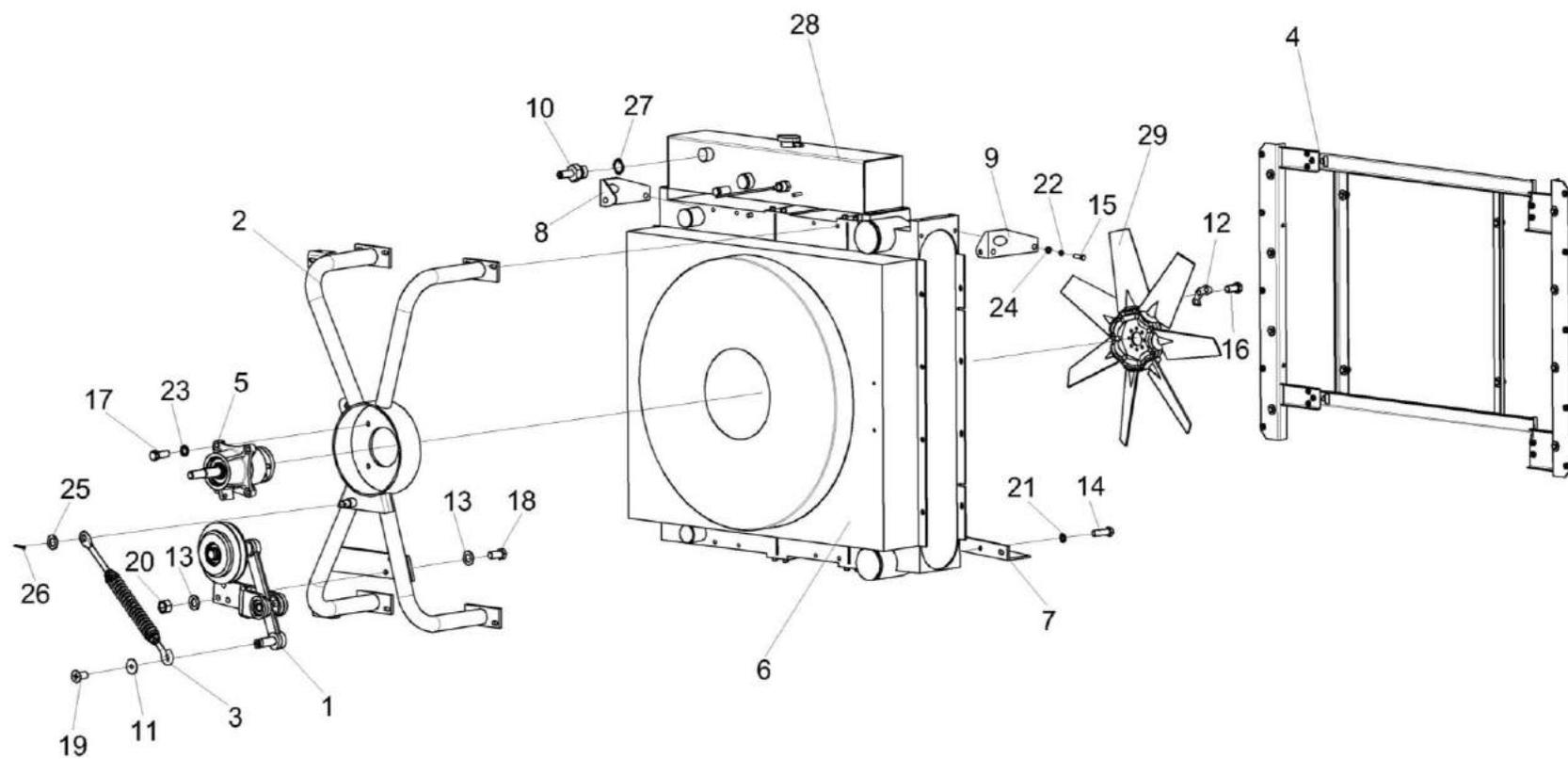
Рисунок 42 – Блок радиаторов КГС-10-0116050
