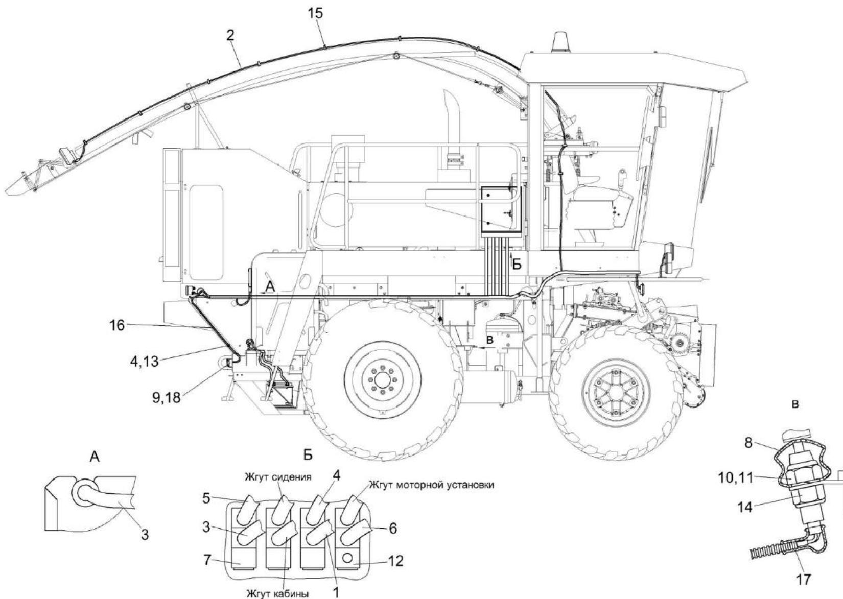
Рисунок 5 – Электрооборудование измельчителя самоходного (вид справа)
