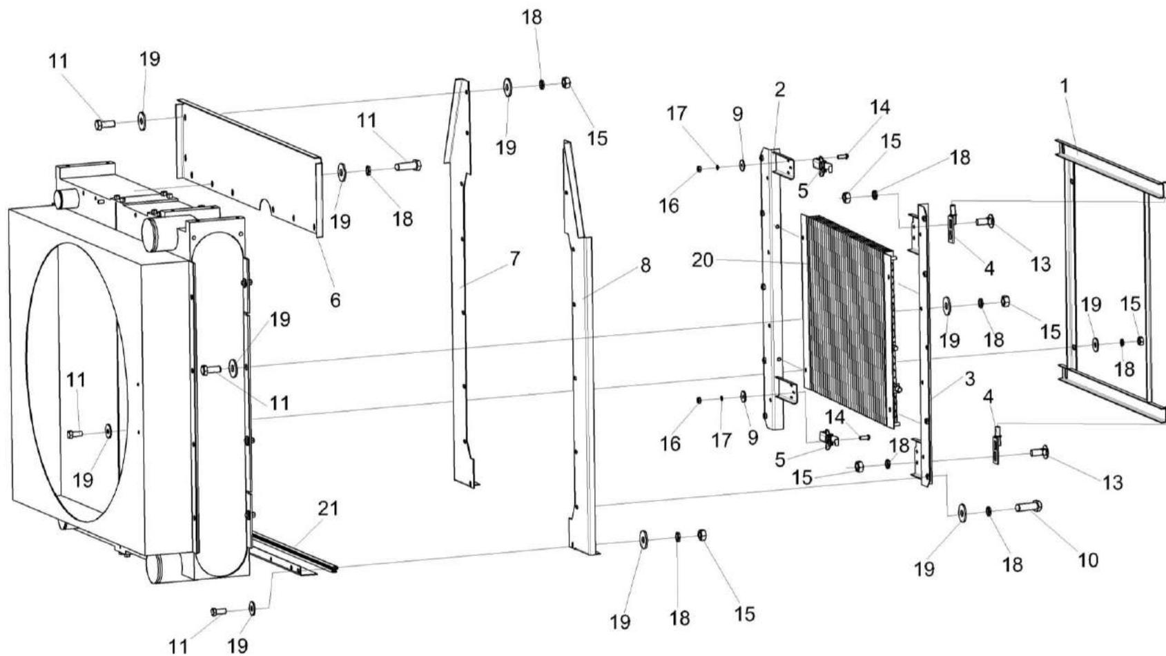
Рисунок 45 – Установка конденсатора КГС-4-0116600
