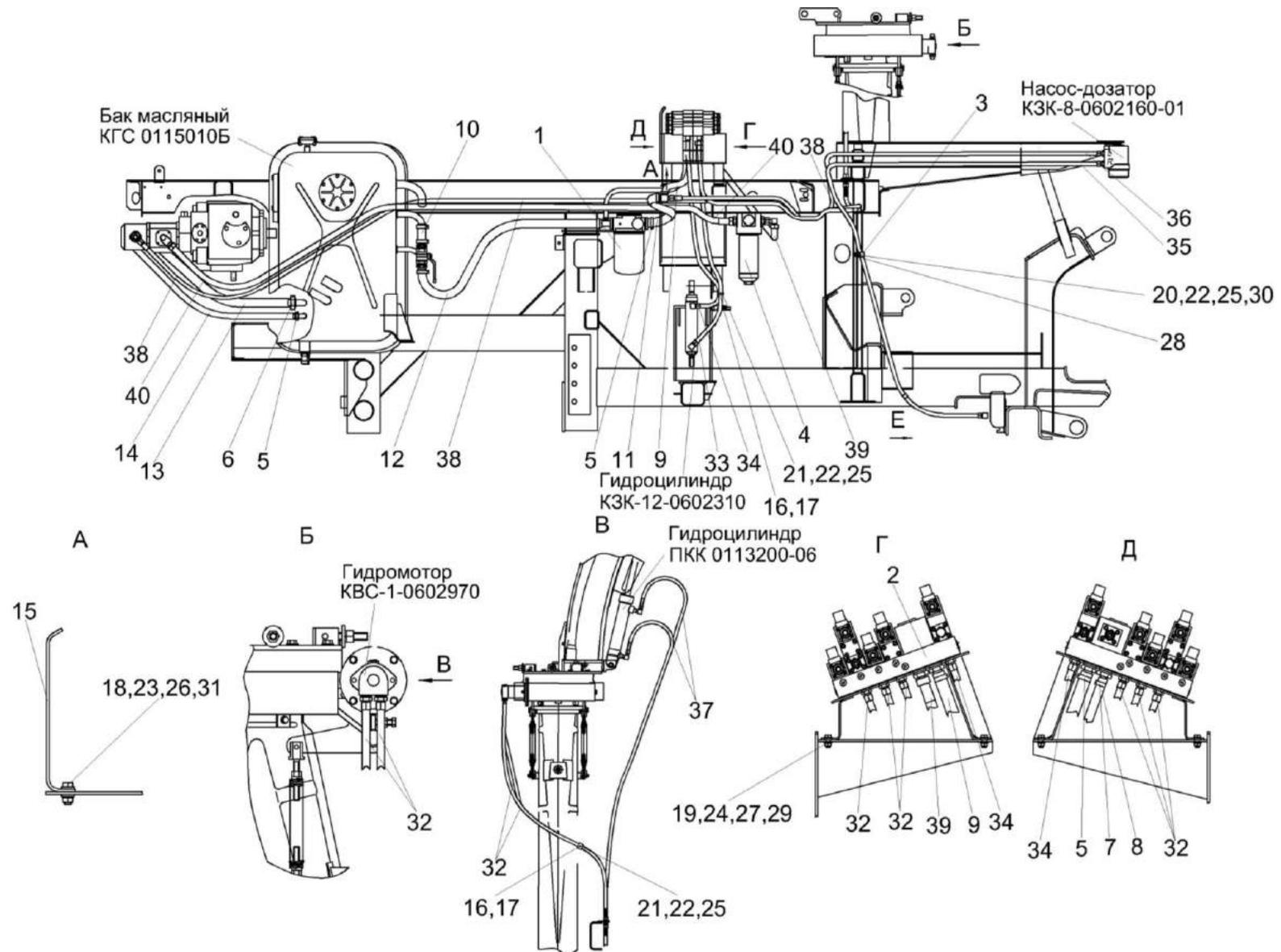
Рисунок 152 – Гидросистема рабочих органов и рулевого управления КГС-4-0125000 (вид справа)
