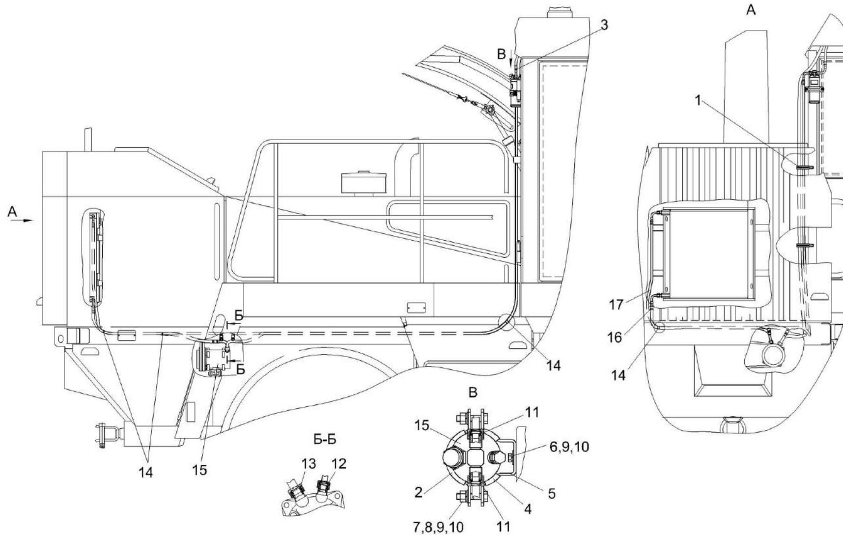
Рисунок 98 – Установка климатическая КГС 0121000
