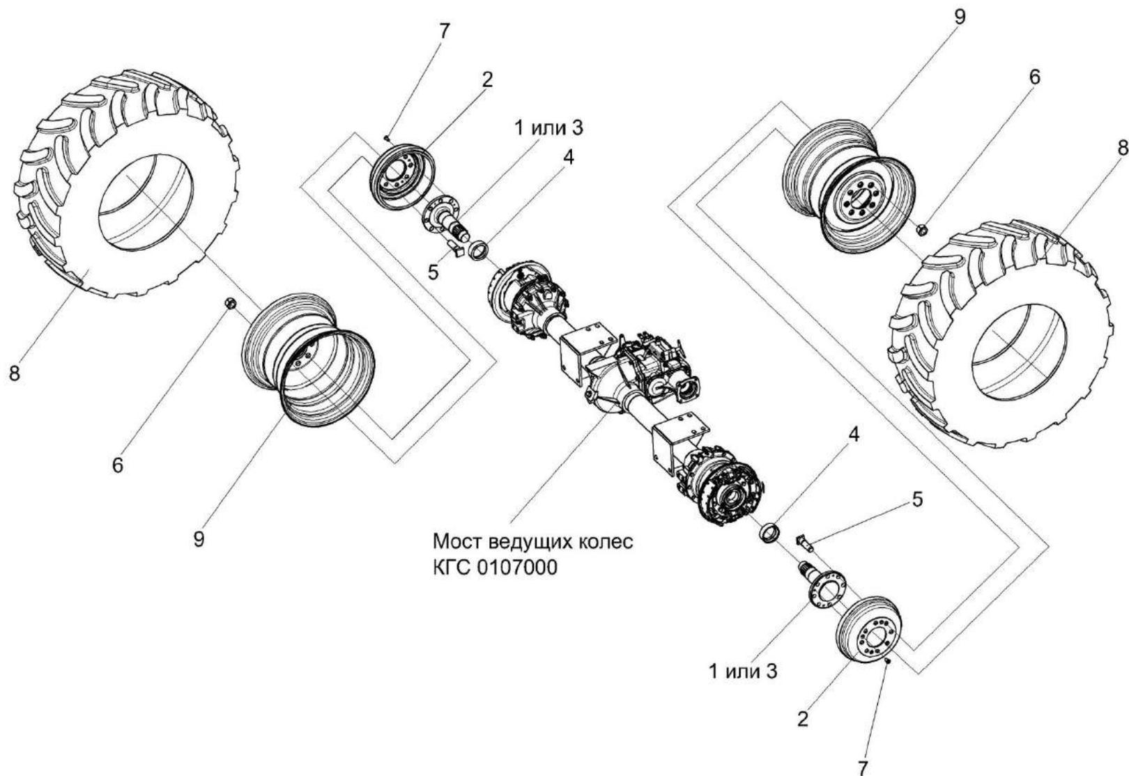
Рисунок 70 – Установка колес 54-4-6 и 54-4-7
