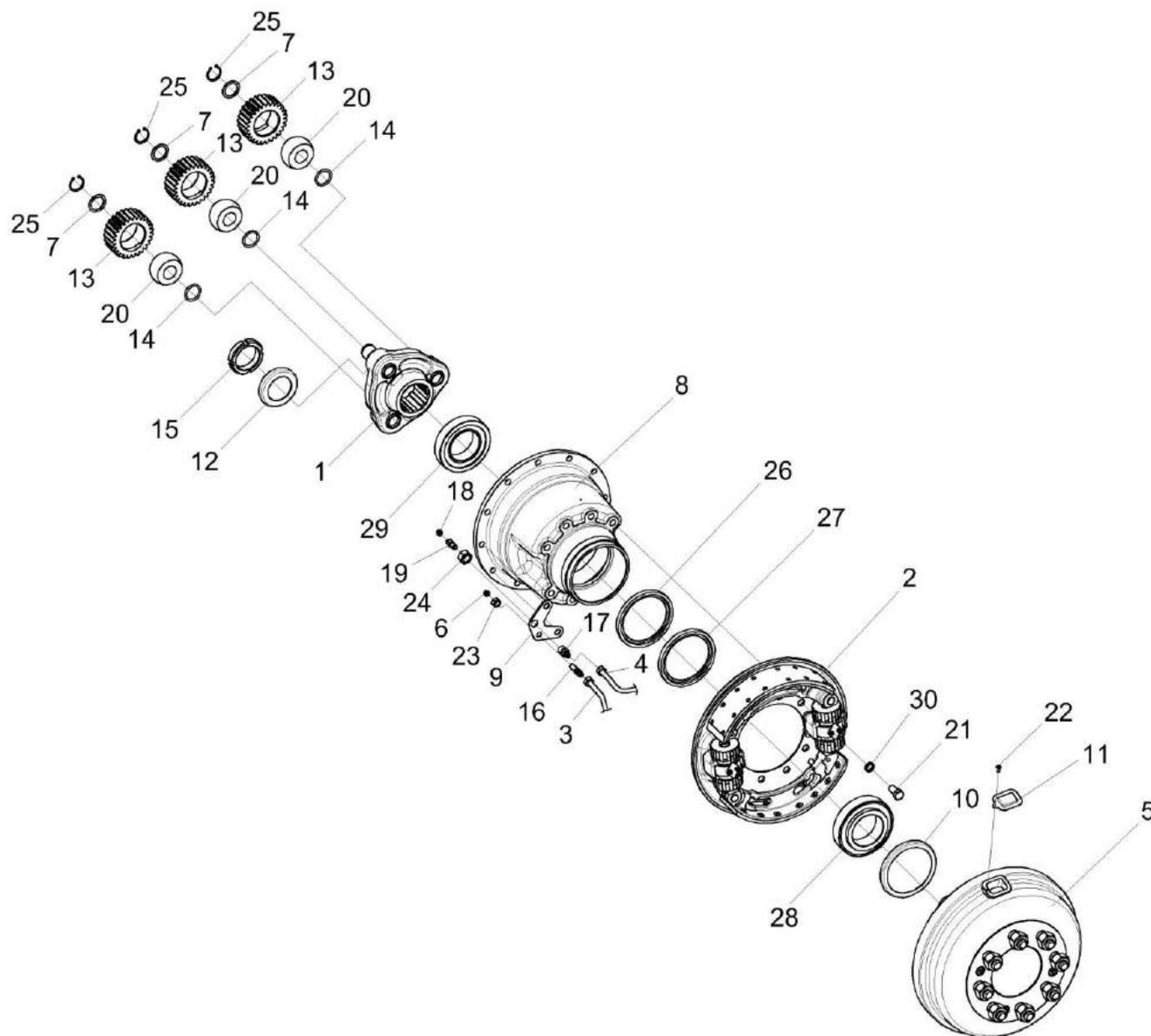
Рисунок 75 – Редуктор бортовой 54-4-3
