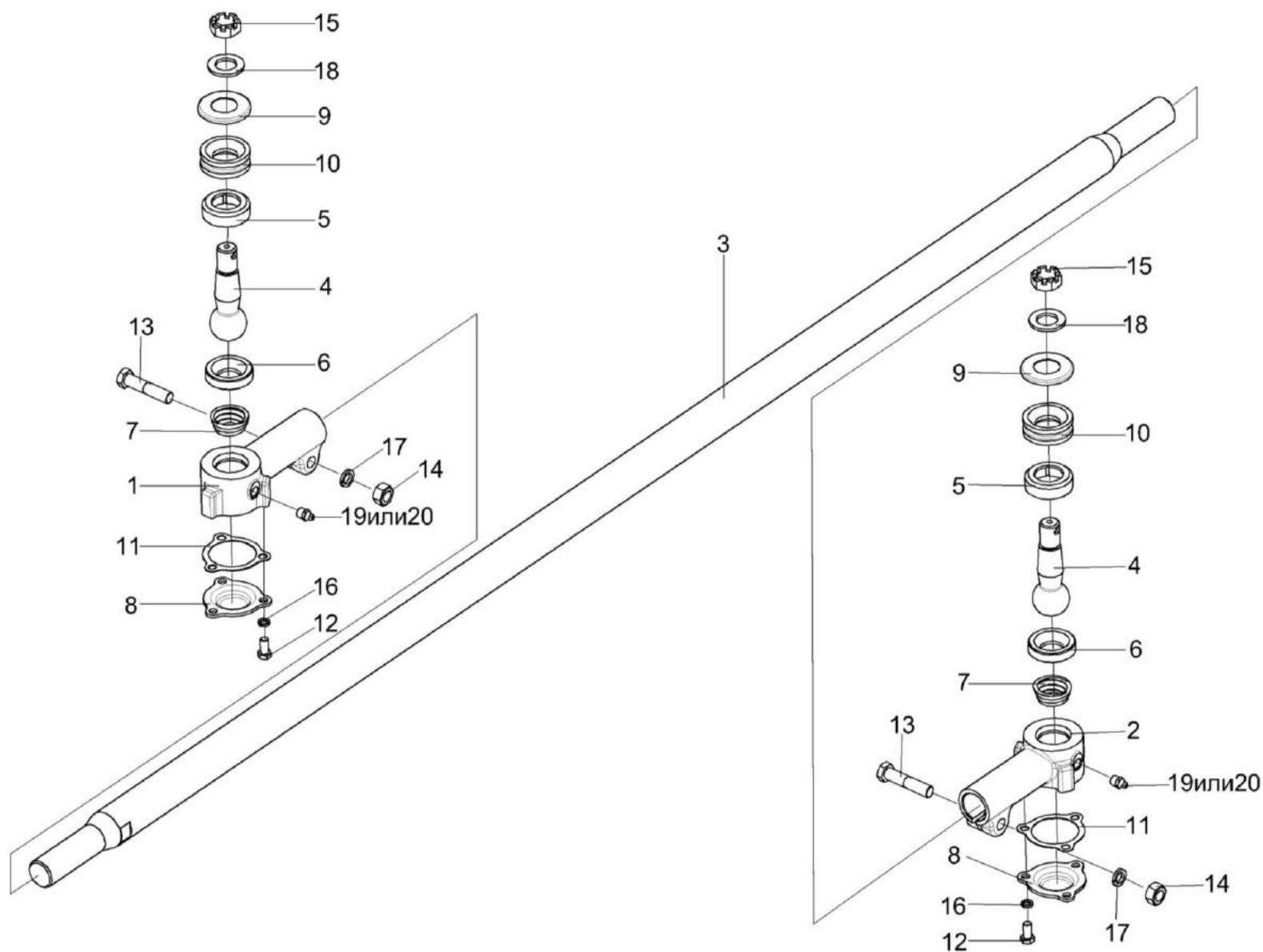
Рисунок 83 – Тяга поперечная КИЛ 0109040
