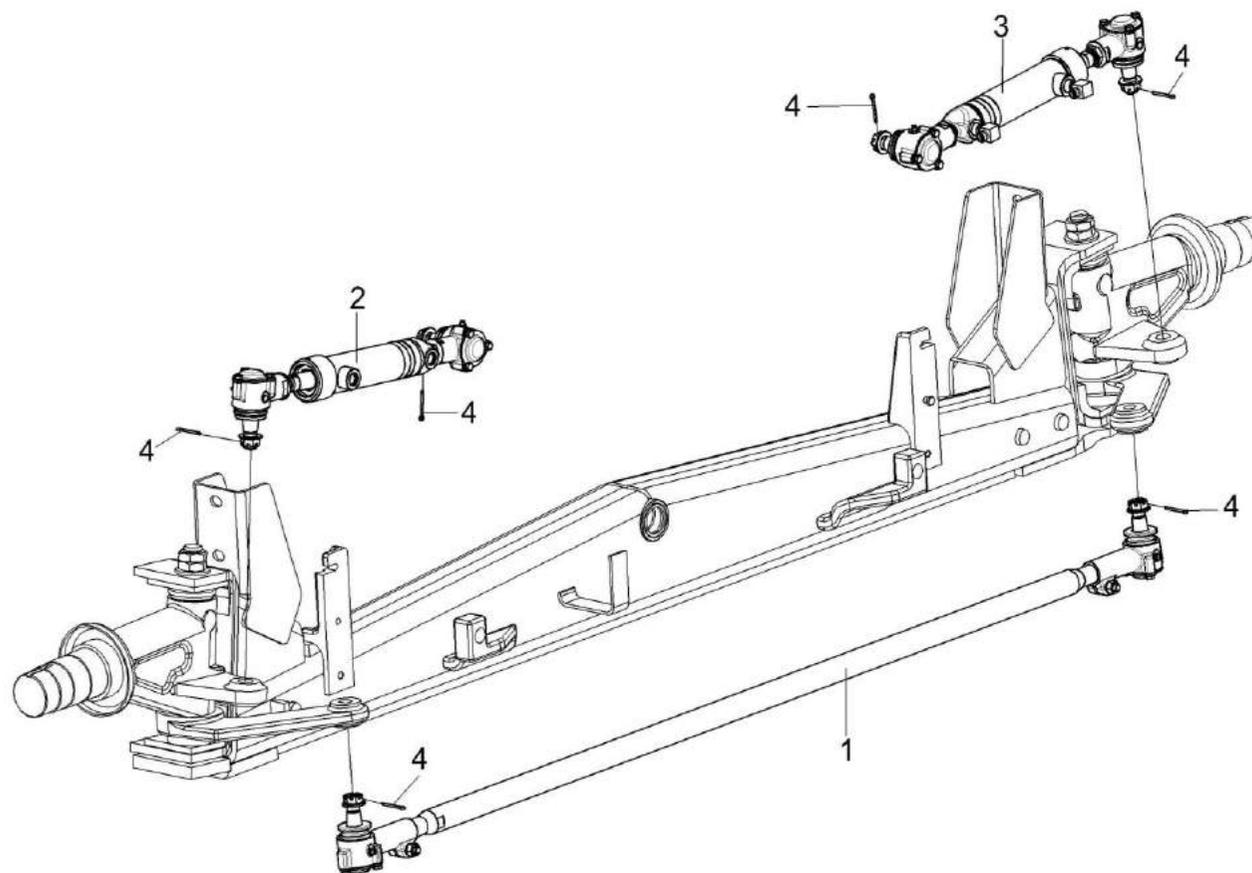
Рисунок 82 – Мост управляемых колес КГС 0109000 (тяга поперечная, гидроцилиндры)
