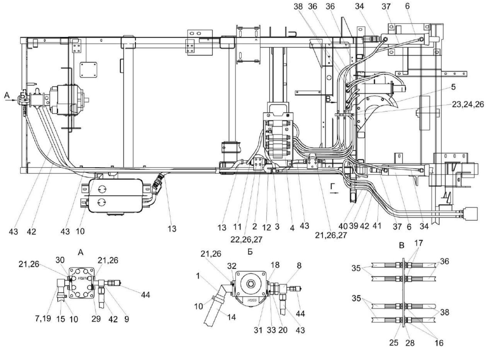
Рисунок 153 – Гидросистема рабочих органов и рулевого управления КГС-4-0125000 (вид сверху)
