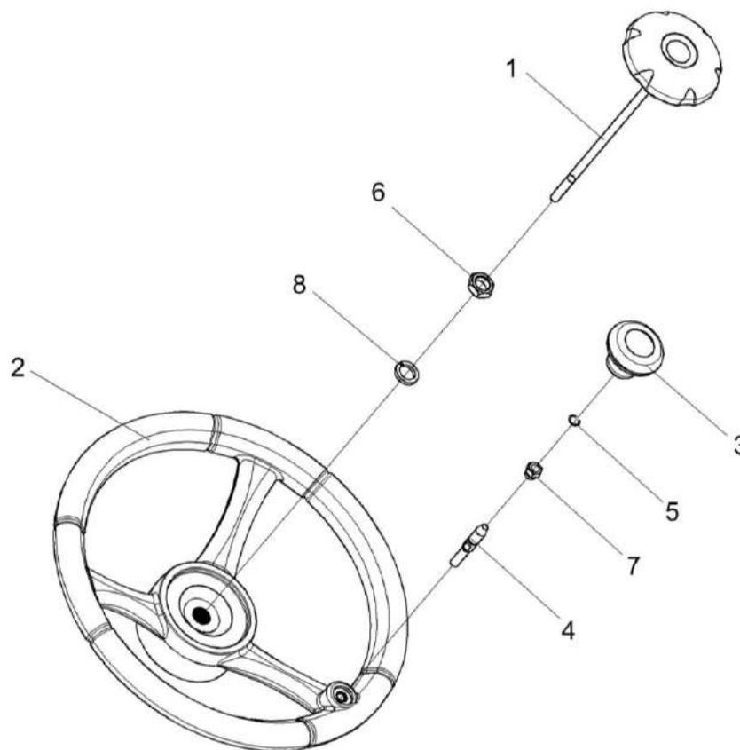
Рисунок 114 – Установка колеса рулевого КЗК-12-0122600
