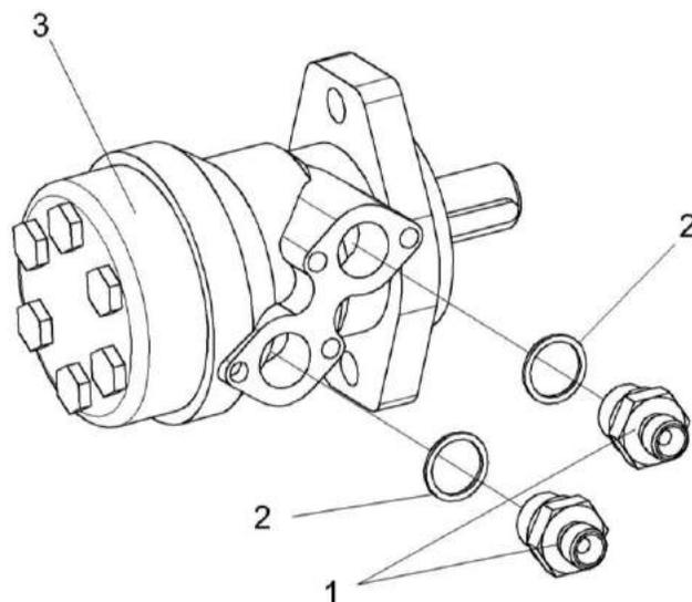
Рисунок 28 – Гидромотор силосопровода КВС-1-0602970
