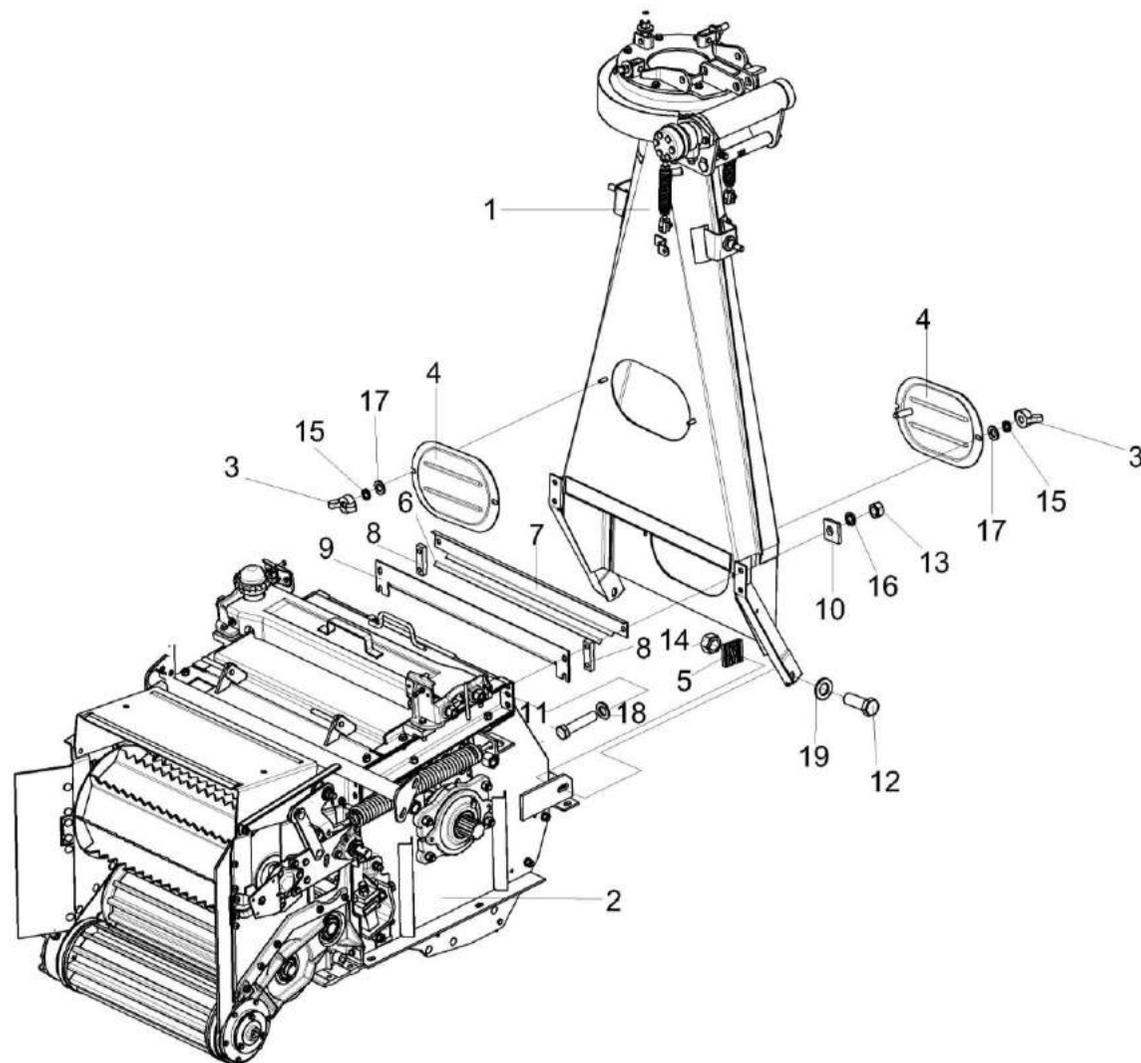
Рисунок 9 – Аппарат питающе-измельчающий КГС 0150000-02
