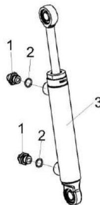
Рисунок 160 – Гидроцилиндр навески КГС 0125500
