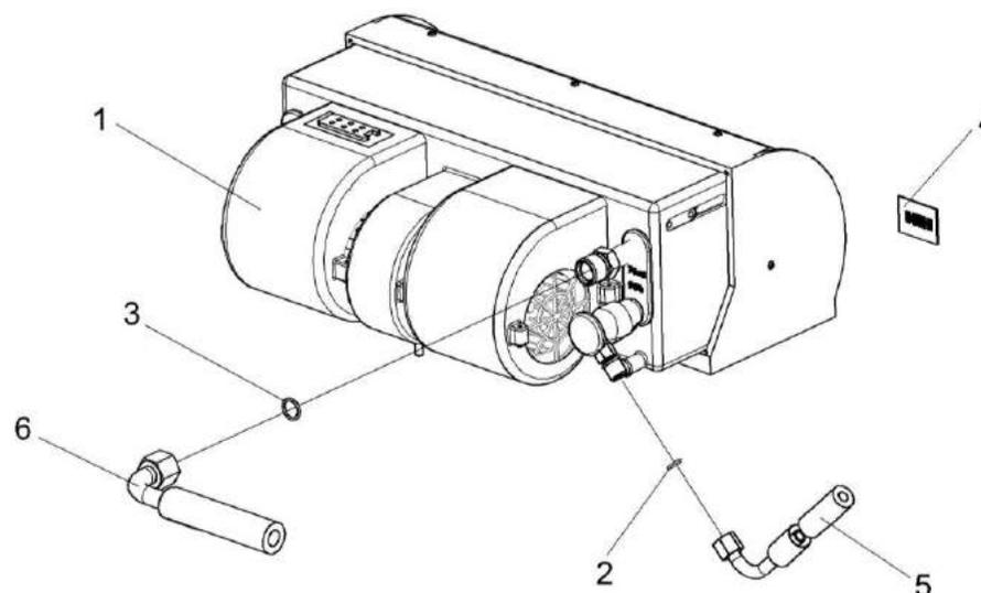
Рисунок 94 – Блок испарительный КГС 0120710
