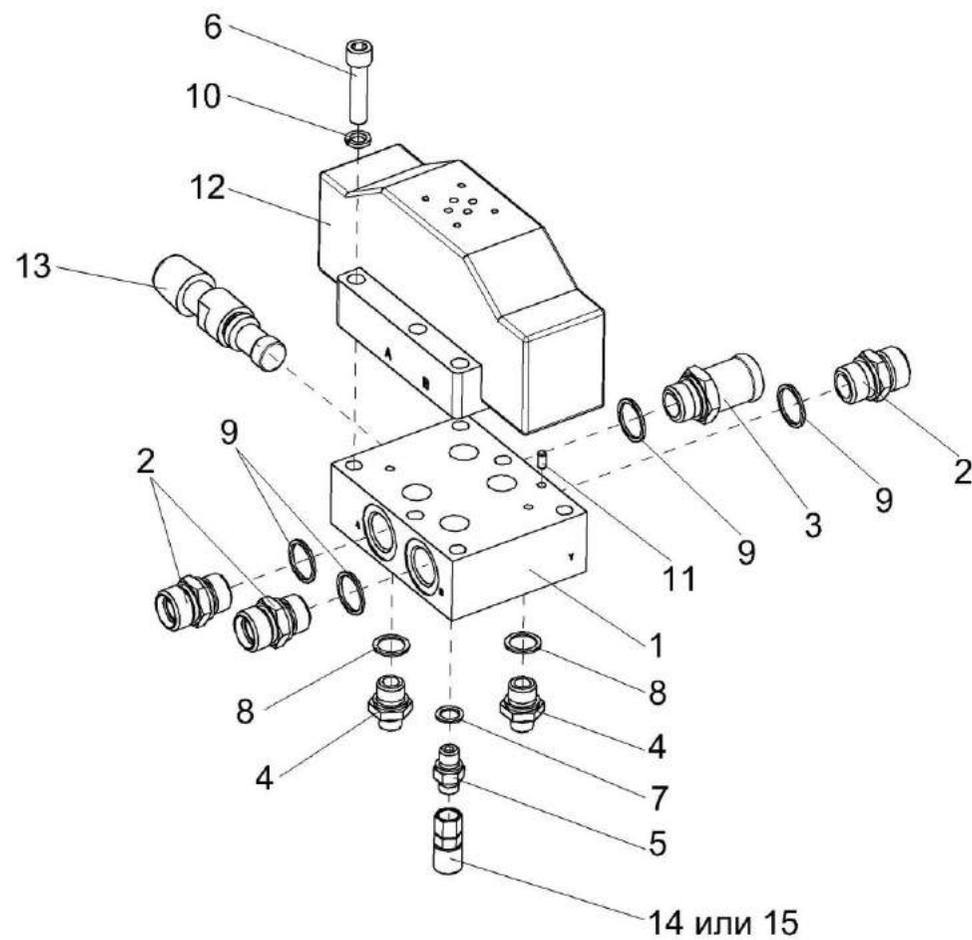
Рисунок 146 – Гидроблок адаптеров КГС 0115110
