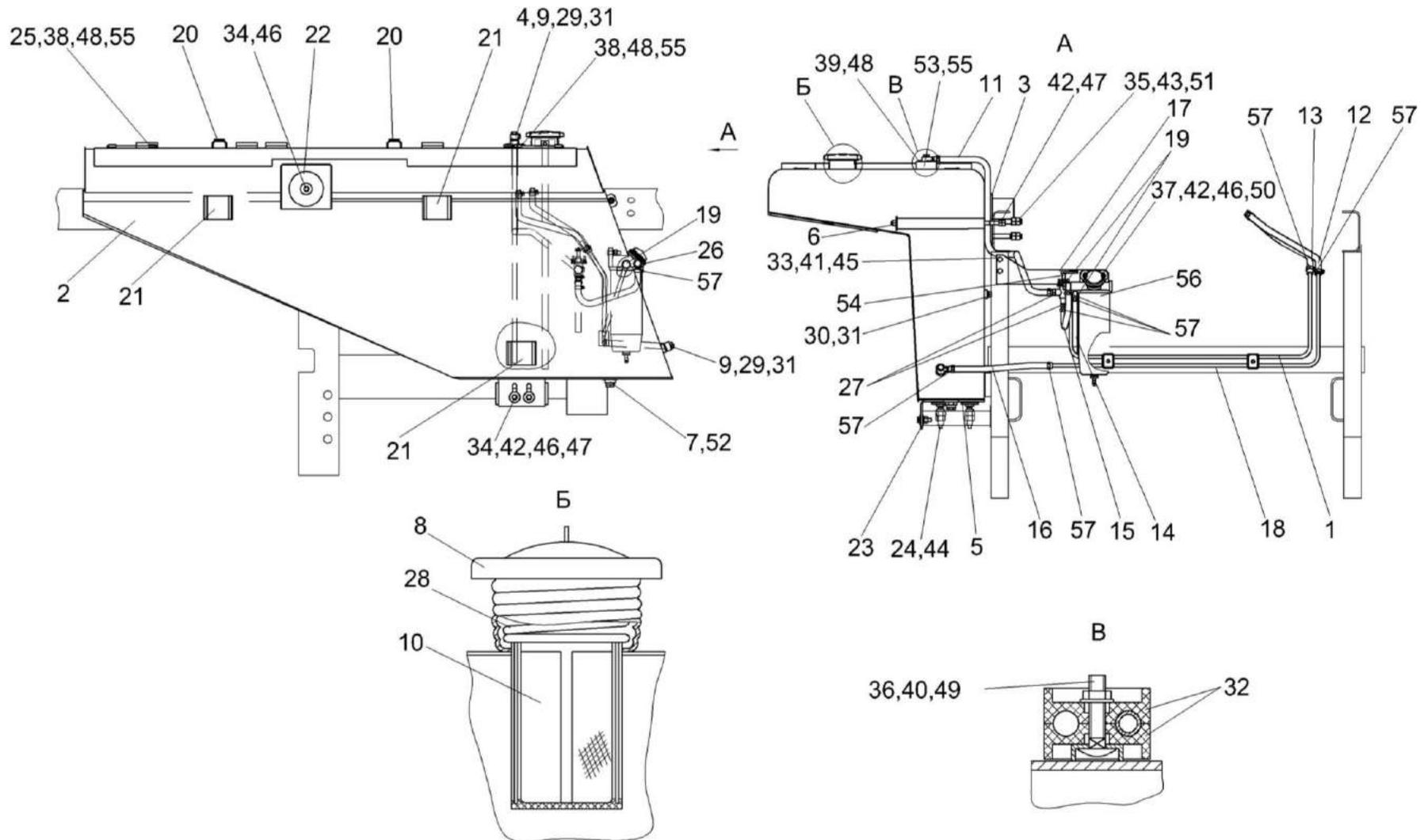
Рисунок 136 – Установка топливного оборудования КГС-1-0123000
