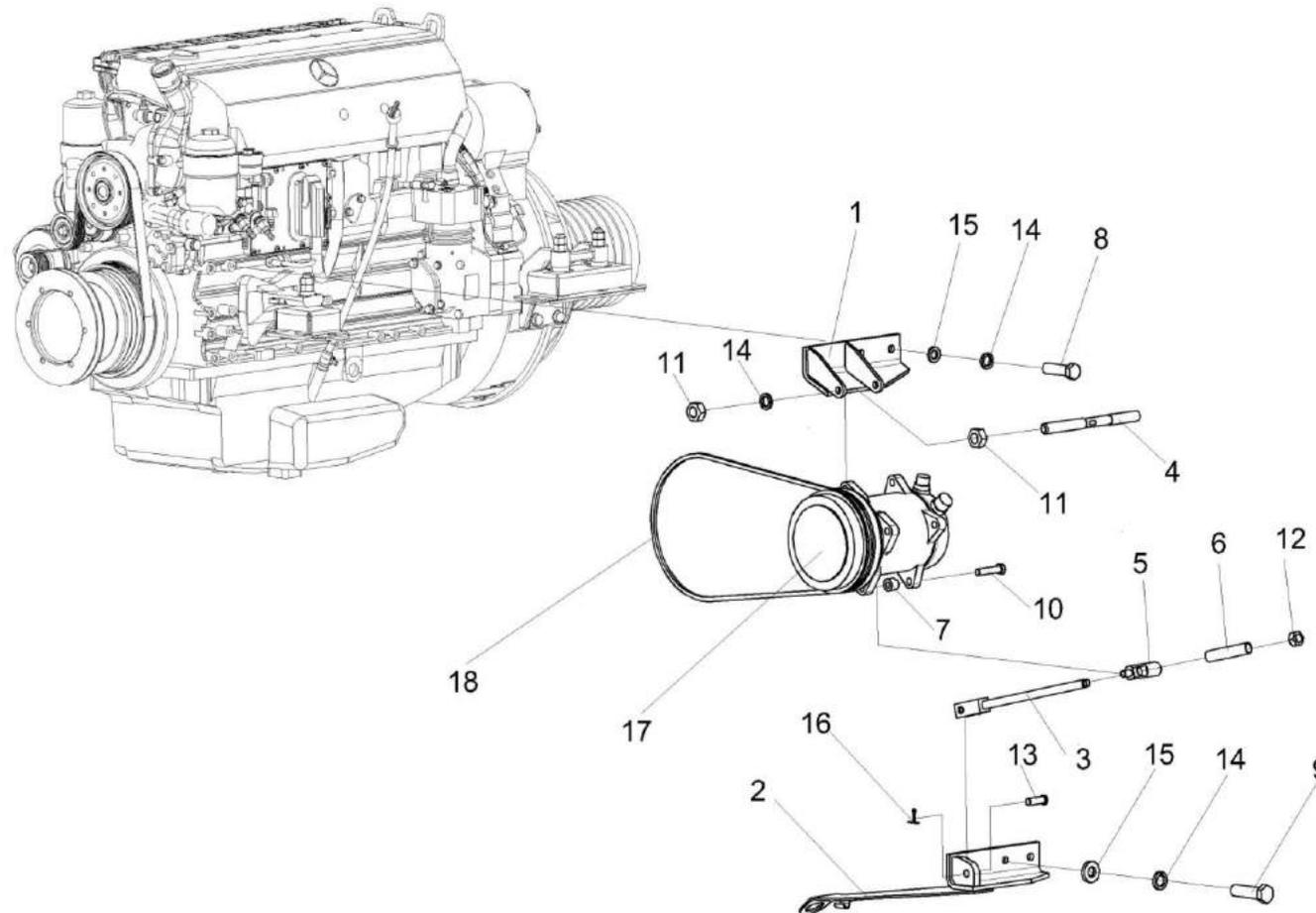
Рисунок 40 – Установка компрессора КГС-1-0116700
