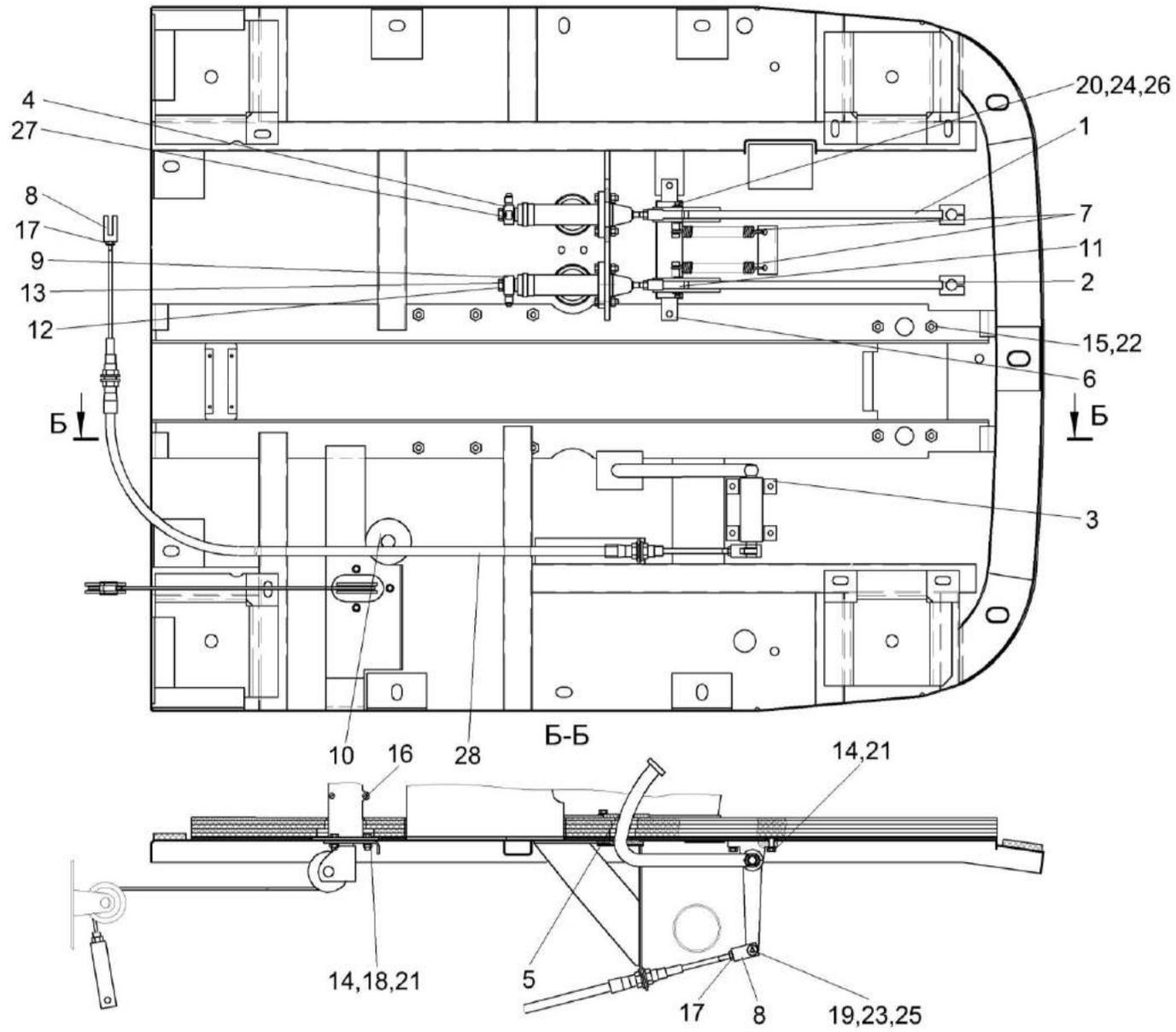
Рисунок 101 – Площадка управления КГС-1-0119000 (вид снизу)
