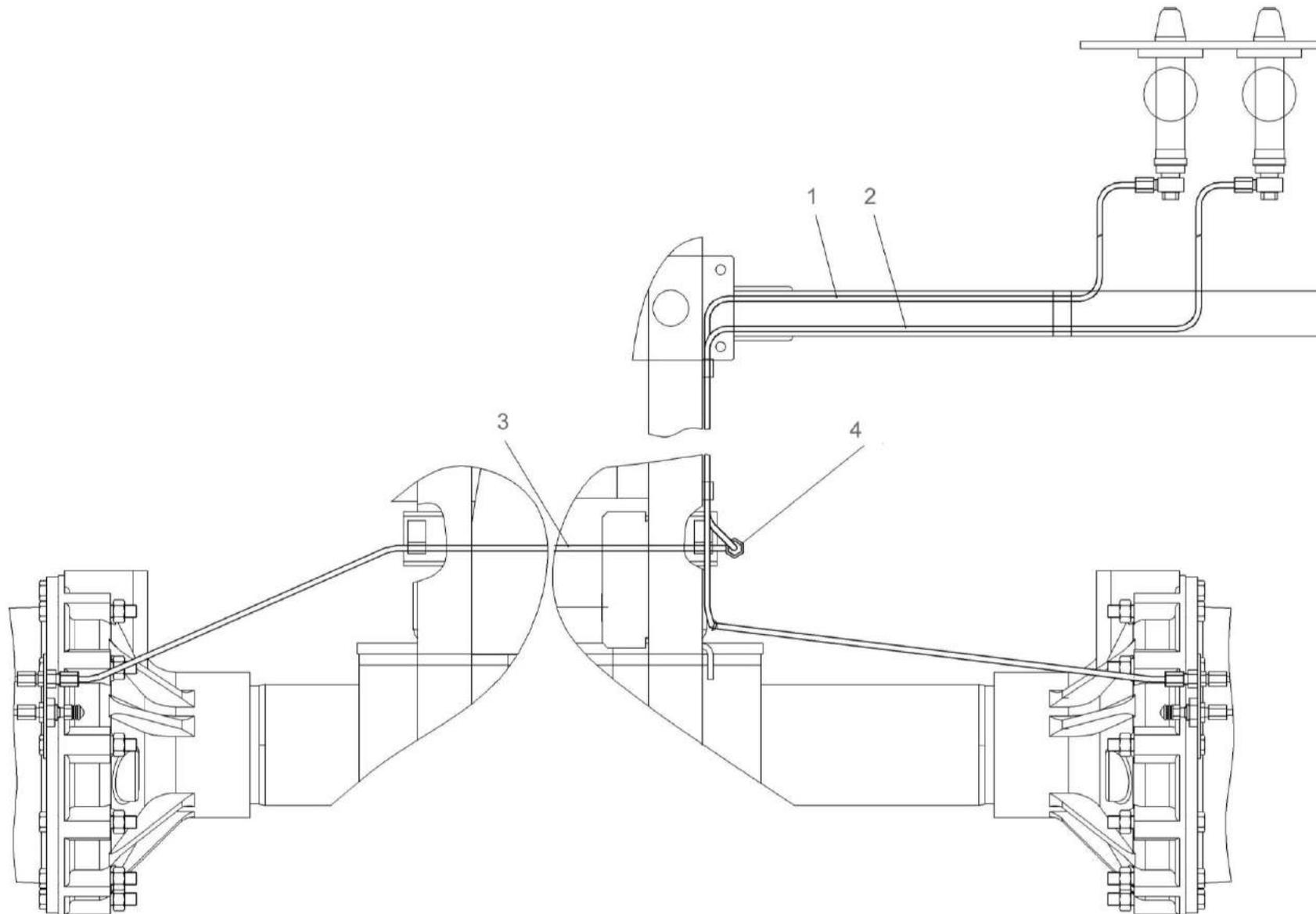
Рисунок 124 – Установка трубопроводов управления тормозами КГС 0119700
