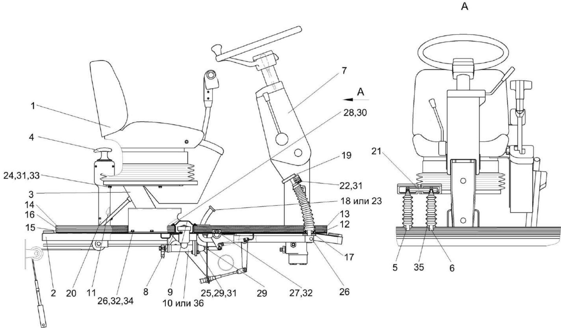
Рисунок 100 – Площадка управления КГС-1-0119000 (вид сбоку и вид спереди)
