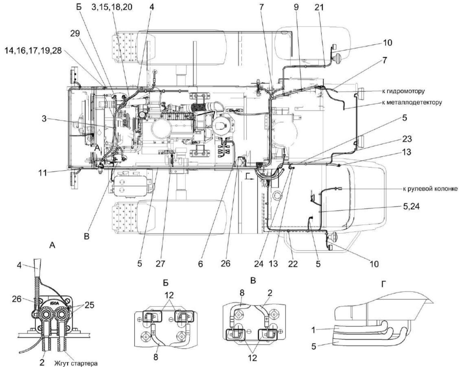
Рисунок 6 – Электрооборудование измельчителя самоходного (вид сверху)
