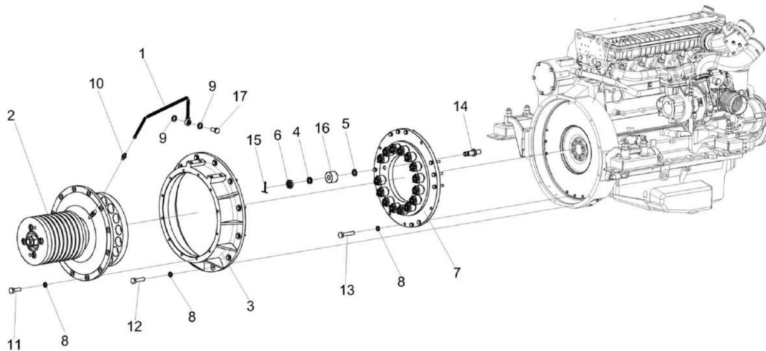
Рисунок 37 – Установка главного привода КГС-1-0116020
