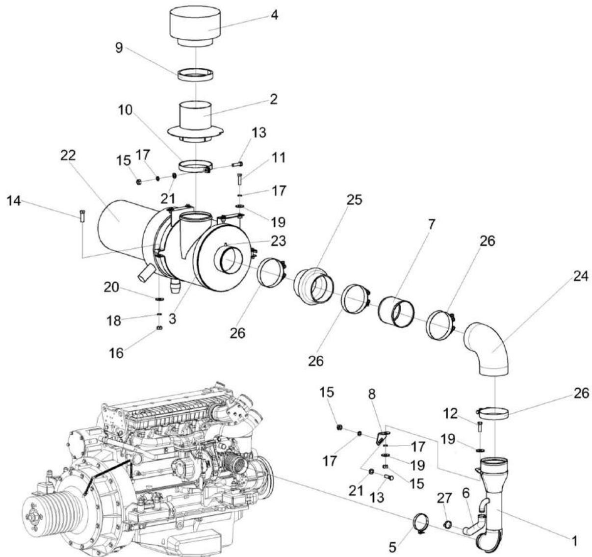
Рисунок 48 – Установка воздухоочистителя КГС-1-0116080
