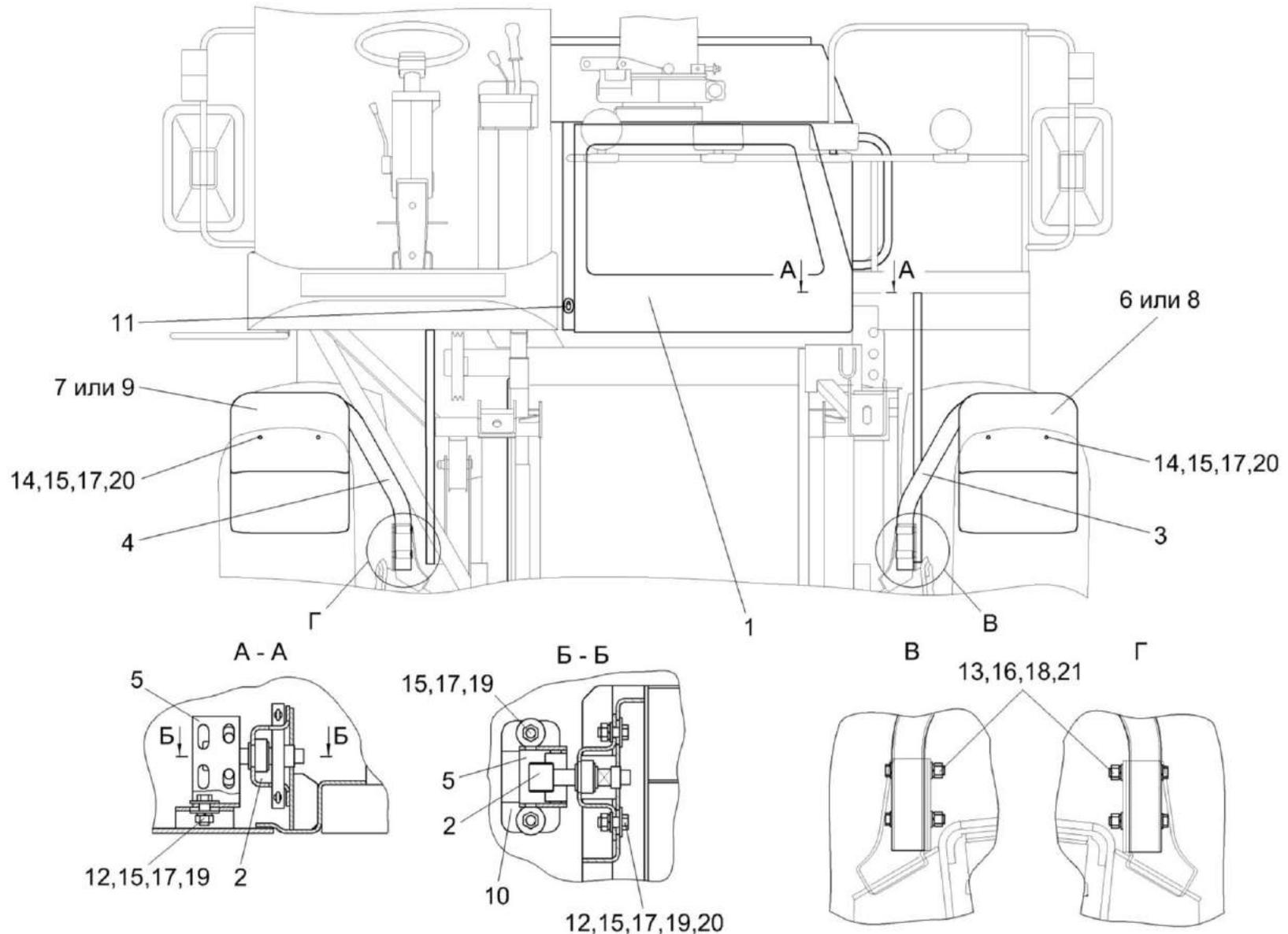
Рисунок 129 – Установка капотов КГС 0128000-02 (вид спереди)
