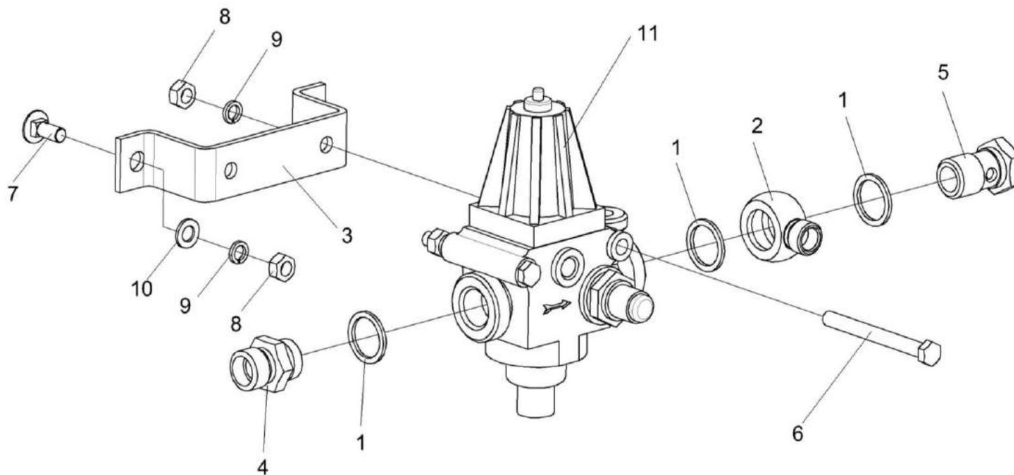
Рисунок 164 – Регулятор давления КГС 0180190
