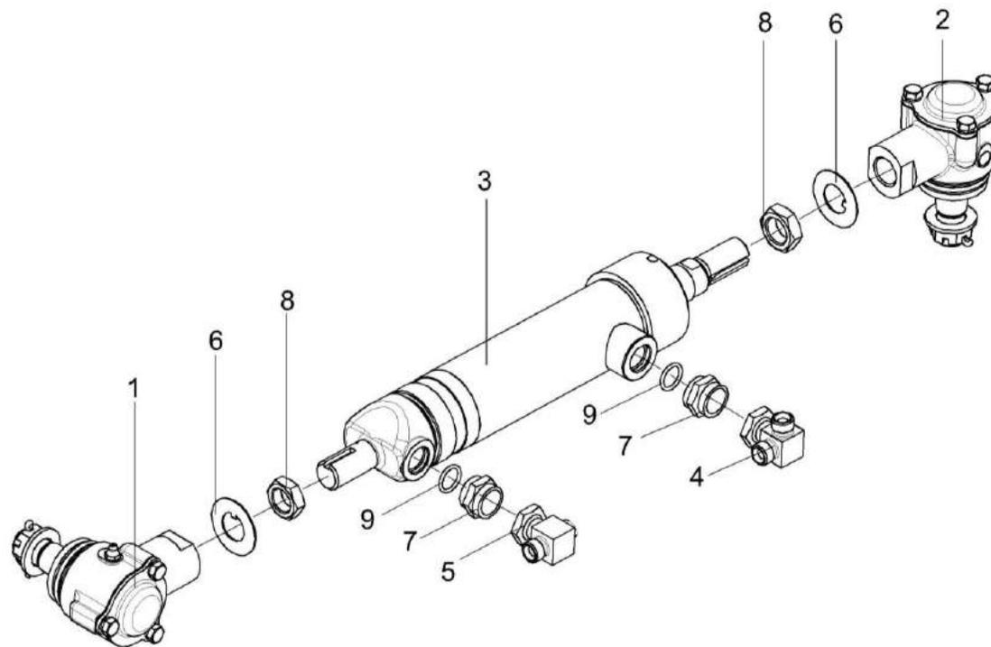
Рисунок 85 – Гидроцилиндр КИЛ 0118460
