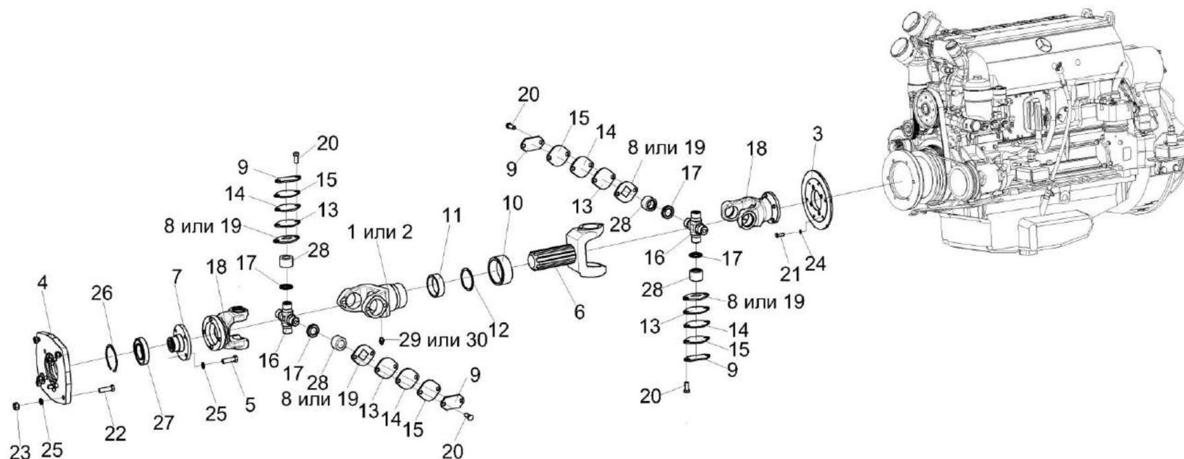
Рисунок 50 – Установка вала карданного КИЛ 0106850
