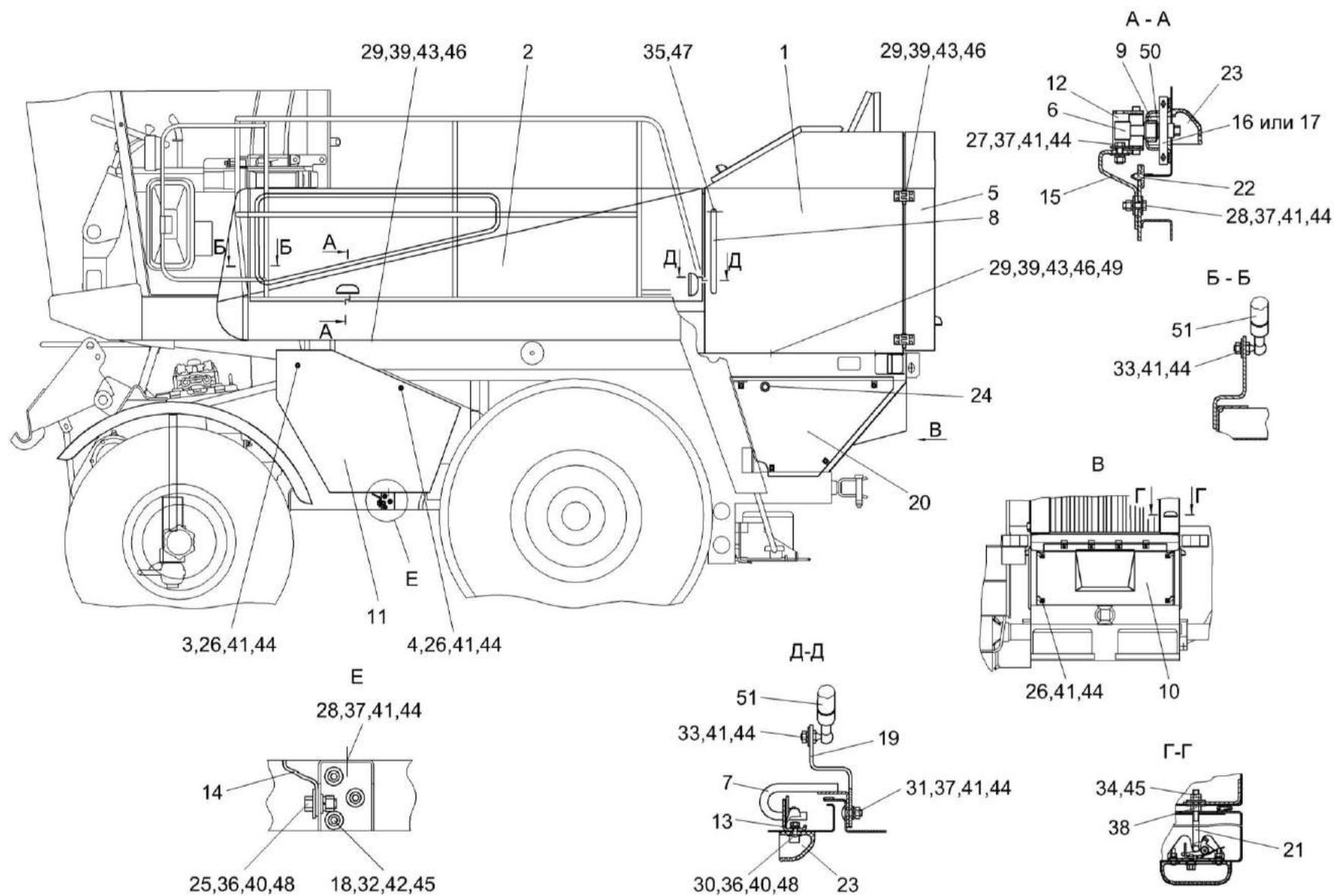
Рисунок 126 – Установка капотов КГС 0128000-02 (вид слева)
