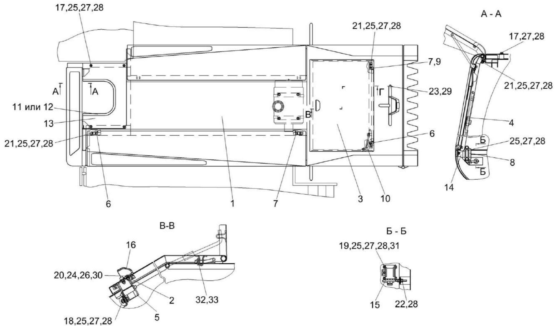
Рисунок 128 – Установка капотов КГС 0128000-02 (вид сверху)
