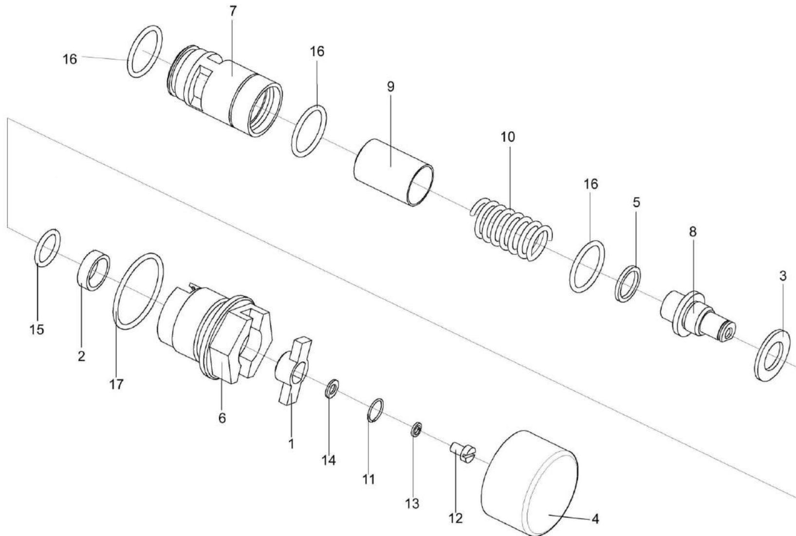
Рисунок 159 – Клапан-сигнализатор УЭС 0603660
