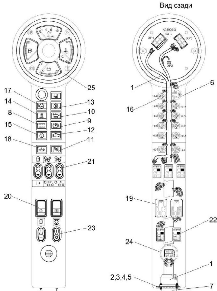
Рисунок 119 – Электрооборудование пульта контроля КГС-1-0122000
