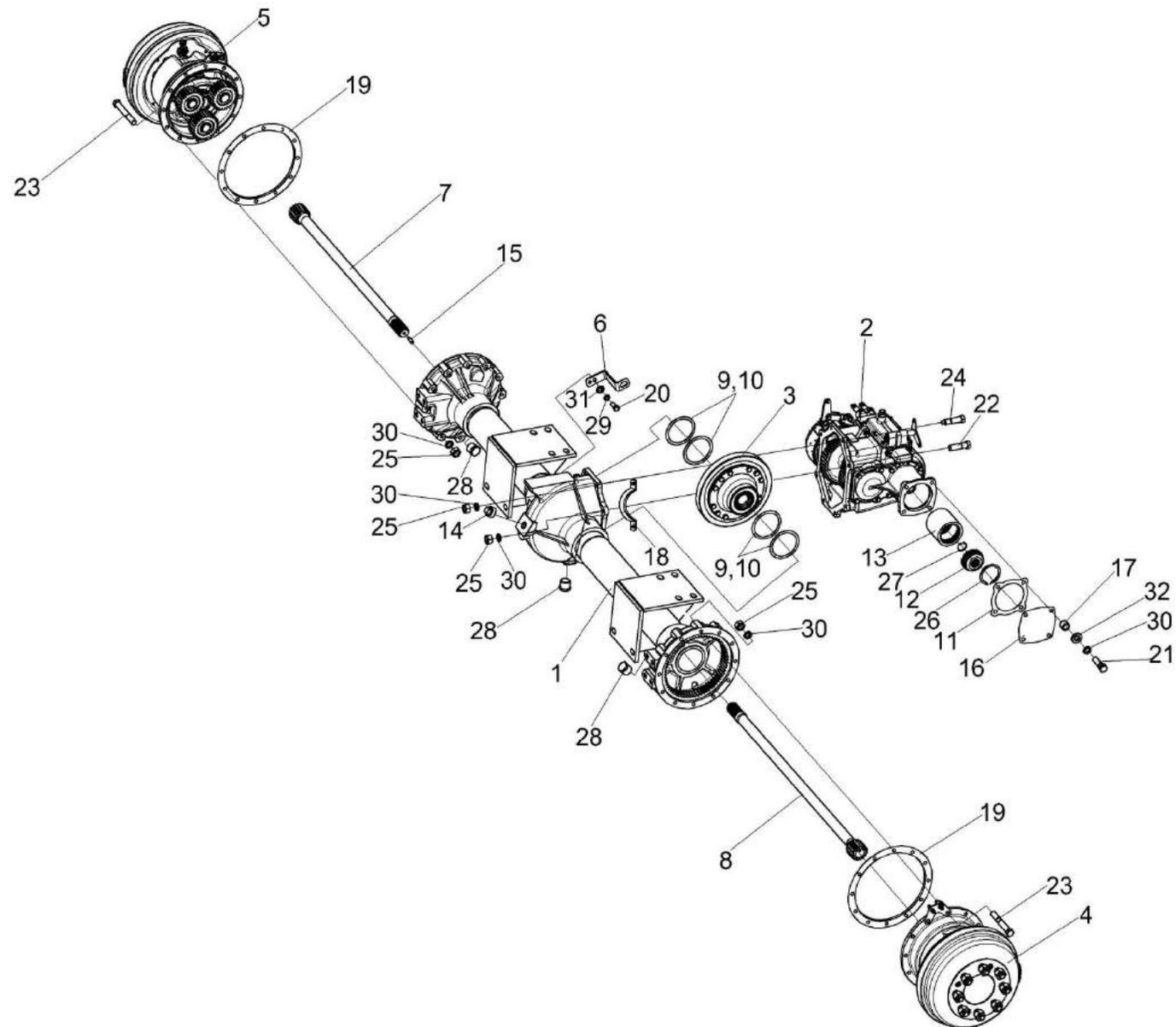
Рисунок 71 – Мост ведущих колес КГС 0107000
