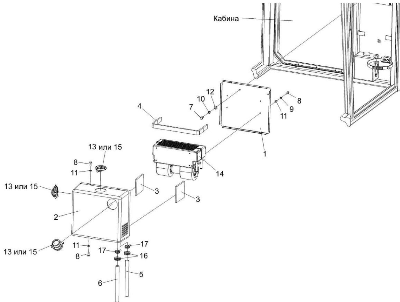
Рисунок 95 – Установка отопителя КГС 0120980
