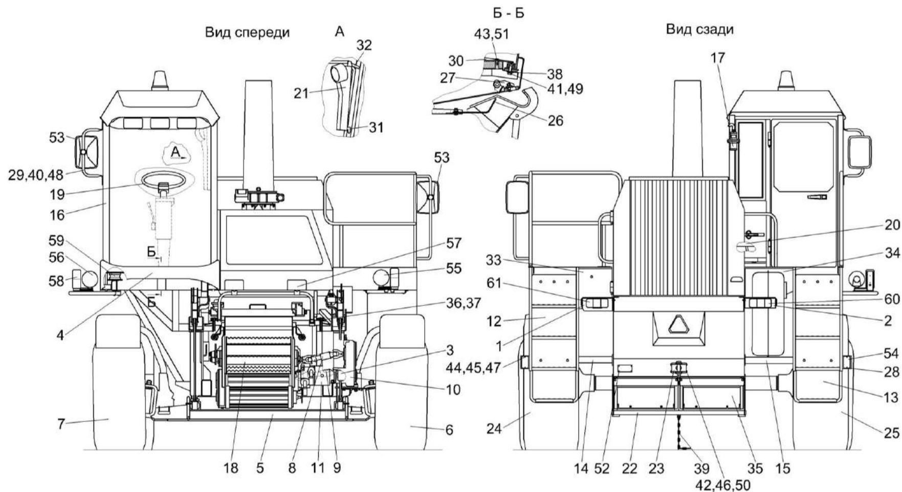
Рисунок 4 – Измельчитель самоходный КГС-10-0100000 (вид спереди, вид сзади)
