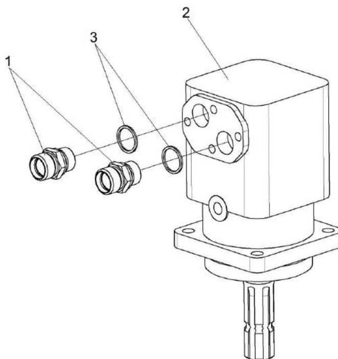
Рисунок 148 – Гидромотор привода адаптеров КГС 0115380
