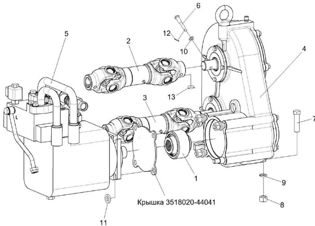
Рисунок 62 – Установка редуктора КГС 0114000
