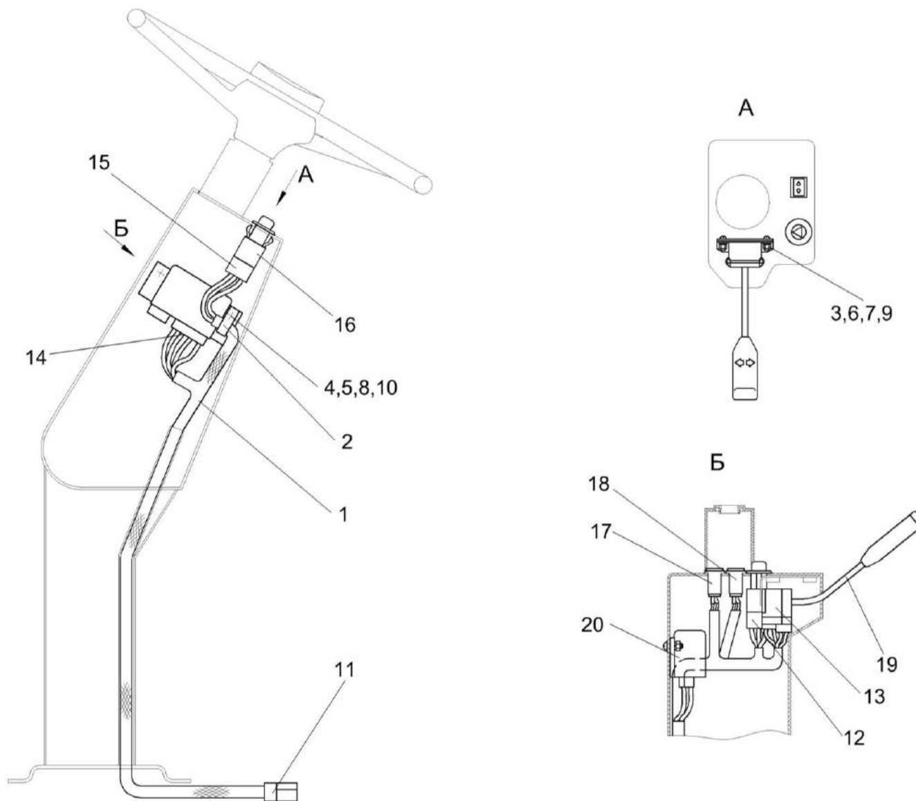
Рисунок 110 – Электрооборудование рулевой колонки
