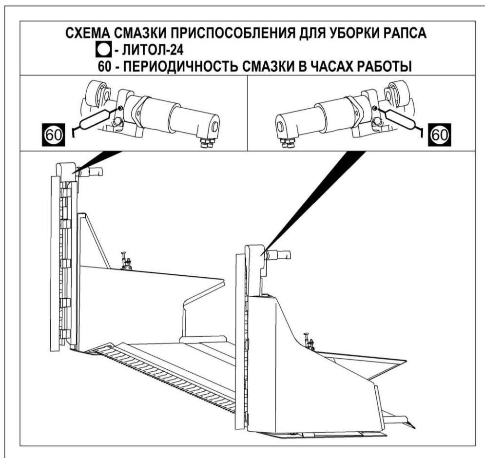
Рисунок 3.1 – Схема смазки приспособления
