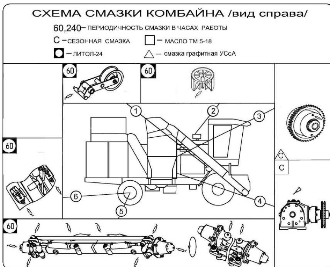
Рисунок 3.1 – Схема смазки комбайна (вид справа)
