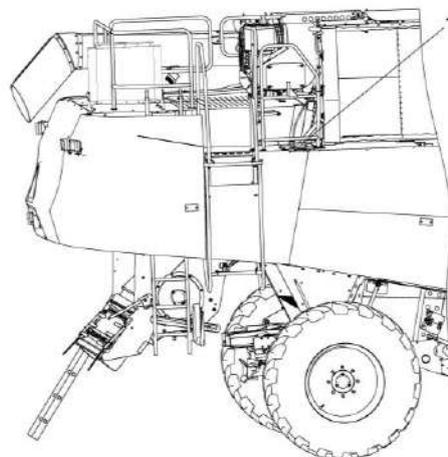
1 – крышка заливной горловины топливного бака
