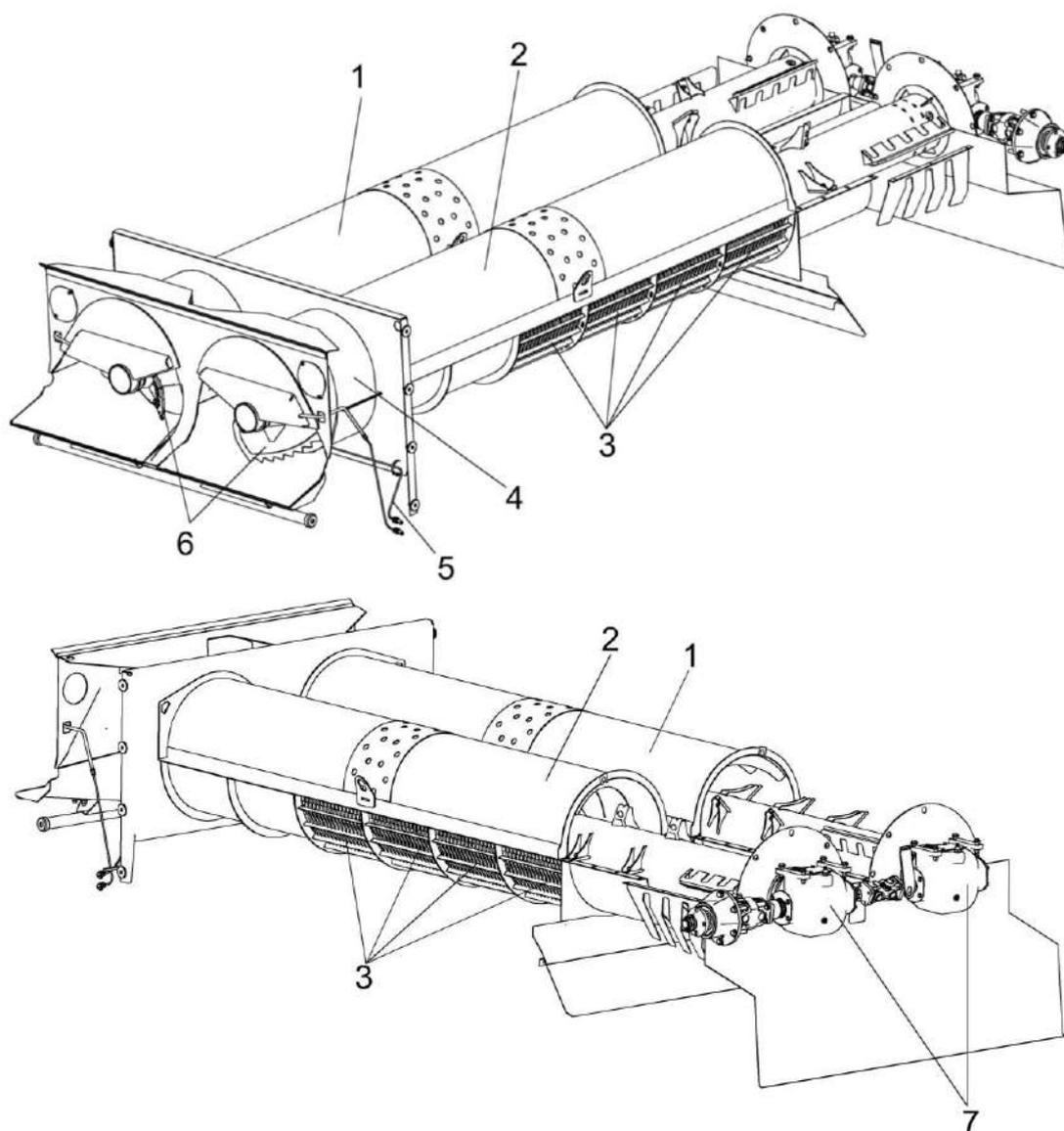
1 – кожух ротор правый; 2 – кожух ротора левый; 3 - деки; 4 – горловина; 5 – трубопровод;
