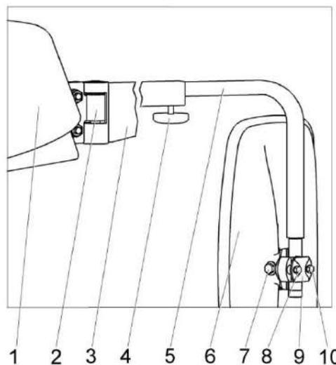
1 – крыша кабины; 2 – зажим; 3 – рычаг; 4 – винт; 5 – держатель; 6 – зеркало; 7, 8, 10 – болты; 9 – хомут зеркала
