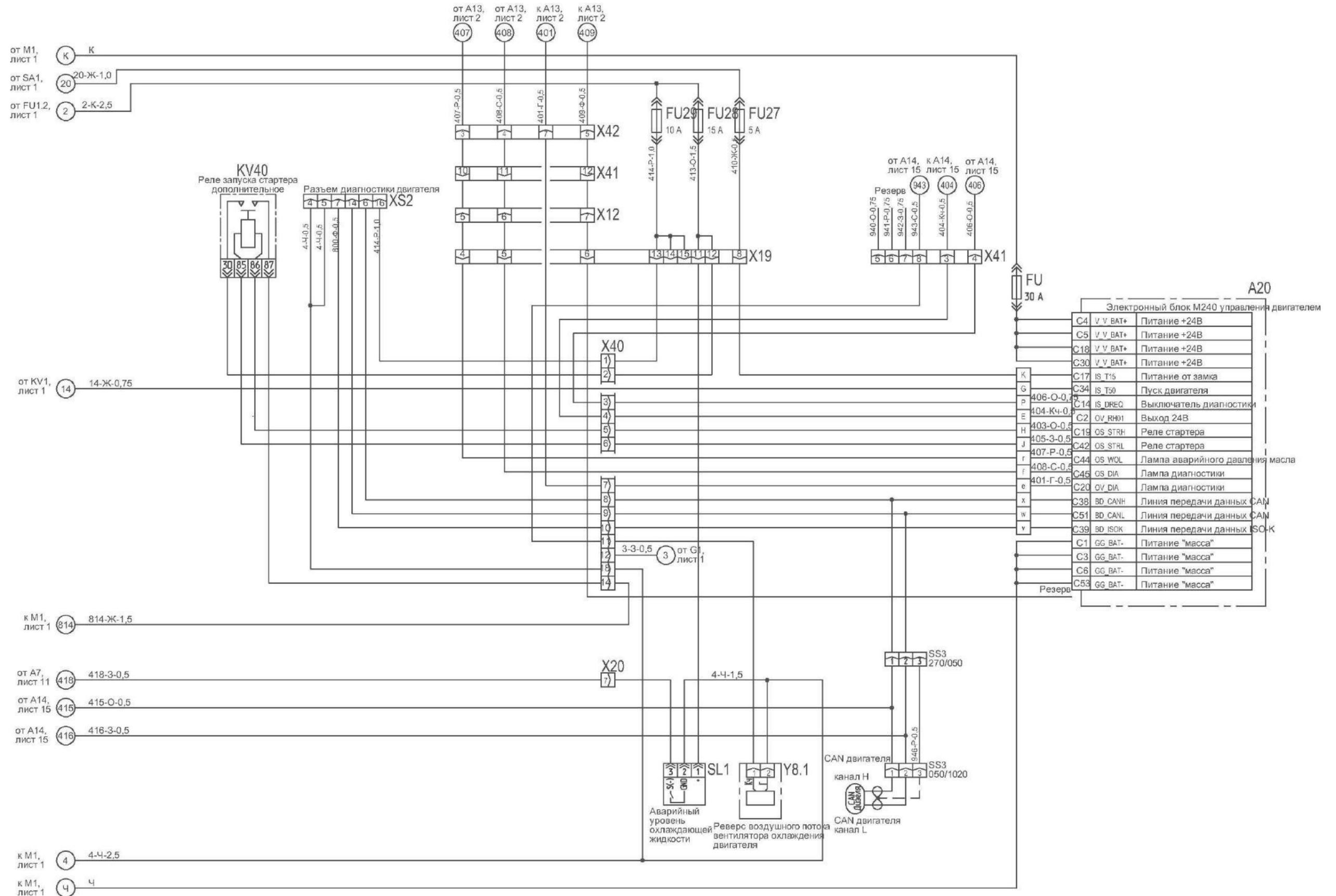
Рисунок Б.8 – Схема электрическая принципиальная комбайна (лист 8)
