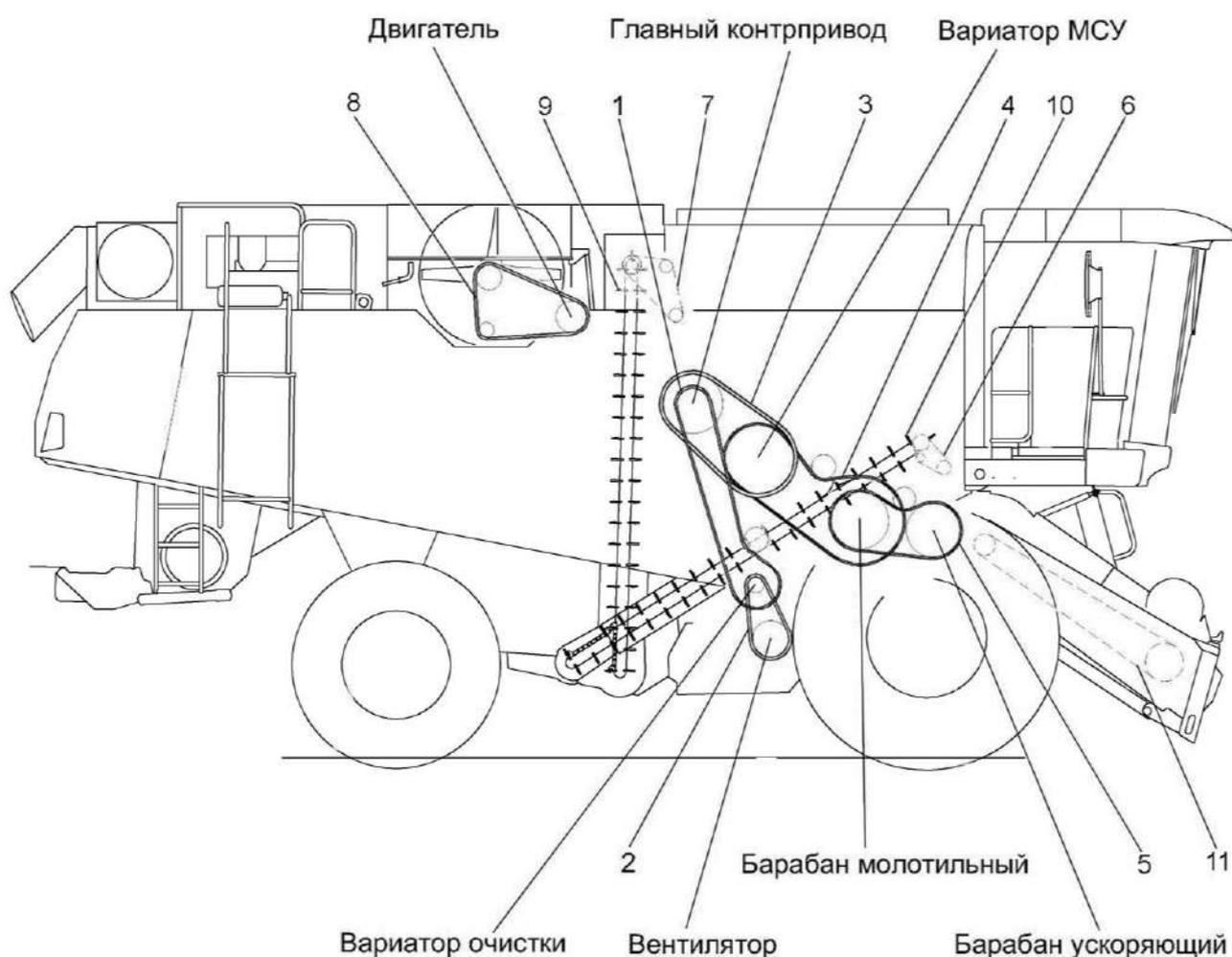
Рисунок К2 – Схема приводов комбайна (вид справа)
