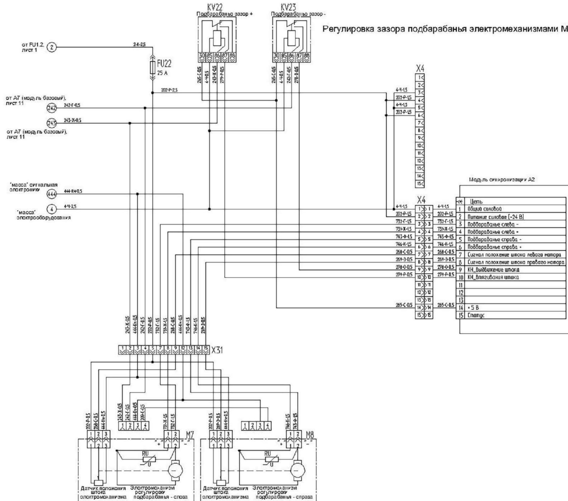
Рисунок Б.12 – Схема электрическая принципиальная комбайна (лист 12)
