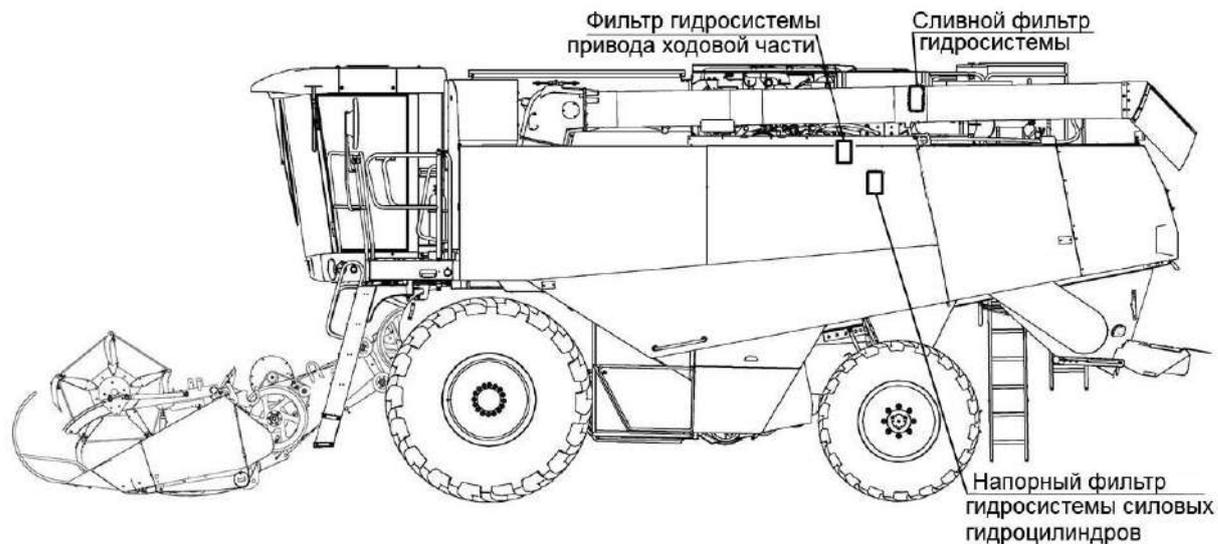
Рисунок 1.22 – Схема размещения фильтров гидросистемы комбайна
