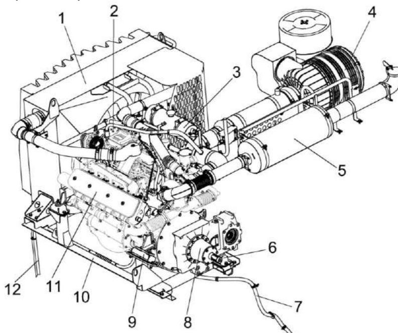
1 – радиатор; 2 – компрессор; 3 – бак расширительный; 4 – воздухоочиститель; 5 – глушитель; 6, 9 – амортизаторы; 7 – маслопровод сливной; 8 – мультипликатор; 10 – рама подmotorная; 11 – двигатель; 12 – сливной рукав охлаждающей жидкости
