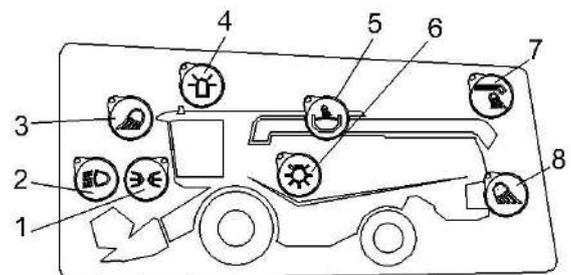
1 – выключатель габаритных огней; 2 – выключатель фар ближнего света; 3 – выключатель рабочих фар кабины; 4 – выключатель сигнальных маяков; 5 – выключатель фары освещения бункера; 6 – выключатель освещения подкапотного пространства; 7 – выключатель фары выгрузного шнека; 8 – выключатель задних рабочих фар
