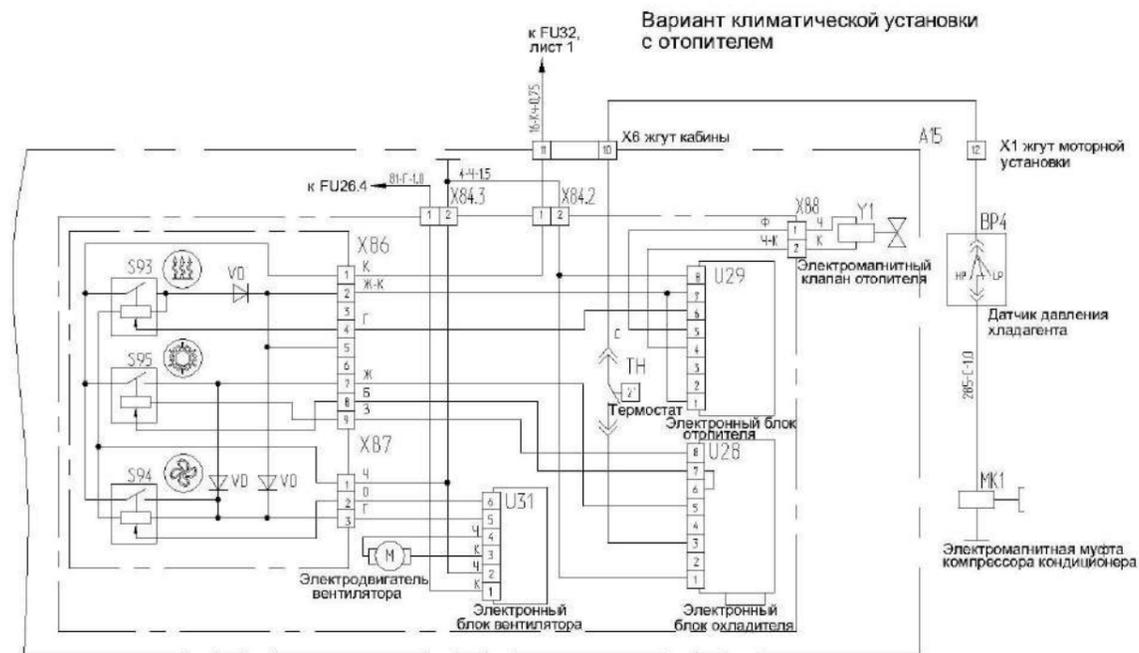
Рисунок Б.3 – Схема электрическая принципиальная комбайна (лист 3)
