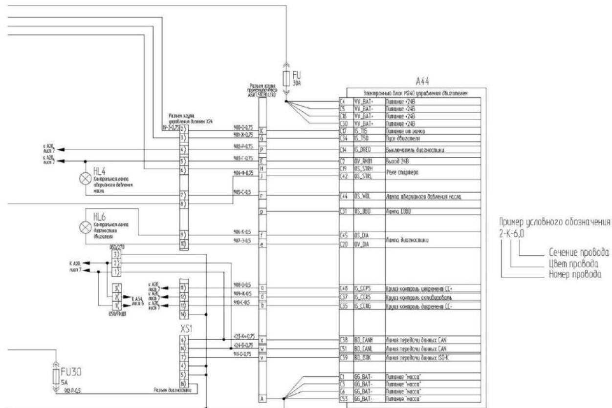
Рисунок Б.1 – Схема электрическая принципиальная комбайна (лист 1)
