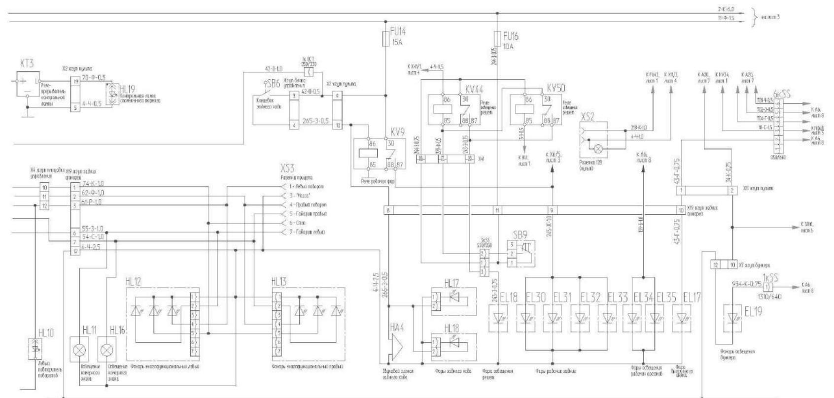
Рисунок Б.2 – Схема электрическая принципиальная комбайна (лист 2)
