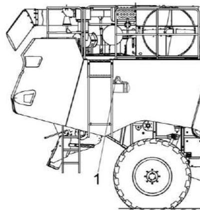
1 – крышка заливной горловины топливного бака
