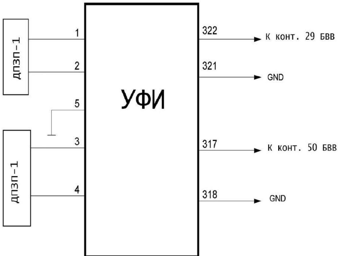
ДПЗП-1 – датчик потерь зерна пьезоэлектрический
