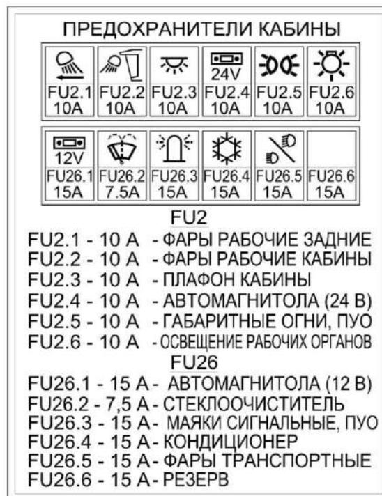
Рисунок 1.38 – Схема расположения предохранителей
