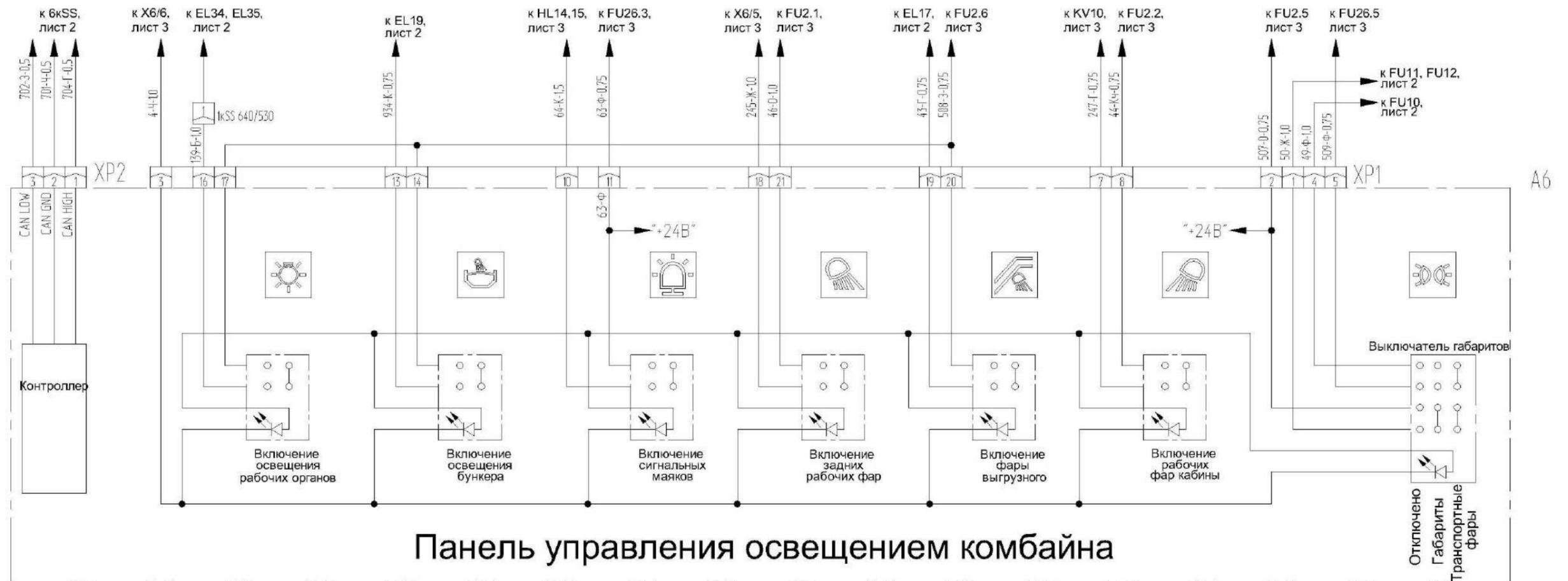
Рисунок Б.8 – Схема электрическая принципиальная комбайна (лист 8)
