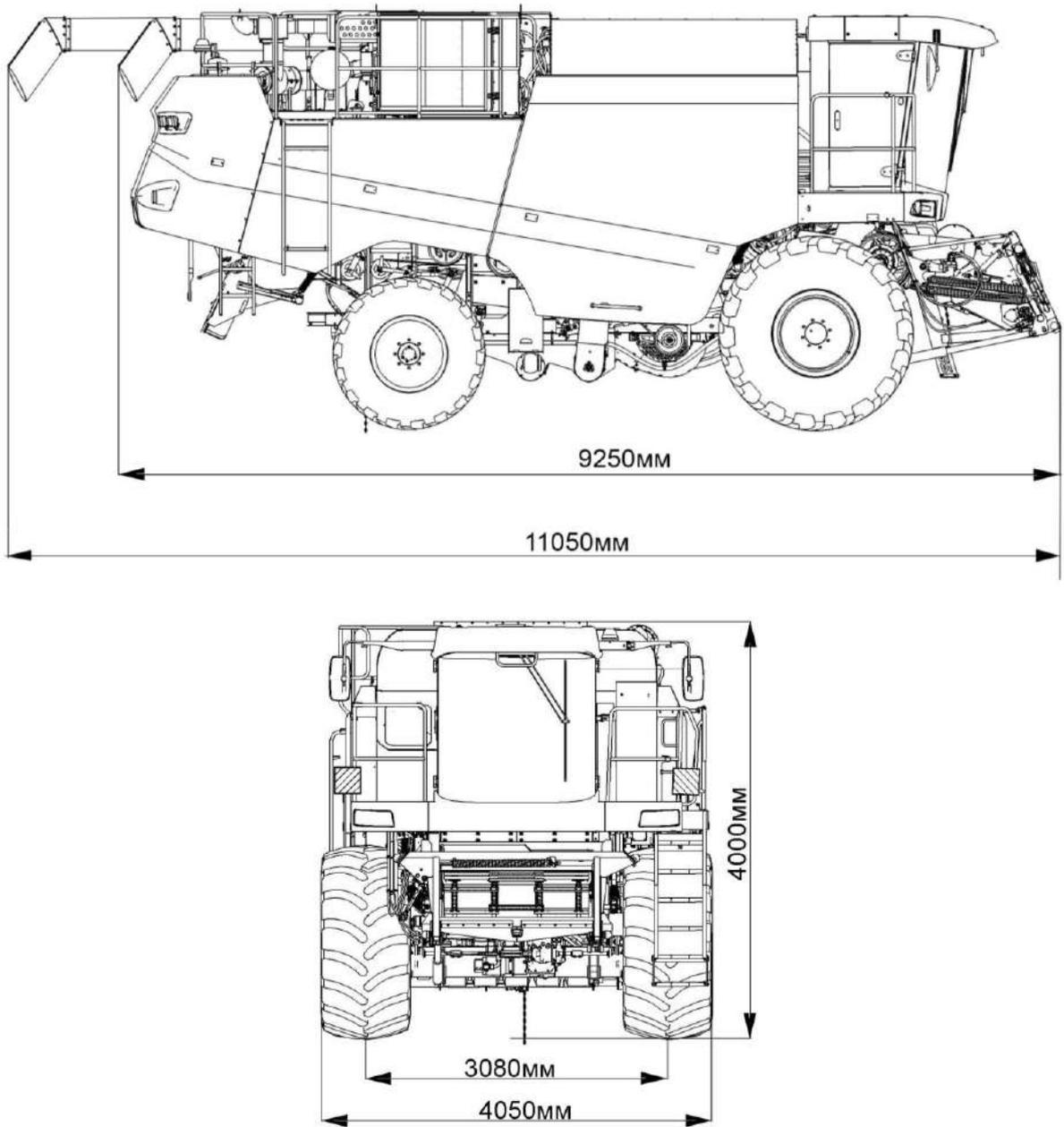
Рисунок 1.1 – Габаритные размеры комбайна
