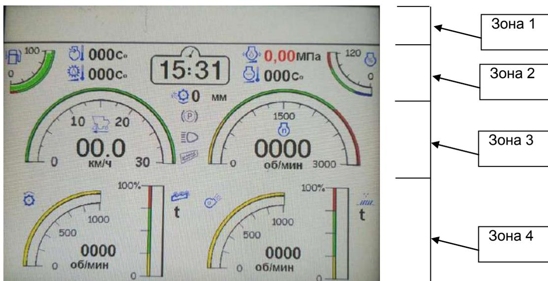
Рисунок Ж.3 – Эcran технологического режима уборки (комбайнирования)
