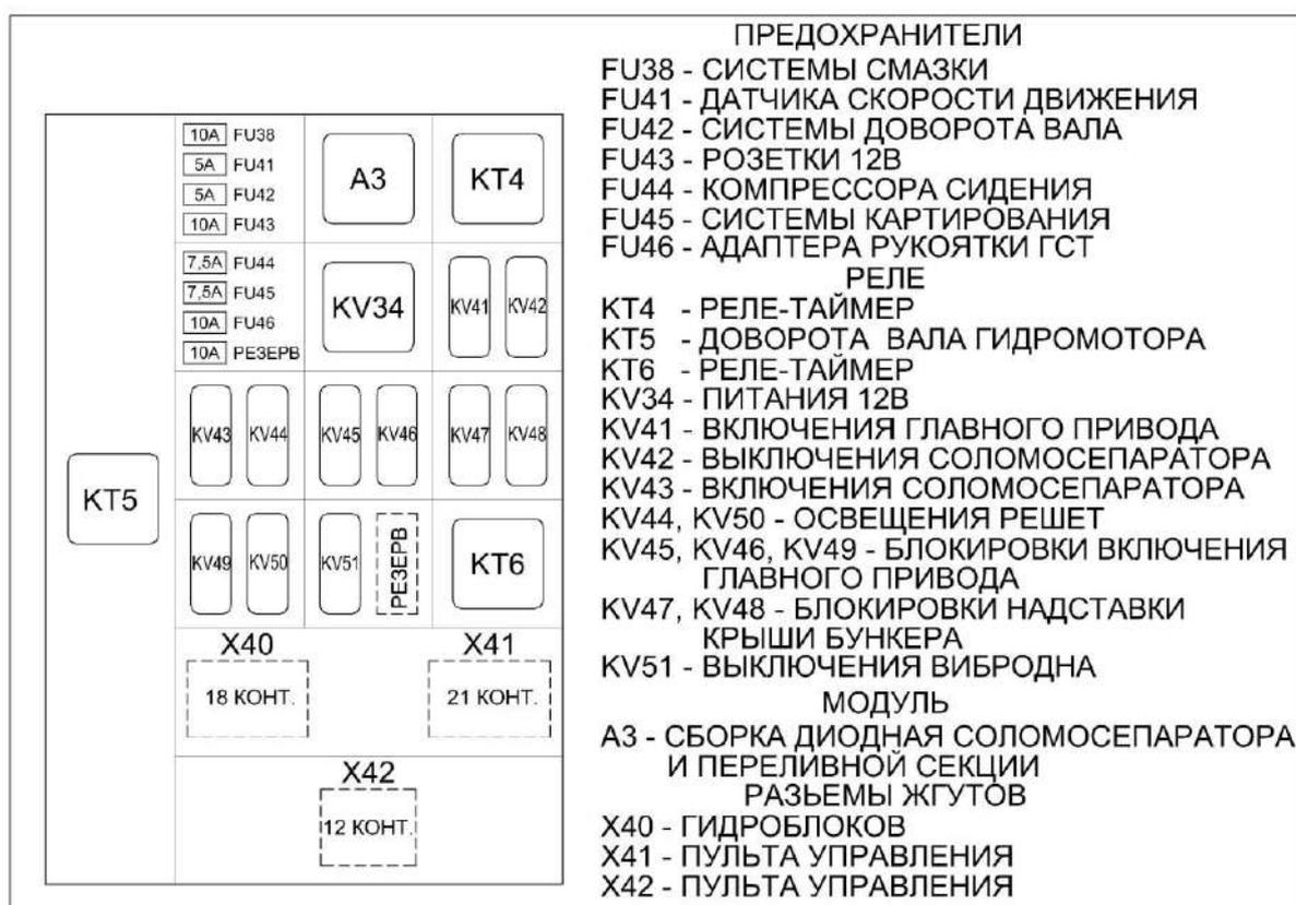
Рисунок 1.33 – Предохранители
